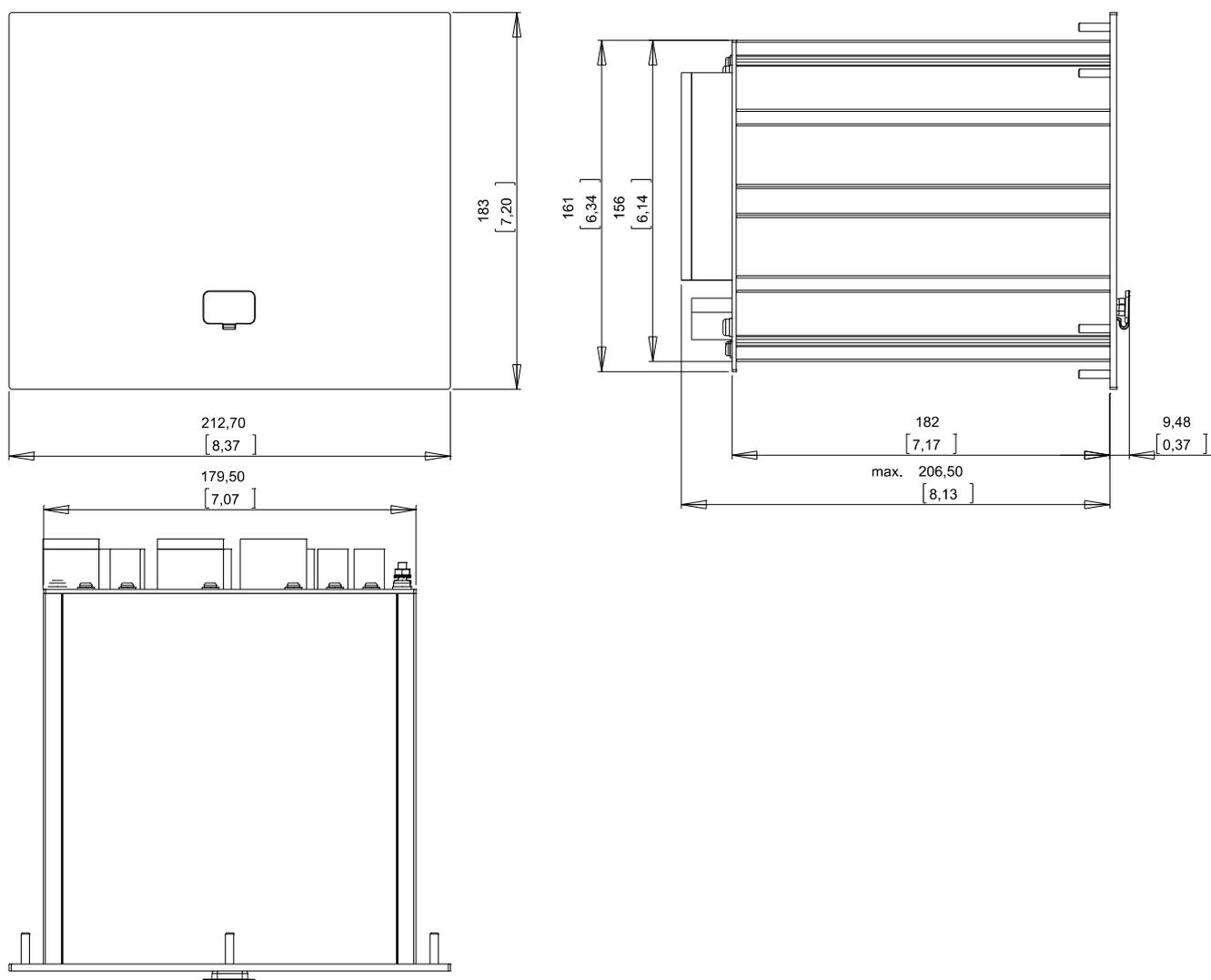
Корпус В2: внешний вид (устройства с 8 кнопками). (Все размеры указаны в миллиметрах, за исключением размеров в квадратных скобках — [дюймы].)
