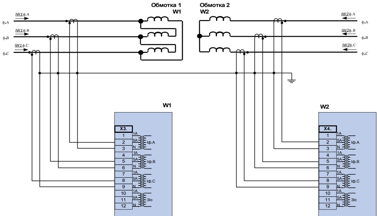
Измерение фазных токов по схеме «полной» звезды; I<sub>n</sub> вторичн. = 5 А.
