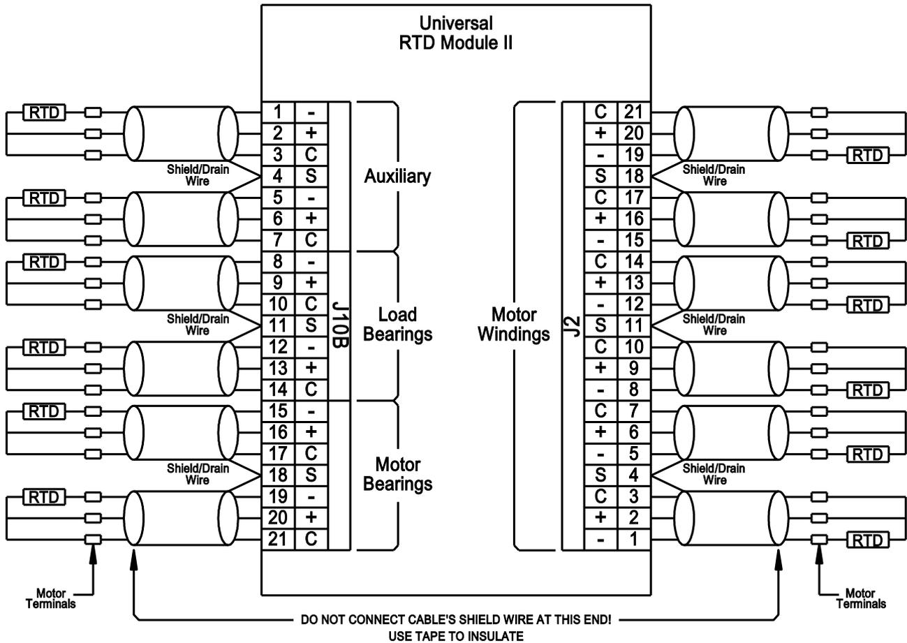
Соединение ТДС со входами УТДС показано на рисунке выше. Используйте трехпроводниковый экранированный кабель. Учитывайте правила соединения на рисунке. При выполнении соединения с ТДС, имеющим два вывода, подсоедините два кабельных проводника к одному из выводов ТДС, как показано. Выполните данное соединение как можно ближе к защищенному объекту. Подсоедините третий кабельный проводник к оставшемуся выводу ТДС.
