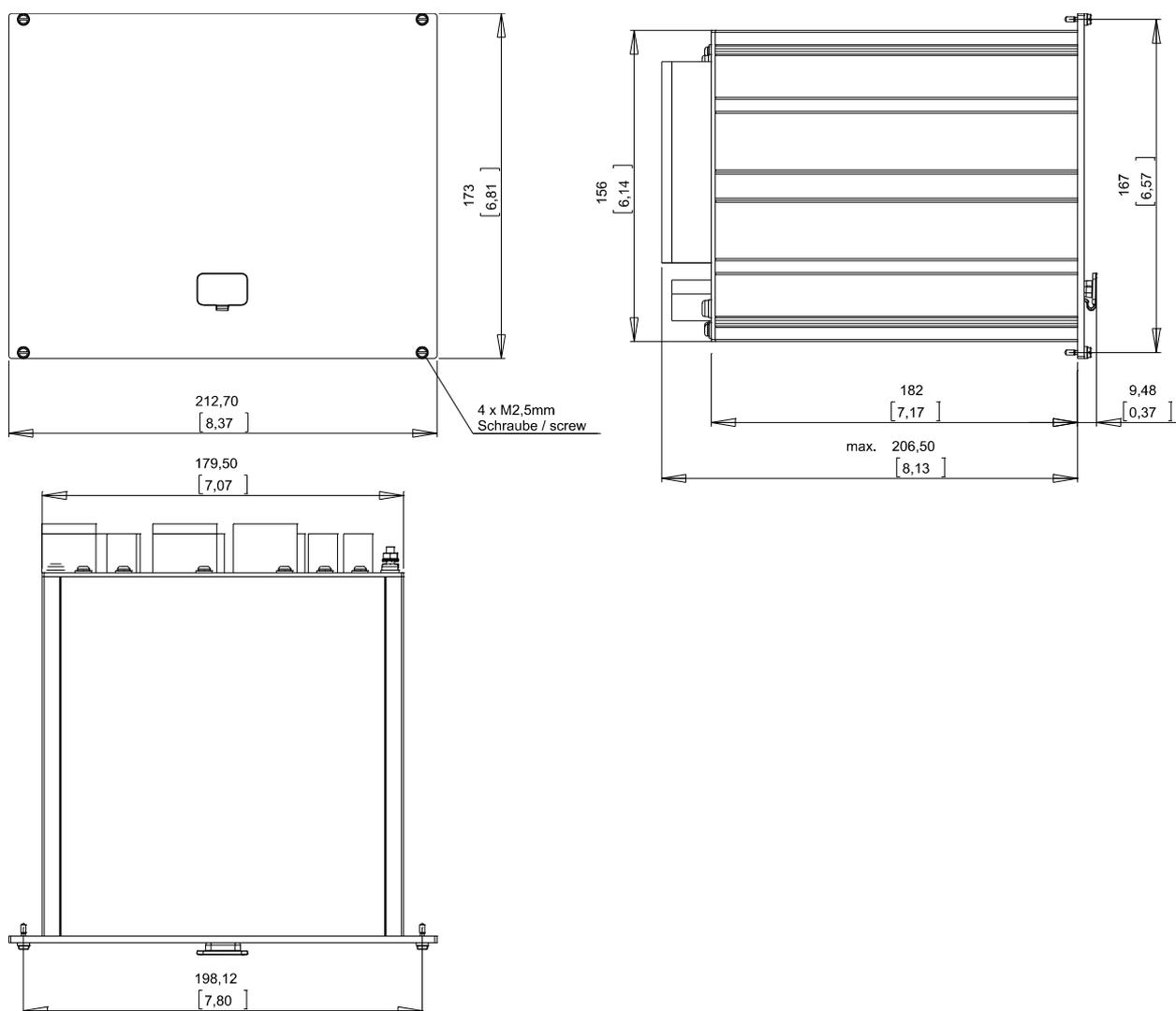
Корпус B2: внешний вид (устройства 19 дюймов). (Все размеры указаны в миллиметрах, за исключением размеров в квадратных скобках — [дюймы].)
