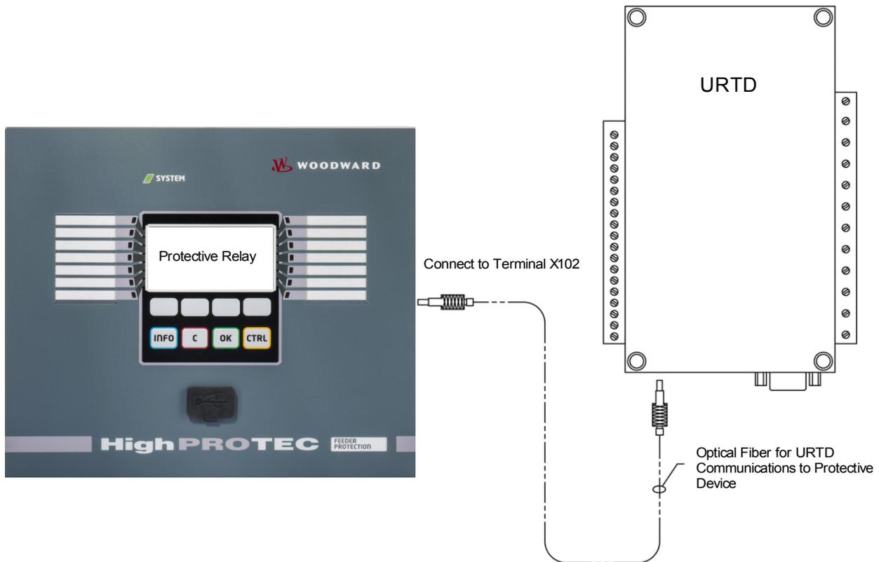
На вышеприведенном рисунке показаны оптоволоконные соединения между модулем УТДС II и защитным устройством. Защитное устройство поддерживает оптоволоконное соединение.
