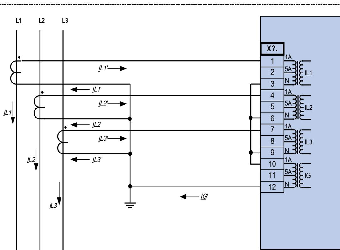
Mesure de courant triphasé ; In sec = 1 A.
