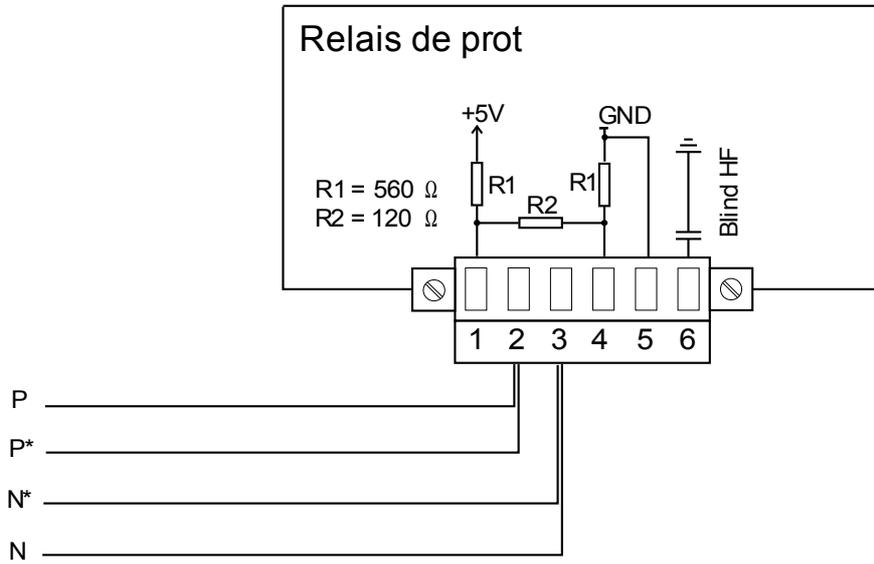
Type 2 Exemple de câblage. Module à la fin du bus (à l'aide de la résistance de la borne intégrée)
