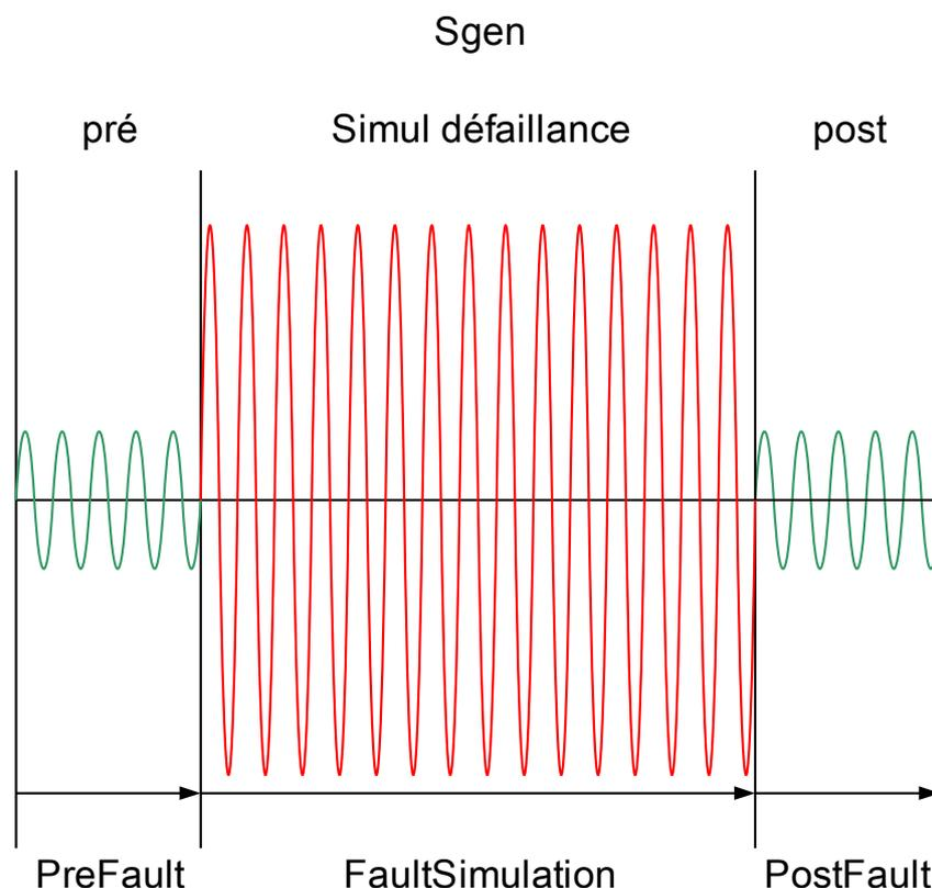
Les compteurs d'énergie seront arrêtés pendant que le fonctionnement du simulateur de panne.
