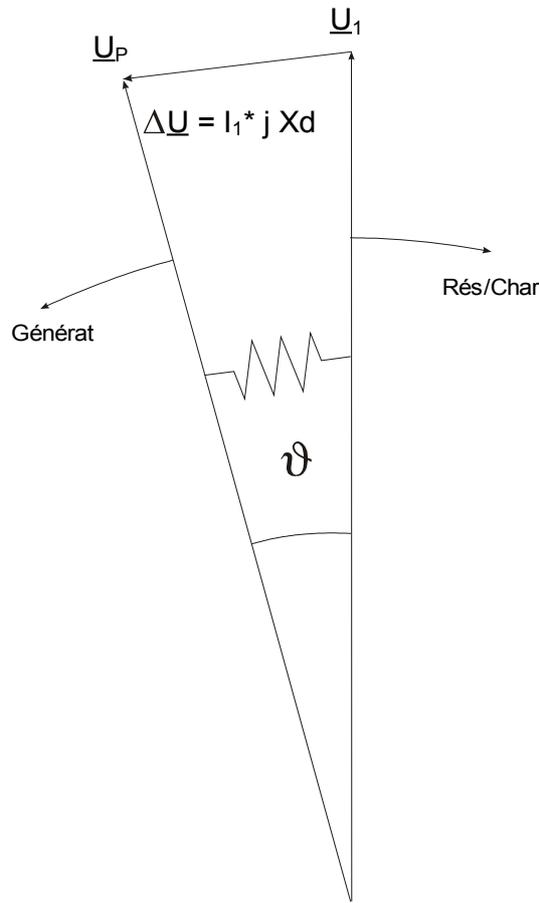
L'angle de déplacement du rotor entre le stator et le rotor dépend du couple mécanique mobile du générateur. La puissance de transmission mécanique est équilibrée avec la puissance d'alimentation électrique et, par conséquent, la vitesse synchrone reste constante.
