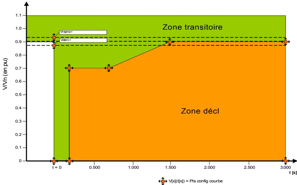
L'élément LVRT repassera en veille dès que la tension du système est rétablie : Cela signifie que la tension a dépassé la tension de rétablissement prédéfinie « Vrecover ».
