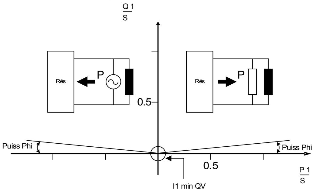
Méthode 2 : Surveillance de la puissance réactive pure
