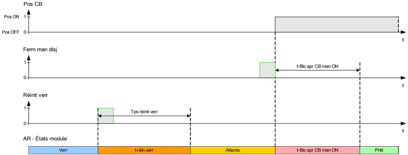
Logique de réinitialisation du verrouillage du réenclenchement automatique si la réinitialisation du verrouillage se produit après la fermeture du disjoncteur manuelle
