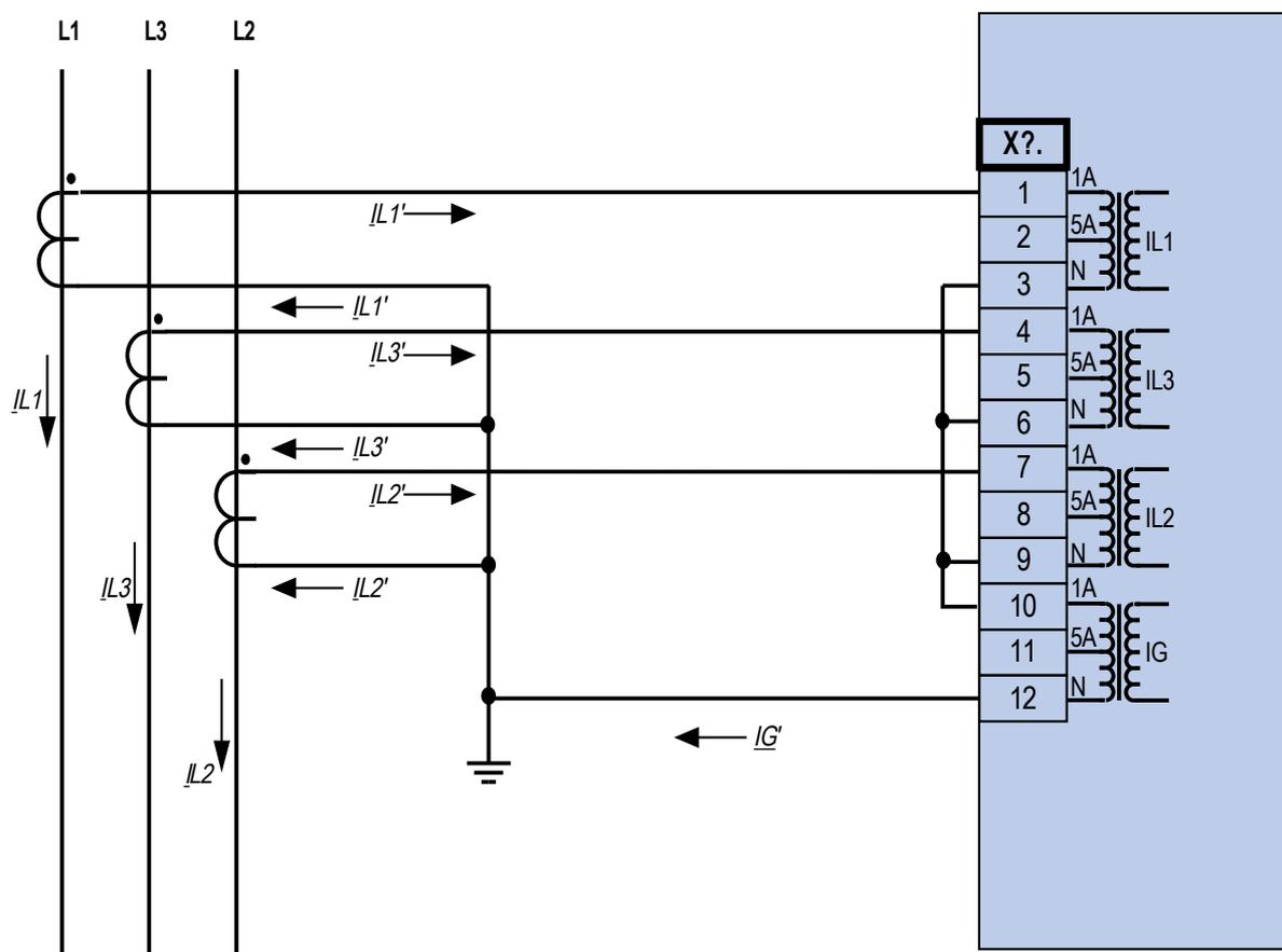
Mesure de courant triphasé ;  $I_n \text{ sec} = 1 \text{ A}$ .
