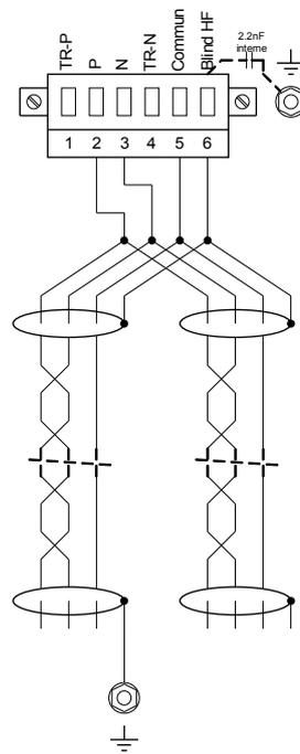
Blindage côté maître bus connecté aux résist terminaison de terre inutilisé
