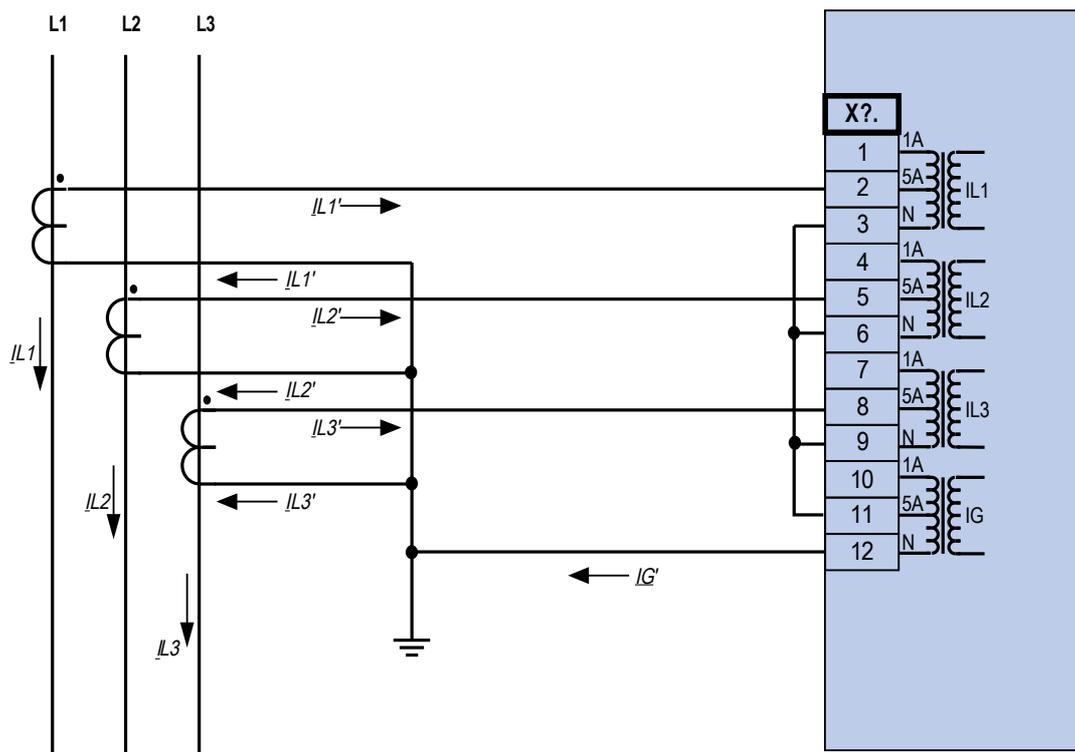
Mesure de courant triphasé ; In sec = 5 A.
