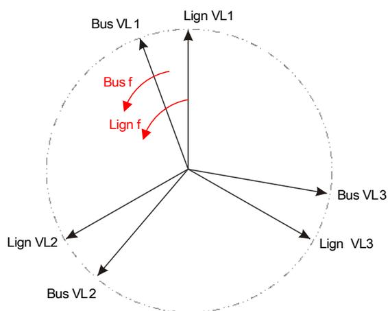
Si la fréquence du générateur  $f_{\text{Bus}}$  n'est pas égale à la fréquence du secteur  $f_{\text{Line}}$ , il se produit un glissement de fréquence
