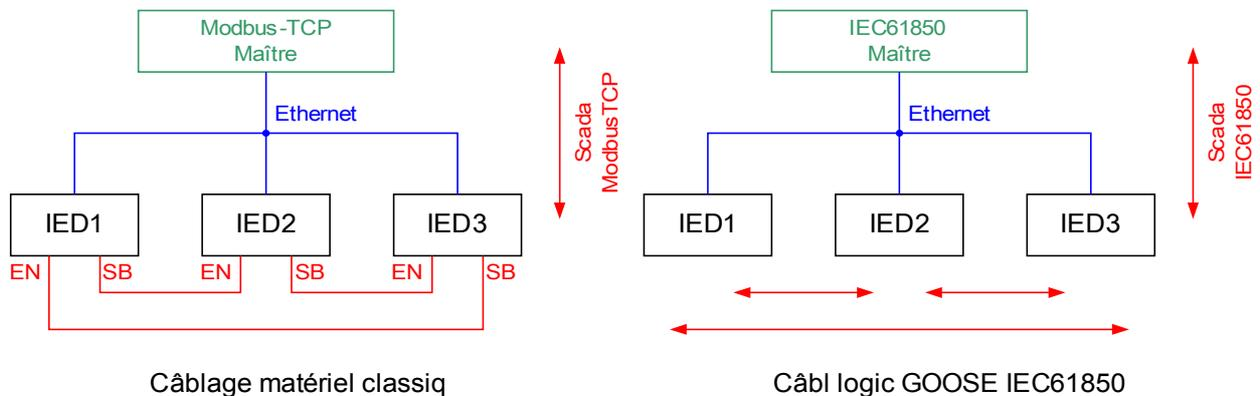
*Étapes de la mise en service d'une sous-station classique avec un environnement Modbus TCP :*
