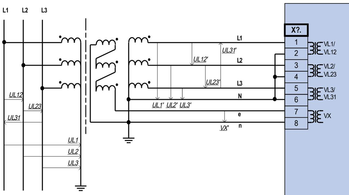
Mesure de tension triphasée - câblage des entrées de mesure: "connex étoile"
