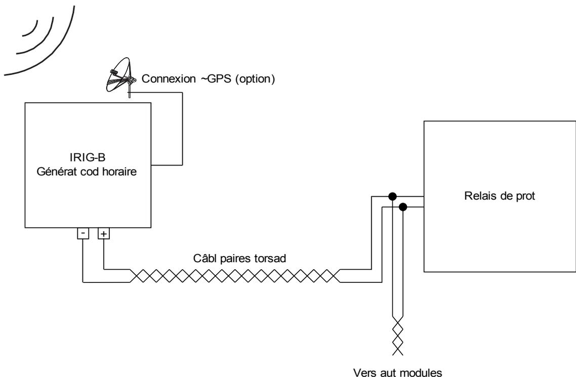
L'emplacement de l'interface IRIG-B dépend du type de module. Reportez-vous au schéma de câblage fourni avec le dispositif de protection.
