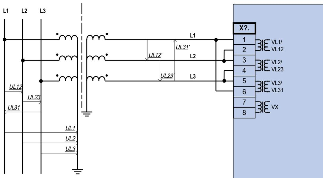
Mesure de tension triphasée - câblage des entrées de mesure: "trian ouv"
