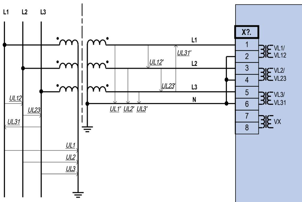
Mesure de tension triphasée - câblage des entrées de mesure: "connex étoile"
