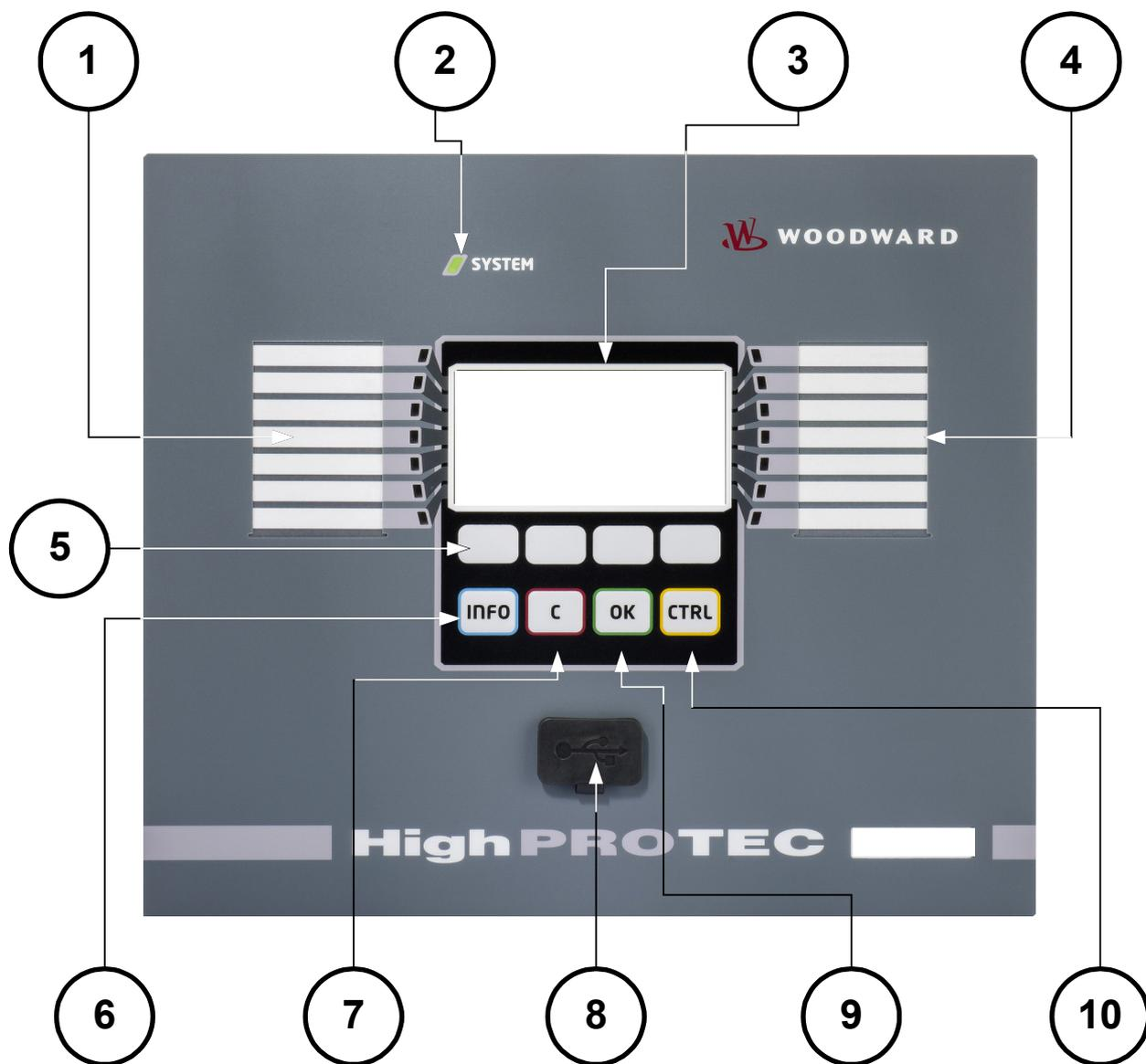
L'illustration suivante s'applique aux dispositifs de protection dotés d'un grand afficheur :
