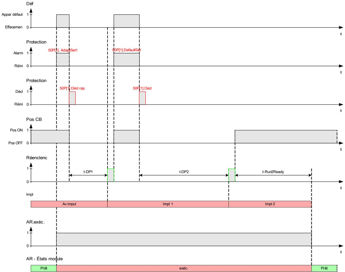
États du réenclenchement automatique pendant la fermeture manuelle du disjoncteur
