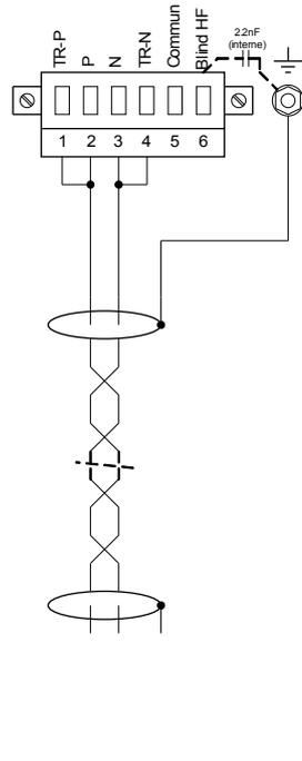
Blindage côté esclave bus connecté aux résist termin terre utilisé
