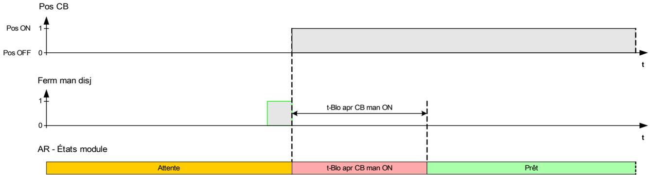
Déclenchement de la protection pendant l'écoulement de la temporisation du blocage de fermeture manuelle
