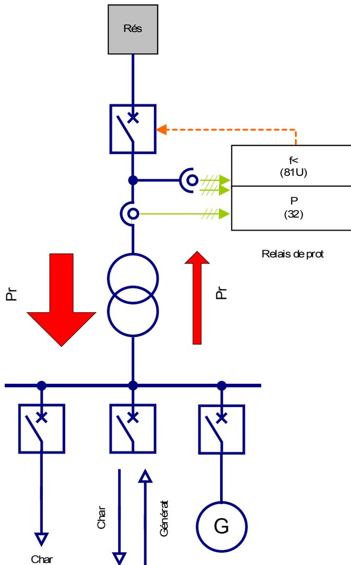
*Délestage de charge de sous-fréquence décentralisé au sein de réseaux avec alimentation temporaire.*
