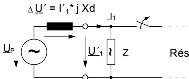
En cas de panne du réseau ou de réenclenchement automatique, le générateur alimente soudain une charge très élevée. L'angle de déplacement du rotor est diminué de façon répétée et le vecteur de tension  $V_1$  change de direction ( $V_1'$ ).
