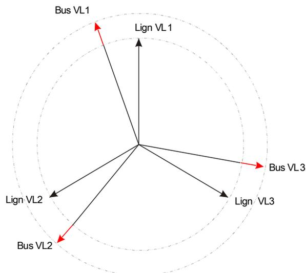
*Différence de fréquence (Glissement de fréquence)  $\Delta F$*
