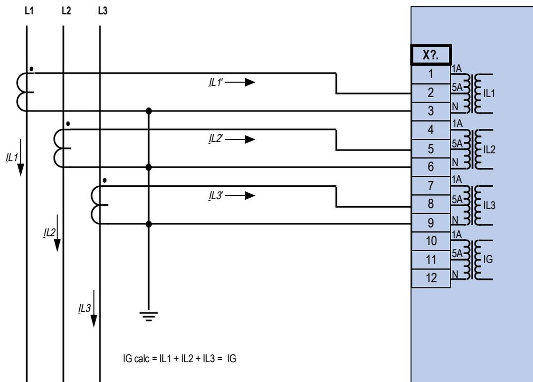
Mesure de courant triphasé ;  $I_n \text{ sec} = 5 \text{ A}$ .
