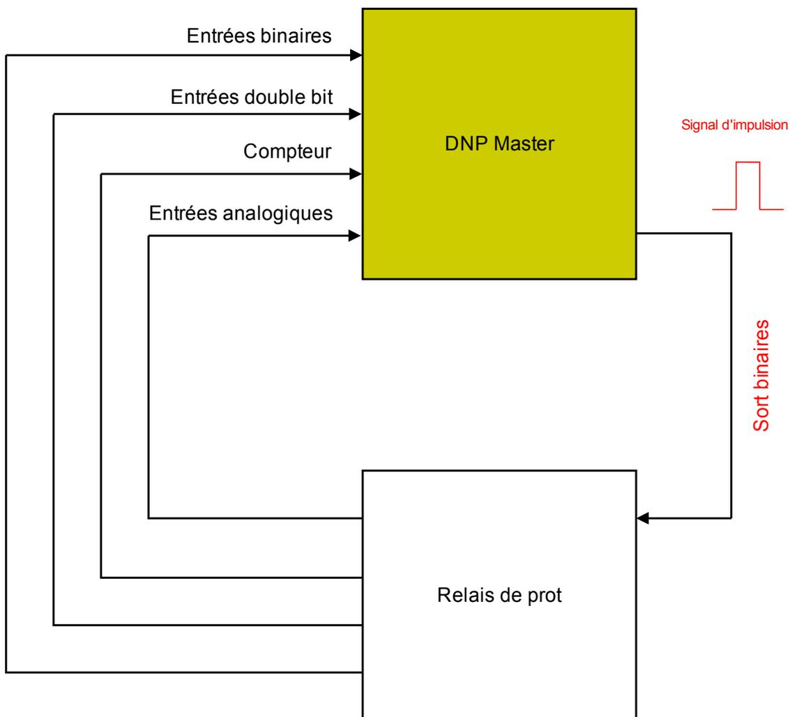
Veuillez essayer d'éviter les écarts qui ralentiront la performance de la communication DNP. Cela signifie ne pas laisser d'entrées / de sorties non utilisées entre les entrées / sorties utilisées (par exemple ne pas utiliser la sortie binaire 1 et 3 lorsque 2 est non utilisée).
