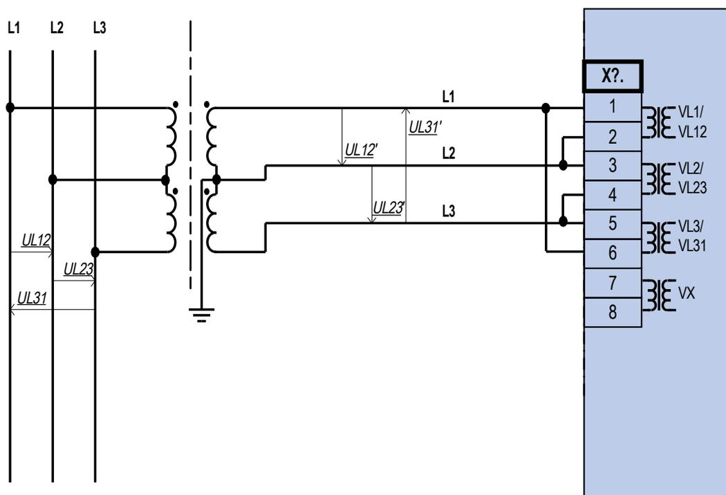
Mesure de tension biphasée - câblage des entrées de mesure: "Trian ouv"
