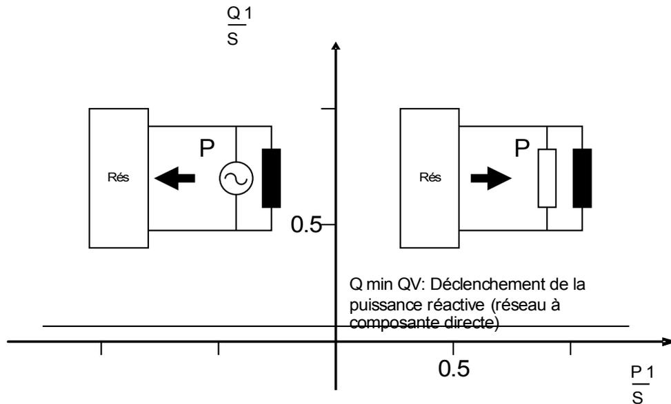
La surveillance du courant minimal ( $I_1$ ) dans le réseau à composante directe empêche un hyperfonctionnement de la surveillance de la puissance réactive à des niveaux de puissance inférieurs.
