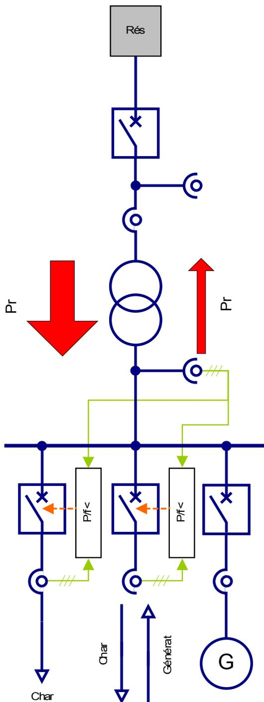
Utilisation centralisée au sein de réseaux avec alimentation prédominante
