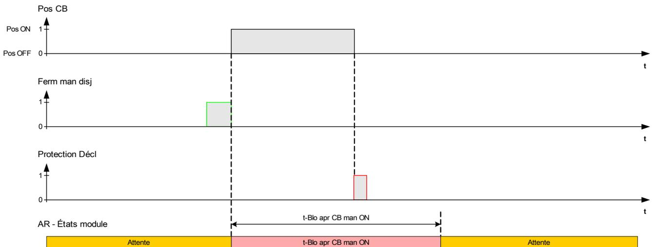
Logique de réinitialisation du verrouillage du réenclenchement automatique si la réinitialisation du verrouillage se produit avant la fermeture du disjoncteur manuelle
