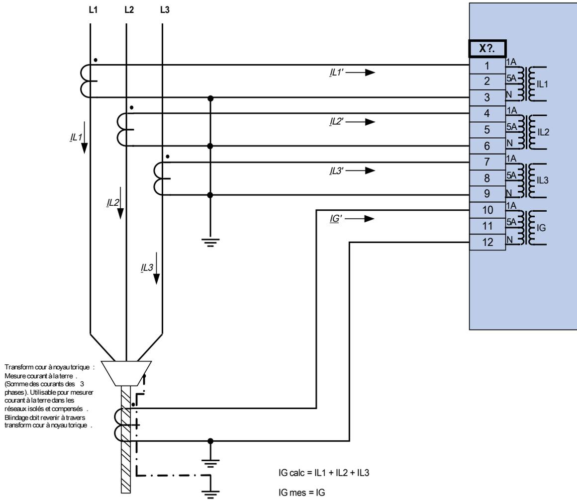
Mesure de courant triphasé ; In sec = 1 A.
