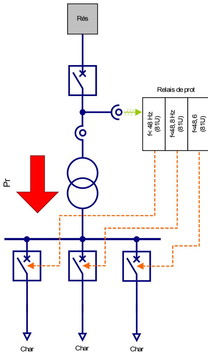
*Délestage de charge de sous-fréquence centralisé au sein de réseaux avec alimentation temporaire.*
