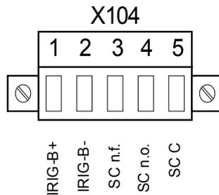
Le *contact System OK (relais SC)* n'est pas configurable. Le contact système est un contact à bascule qui est excité lorsque le dispositif est sans défaut interne. À l'amorçage du module, le *relais System OK (SC)* n'est pas excité (non alimenté). Dès que le système est démarré correctement (et que la protection est active), le contact système est excité et la DEL assignée réagit en fonction (reportez-vous au chapitre Auto-surveillance).
