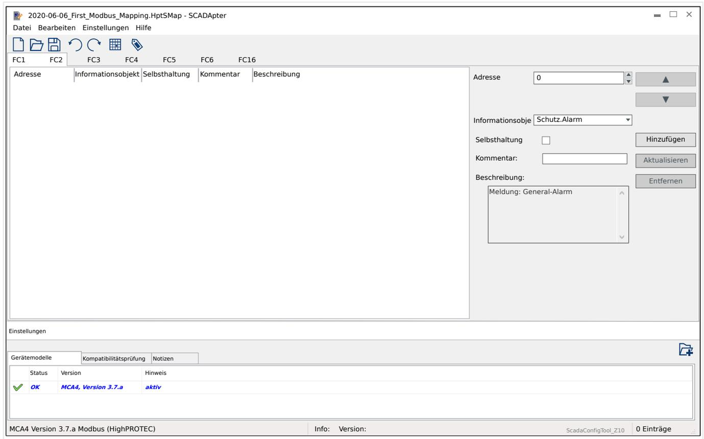
Wenn Modbus als SCADA-Protokoll ausgewählt wurde, erscheinen mehrere Reiter mit den Beschriftungen „FCx“. Jeder Reiter entspricht einem Modbus-Funktionscode und enthält eine Tabelle mit den Zuweisungen von Datenobjekten.
