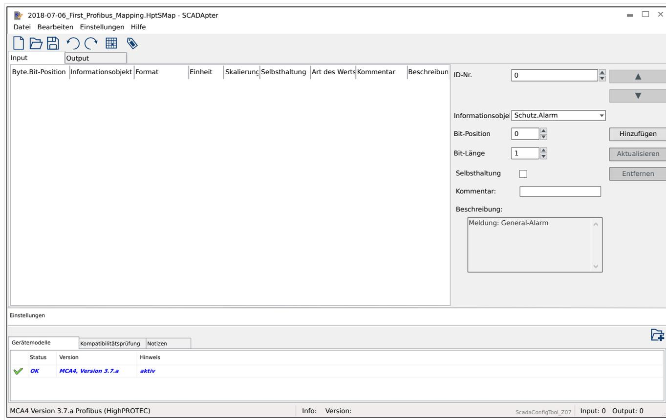
Das Bedienfeld mit Zuweisungen ist in zwei Reiter aufgeteilt, „Input“ und „Output“. Die Datenpunkte im Reiter „Output“ werden vom Master zum Slave übertragen (wobei in unserem Falle der Slave das Schutzgerät ist), und die Datenpunkte im Reiter „Input“ werden vom Slave zum Master übertragen.
