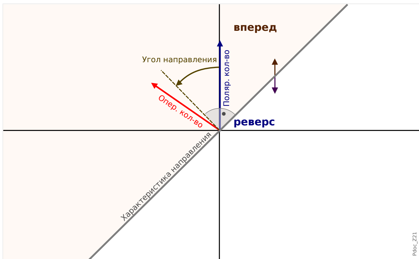
Рис. 62: Принцип определения направления межфазного короткого замыкания.
