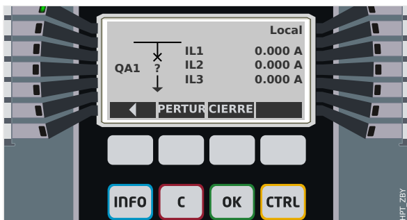
Fig. 128: Ejemplo de página de control, con el circuito en posición de fallo (o improbable).
