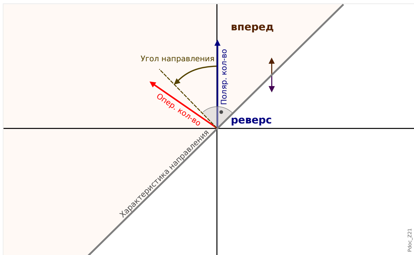
Рис. б1: Принцип определения направления межфазного короткого замыкания.
