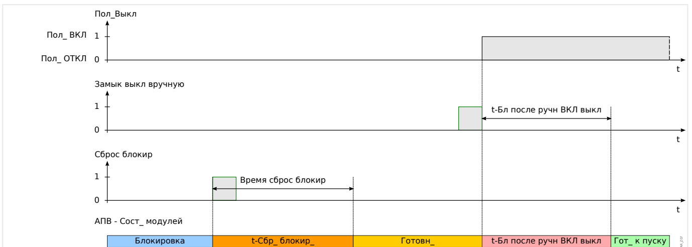
Рис. 115: Логика сброса блокировки АПВ при получении команды сброса блокировки перед замыканием выключателя вручную.
