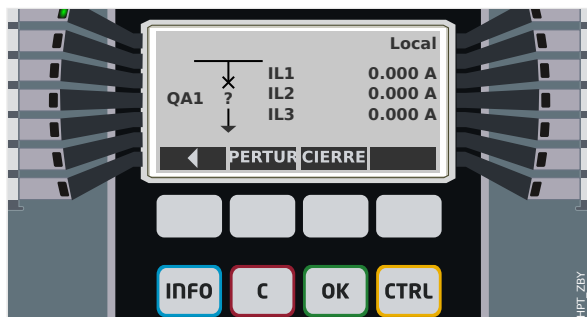
Fig. 120: Ejemplo de página de control, con el circuito en posición de fallo (o improbable).
