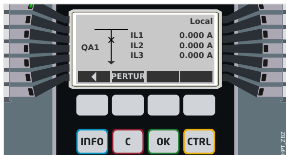
Fig. 119: Ejemplo de página de control, con el circuito en posición cerrada.
