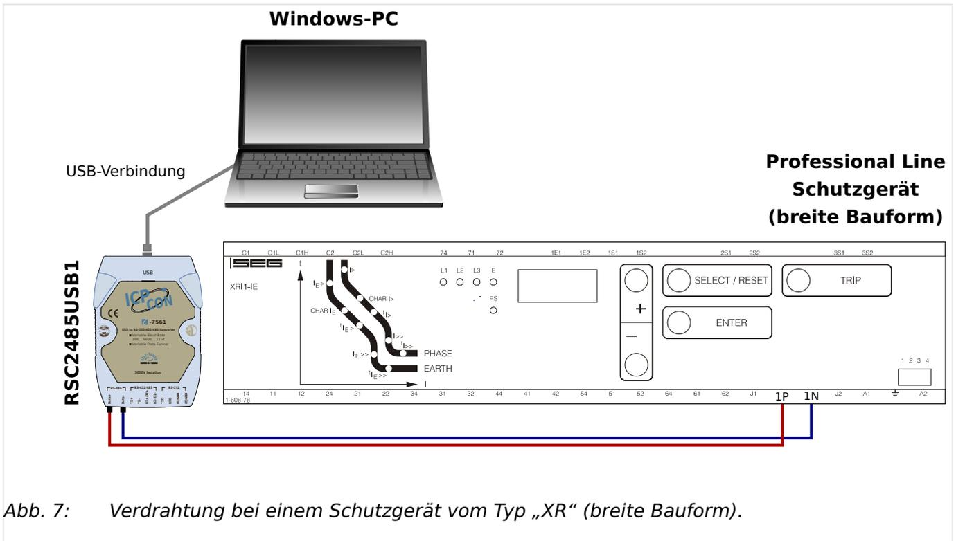
Abb. 7: Verdrahtung bei einem Schutzgerät vom Typ „XR“ (breite Bauform).
