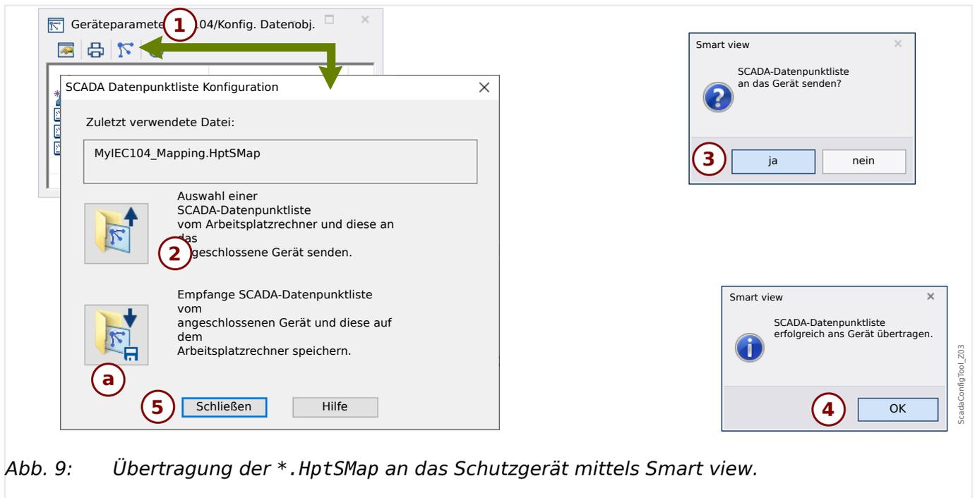
Abb. 9: Übertragung der \*.HptSMap an das Schutzgerät mittels Smart view.
