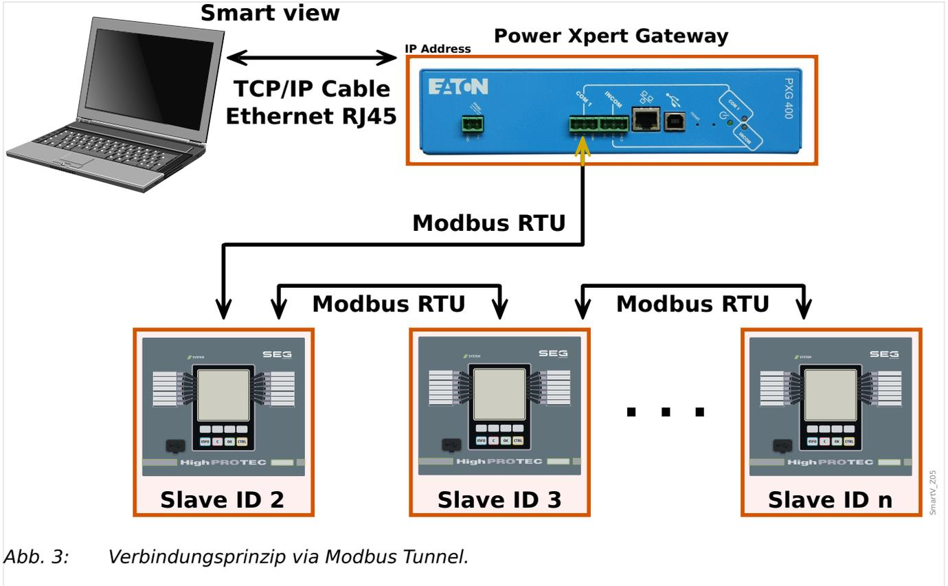
Abb. 3: Verbindungsprinzip via Modbus Tunnel.
