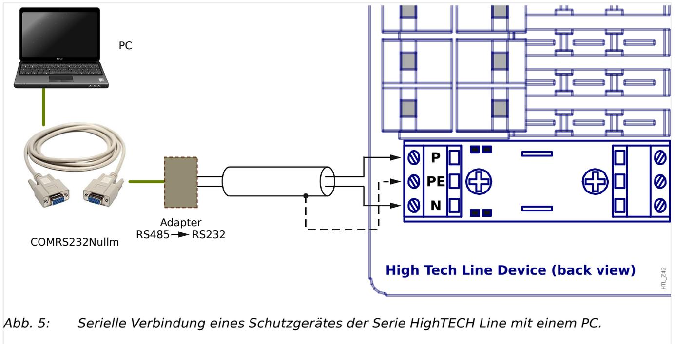
Abb. 5: Serielle Verbindung eines Schutzgerätes der Serie HighTECH Line mit einem PC.
