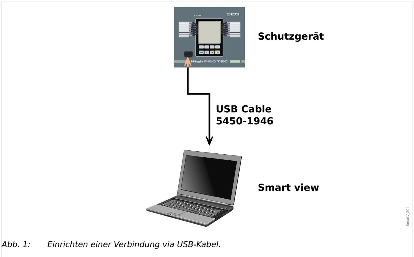
Abb. 1: Einrichten einer Verbindung via USB-Kabel.
