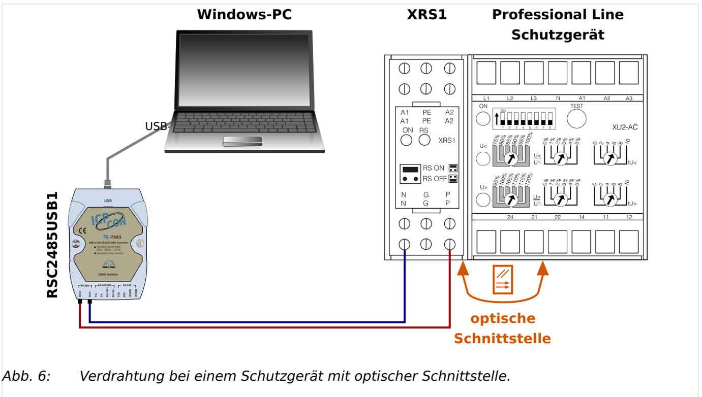
Abb. 6: Verdrahtung bei einem Schutzgerät mit optischer Schnittstelle.
