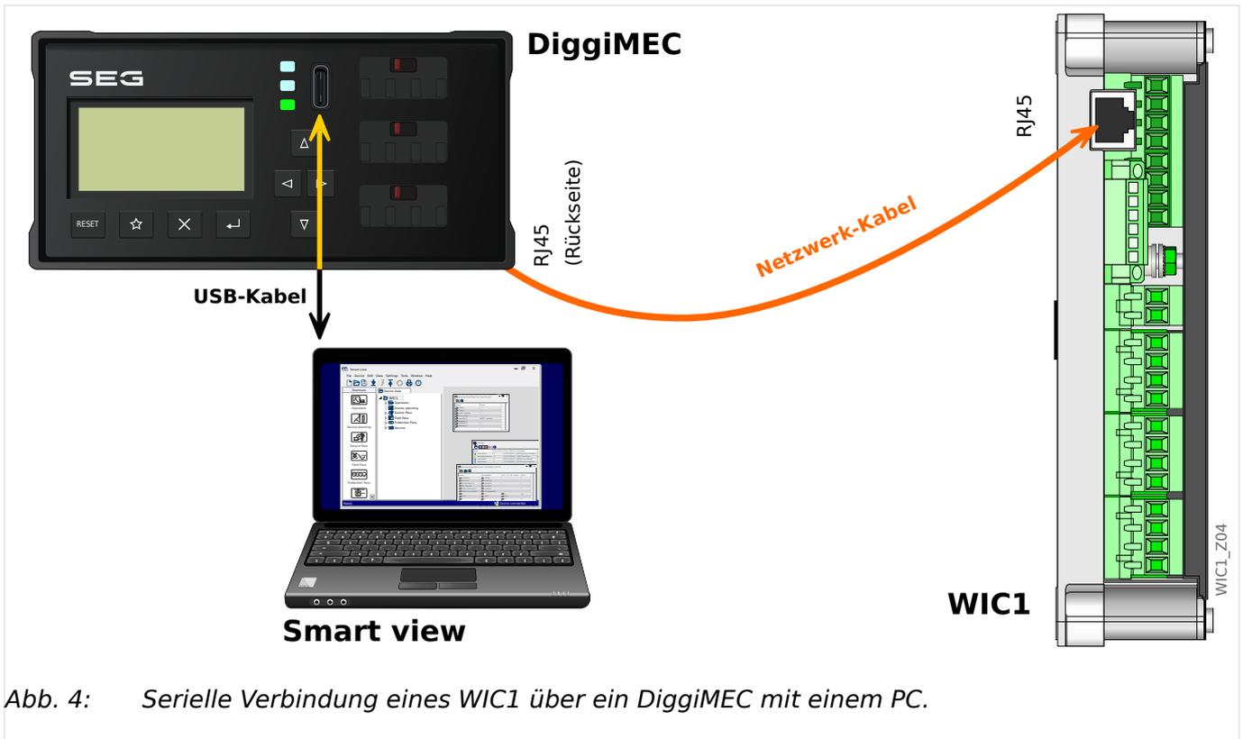
Abb. 4: Serielle Verbindung eines WIC1 über ein DiggiMEC mit einem PC.
