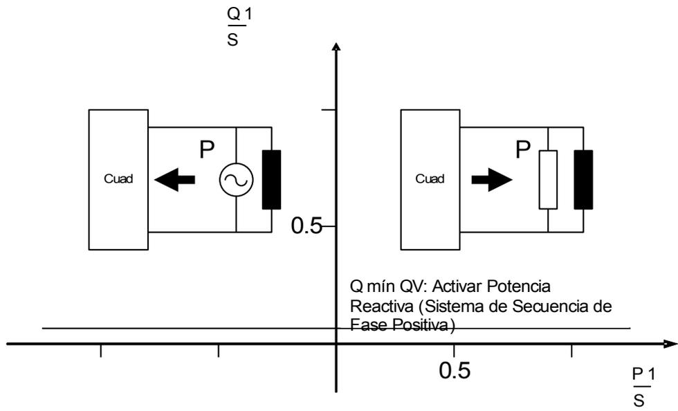
Una supervisión de la corriente mínima ( $I_1$ ) en el sistema de secuencia de fase positiva impide una hiperfunción de la supervisión de la potencia reactiva a niveles de potencia más bajos.
