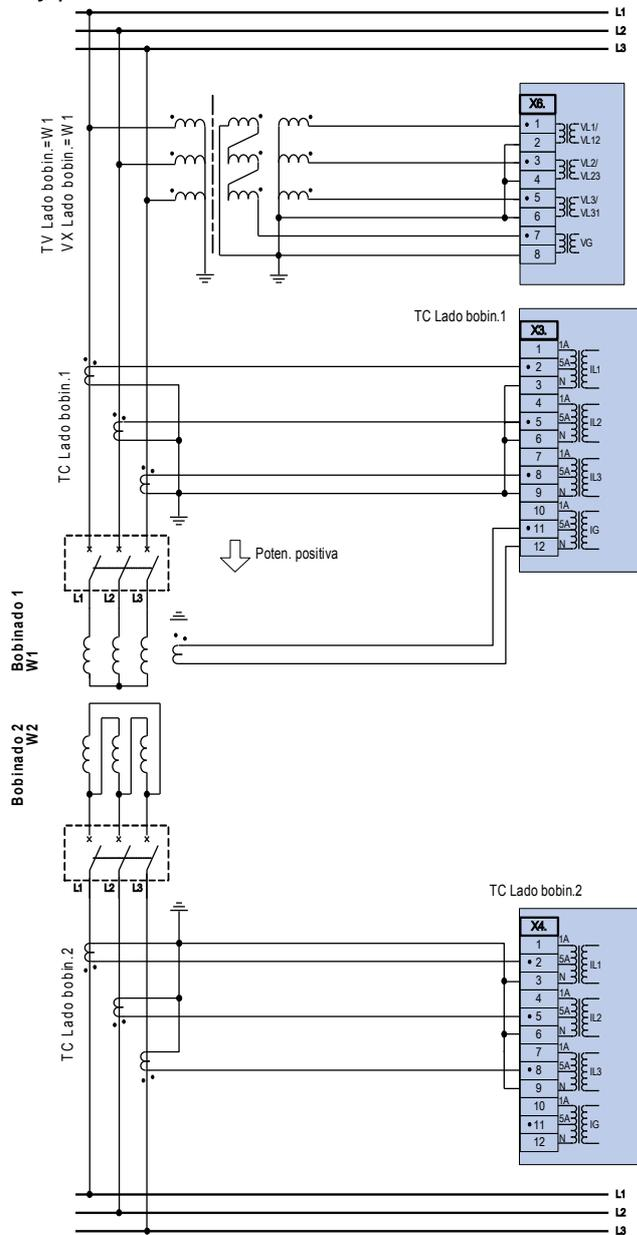
Transformador DY con protección diferencial de fase, REF en W1 y VT en W2 (Conexión V)
