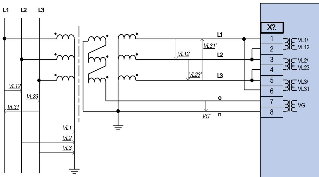
Medida de tensión trifásica (cableado de las entradas de medición: "conexión delta")
