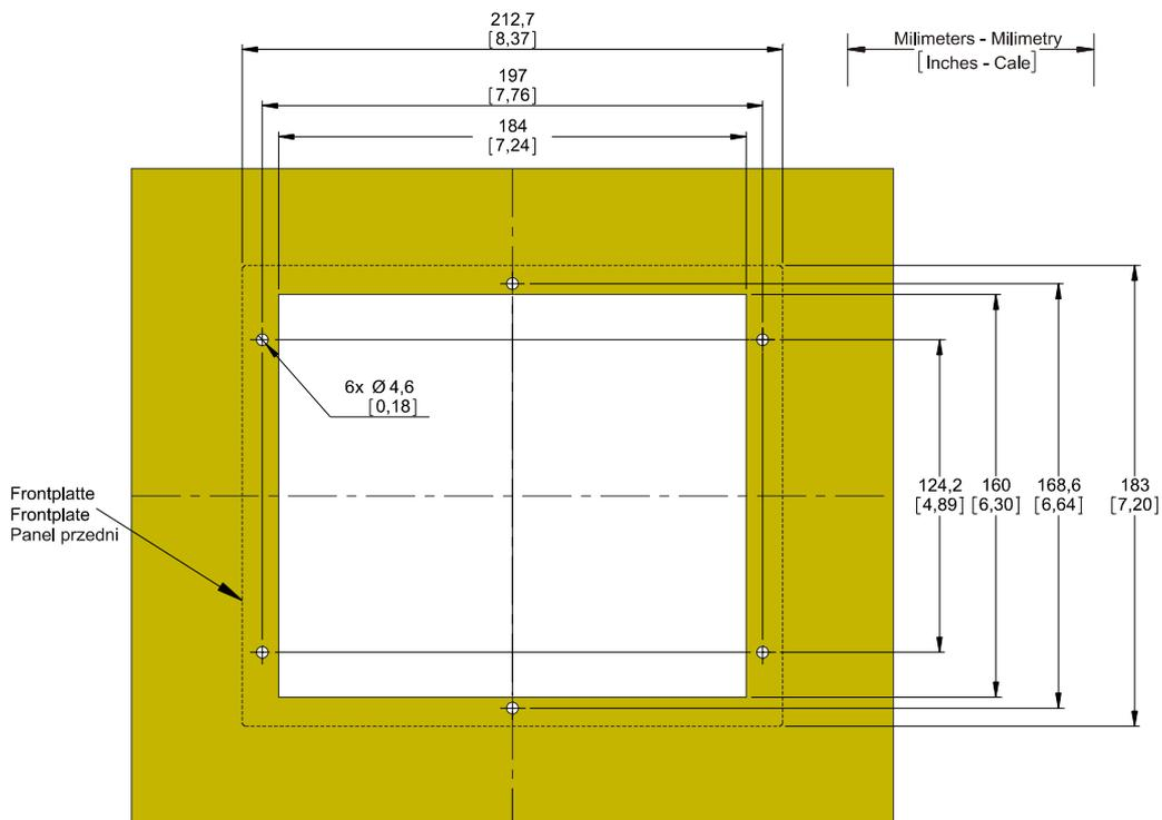
Corte de puerta de carcasa B2 (versión de 8 botones de comando) (Todas las medidas en mm, excepto medidas entre paréntesis [pulg.]).
