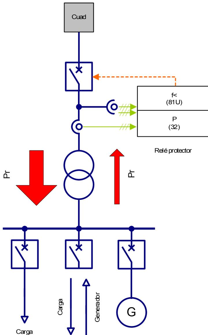
*Reducción de carga descentralizada por subfrecuencia en redes eléctricas con alimentación temporal*
