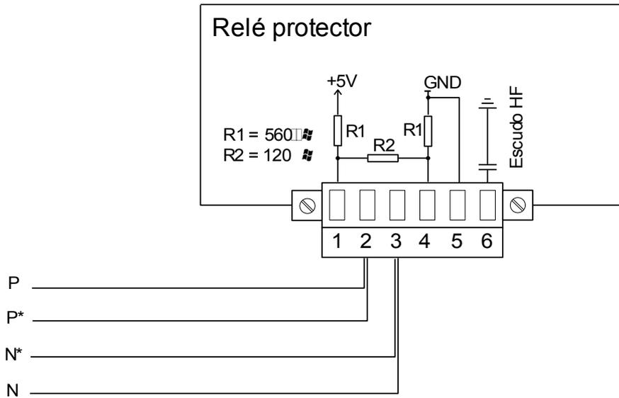
*Ejemplo de cableado de tipo 1, Dispositivo en el extremo del bus (usando puentes de cables para activar el terminal del resistor integrado)*
