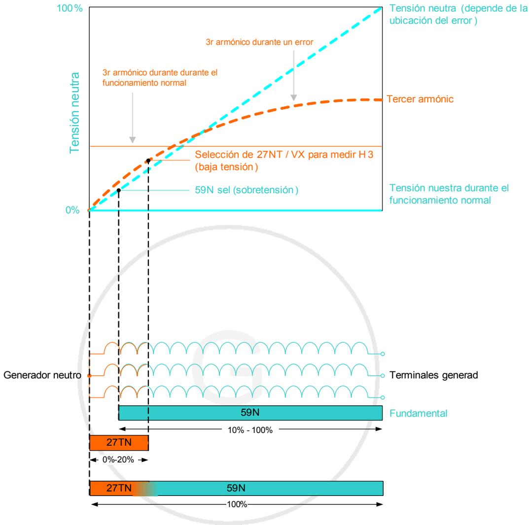
evita la desconexión errónea mientras el sistema está muerto / se para el generador
