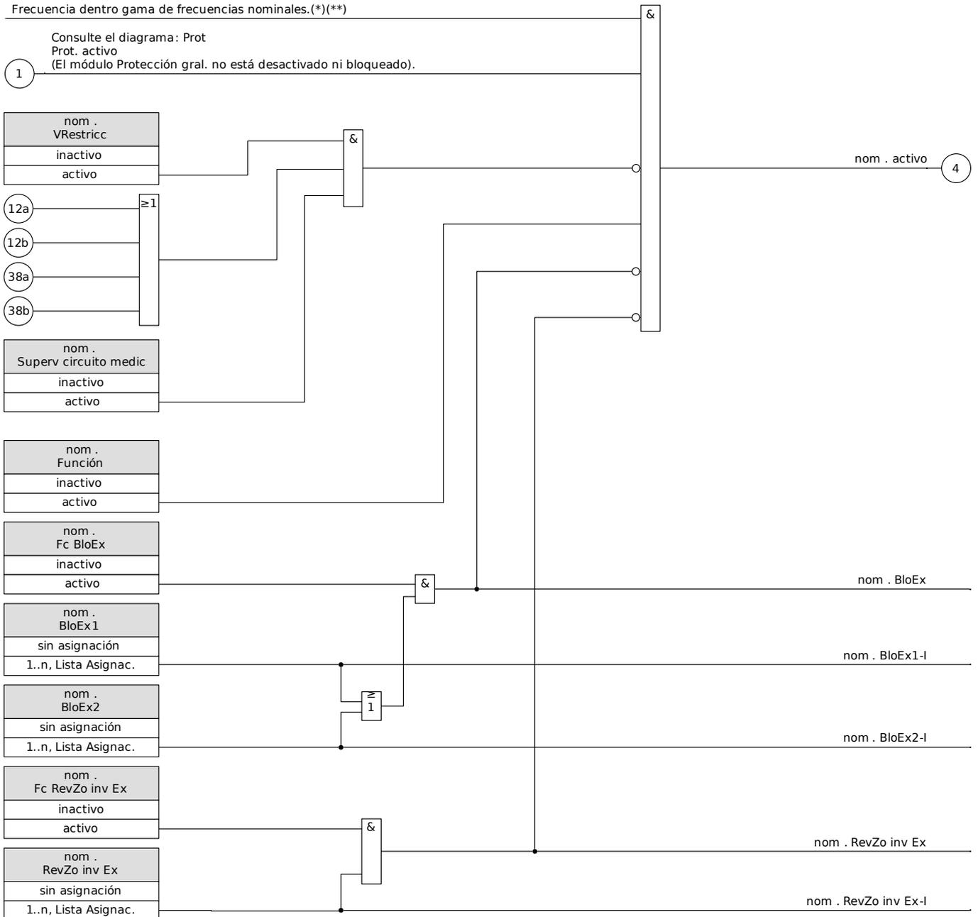
(\*) Se bloquearán todos los elementos protección que usen valores fundamentales o medidos en el armónico, si la frecuencia sale de la gama de frecuencia nominales. Los elementos de protección que usen valores RMS permanecerán activos.
