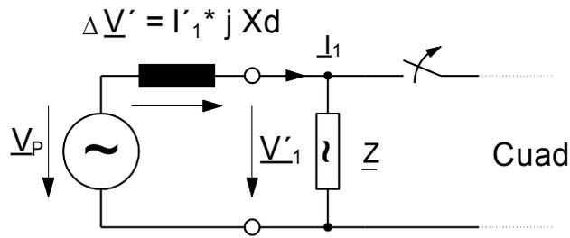
En caso de fallo de la red de suministro eléctrico o del reconector automático, el generador alimentará bruscamente un carga de consumo muy alta. El ángulo de desplazamiento del rotor disminuye repetidamente y el vector de tensión  $V_1$  modifica su dirección ( $V_1'$ ).
