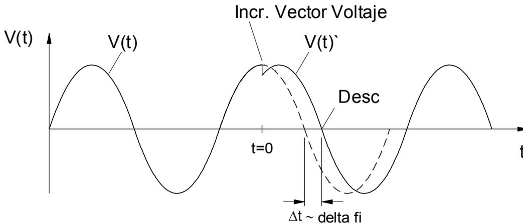
Tal como se muestra en el diagrama de tensión/tiempo, el valor instantáneo de tensión salta a otro valor en los cambios de posición de fase. Esto se denomina incremento vectorial o de fase.
