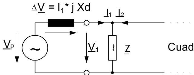
Vectores de tensión en funcionamiento en paralelo con la red de suministro eléctrico.
