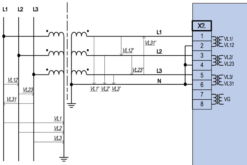
Medida de voltaje trifásico: cableado de las entradas de medida: "conex. estrella"
