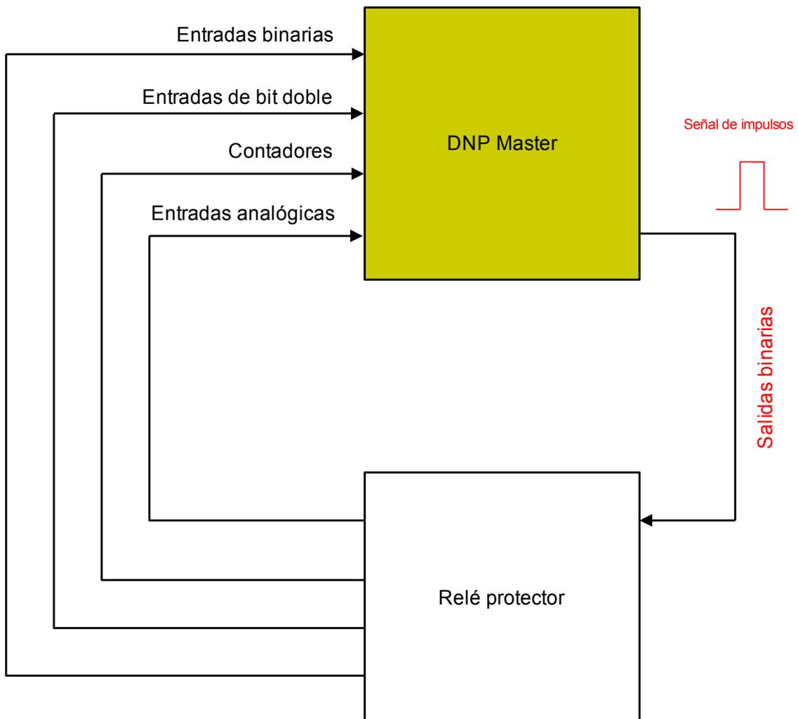
Procure dejar entradas o salidas sin asignar, ya que disminuirá el rendimiento de la comunicación DNP. Es decir, no deje entradas o salidas sin usar entre entradas o salidas utilizadas (por ejemplo, no use las salidas 1 y 3 cuando la 2 esté sin usar).
