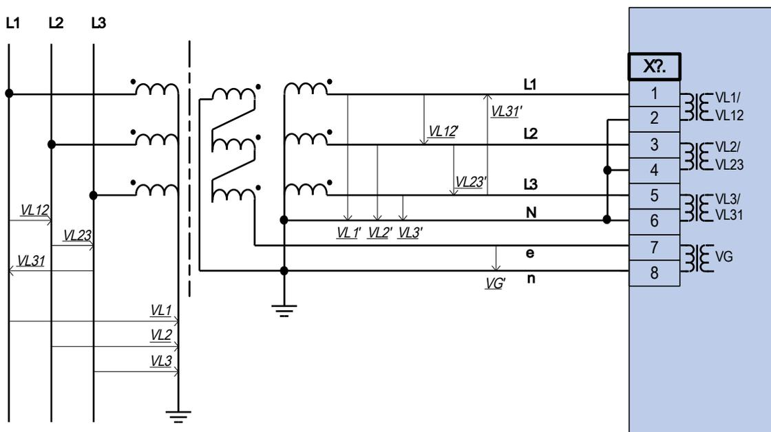
Medida de voltaje trifásico: cableado de las entradas de medida: "conex. estrella"
