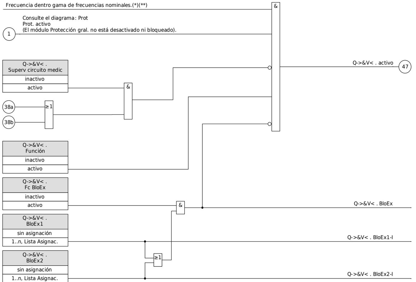
(\*) Se bloquearán todos los elementos protección que usen valores fundamentales o medidos en el armónico, si la frecuencia sale de la gama de frecuencia nominales. Los elementos de protección que usen valores RMS permanecerán activos.
