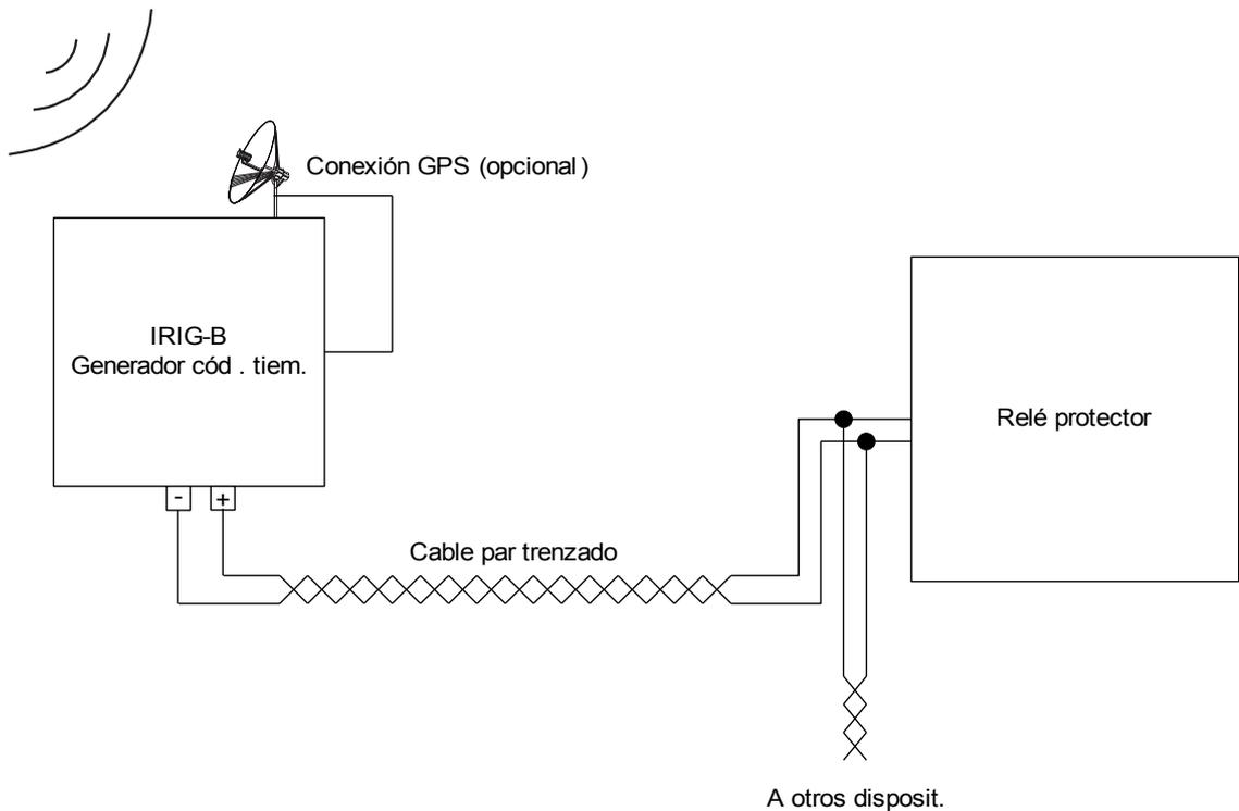
La ubicación de la interfaz IRIG-B depende del tipo de dispositivo. Consulte el diagrama de cableado suministrado con el dispositivo de protección.
