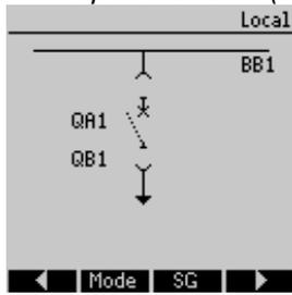
La unidad de un interruptor automático extraíble tiene que ser manejado como un conmutador individual. No existe ninguna conexión fija entre el interruptor y la unidad. Es necesario que el usuario establezca un interbloqueo porque no se permite retirar el interruptor mientras esté en la posición cerrada. El interruptor se puede cambiar en la posición de extracción y en la posición de no extracción.
