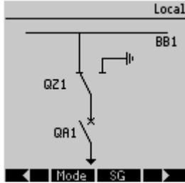
Este conmutador es una combinación de un desconector y un interruptor de tierra. Este interruptor cambia entre la »Posición ON« (p. ej., una barra colectora) y la »Posición-Tierra«.
