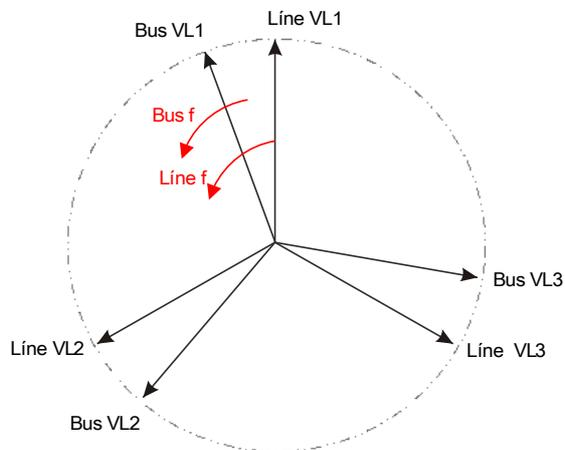
Si la frecuencia del generador  $f_{\text{Bus}}$  no es igual a la frecuencia de la red  $f_{\text{Line}}$ , provoca una frecuencia de deslizamiento  $\Delta F = |f_{\text{Bus}} - f_{\text{Line}}|$  entre las dos frecuencias del sistema.
