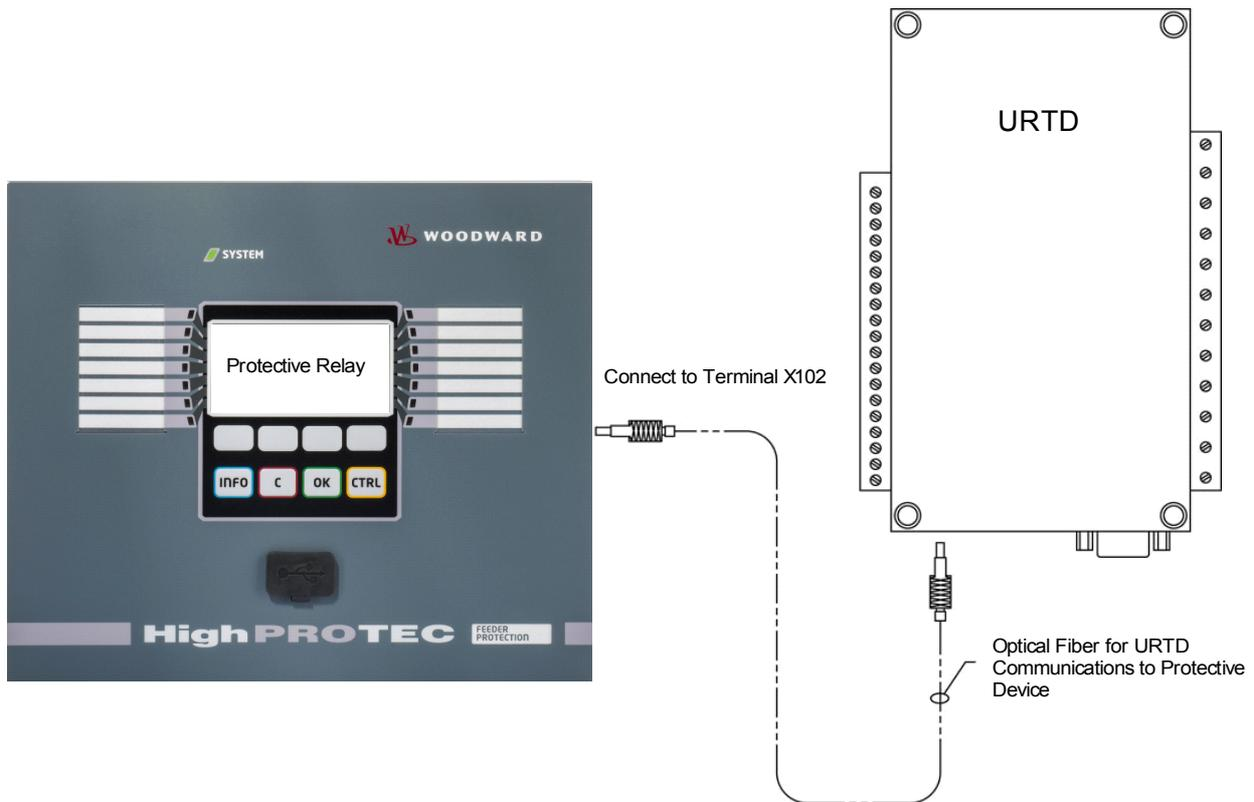
La figura anterior muestra las conexiones de fibra óptica entre el módulo URTDII y el dispositivo de protección. El dispositivo de protección es compatible con la conexión de fibra óptica.
