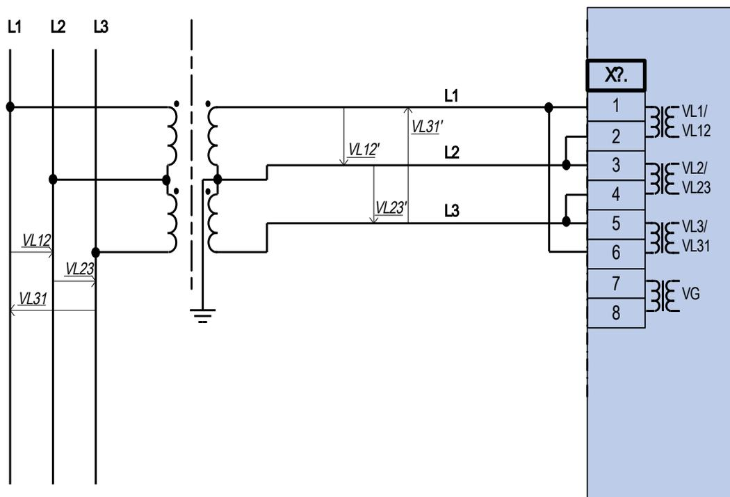
Medida voltaje bifásico: cableado de las entradas de medida: "Abr. Delta"
