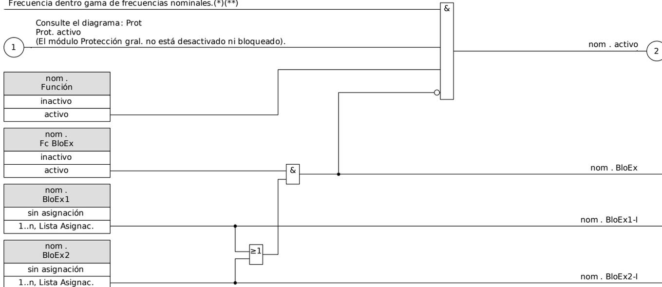
(\*) Se bloquearán todos los elementos protección que usen valores fundamentales o medidos en el armónico, si la frecuencia sale de la gama de frecuencia nominales. Los elementos de protección que usen valores RMS permanecerán activos.
