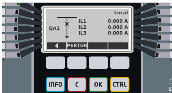
Fig. 122: Ejemplo de página de control, con el circuito en posición cerrada.
