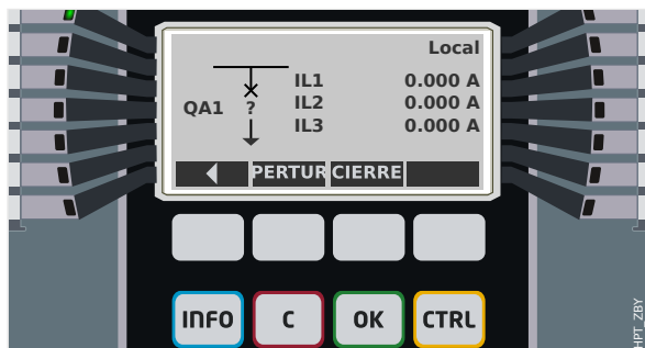
Fig. 123: Ejemplo de página de control, con el circuito en posición de fallo (o improbable).
