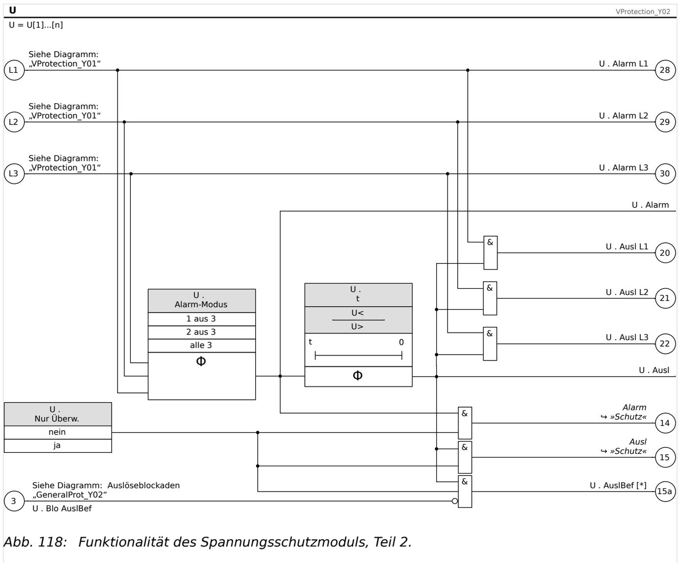
Abb. 118: Funktionalität des Spannungsschutzmoduls, Teil 2.
