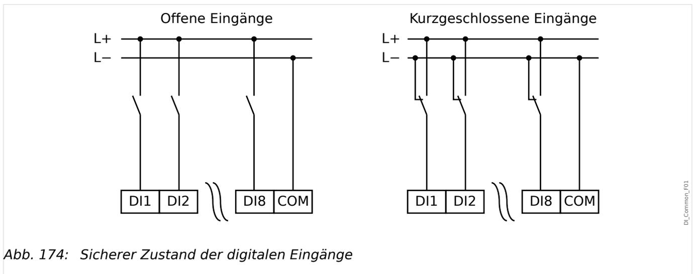
Abb. 174: Sicherer Zustand der digitalen Eingänge
