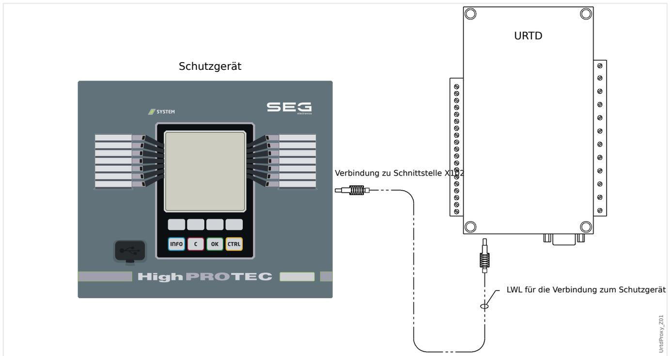
Vorkonfektionierte Kunststofflichtwellenleiter können von entsprechenden Lieferanten von Lichtwellenleiterprodukten bezogen werden. Meistens sind Lichtwellenleiter auch als Meterware erhältlich, mit Steckern, die vor Ort montiert werden können.
