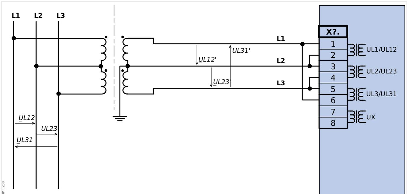
Abb. 38: Zwei Spannungswandler mit Geräteanschluss in V-Schaltung
