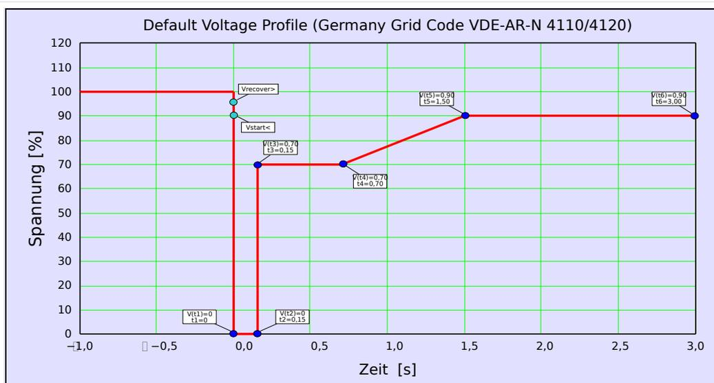
Abb. 143: LVRT-Werkseinstellung (Typ I).
