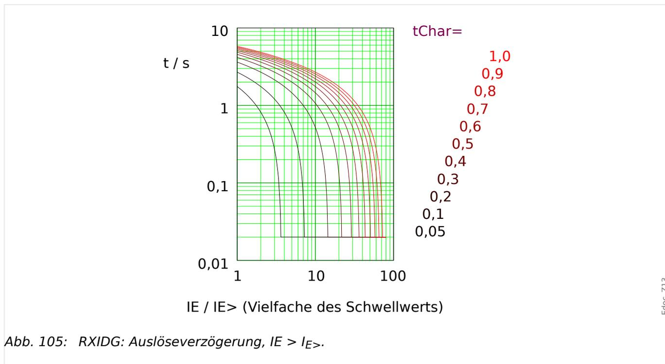
Abb. 105: RXIDG: Auslöseverzögerung,  $IE > I_{E>}$ .
