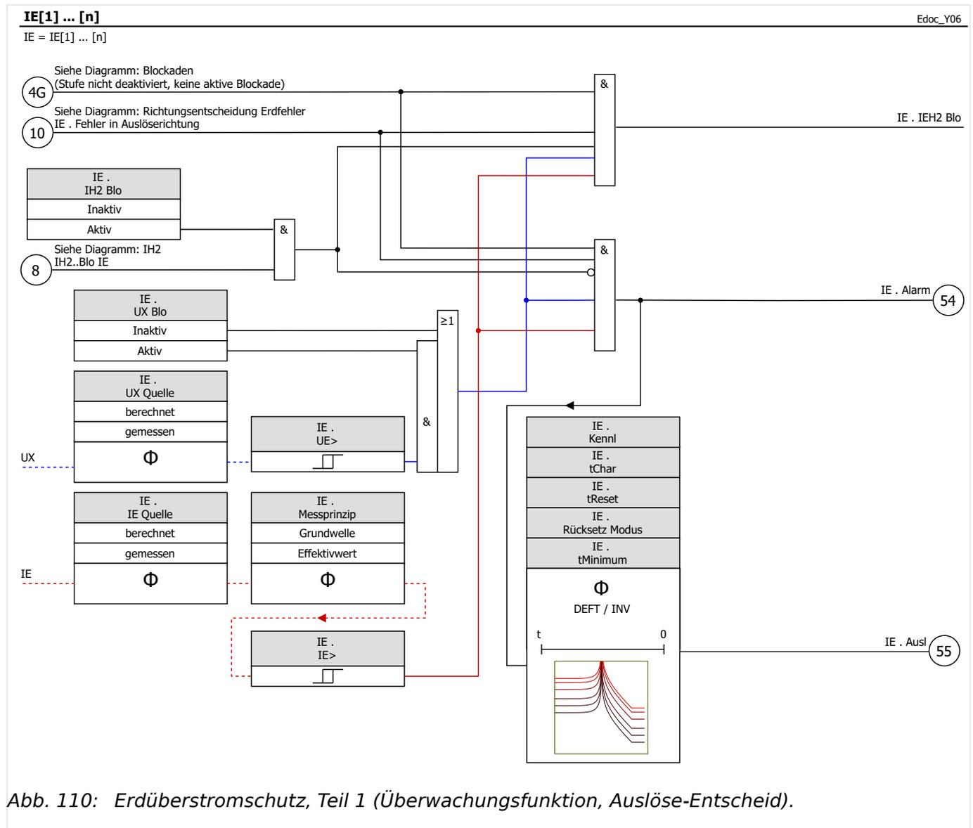
Abb. 110: Erdüberstromschutz, Teil 1 (Überwachungsfunktion, Auslöse-Entscheidung).
