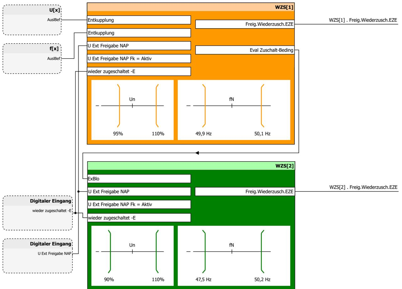
Abb. 135: Applikationsbeispiel für ein (Wieder-)Zuschalten in Abhängigkeit von einer vorherigen Auslösung des Entkupplungsschutzes.
