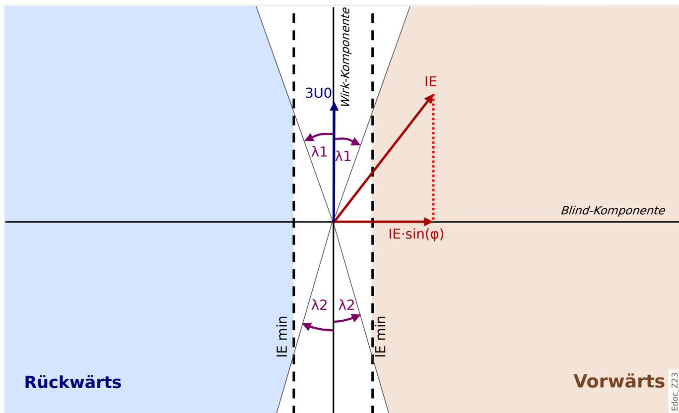
Abb. 71: Richtungserkennung nach der Methode „ $\sin(\phi)$ “.
