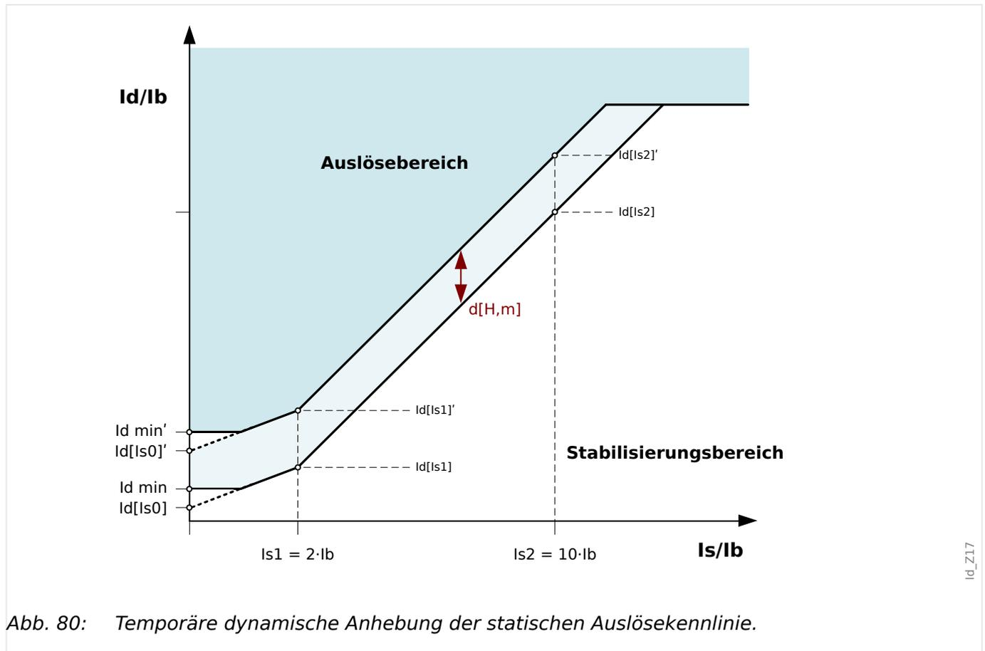
Abb. 80: Temporäre dynamische Anhebung der statischen Auslösekennlinie.
