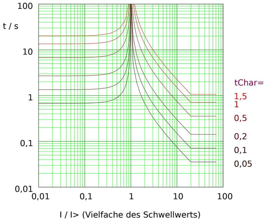
Abb. 86: VINV: Rückfallverzögerung (linke Hälfte,  $I < I_{>}$ ) und Auslöseverzögerung (rechte Hälfte,  $I > I_{>}$ ), Beispieldiagramm für  $I_{max} = 20 \cdot I_{>}$ .
