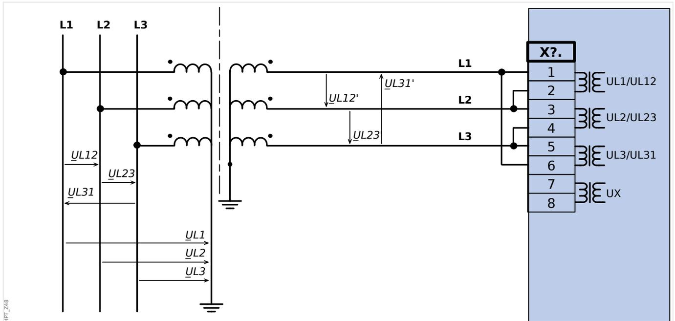
Abb. 36: Drei Spannungswandler mit Geräteanschluss in Dreieckschaltung
