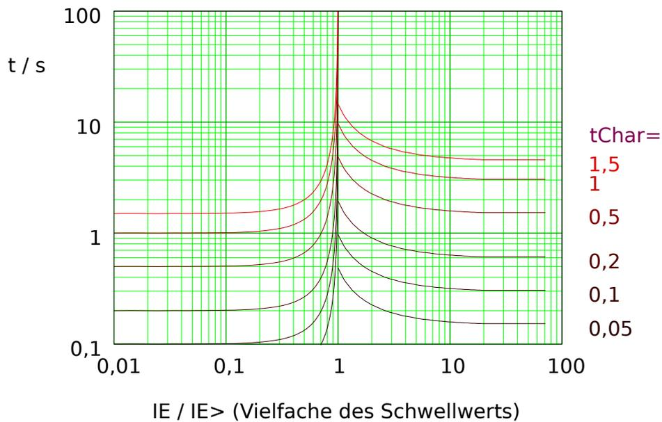
Abb. 101: RINV: Rückfallverzögerung (linke Hälfte,  $IE < IE>$ ) und Auslöseverzögerung (rechte Hälfte,  $IE > IE>$ ), Beispieldiagramm für  $I_{max} = 20 \cdot IE>$ .
