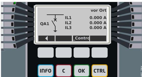
Abb. 155: Beispiel einer Steuer-Seite mit geöffnetem „Leistungsschalter“.
