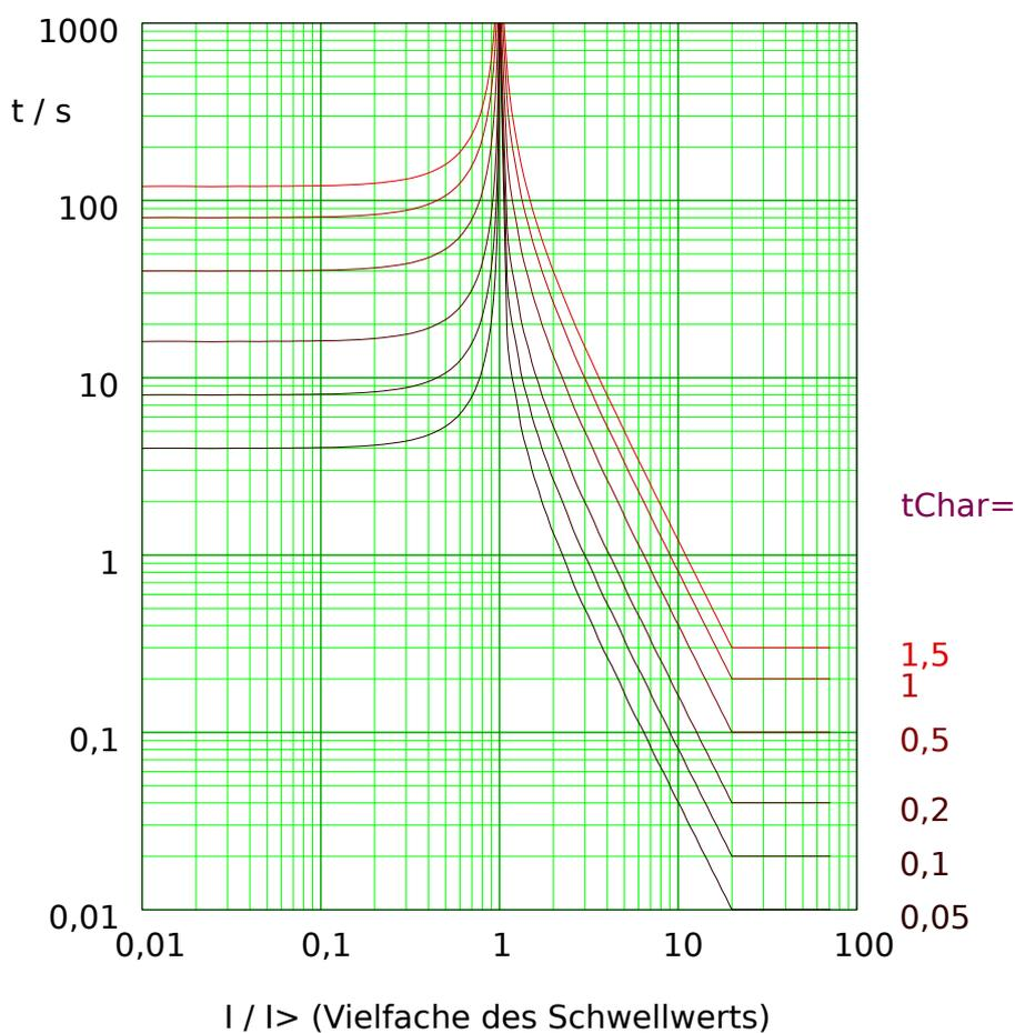
Abb. 87: EINV: Rückfallverzögerung (linke Hälfte,  $I < I_{>}$ ) und Auslöseverzögerung (rechte Hälfte,  $I > I_{>}$ ), Beispieldiagramm für  $I_{max} = 20 \cdot I_{>}$ .
