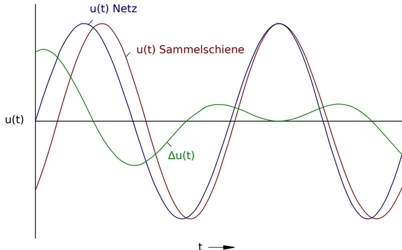
Abb. 128: Spannungsverlauf der Schwebespannung  $\Delta u(t)$ , vergrößert.
