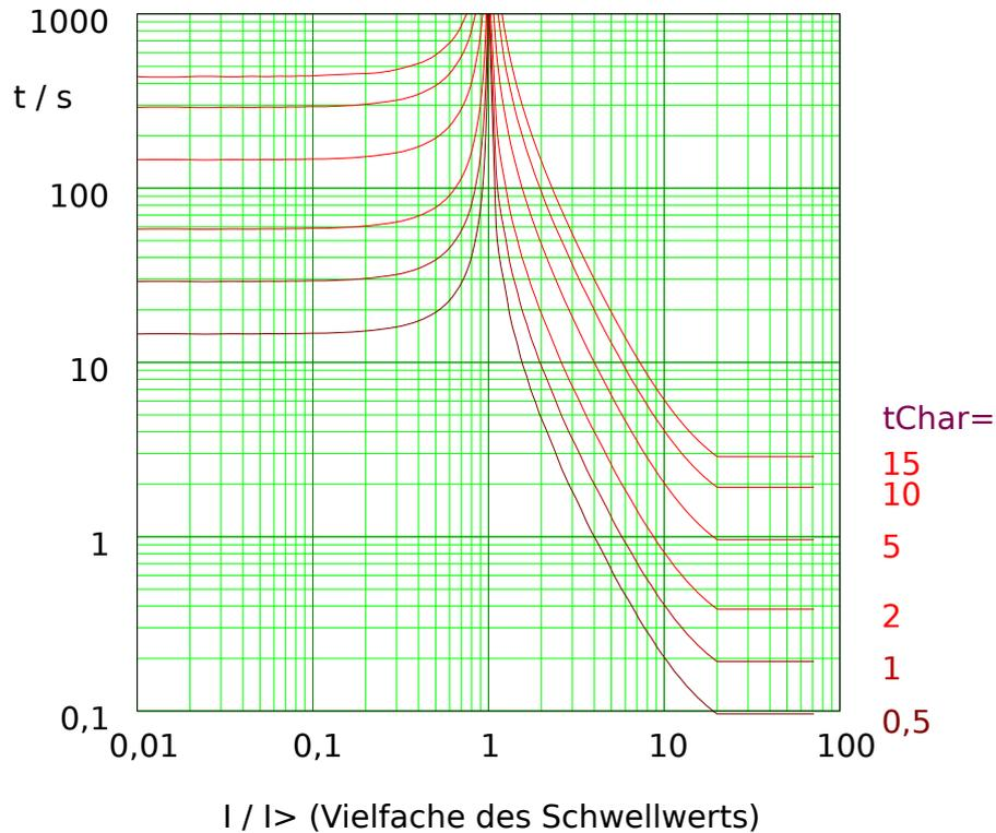
Abb. 92: EINV: Rückfallverzögerung (linke Hälfte,  $I < I_{>}$ ) und Auslöseverzögerung (rechte Hälfte,  $I > I_{>}$ ), Beispieldiagramm für  $I_{max} = 20 \cdot I_{>}$ .
