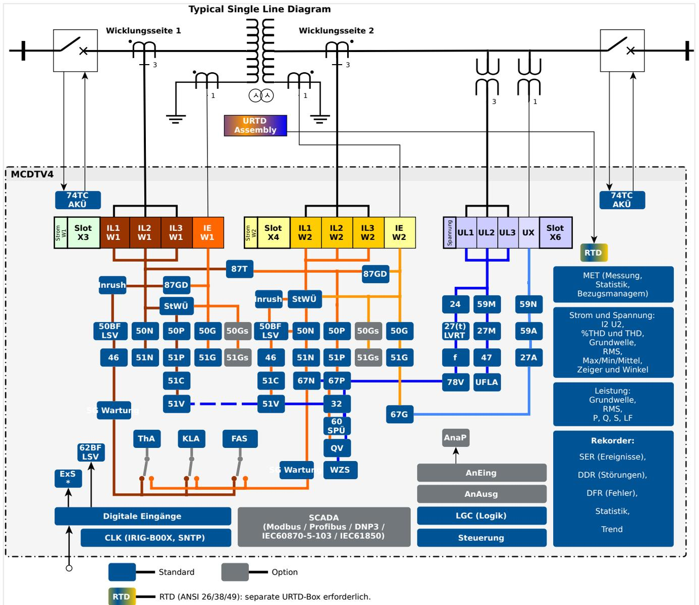
Abb. 1: Funktionsübersicht für das MCDTV4.
