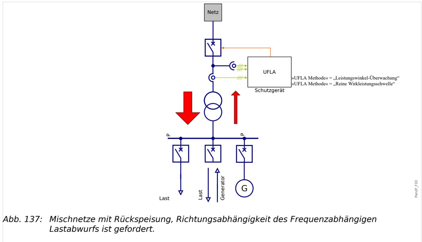
Abb. 137: Mischnetze mit Rückspeisung, Richtungsabhängigkeit des Frequenzabhängigen Lastabwurfs ist gefordert.
