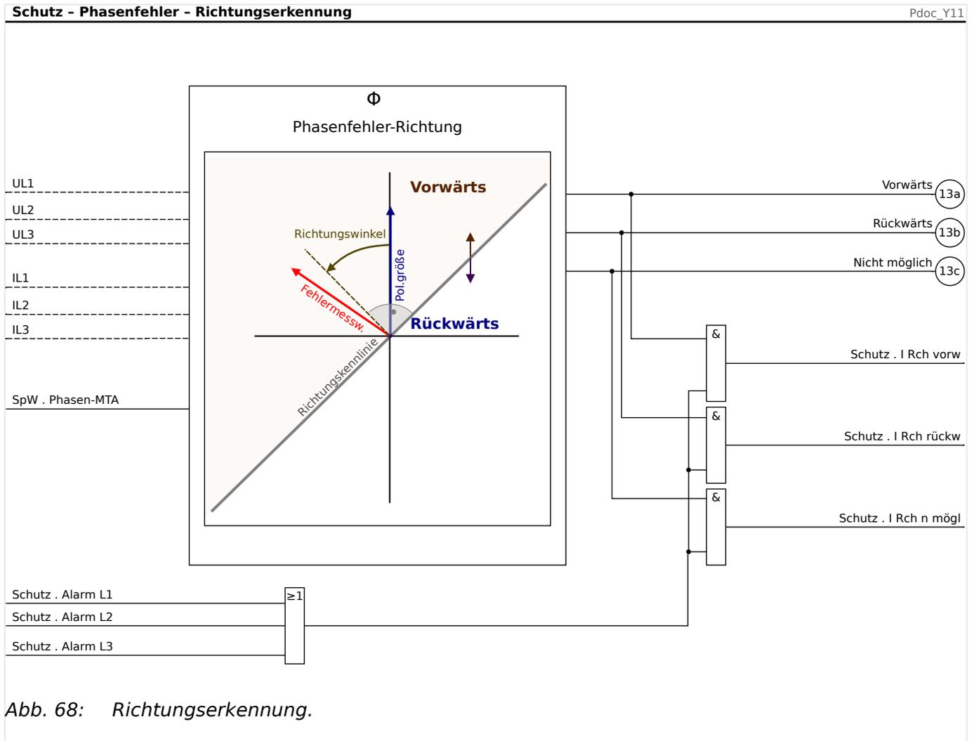
Das MCDTV4 ermittelt den Winkel zwischen dem Phasenstrom mit der größten Stromstärke (*Fehlermesswert*) und der Leiter-Leiter-Spannung der anderen Phasen (*Polarisationsgröße*). Im Falle eines dreiphasigen Fehlers, bei dem die Leiter-Leiter-Spannung zu klein für eine Richtungserkennung ist, wird ein Spannungsspeicher verwendet.
