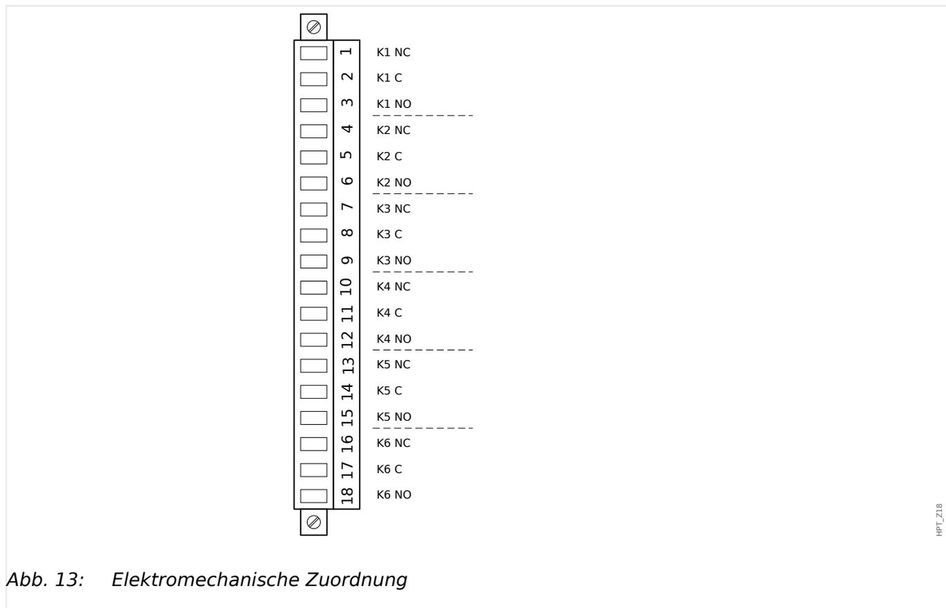
Abb. 13: Elektromechanische Zuordnung
