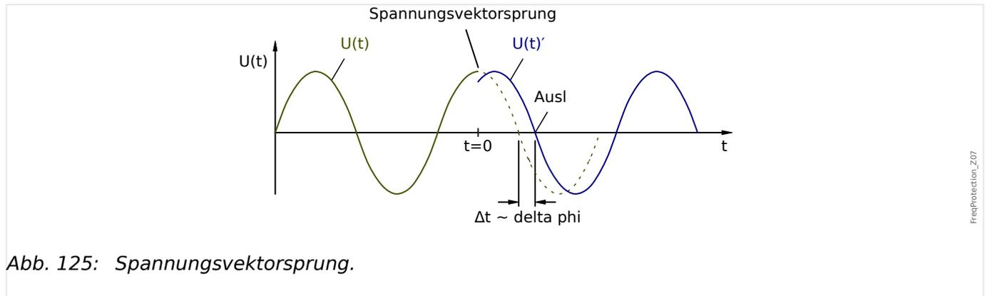
Abb. 125: Spannungsvektorsprung.
