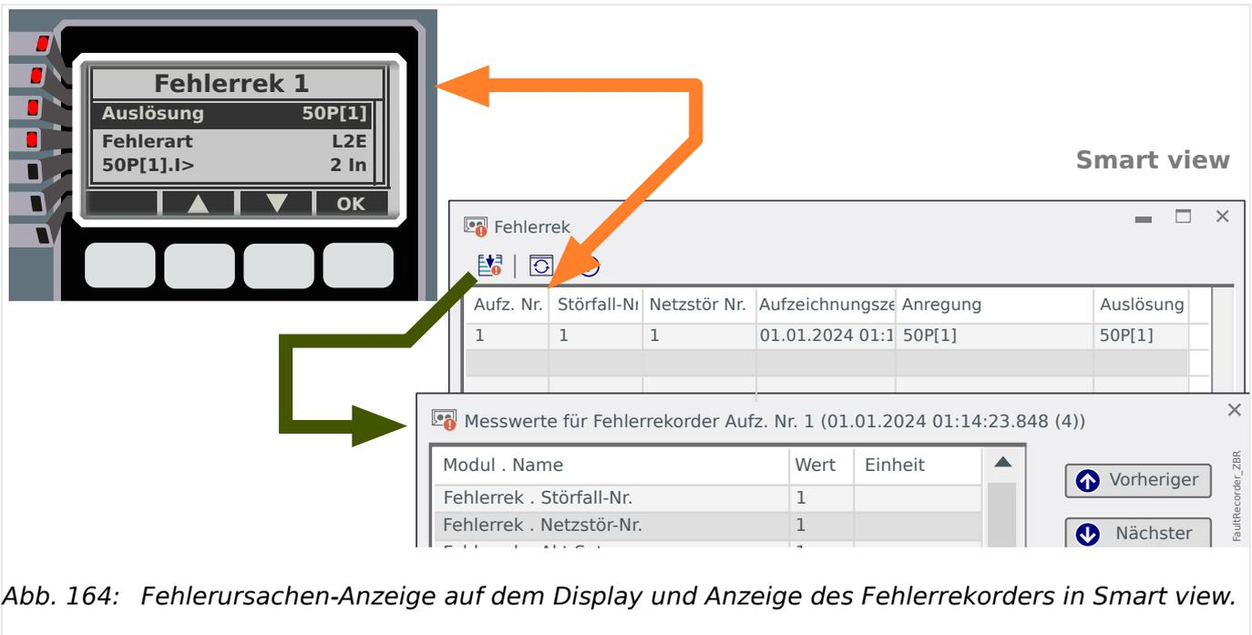
Abb. 164: Fehlerursachen-Anzeige auf dem Display und Anzeige des Fehlerrekorders in Smart view.
