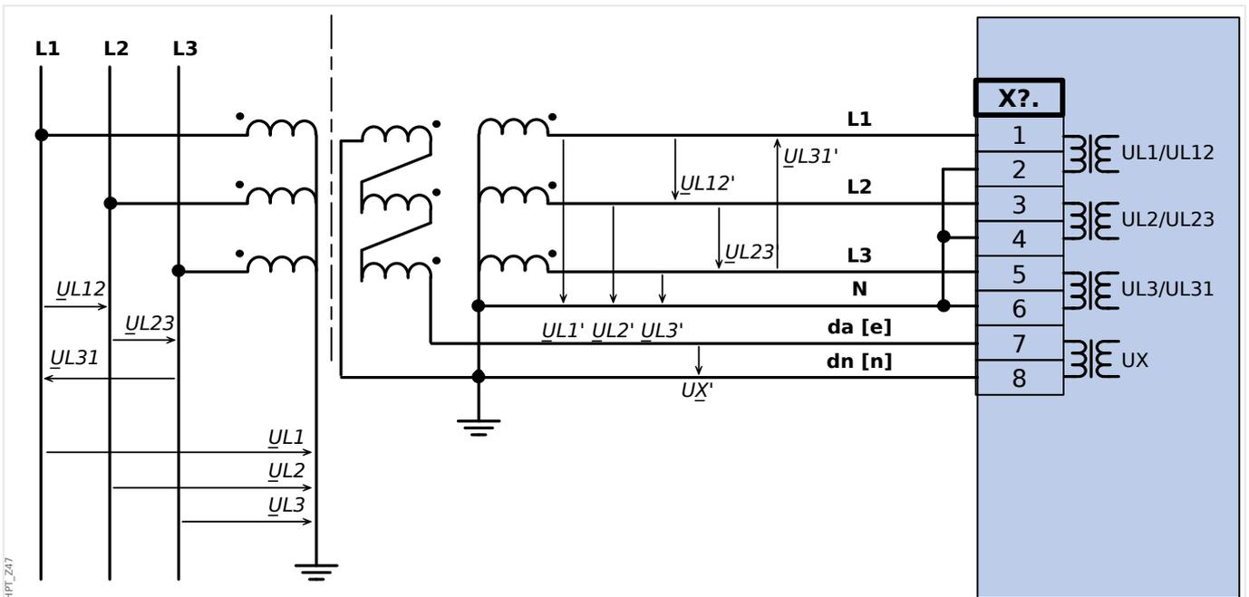
Abb. 35: Spannungswandler mit Geräteanschluss in offener Dreieckschaltung.
