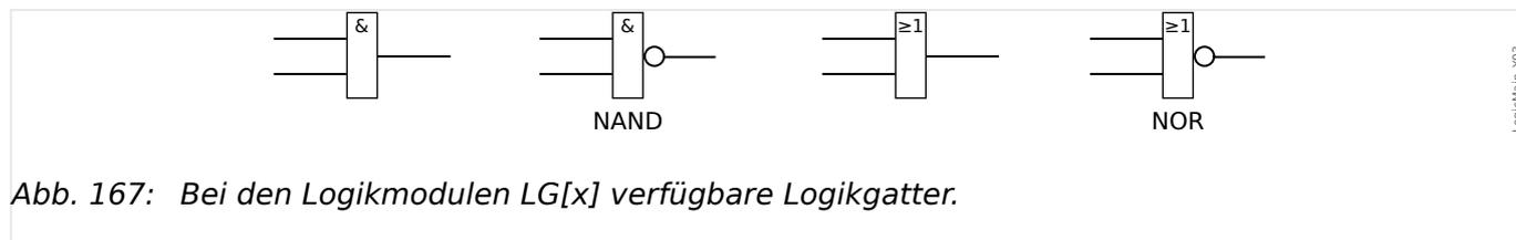
Abb. 167: Bei den Logikmodulen LG[x] verfügbare Logikgatter.
