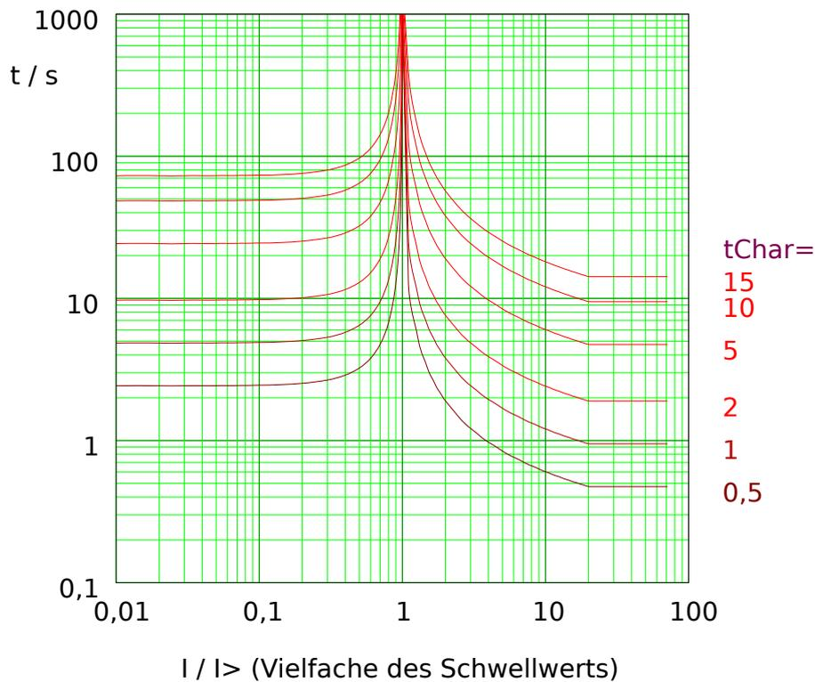
Abb. 90: MINV: Rückfallverzögerung (linke Hälfte,  $I < I_{>}$ ) und Auslöseverzögerung (rechte Hälfte,  $I > I_{>}$ ), Beispieldiagramm für  $I_{max} = 20 \cdot I_{>}$ .
