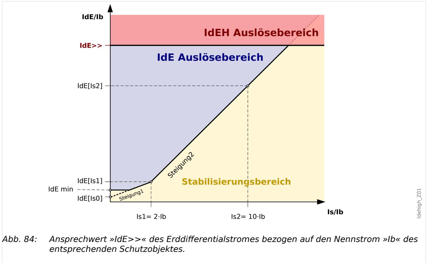
Abb. 84: Ansprechwert »IdE>>« des Erddifferentialstromes bezogen auf den Nennstrom »Ib« des entsprechenden Schutzobjektes.
