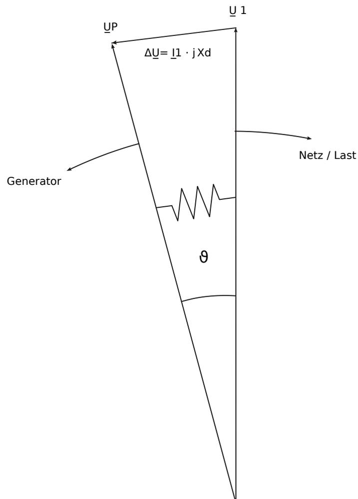
Abb. 122: Polradwinkel bei konstanter Belastung des Generators.
