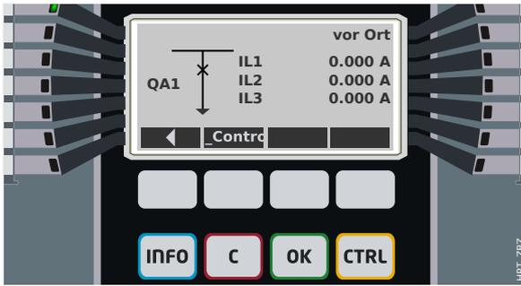
Abb. 153: Beispiel einer Steuer-Seite mit geschlossenem „Leistungsschalter“.
