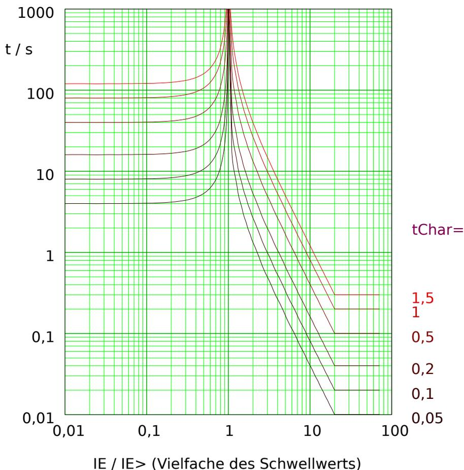
Abb. 99: EINV: Rückfallverzögerung (linke Hälfte,  $IE < I_{E>}$ ) und Auslöseverzögerung (rechte Hälfte,  $IE > I_{E>}$ ), Beispieldiagramm für  $I_{max} = 20 \cdot I_{E>}$ .
