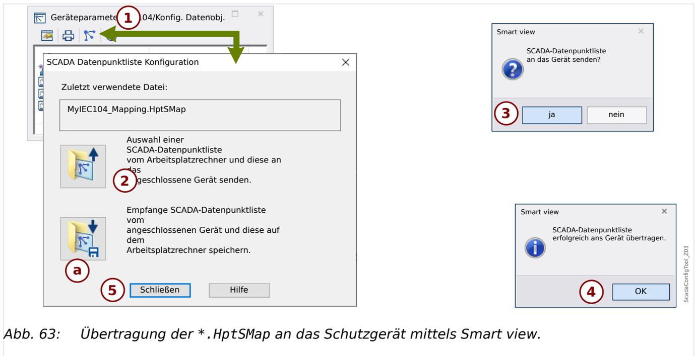
Abb. 63: Übertragung der \*.HptSMap an das Schutzgerät mittels Smart view.
