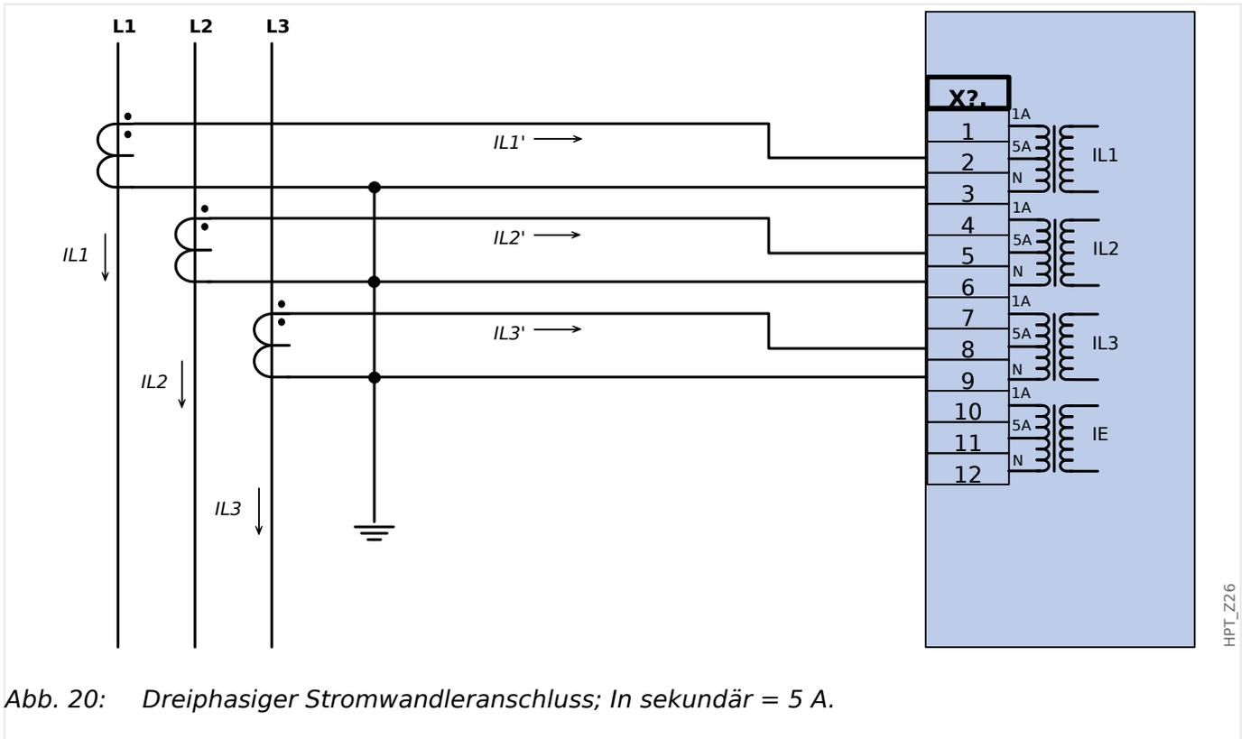
Abb. 20: Dreiphasiger Stromwandleranschluss; In sekundär = 5 A.
