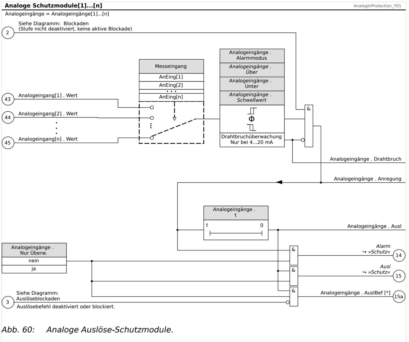
Abb. 60: Analoge Auslöse-Schutzmodule.
