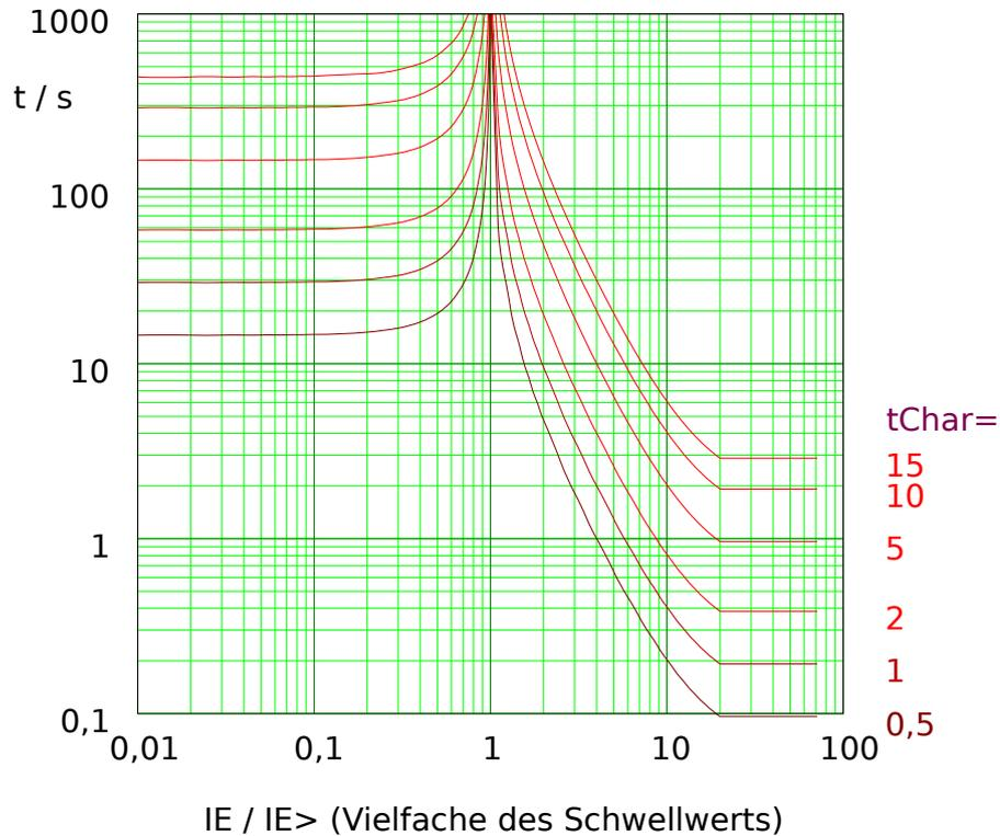
Abb. 104: EINV: Rückfallverzögerung (linke Hälfte,  $IE < I_{E>}$ ) und Auslöseverzögerung (rechte Hälfte,  $IE > I_{E>}$ ), Beispieldiagramm für  $I_{max} = 20 \cdot I_{E>}$ .
