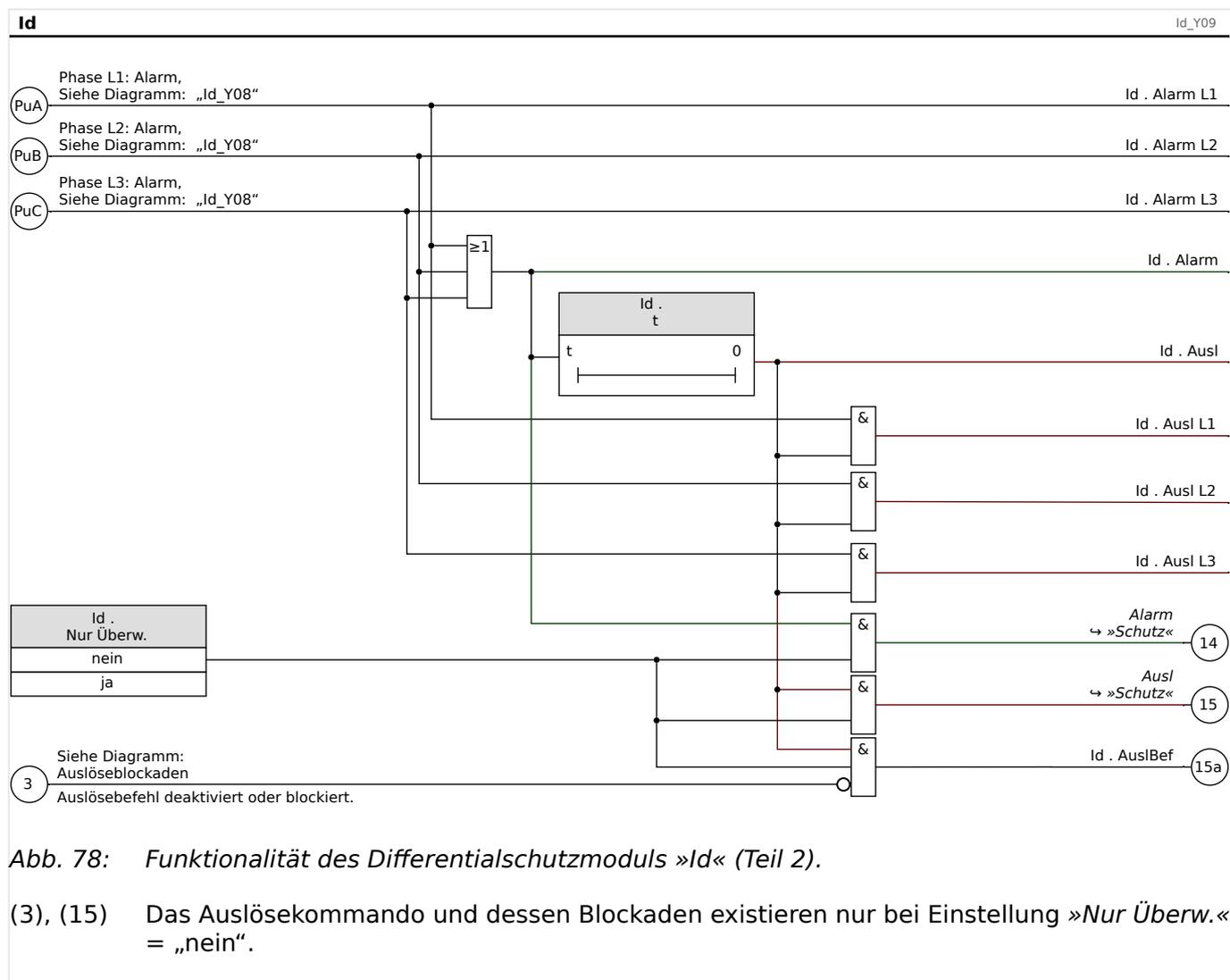
Abb. 78: Funktionalität des Differentialschutzmoduls »Id« (Teil 2).
