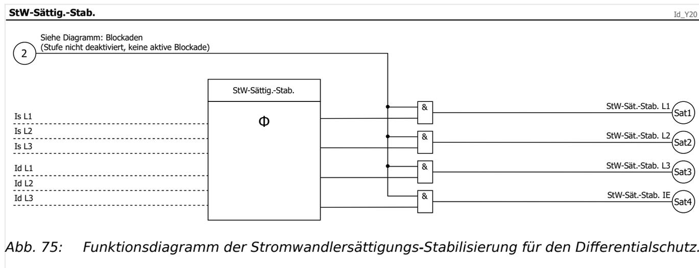
Die Stabilisierung wird gestartet sobald ein externer Fehler erkannt wird, was kontinuierlich überprüft wird. Der Differentialschutz ist robust gegen Wandlersättigung, solange der externe Fehler andauert und somit auch die Stabilisierung. Wird hingegen ein interner Fehler erkannt, wird die Stabilisierung gestoppt.
