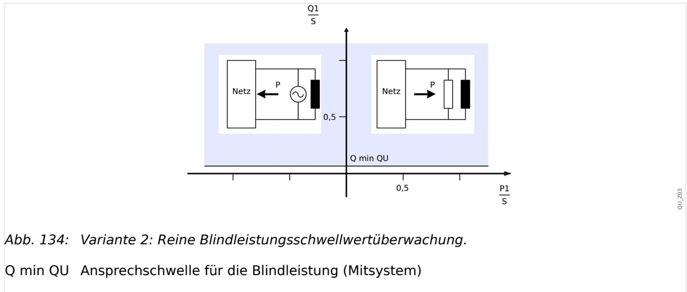
Abb. 134: Variante 2: Reine Blindleistungsschwellwertüberwachung.
