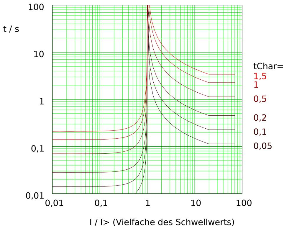
Abb. 85: NINV: Rückfallverzögerung (linke Hälfte,  $I < I_{>}$ ) und Auslöseverzögerung (rechte Hälfte,  $I > I_{>}$ ), Beispieldiagramm für  $I_{max} = 20 \cdot I_{>}$ .
