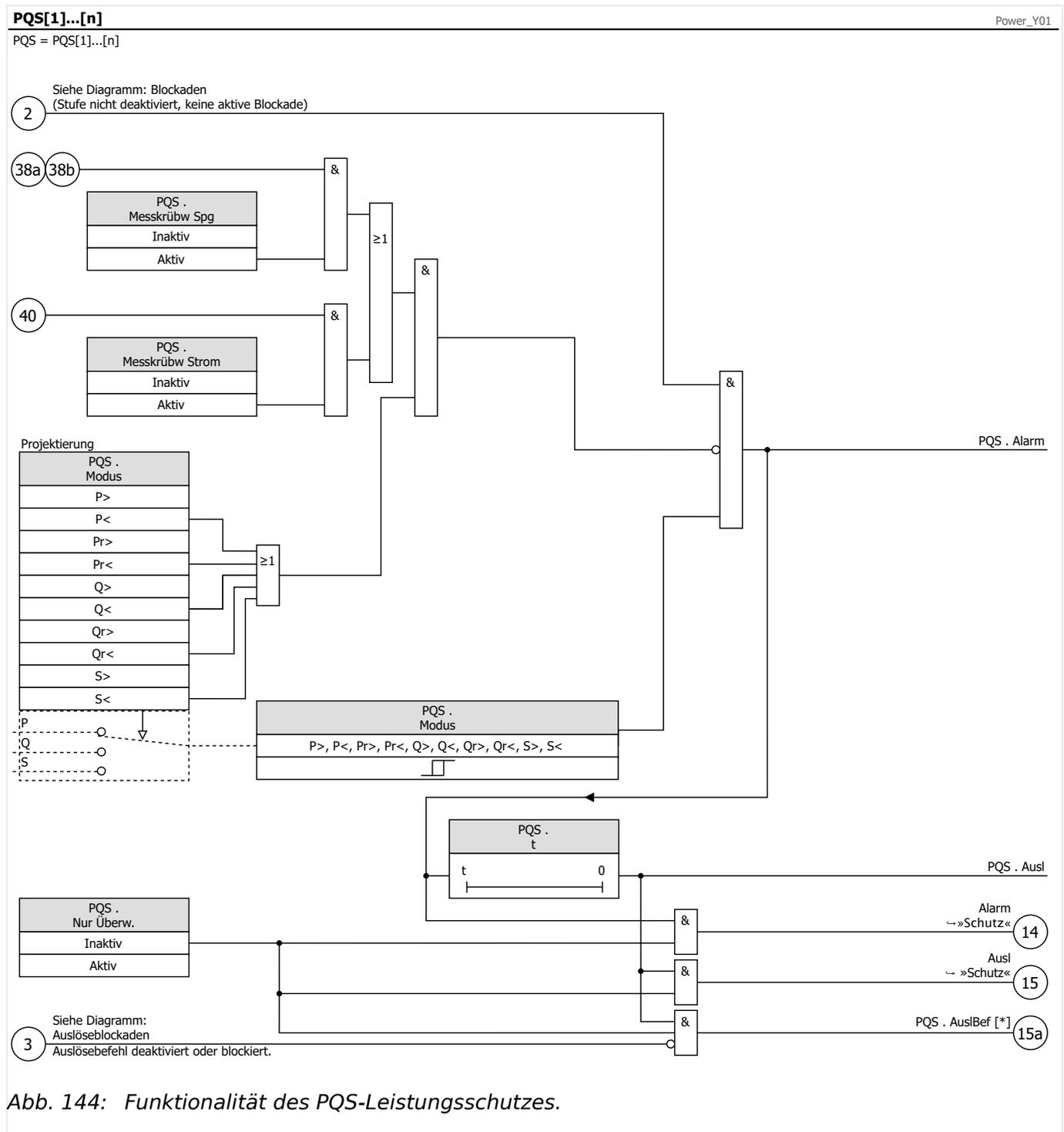
Abb. 144: Funktionalität des PQS-Leistungsschutzes.
