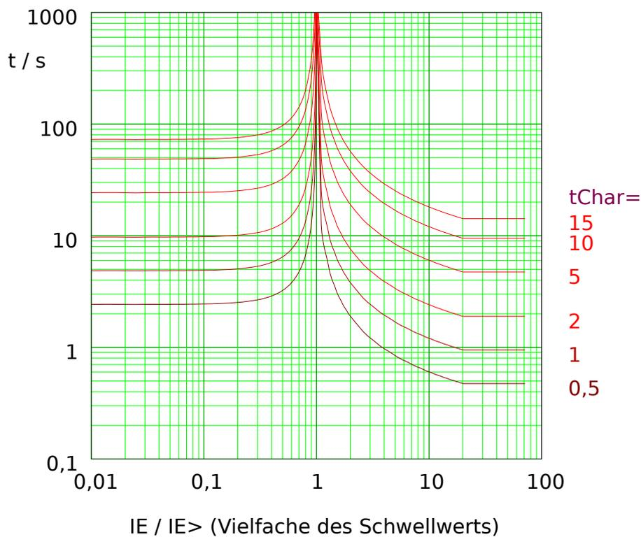
Abb. 102: MINV: Rückfallverzögerung (linke Hälfte,  $IE < I_{E>}$ ) und Auslöseverzögerung (rechte Hälfte,  $IE > I_{E>}$ ), Beispieldiagramm für  $I_{max} = 20 \cdot I_{E>}$ .
