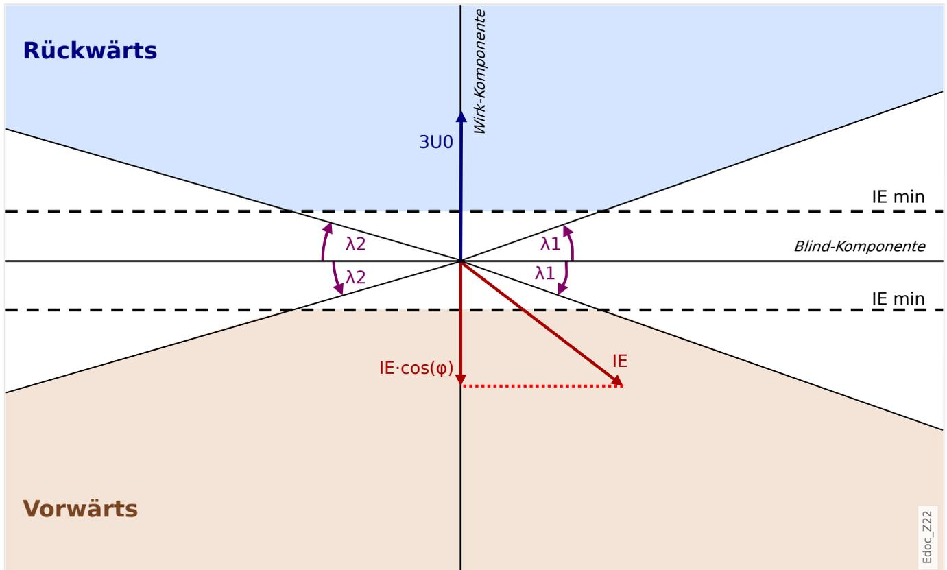
Abb. 70: Richtungserkennung nach der Methode „ $\cos(\phi)$ “.
