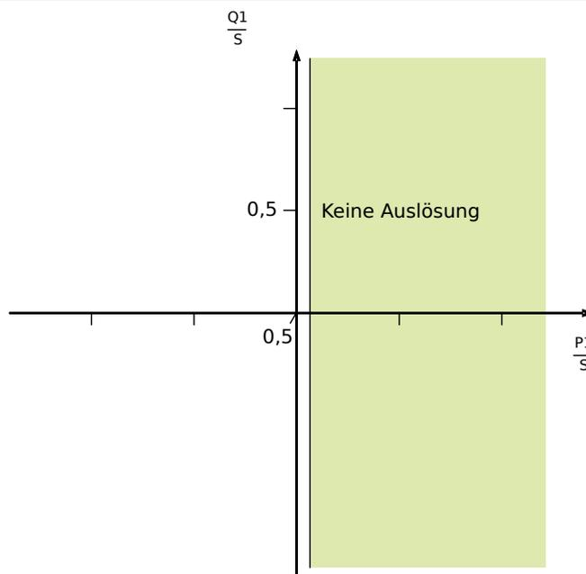
Abb. 139: Variante 2 (Reine Wirkleistungsschwellwertüberwachung): »UFLA Methode« = „Reine Wirkleistungsschwelle“.
