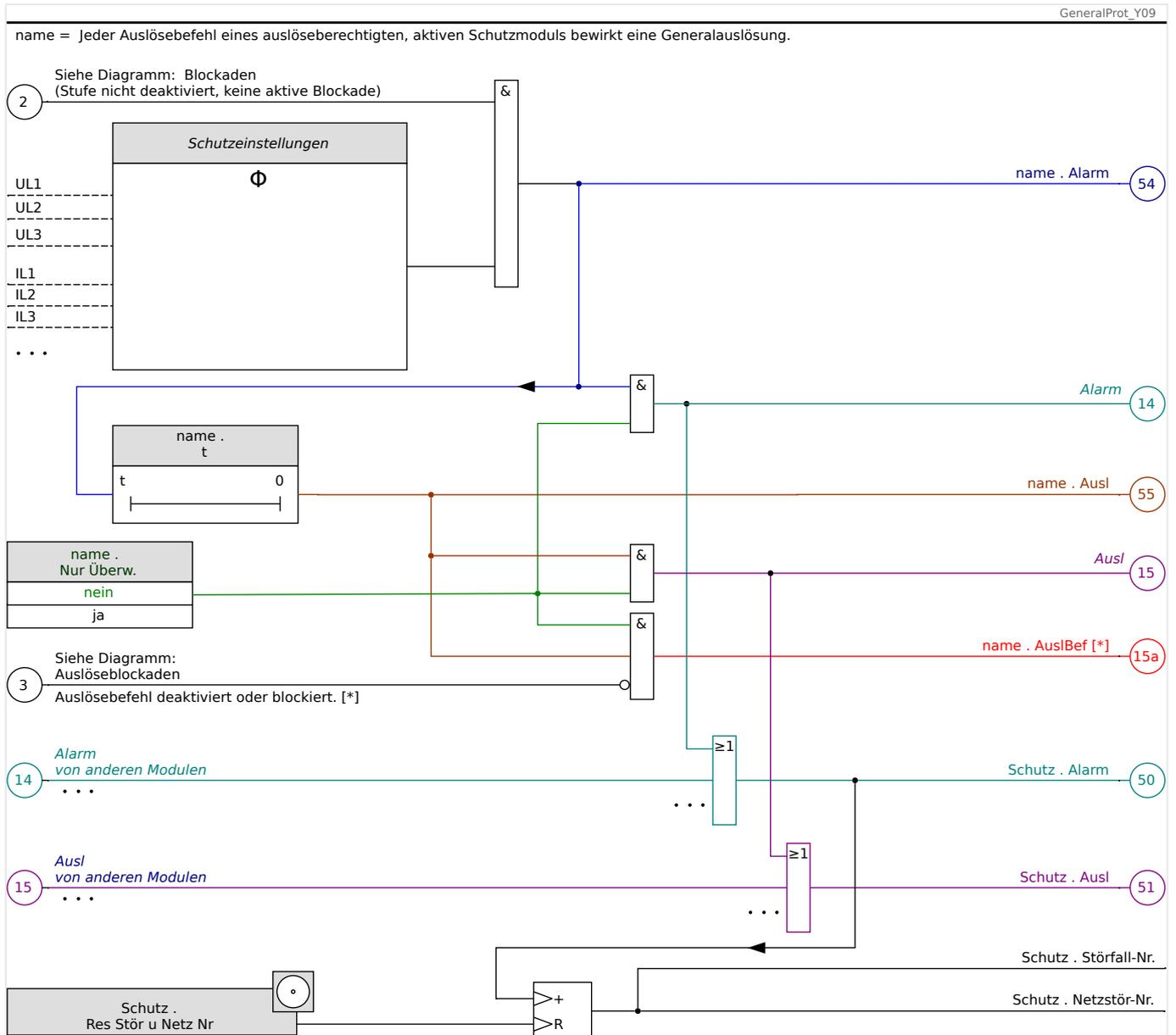
Abb. 65: Grobe Skizze der Funktionalität einer HighPROTEC-Schutzfunktion.
