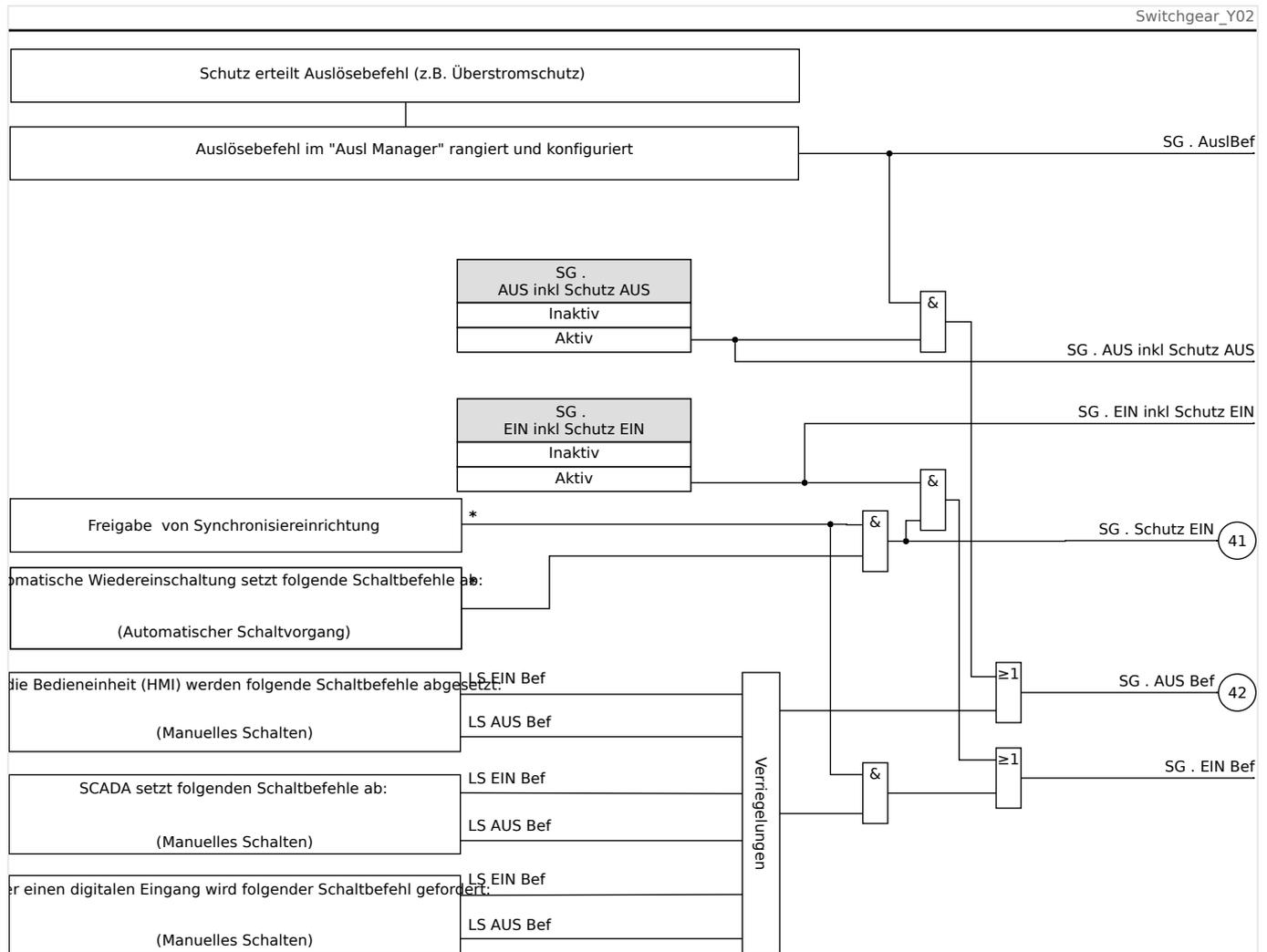
Abb. 156: Verriegelungen. (Für die mit „\*“ markierten Teile gilt: Verfügbarkeit hängt von der bestellten Gerätevariante ab.)
