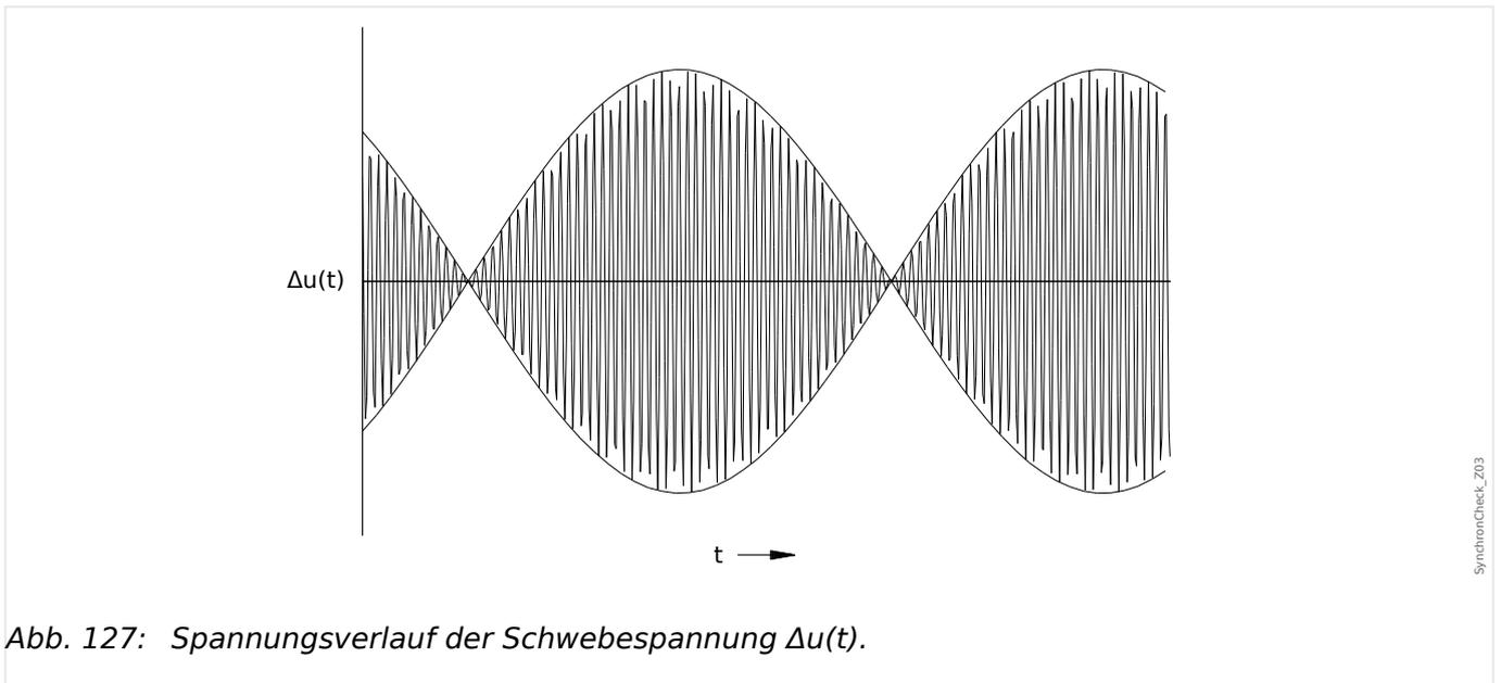
Abb. 127: Spannungsverlauf der Schwebespannung  $\Delta u(t)$ .
