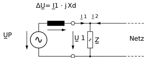
Abb. 121: Ersatzschaltbild netzparalleler Synchrongenerator
