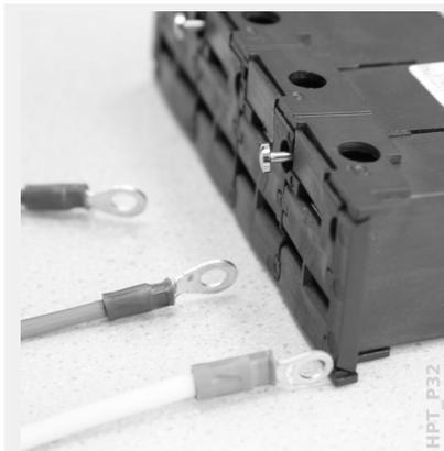
Bei Ringkabelschuhen ist ein Zwischenschritt erforderlich, weil die Verschraubungen komplett entfernt werden müssen.
