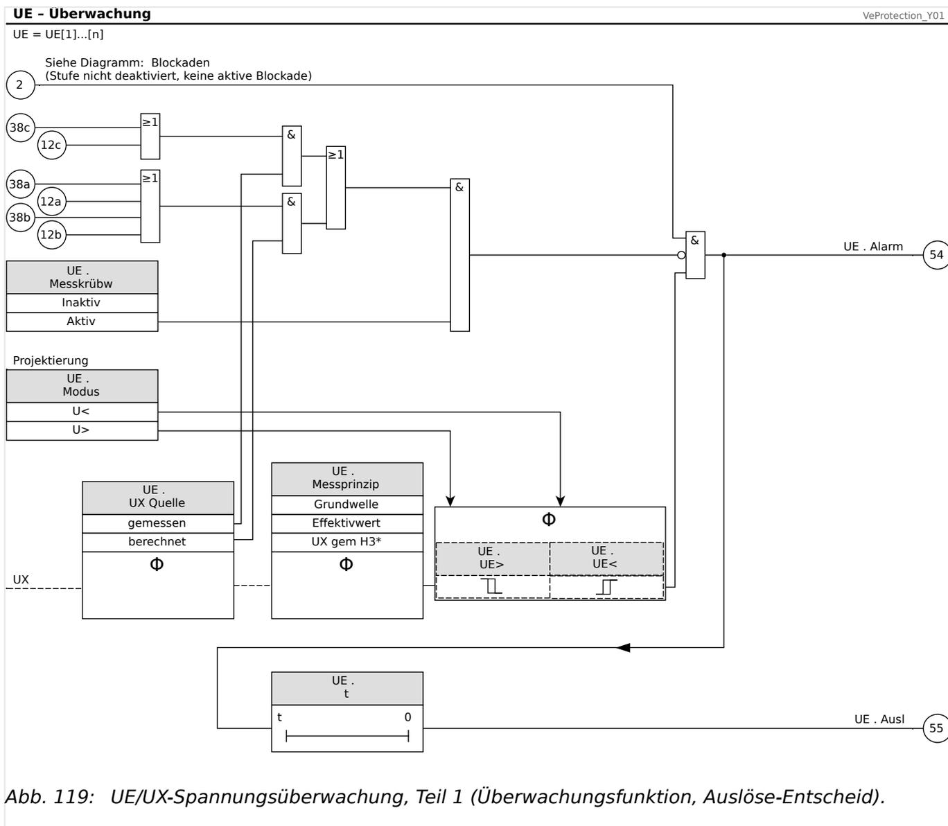
Abb. 119: UE/UX-Spannungsüberwachung, Teil 1 (Überwachungsfunktion, Auslöse-Entscheidung).
