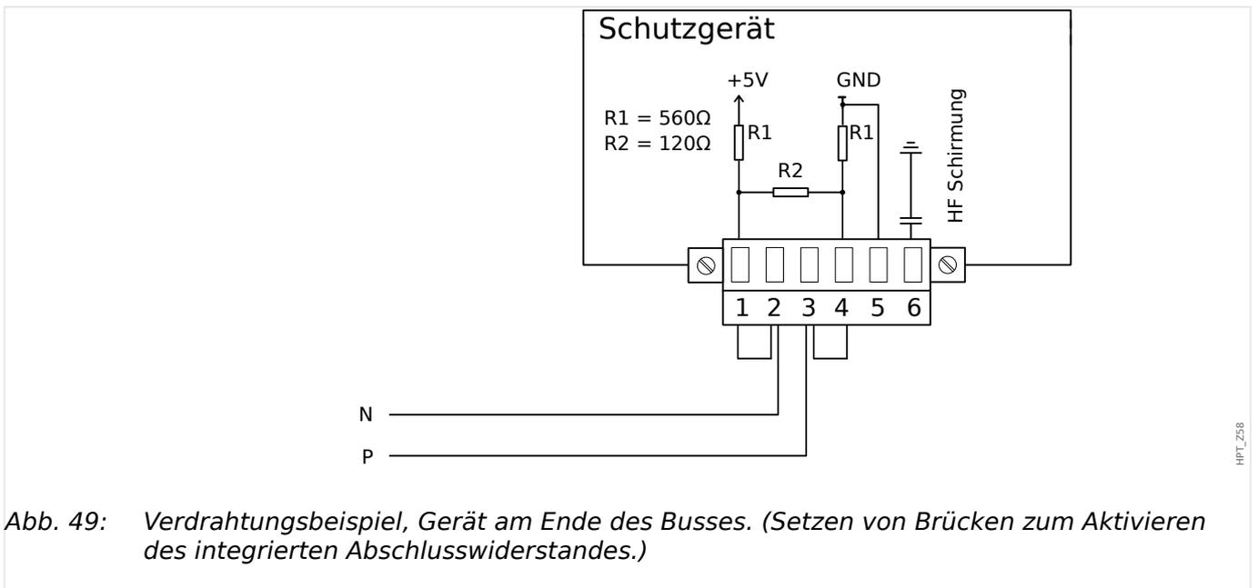
Abb. 49: Verdrahtungsbeispiel, Gerät am Ende des Busses. (Setzen von Brücken zum Aktivieren des integrierten Abschlusswiderstandes.)
