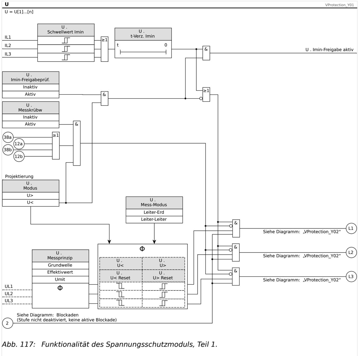
Abb. 117: Funktionalität des Spannungsschutzmoduls, Teil 1.
