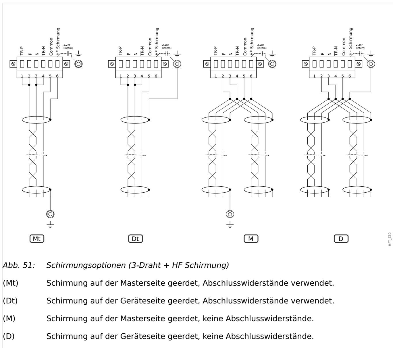
Abb. 51: Schirmungsoptionen (3-Draht + HF Schirmung)
