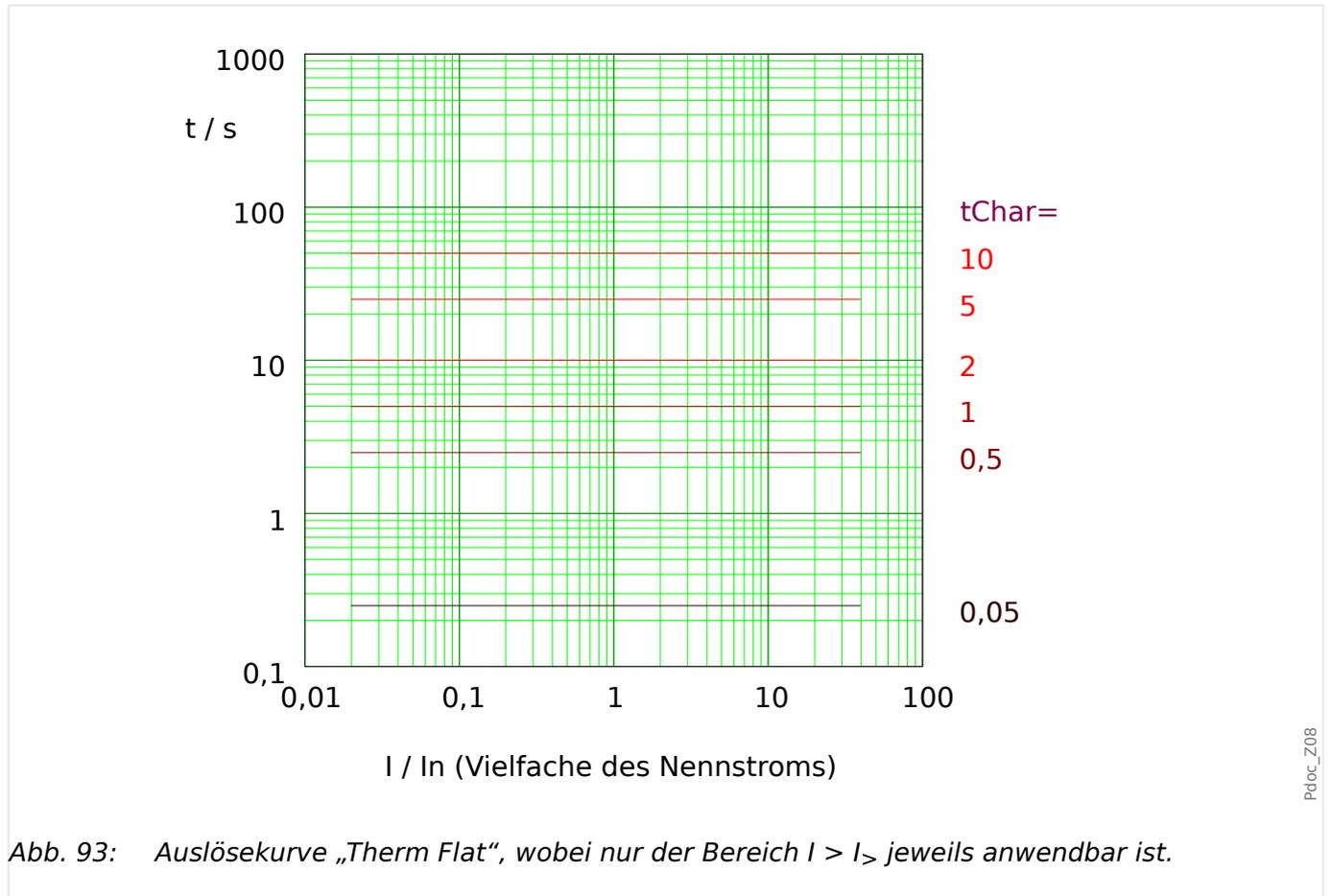
Abb. 93: Auslösekurve „Therm Flat“, wobei nur der Bereich  $I > I_{>}$  jeweils anwendbar ist.
