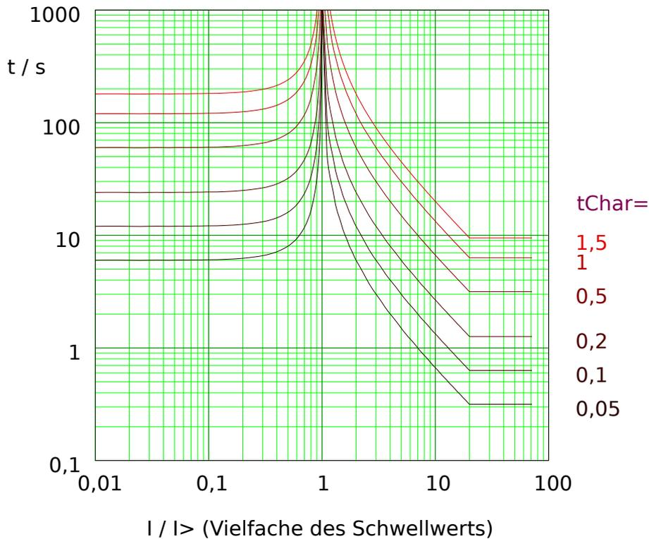
Abb. 88: LINV: Rückfallverzögerung (linke Hälfte,  $I < I_{>}$ ) und Auslöseverzögerung (rechte Hälfte,  $I > I_{>}$ ), Beispieldiagramm für  $I_{max} = 20 \cdot I_{>}$ .
