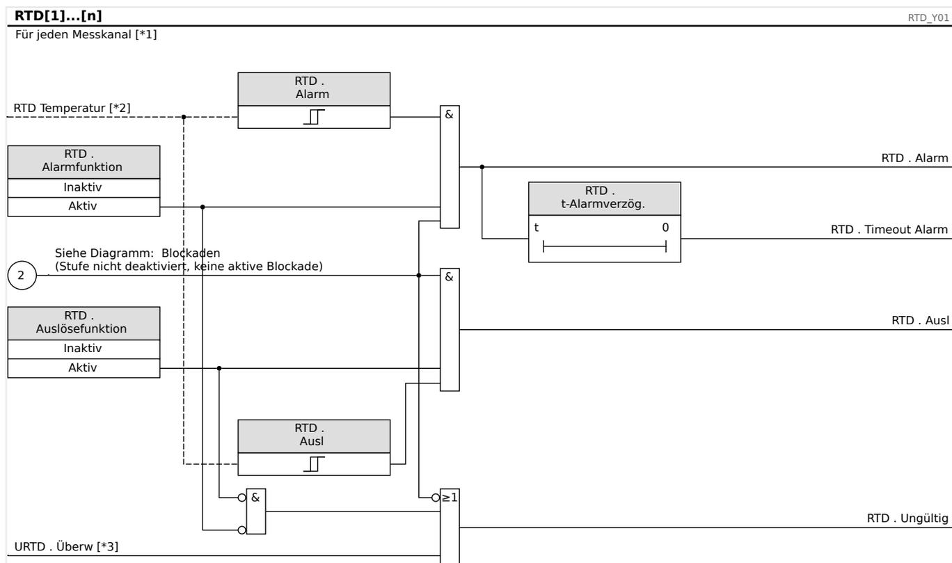
Abb. 147: Generelles RTD-Funktionsprinzip.
