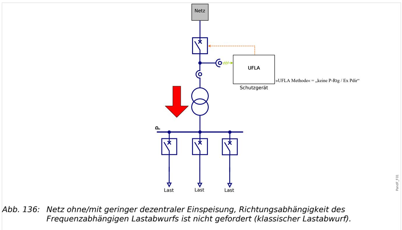
Abb. 136: Netz ohne/mit geringer dezentraler Einspeisung, Richtungsabhängigkeit des Frequenzabhängigen Lastabwurfs ist nicht gefordert (klassischer Lastabwurf).
