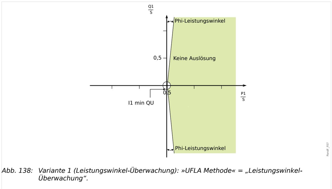
Abb. 138: Variante 1 (Leistungswinkel-Überwachung): »UFLA Methode« = „Leistungswinkel-Überwachung“.
