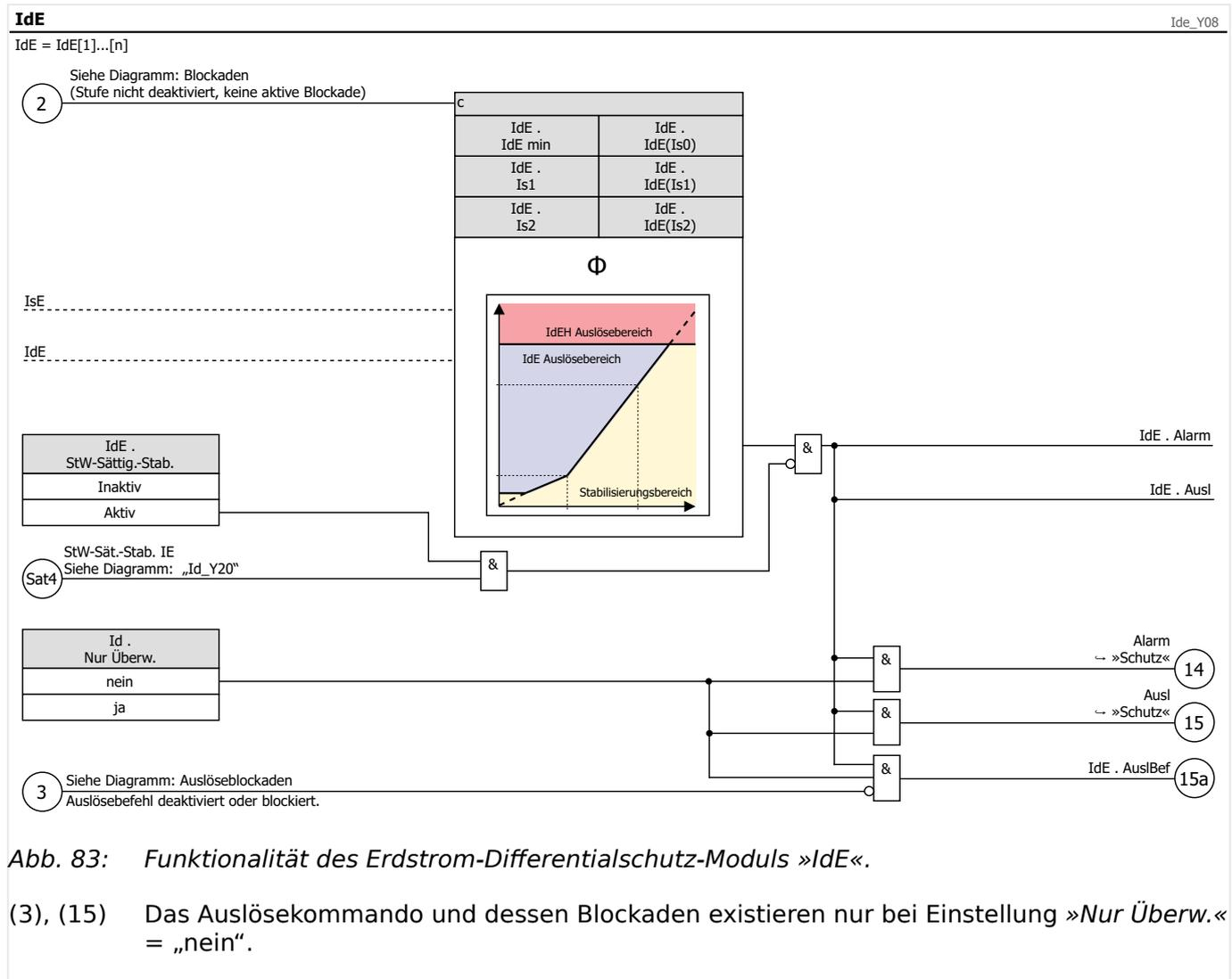
Abb. 83: Funktionalität des Erdstrom-Differentialschutz-Moduls »IdE«.
