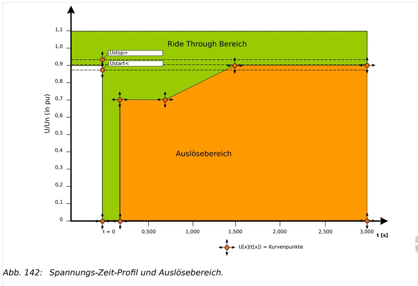
Das LVRT-Modul wechselt in den Standby-Modus zurück, wenn die Netzspannung den Stoppwert » $U_{stop}$ « wieder überschreitet.
