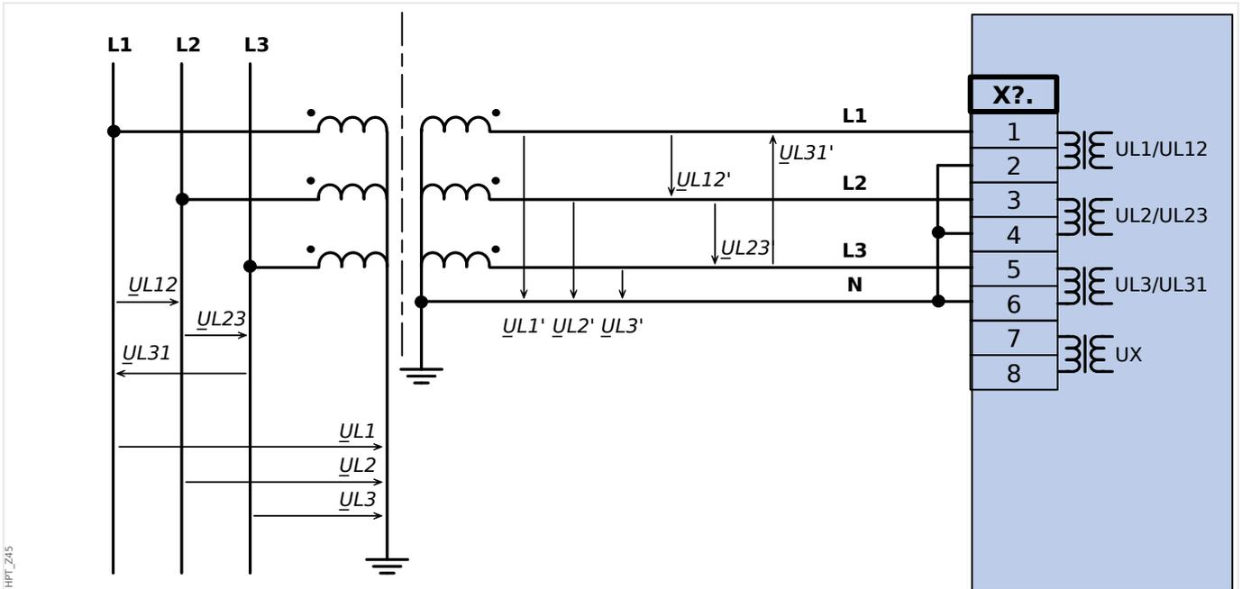
Abb. 34: Drei Spannungswandler mit Geräteanschluss in Sternschaltung
