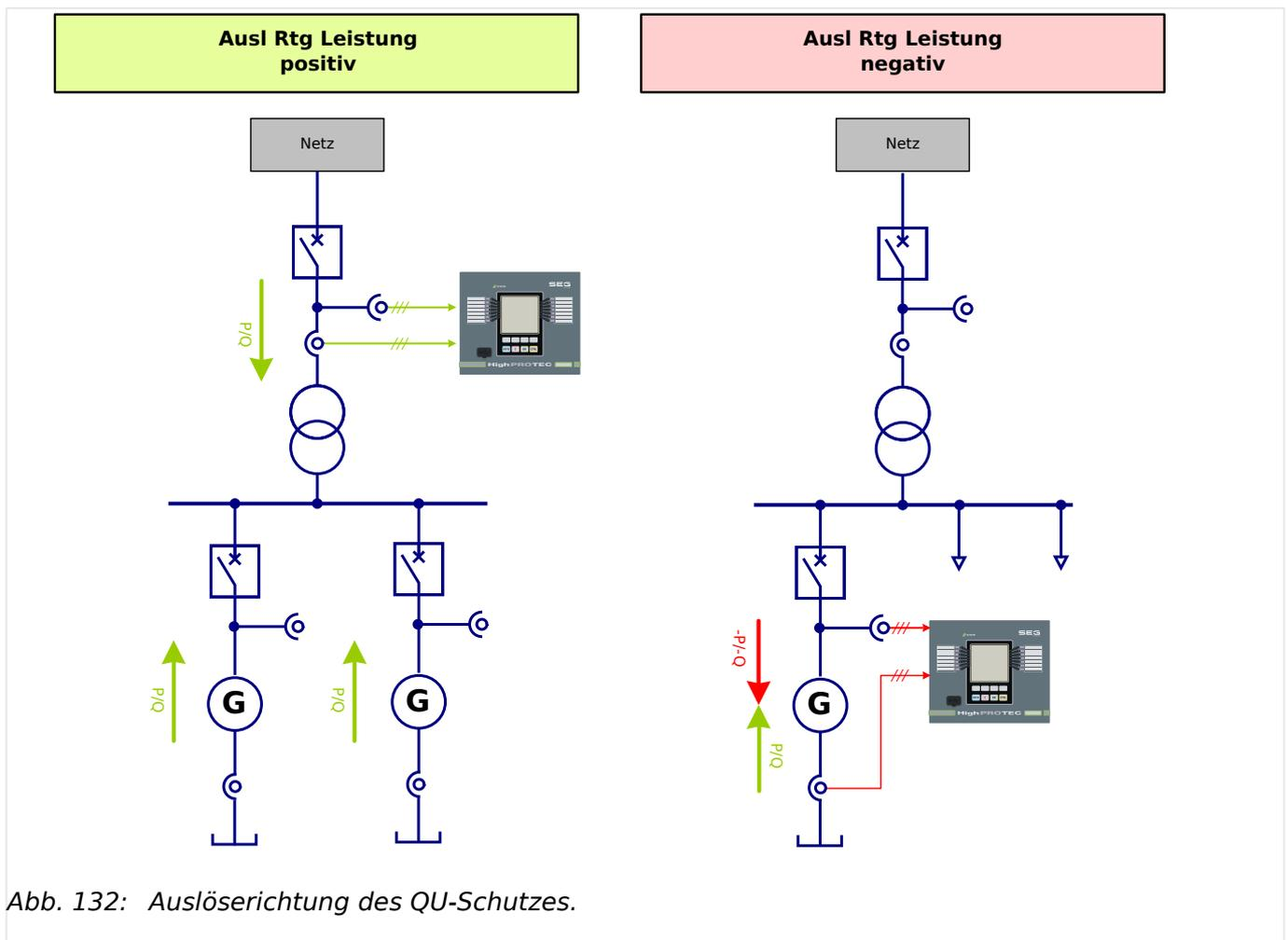
Abb. 132: Auslöserichtung des QU-Schutzes.
