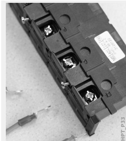
Die Schrauben sind mit einem Plastikschieber abgedeckt, der sich einfach nach hinten wegschieben lässt. Die Verschraubungen liegen nun völlig frei.
