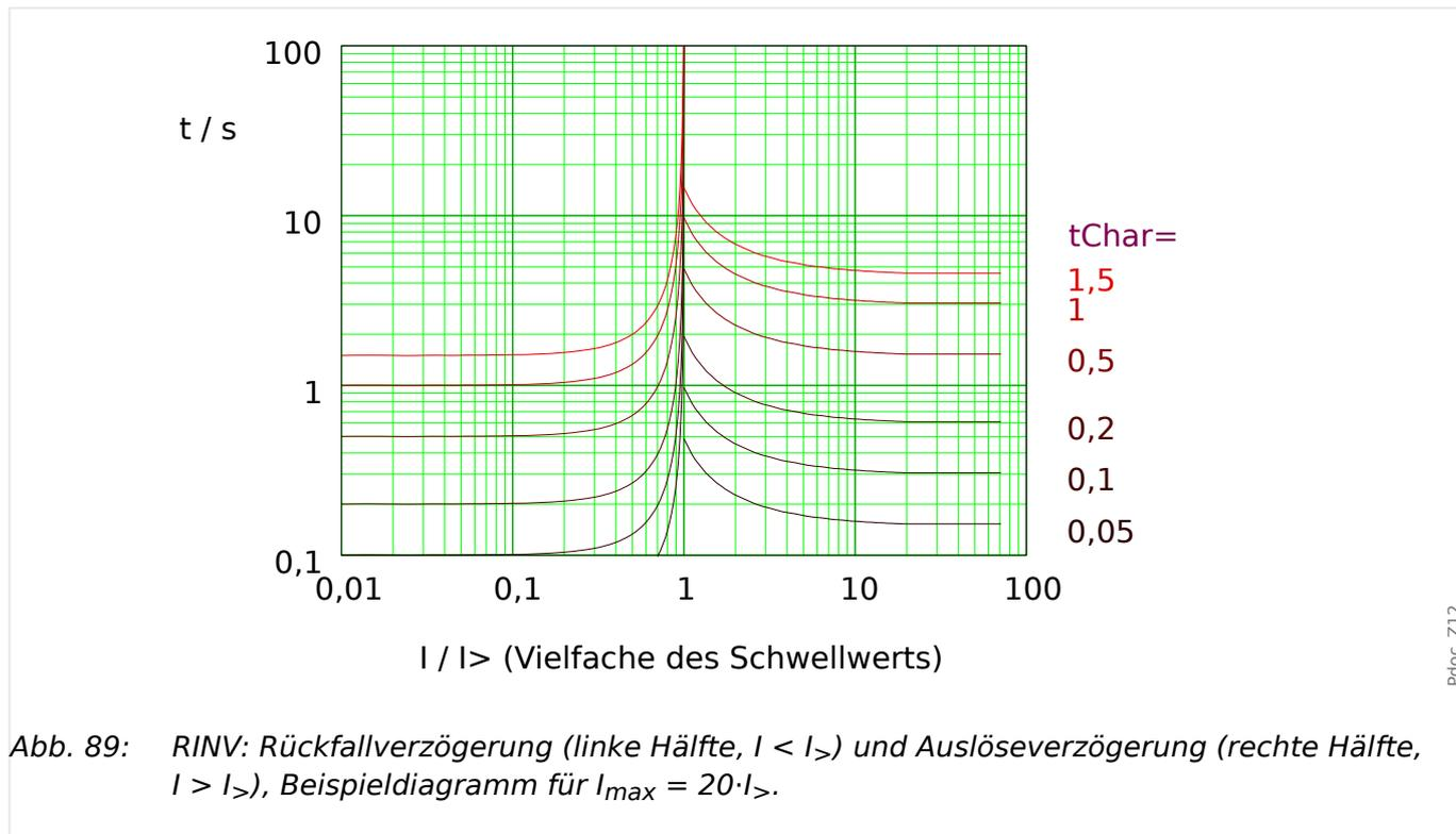
Abb. 89: RINV: Rückfallverzögerung (linke Hälfte,  $I < I_{>}$ ) und Auslöseverzögerung (rechte Hälfte,  $I > I_{>}$ ), Beispieldiagramm für  $I_{max} = 20 \cdot I_{>}$ .
