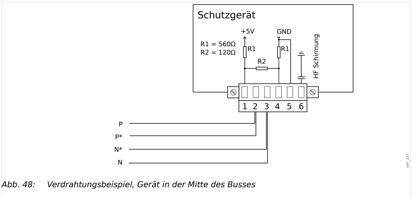
Abb. 48: Verdrahtungsbeispiel, Gerät in der Mitte des Busses
