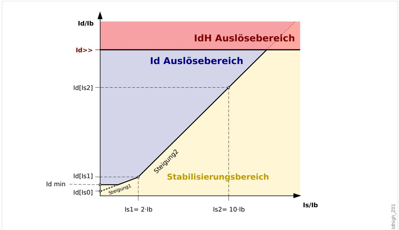
Abb. 81: Unstabilisierte Hochstromdifferentialstufe IdH.
