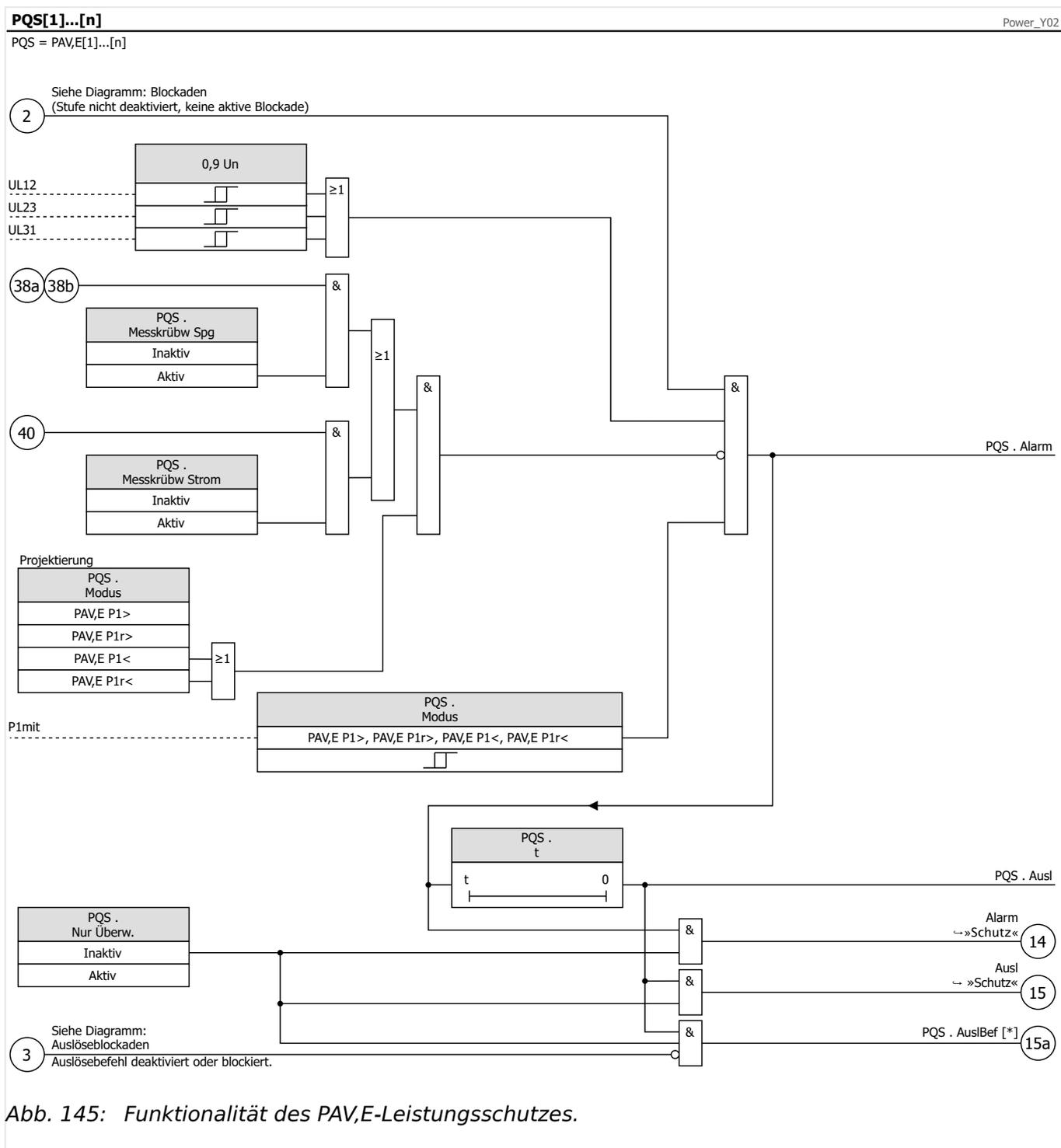
Abb. 145: Funktionalität des PAV,E-Leistungsschutzes.
