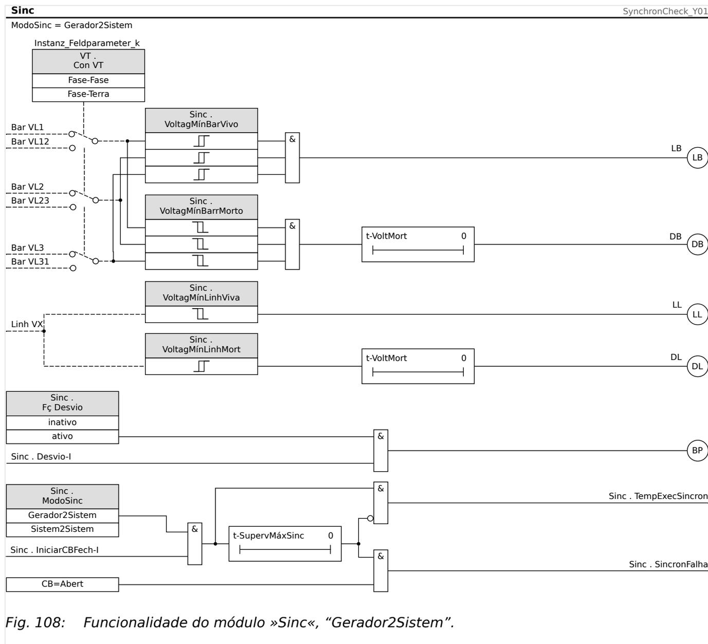
Fig. 108: Funcionalidade do módulo »Sinc«, “Gerador2Sistem”.
