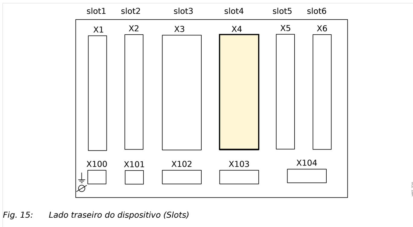
Fig. 15: Lado traseiro do dispositivo (Slots)
