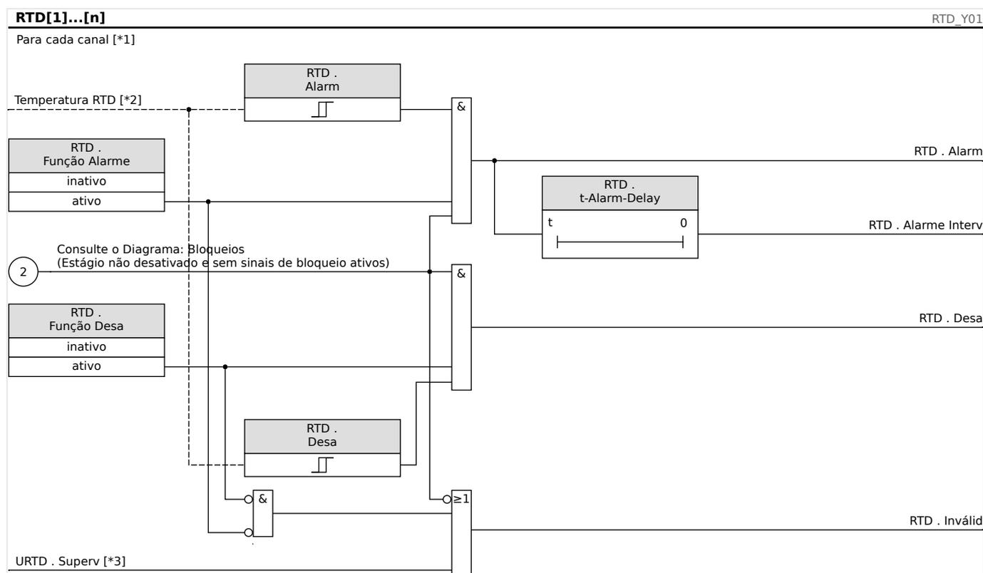
Fig. 127: O princípio geral de funcionamento (alarme atrasado, disparo sem atraso).
