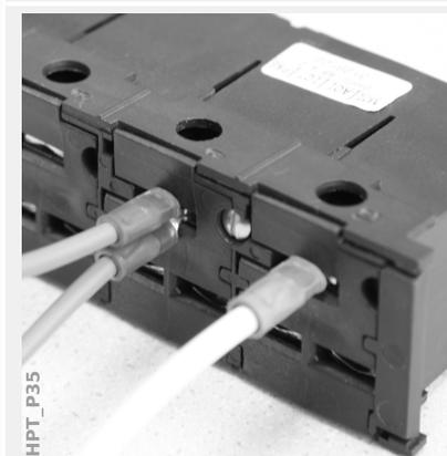
Observação: Enquanto as seções transversais do cabo estiverem dentro dos limites indicados no capítulo Dados Técnicos ([↪ "12 Dados Técnicos"](#), [↪ Quad. .](#)), também é possível inserir dois anéis em um terminal, como mostrado aqui. Isso é útil para configurar a conexão de ponto neutro.
