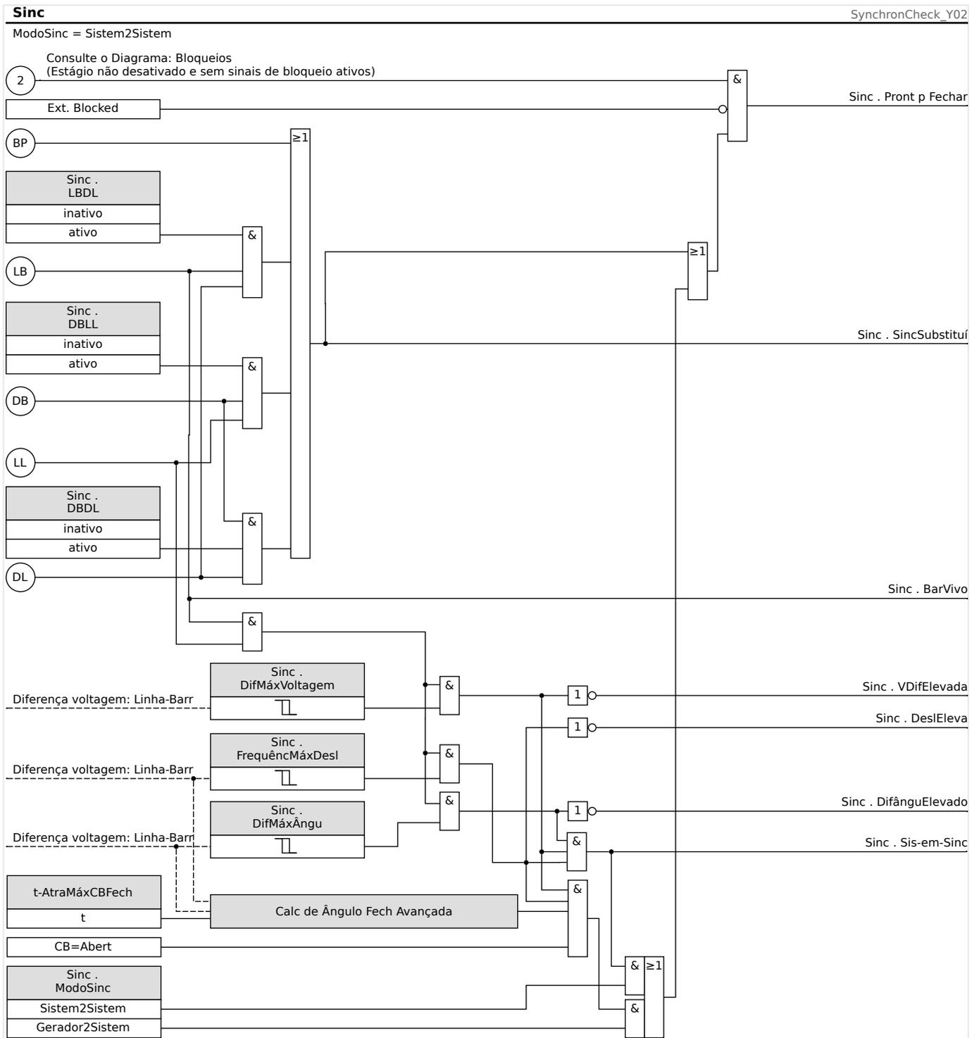
Fig. 109: Funcionalidade do módulo »Sinc«, "Sistem2Sistem".
