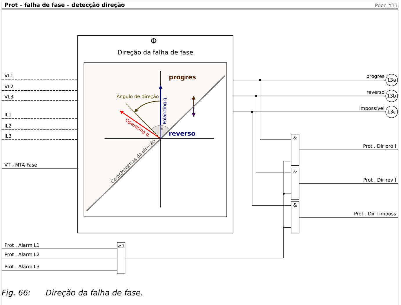
O MCDTV4 avalia o ângulo entre a corrente da fase com a maior corrente (*Quantidade operacional*) e a tensão fase-fase das outras fases (*Quantidade de polarização*). Para falhas de três fases onde a tensão fase-fase é uma tensão demasiado baixa, é usada uma memória de tensão.
