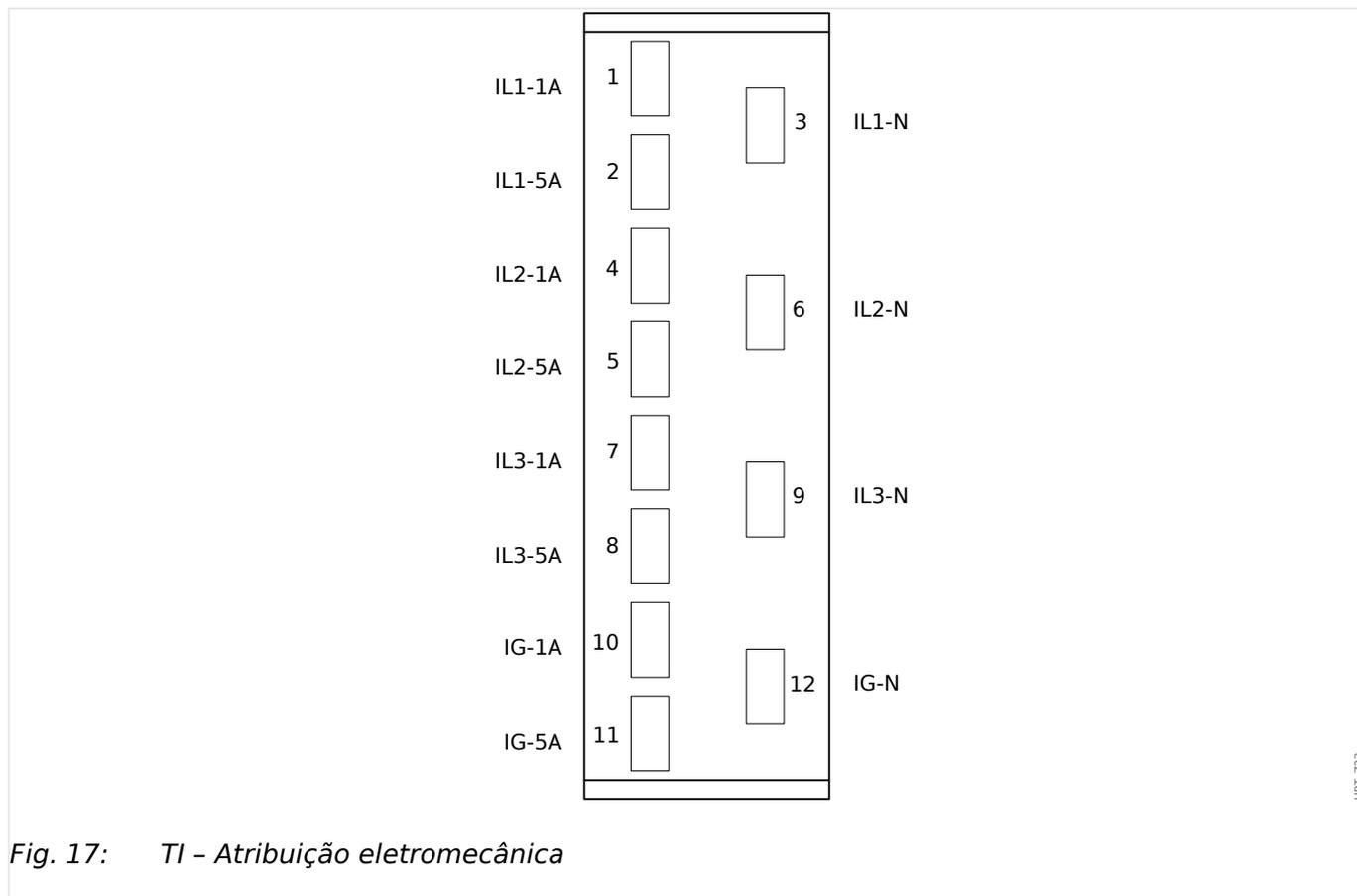
Fig. 17: TI - Atribuição eletromecânica
