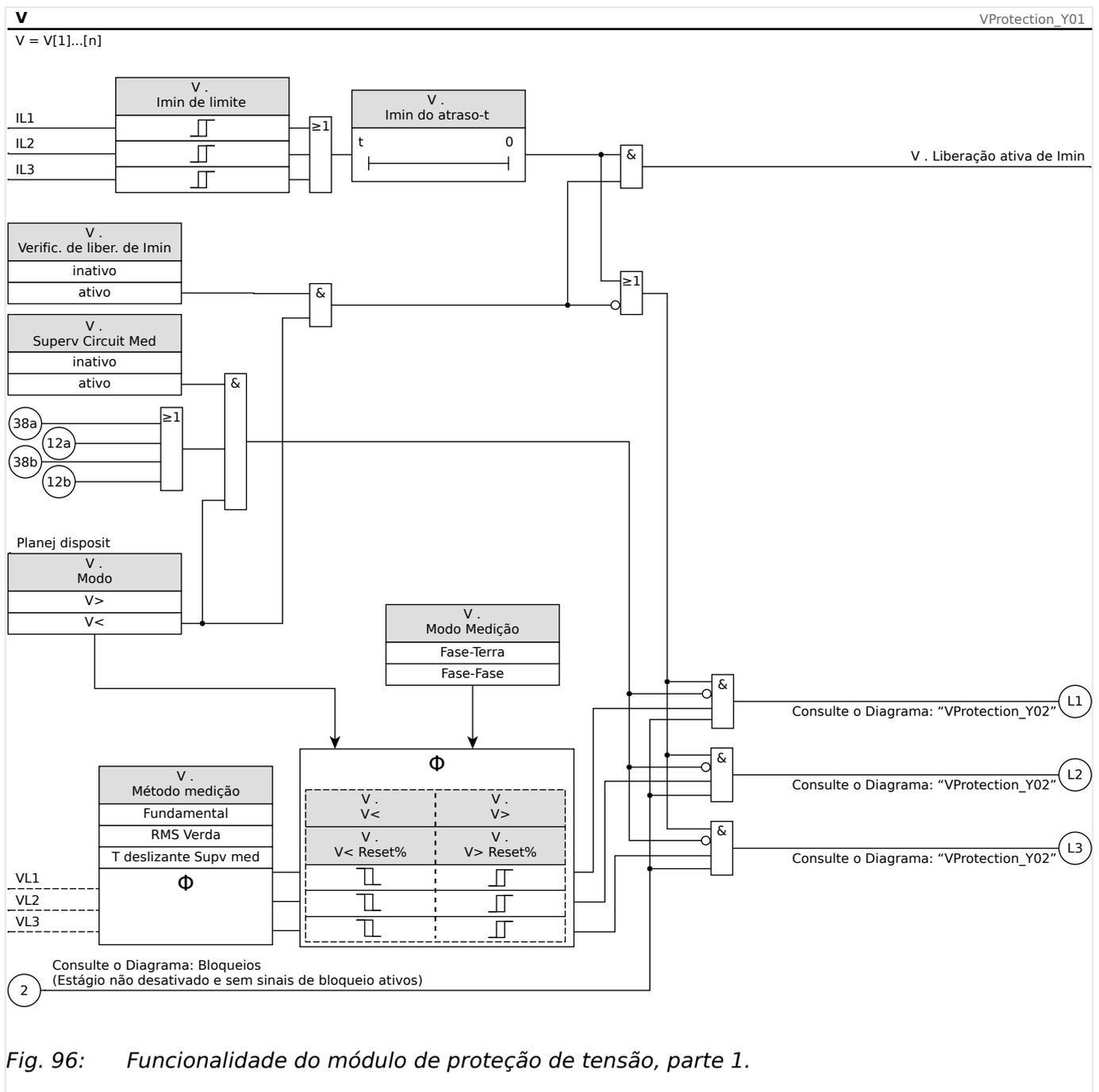
Fig. 96: Funcionalidade do módulo de proteção de tensão, parte 1.
