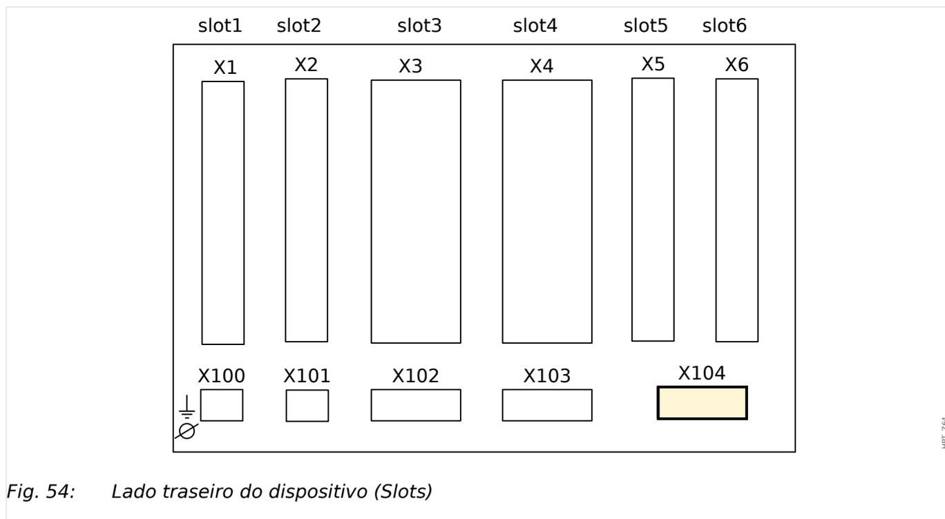
Fig. 54: Lado traseiro do dispositivo (Slots)
