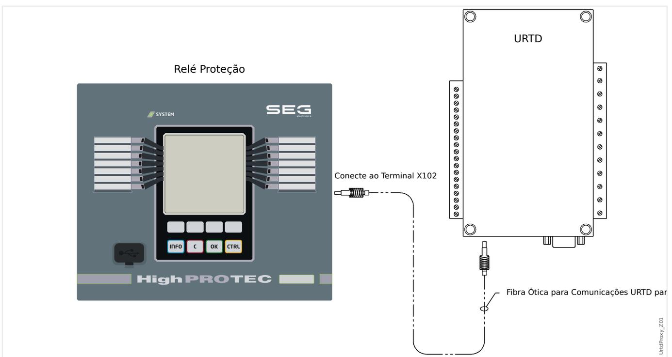
A figura acima mostra as conexões de fibra ótica entre o Módulo URTDII e o dispositivo de proteção. O dispositivo de proteção suporta a conexão de fibra ótica.
