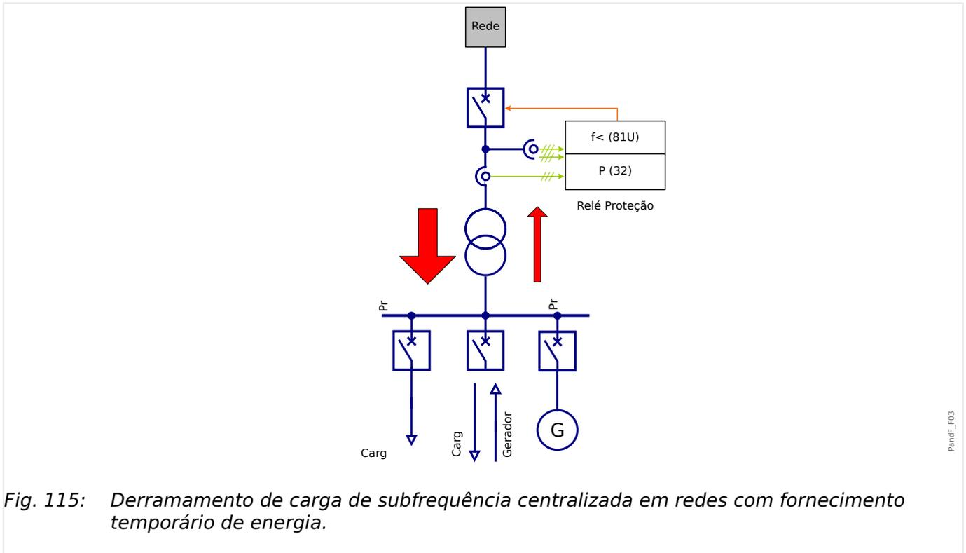
Fig. 115: Derramamento de carga de subfrequência centralizada em redes com fornecimento temporário de energia.
