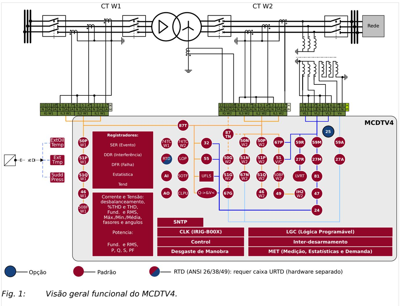
Fig. 1: Visão geral funcional do MCDTV4.
