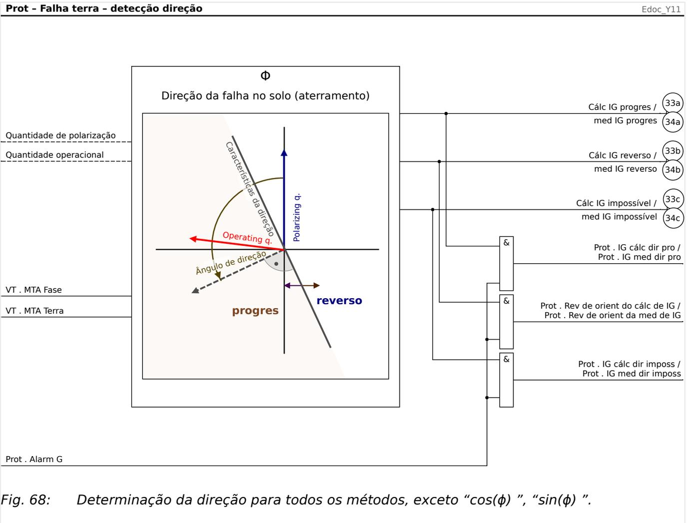
Fig. 68: Determinação da direção para todos os métodos, exceto "cos( $\phi$ )", "sin( $\phi$ )".
