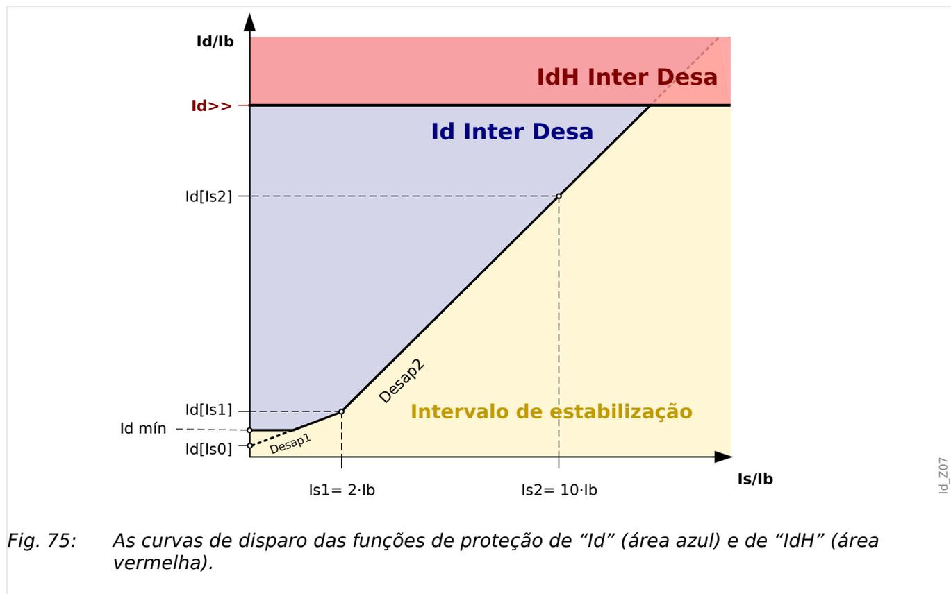
Fig. 75: As curvas de disparo das funções de proteção de “Id” (área azul) e de “IdH” (área vermelha).
