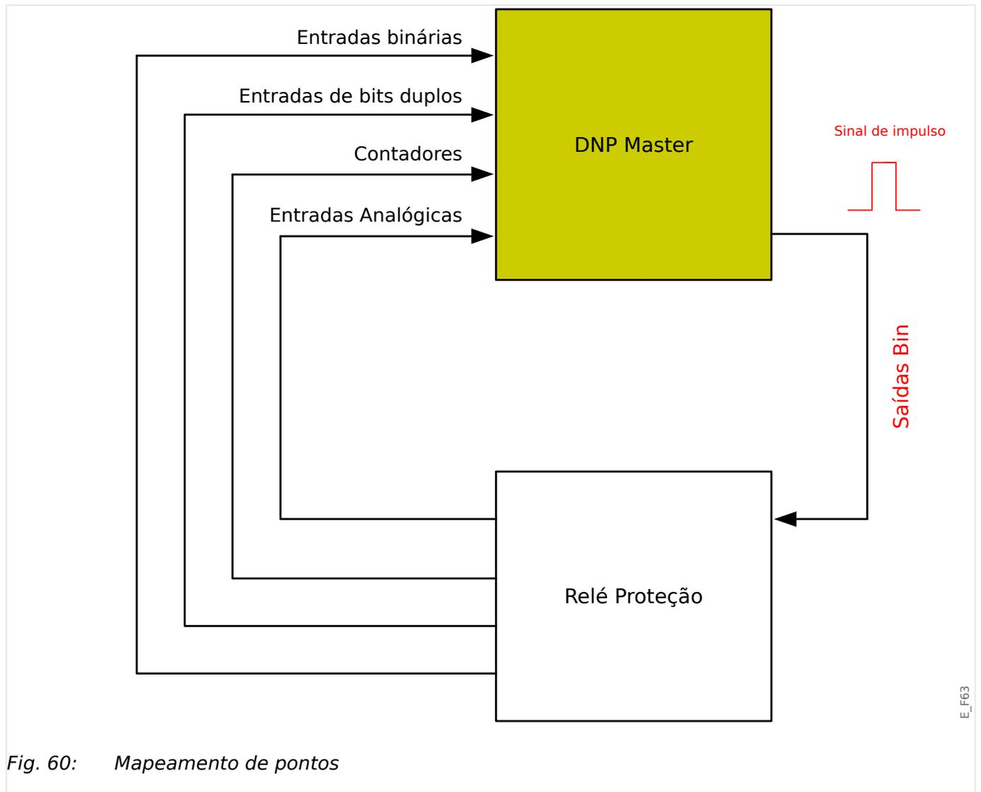
Fig. 60: Mapeamento de pontos
