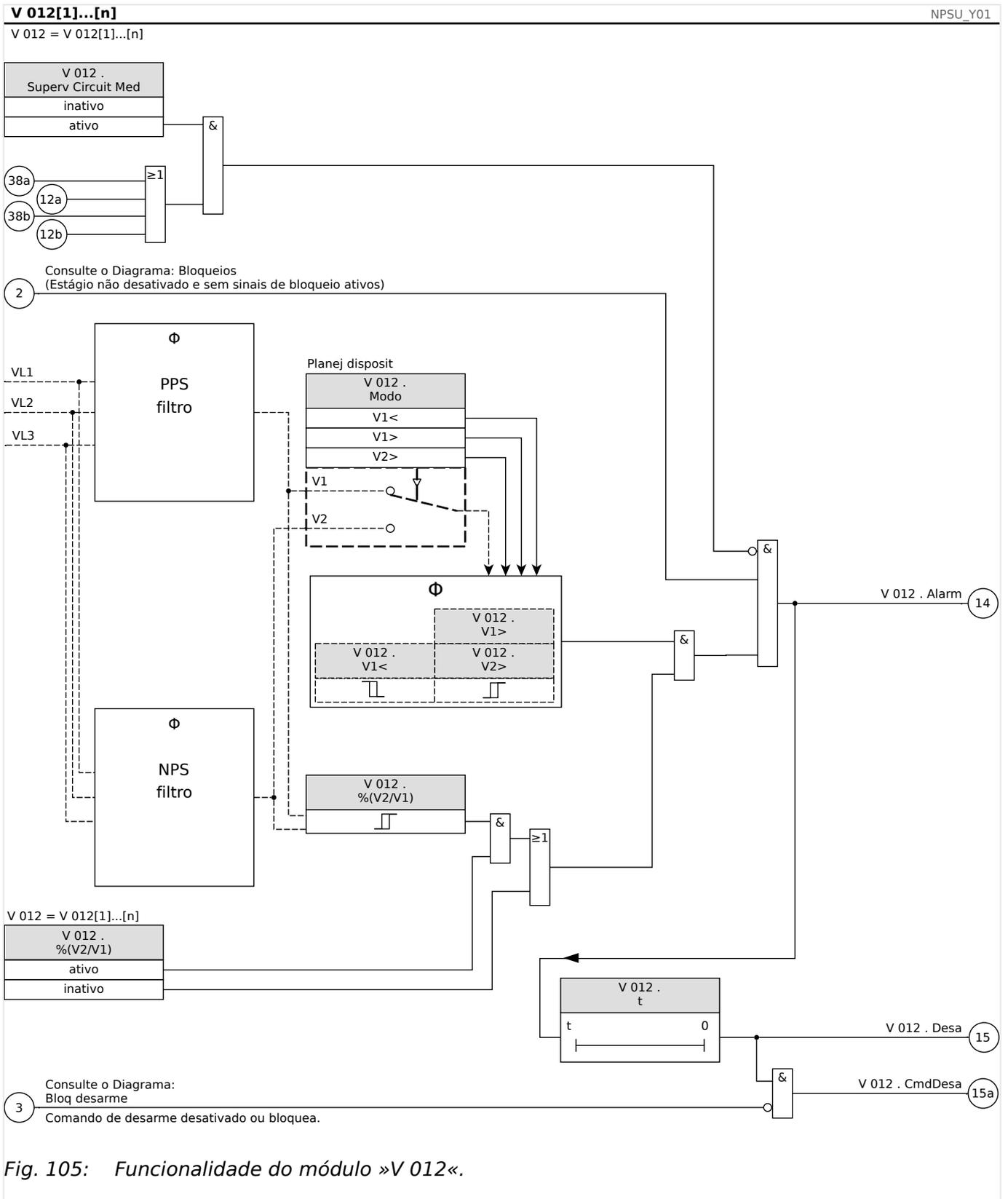
Fig. 105: Funcionalidade do módulo »V 012«.
