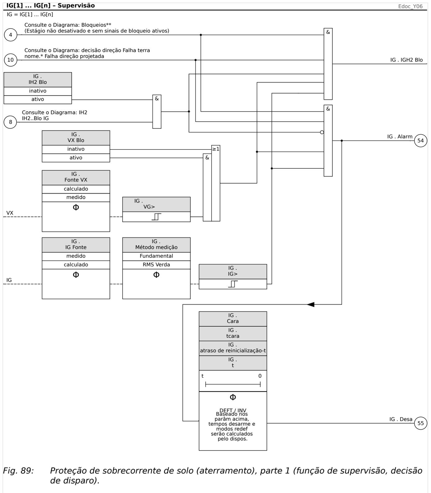
Fig. 89: Proteção de sobrecorrente de solo (aterramento), parte 1 (função de supervisão, decisão de disparo).
