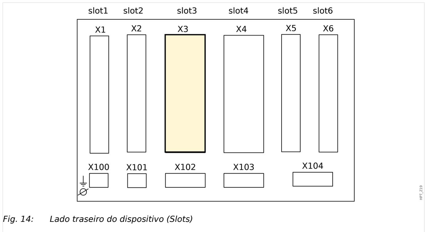
Fig. 14: Lado traseiro do dispositivo (Slots)
