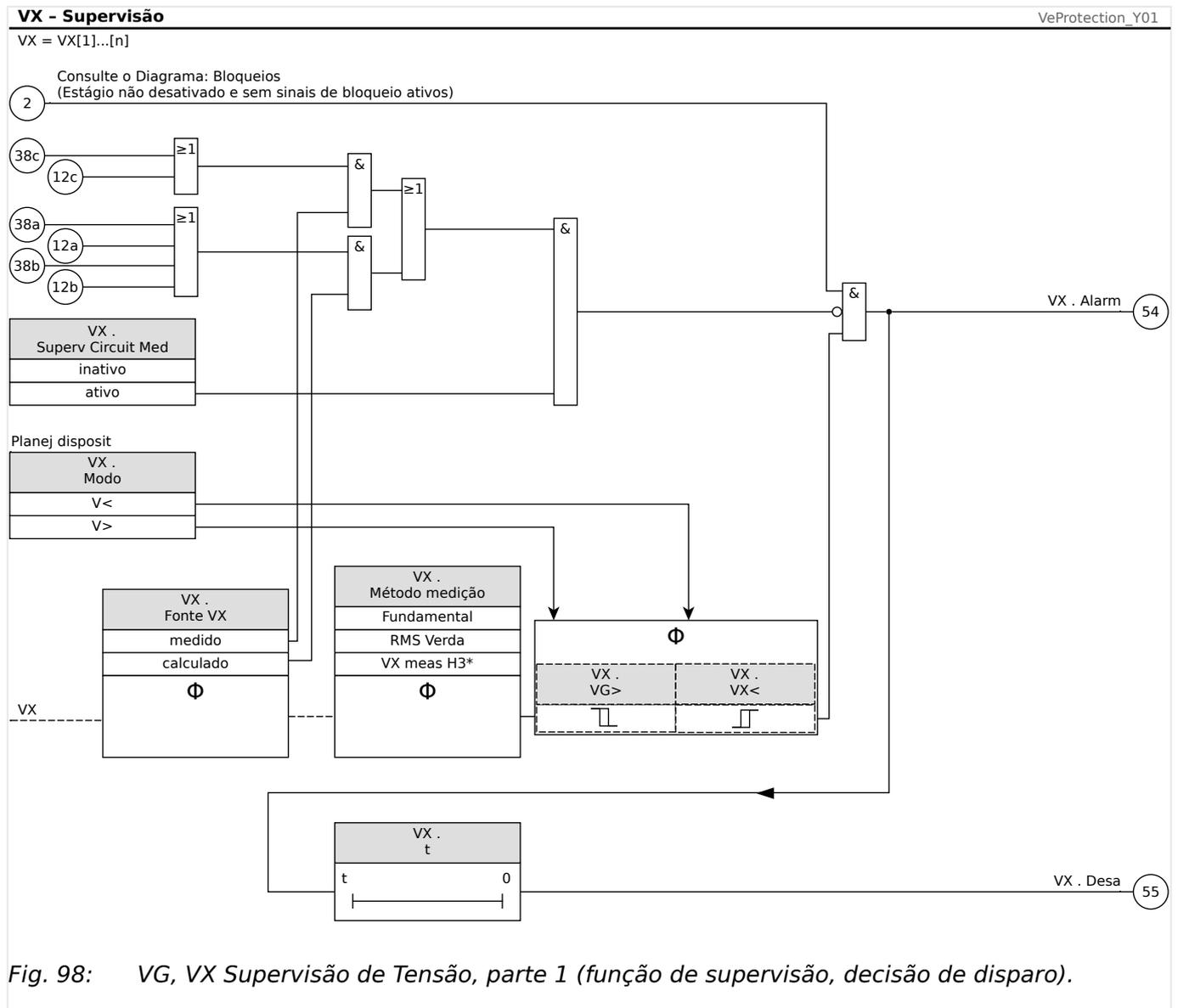
Fig. 98: VG, VX Supervisão de Tensão, parte 1 (função de supervisão, decisão de disparo).
