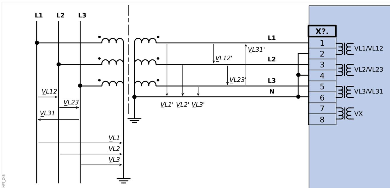
Fig. 34: VT Wye: Medição de voltagem trifásica - fiação das entradas de medição: "conexão estrela"
