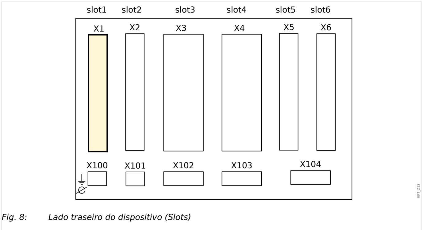
O tipo de cartão de abastecimento de energia e o número de entradas digitais utilizado neste slot depende do tipo de dispositivo solicitado. [tipo de dispositivo solicitado](#). As diferentes variantes têm um escopo de funções diferente.
