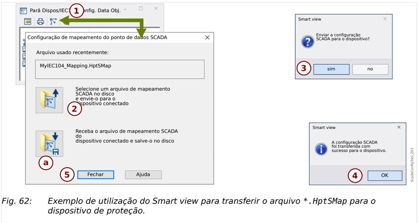
Fig. 62: Exemplo de utilização do Smart view para transferir o arquivo \*.HptSMap para o dispositivo de proteção.
