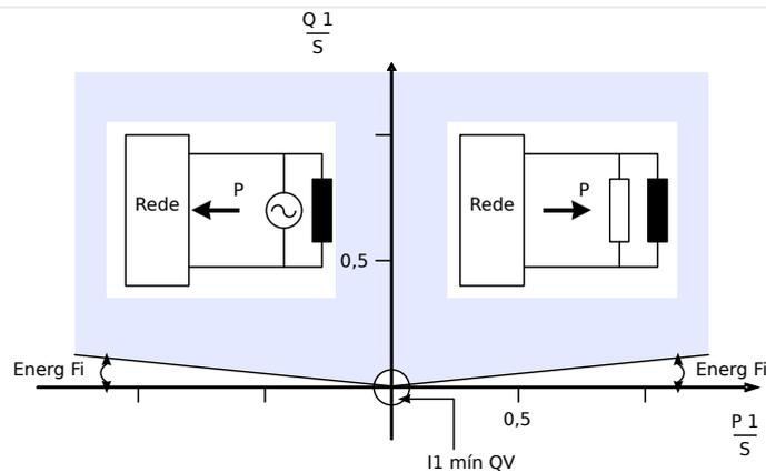
Fig. 111: Método 1: Supervisão Âng Energ.
