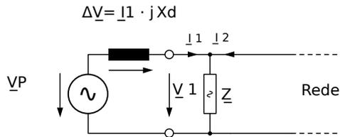
Fig. 100: Circuito equivalente no gerador síncrono em paralelo com a rede.
