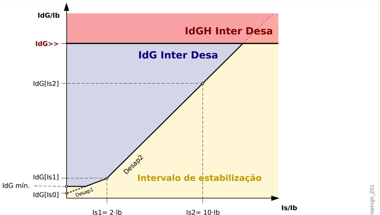
Fig. 80: Valor de arranque "IdG>>" da corrente diferencial de aterramento com base na corrente nominal "lb" do objeto de proteção relacionado.
