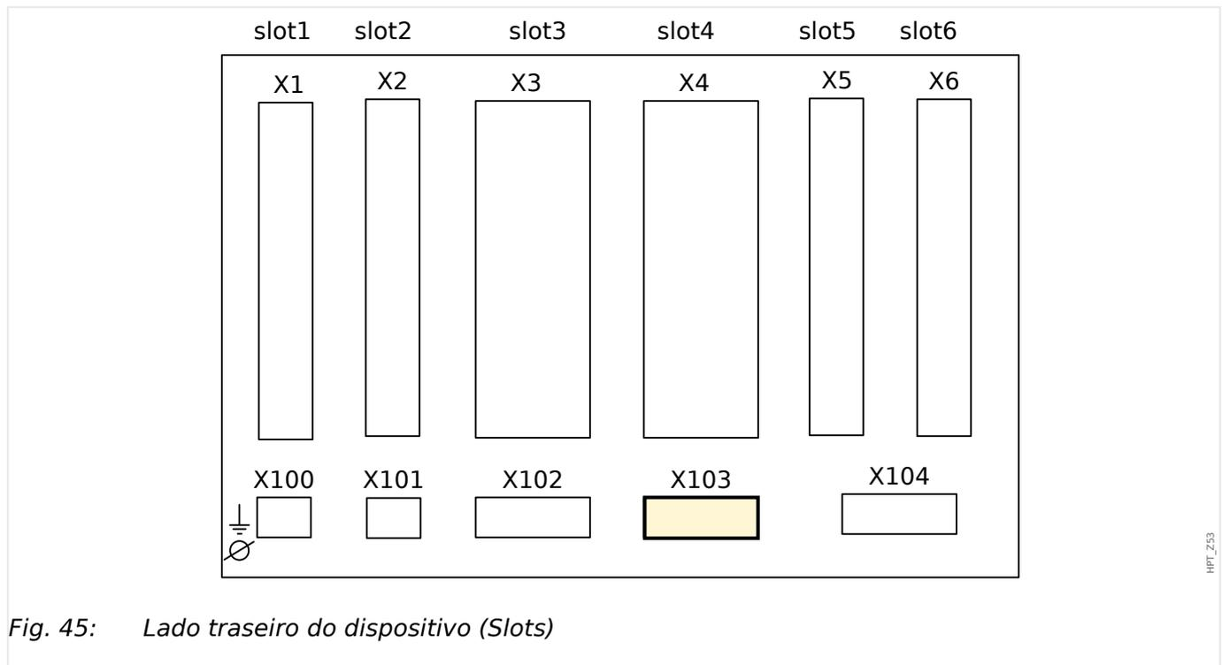
Fig. 45: Lado traseiro do dispositivo (Slots)
