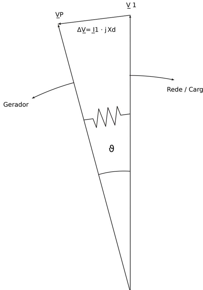
Fig. 101: Vetores de voltagem em operação paralela.
