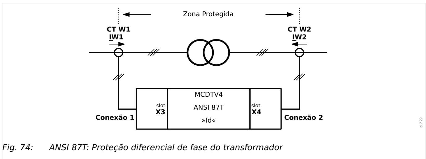
Fig. 74: ANSI 87T: Proteção diferencial de fase do transformador
