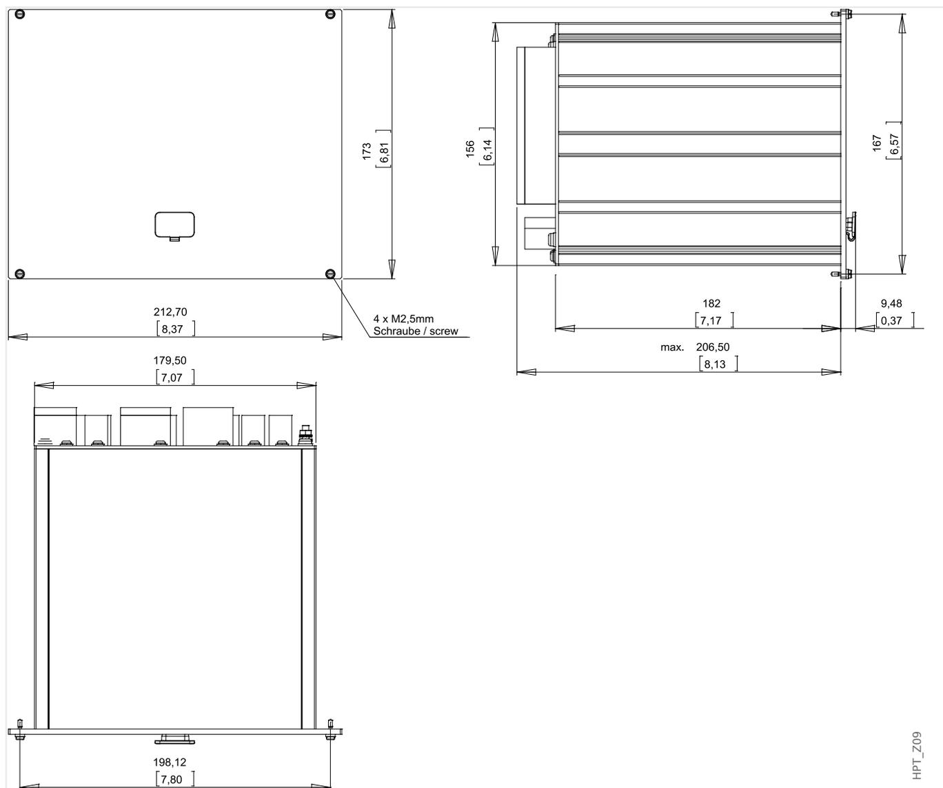
Fig. 4: Vista de 3 Lados Caixa B2 (Dispositivos 19") (Todas as dimensões em mm, exceto as dimensões entre colchetes [polegada].)
