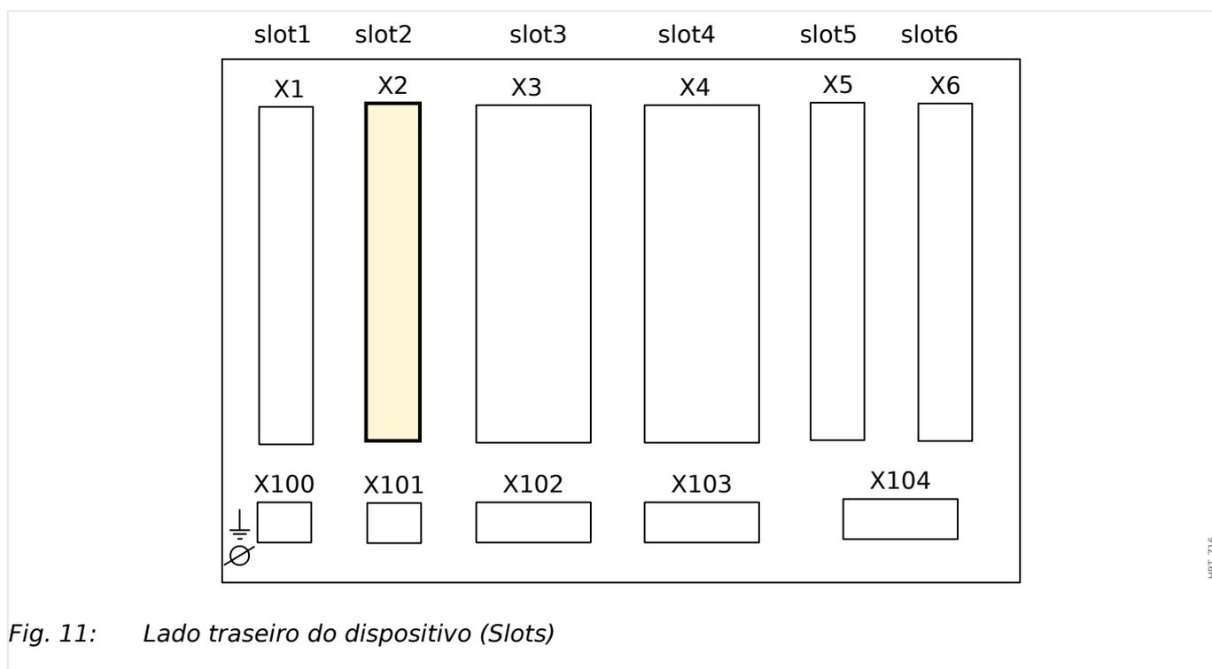
O tipo de placa neste slot depende do [tipo de dispositivo solicitado](#). As diferentes variantes têm um escopo de funções diferente.
