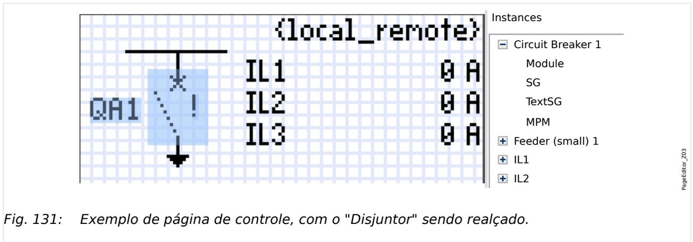
Fig. 131: Exemplo de página de controle, com o "Disjuntor" sendo realçado.
