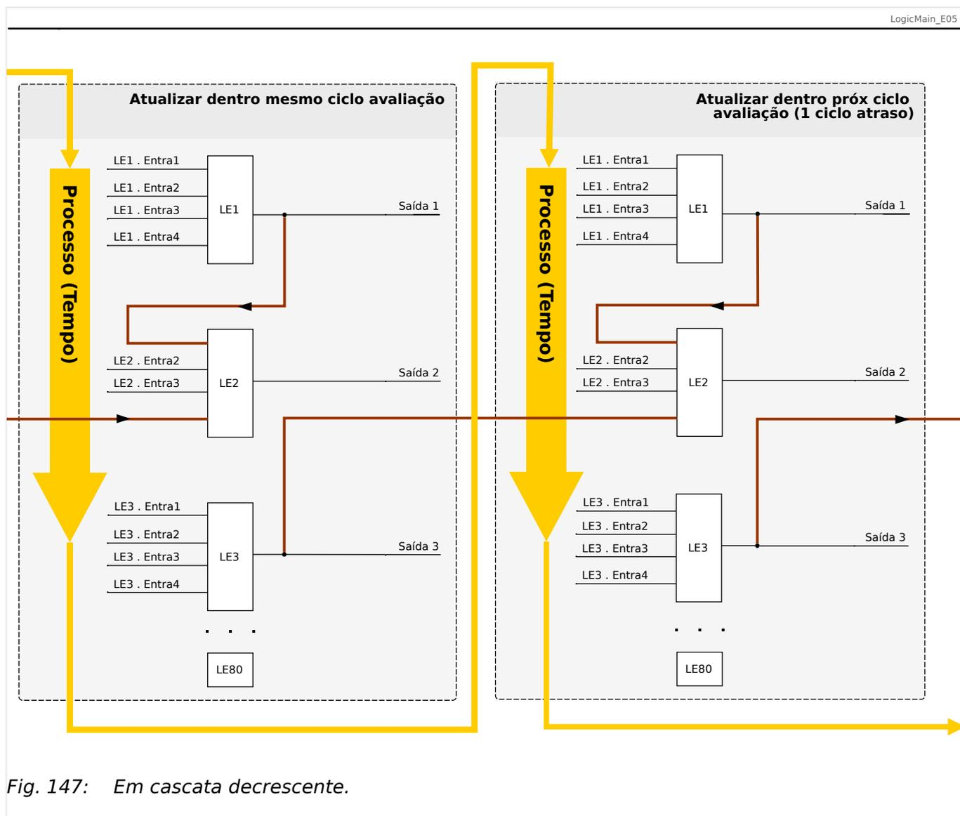
No exemplo mostrado em Fig. 147 acima, a “Equação Lógica 2” usa os estados de saída de duas outras equações, “Equação Lógica 1” e “Equação Lógica 3”. O resultado da “Equação Lógica 1” é usado em ordem ascendente e, portanto, foi avaliado dentro do mesmo ciclo do processo. O resultado da “Equação Lógica 3” é usado em ordem descendente e, portanto, foi avaliado dentro do ciclo de processo anterior.
