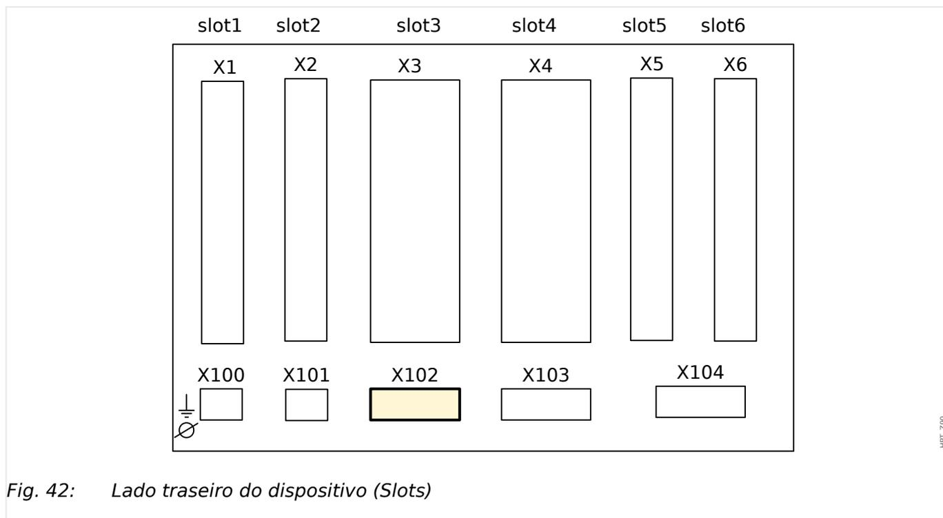
Fig. 42: Lado traseiro do dispositivo (Slots)
