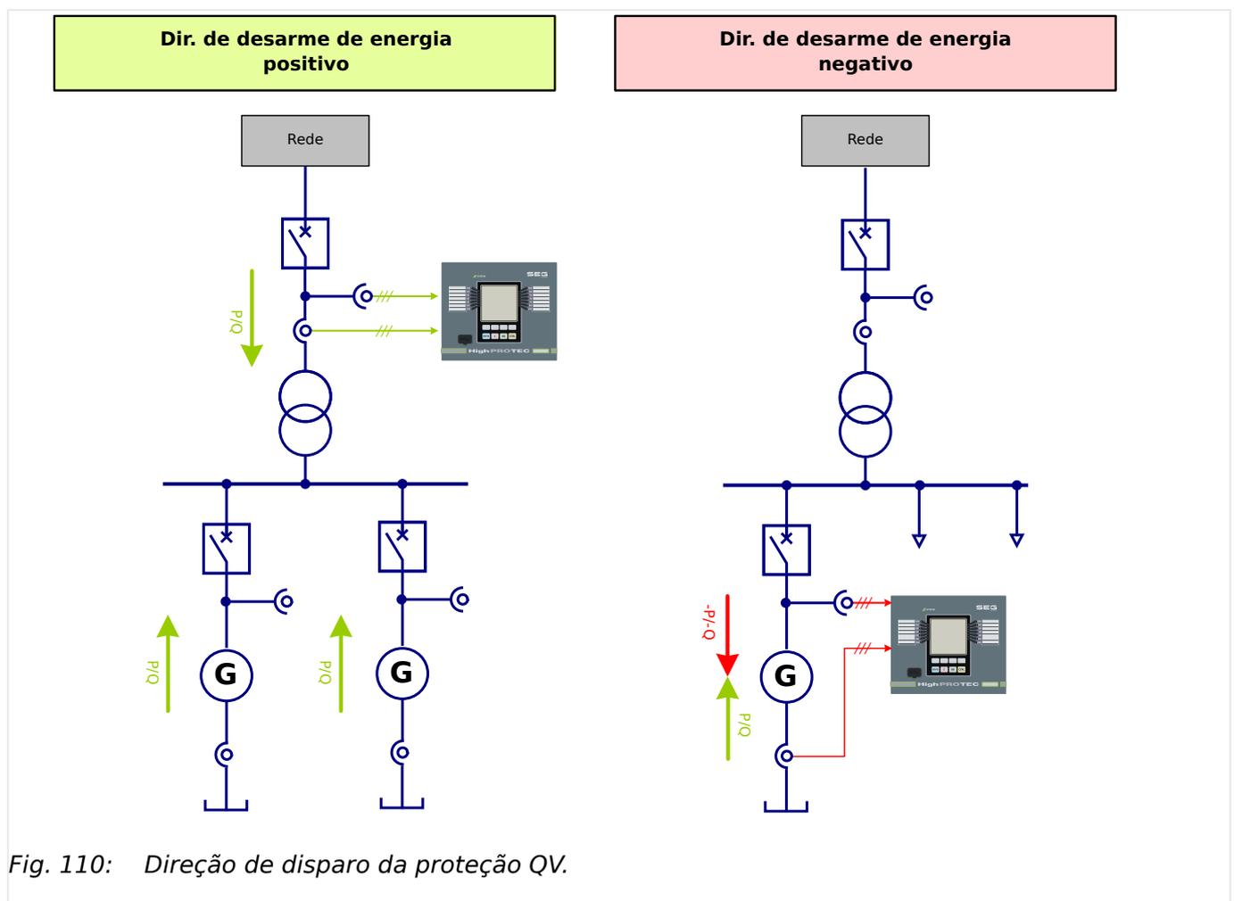
Fig. 110: Direção de disparo da proteção QV.
