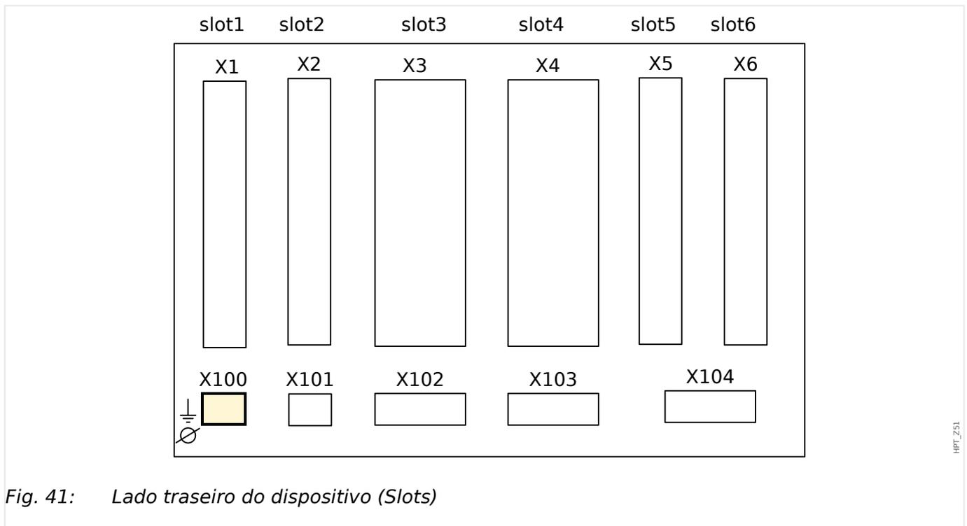
Fig. 41: Lado traseiro do dispositivo (Slots)
