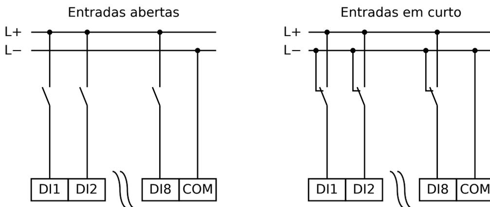
Fig. 152: Estado seguro das entradas digitais
