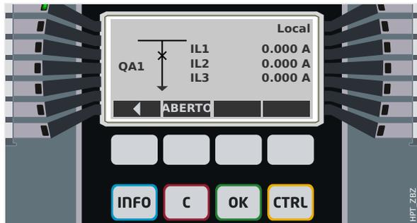
Fig. 132: Exemplo de página de controle, com o "Disjuntor" na posição fechada.
