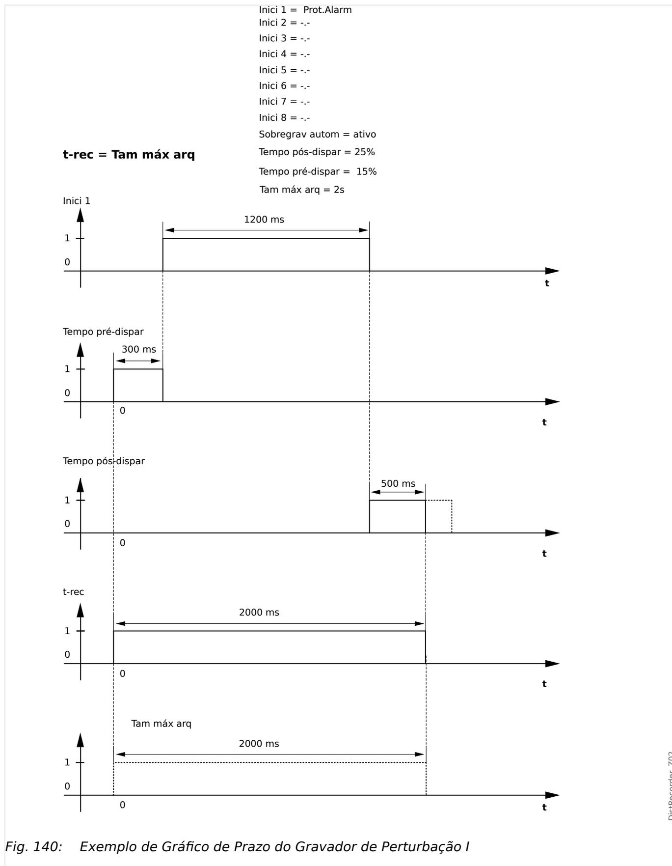
Fig. 140: Exemplo de Gráfico de Prazo do Gravador de Perturbação I
