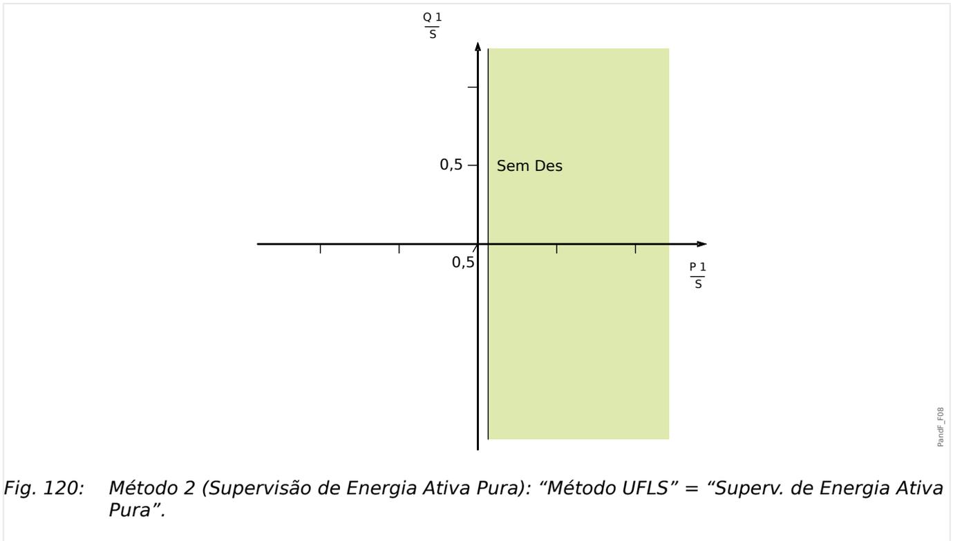
Fig. 120: Método 2 (Supervisão de Energia Ativa Pura): “Método UFLS” = “Superv. de Energia Ativa Pura”.
