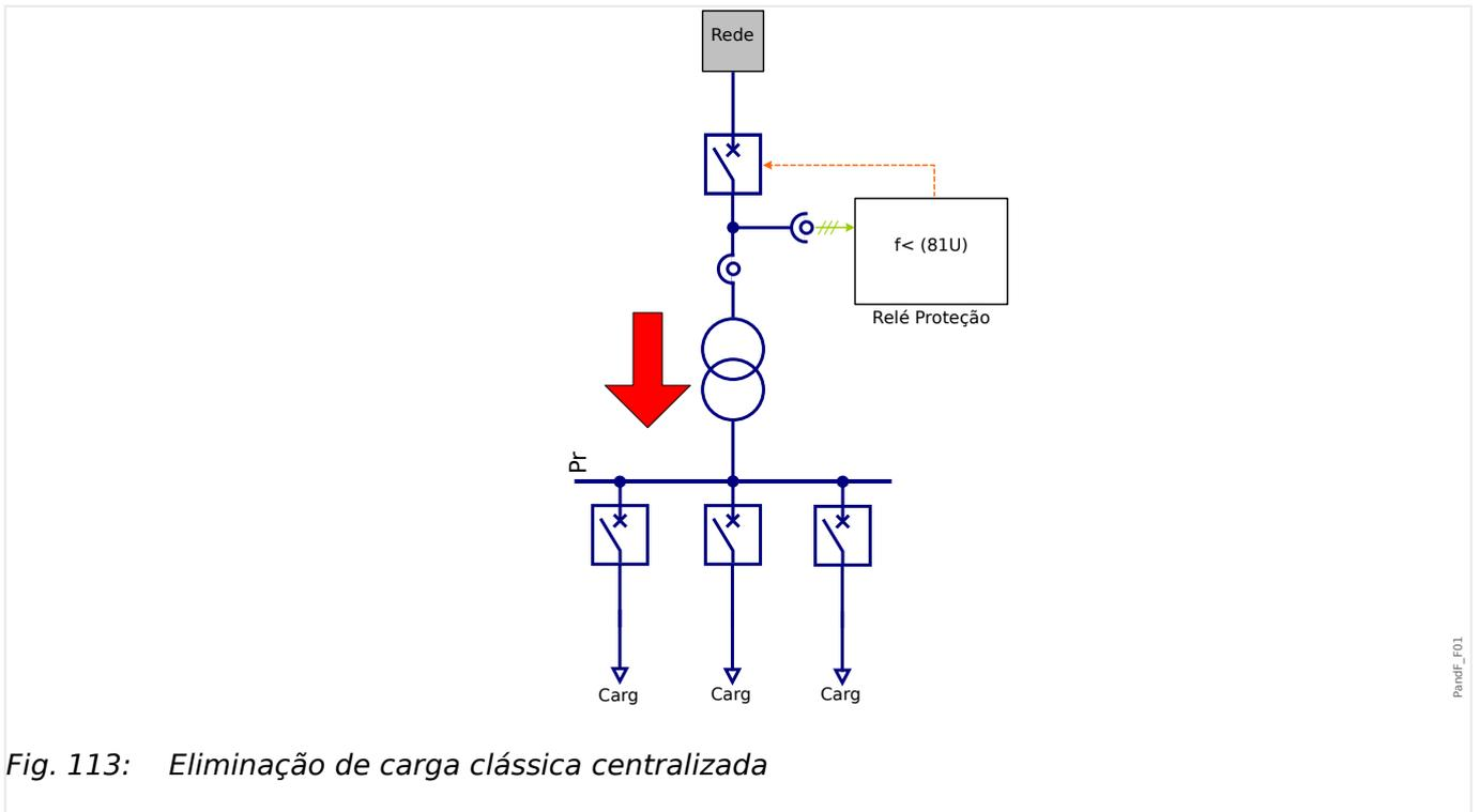
Derramamento de carga clássico de uma sub-rede a partir de um ponto de conexão central. O derramamento de carga será iniciado pela frequência abaixo.
