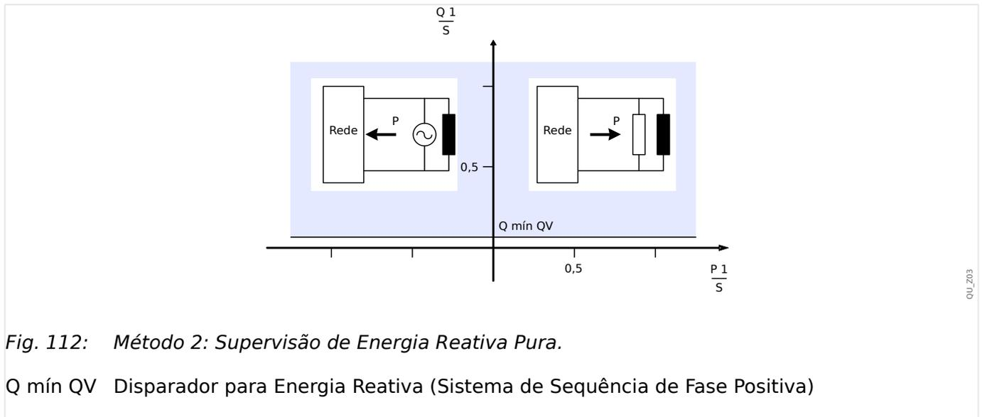
Uma supervisão de corrente mínima ( $I_1$ ) no sistema de sequência de fase positivo previne a hiperfunção da supervisão da energia reativa a um nível de energia mais baixo.
