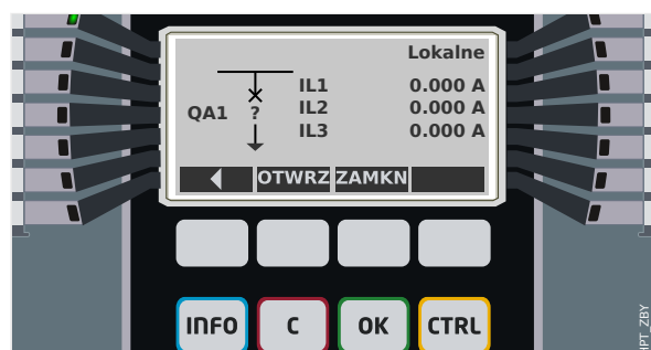
Rys. 123: Przykład strony sterowania z wyłącznikiem w pozycji zakłóconej (lub nieprawidłowej).
