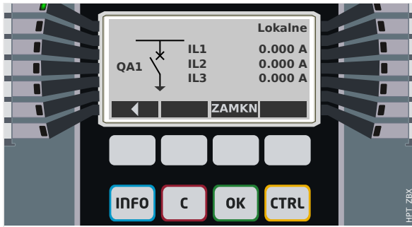
Rys. 124: Przykład strony sterowania z wyłącznikiem w pozycji otwartej.
