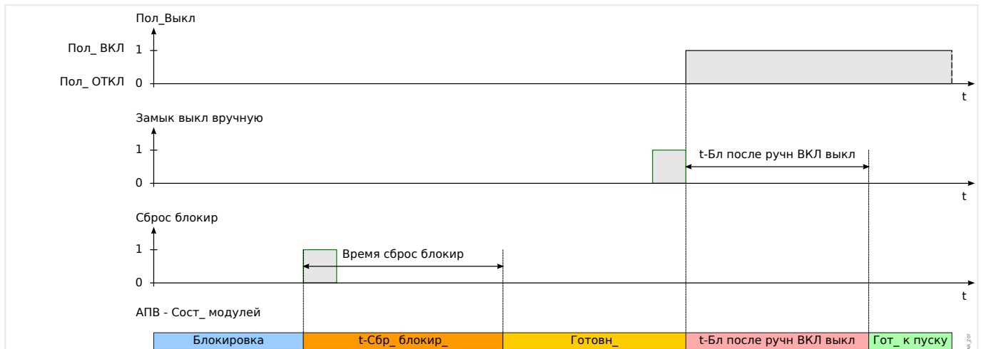
Рис. 106: Логика сброса блокировки АПВ при получении команды сброса блокировки перед замыканием выключателя вручную.
