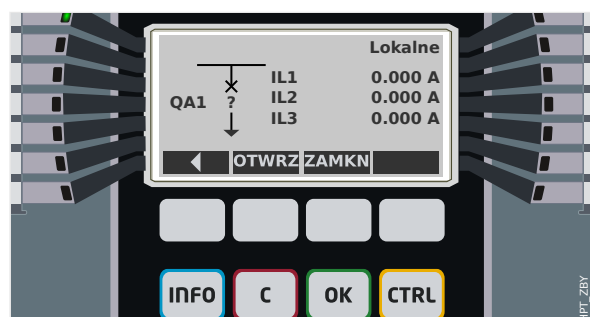
Rys. 144: Przykład strony sterowania z wyłącznikiem w pozycji zakłóconej (lub nieprawidłowej).
