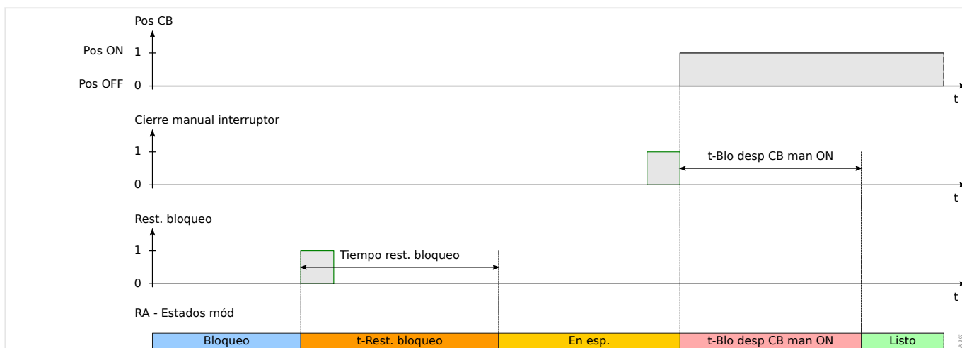
Fig. 106: Lógica de reinicio de bloqueo de AR en caso de que el reinicio de bloqueo llegue antes de que se cierre el interruptor manualmente.
