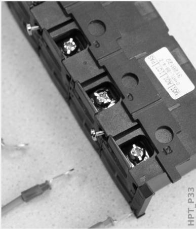
Déplacez le curseur sur le côté, de sorte que les vis et le contact métallique soit totalement accessibles.
