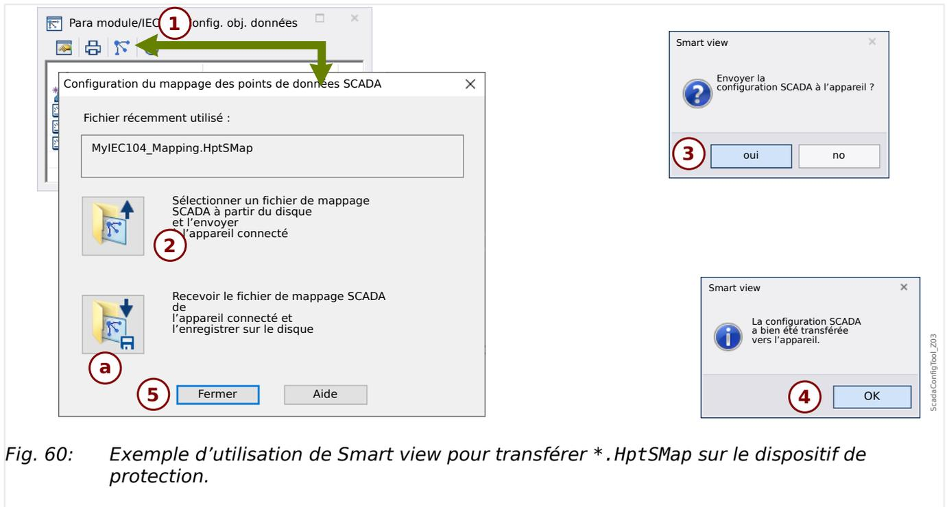
Fig. 60: Exemple d'utilisation de Smart view pour transférer \*.HptSMap sur le dispositif de protection.
