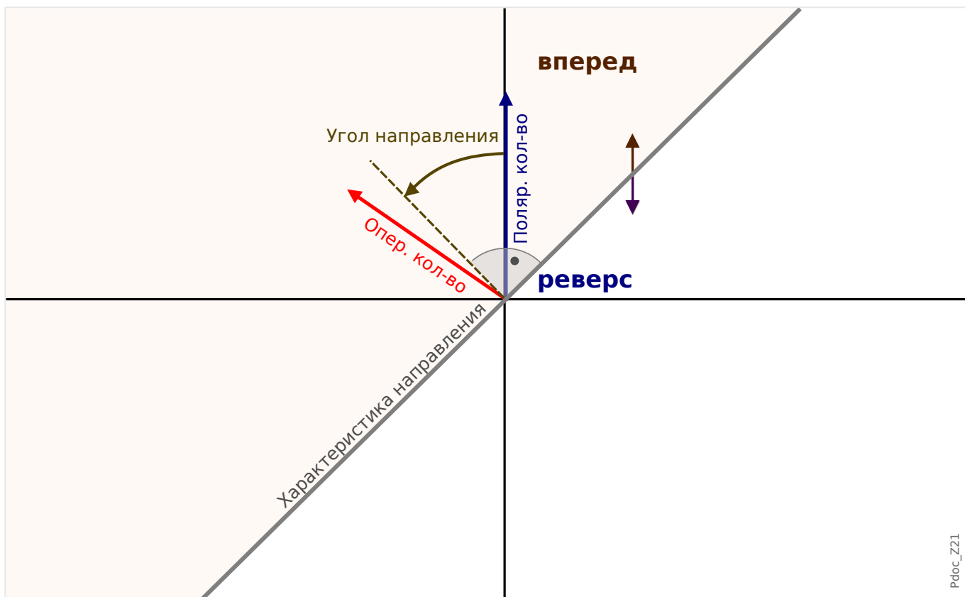
Рис. 63: Принцип определения направления межфазного короткого замыкания.
