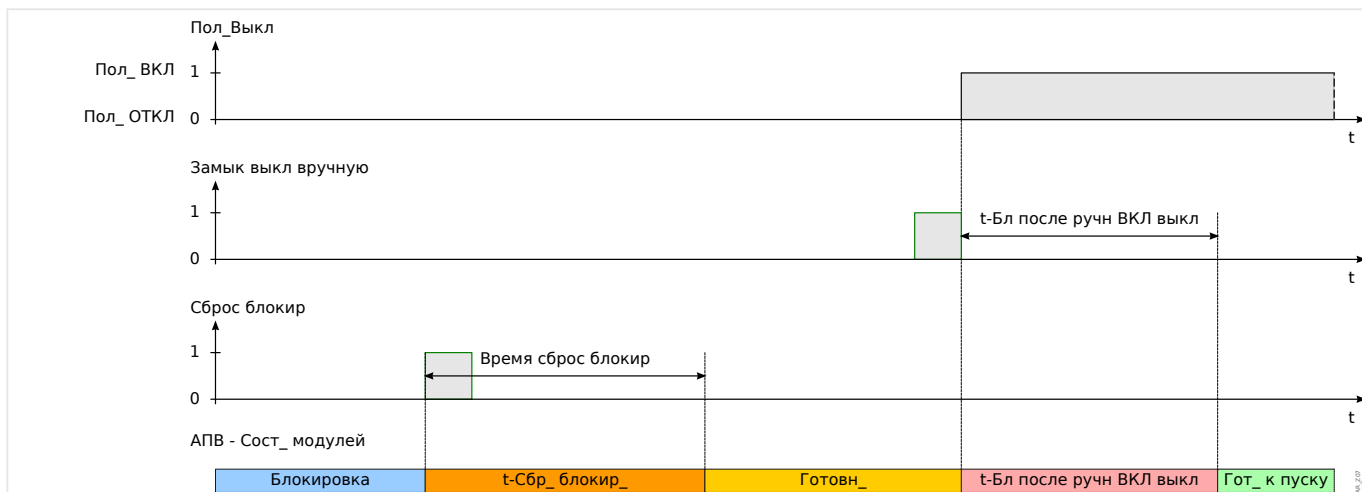
Рис. 96: Логика сброса блокировки АПВ при получении команды сброса блокировки перед замыканием выключателя вручную.
