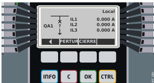
Fig. 134: Ejemplo de página de control, con el circuito en posición de fallo (o improbable).
