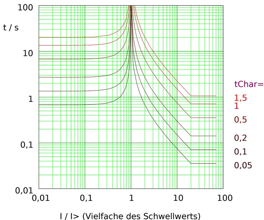
Abb. 119: VINV: Rückfallverzögerung (linke Hälfte,  $I < I_{>}$ ) und Auslöseverzögerung (rechte Hälfte,  $I > I_{>}$ ), Beispieldiagramm für  $I_{max} = 20 \cdot I_{>}$ .
