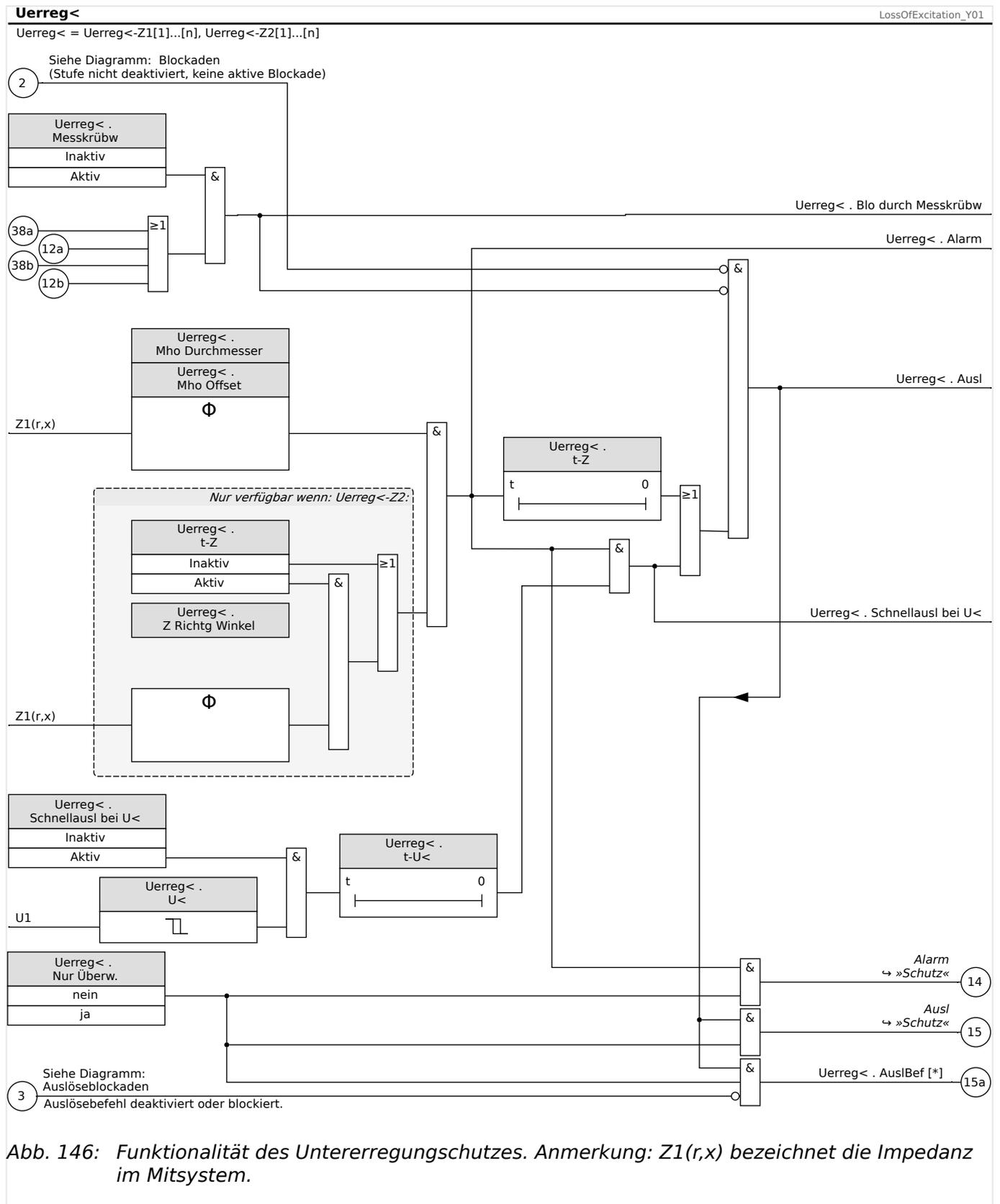
Abb. 146: Funktionalität des Untererregungsschutzes. Anmerkung: Z1(r,x) bezeichnet die Impedanz im Mitsystem.
