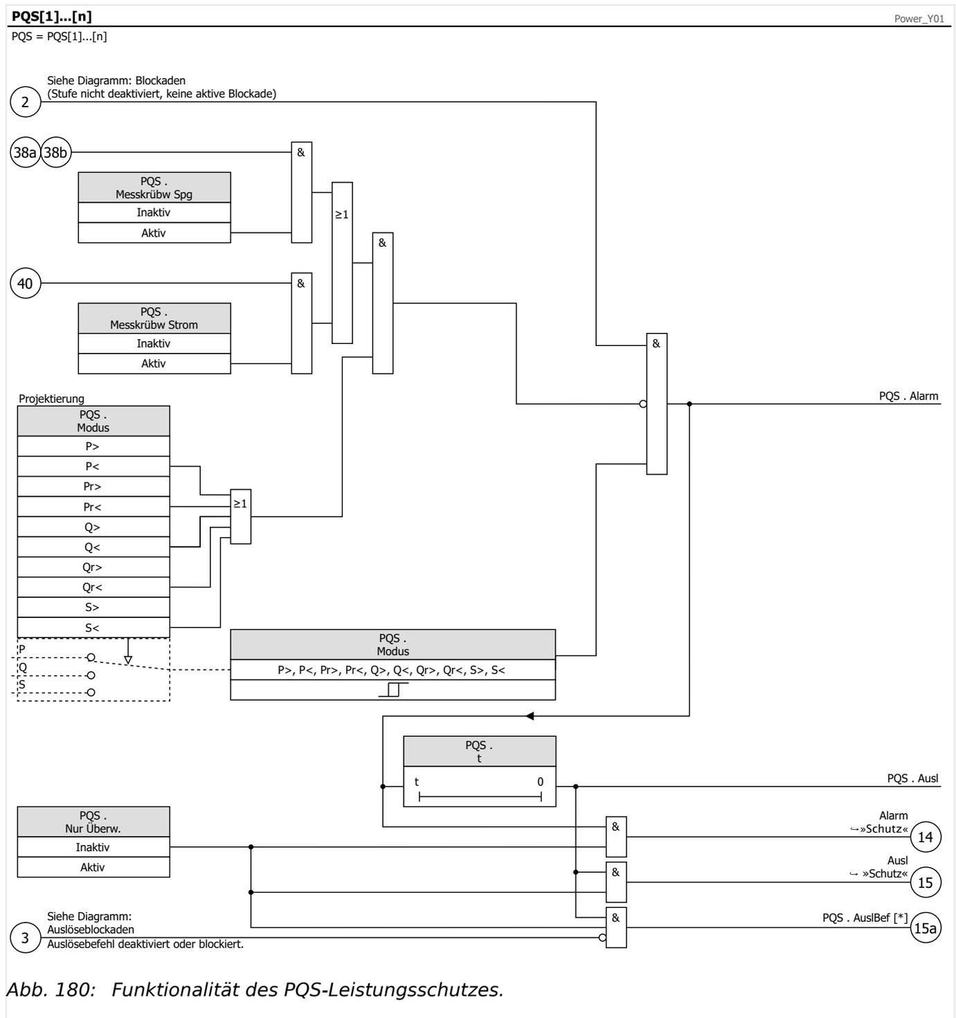
Abb. 180: Funktionalität des PQS-Leistungsschutzes.
