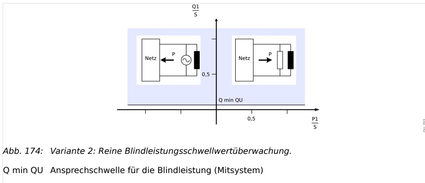
Abb. 174: Variante 2: Reine Blindleistungsschwellwertüberwachung.
