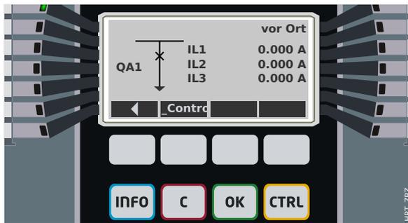
Abb. 190: Beispiel einer Steuer-Seite mit geschlossenem „Leistungsschalter“.
