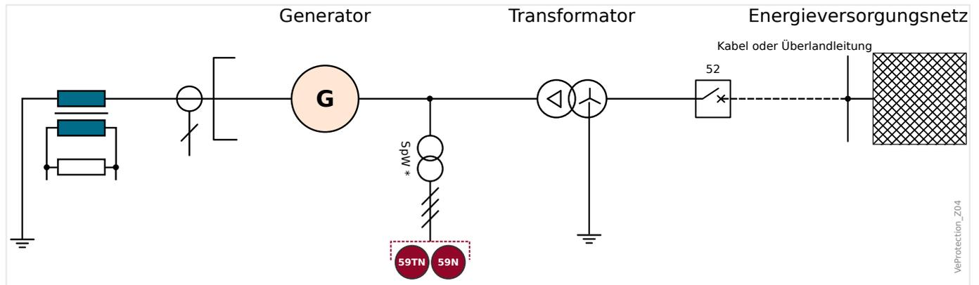
Abb. 160: 100% Stator-Erdfehler-Schutz mittels ANSI 59TN/59N-Kombination.
