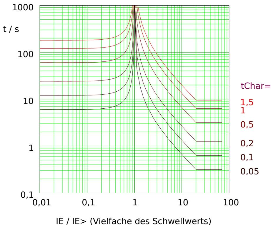
Abb. 133: LINV: Rückfallverzögerung (linke Hälfte,  $IE < I_{E>}$ ) und Auslöseverzögerung (rechte Hälfte,  $IE > I_{E>}$ ), Beispieldiagramm für  $I_{max} = 20 \cdot I_{E>}$ .
