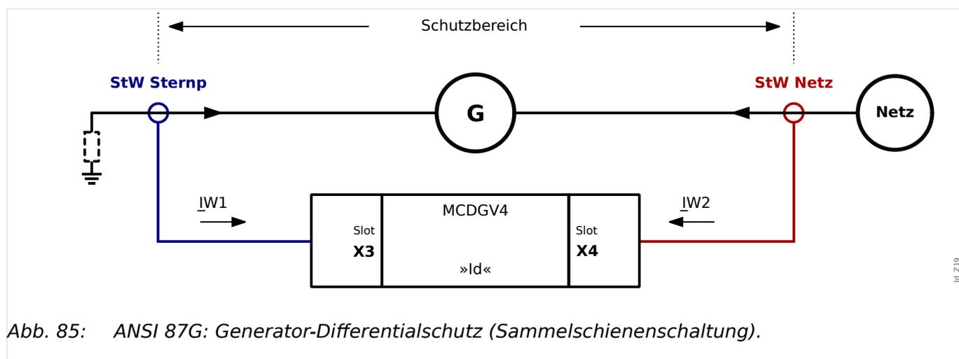
Zu verwenden, wenn nur der Generator gegen Phasenstrom-Differentialfehler geschützt werden soll.
