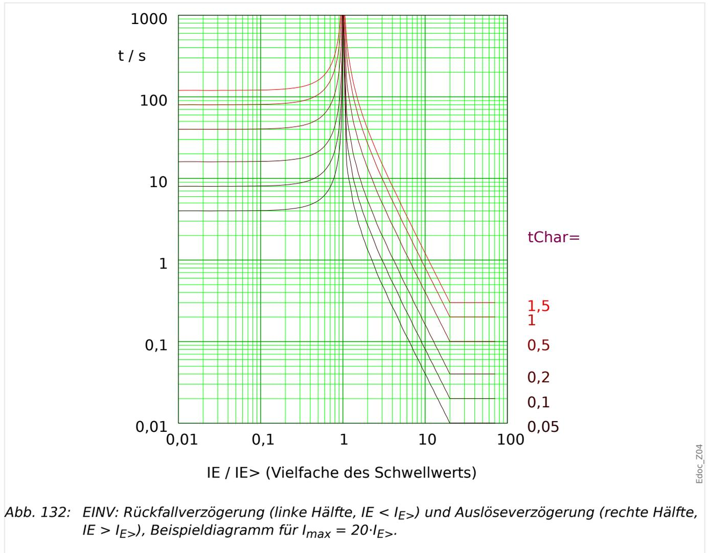
Abb. 132: EINV: Rückfallverzögerung (linke Hälfte,  $IE < I_{E>}$ ) und Auslöseverzögerung (rechte Hälfte,  $IE > I_{E>}$ ), Beispieldiagramm für  $I_{max} = 20 \cdot I_{E>}$ .
