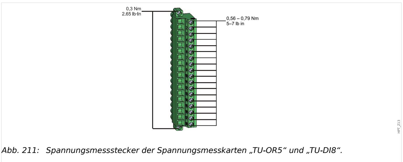
Abb. 211: Spannungsmessstecker der Spannungsmesskarten „TU-OR5“ und „TU-DI8“.
