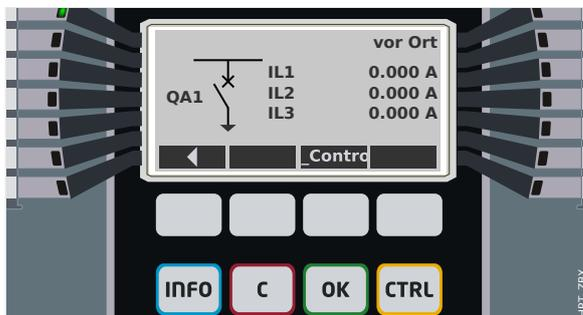
Abb. 192: Beispiel einer Steuer-Seite mit geöffnetem „Leistungsschalter“.
