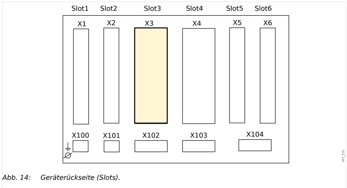
In diesem Slot befinden sich die Strommesseingänge für die Sternpunktseite des Differentialschutzes. In Abhängigkeit der bestellten Gerätevariante ist dies eine Standardstrommesskarte oder eine Messkarte für empfindlichen Erdstrom.
