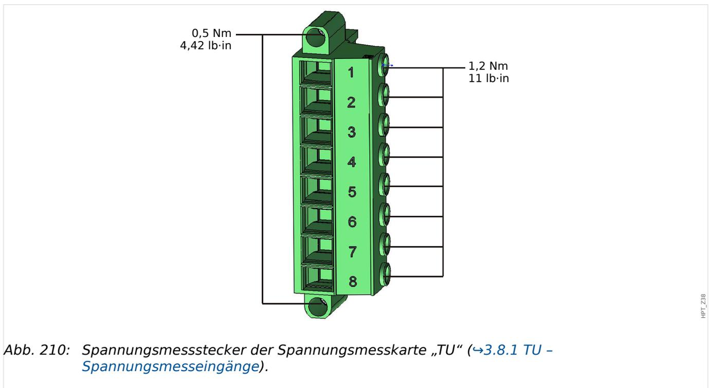
Die folgenden Technischen Daten gelten für 8-polige (große) Spannungsmessstecker.
