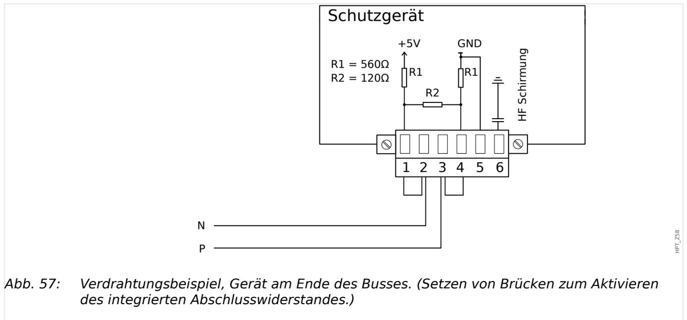
Abb. 57: Verdrahtungsbeispiel, Gerät am Ende des Busses. (Setzen von Brücken zum Aktivieren des integrierten Abschlusswiderstandes.)
