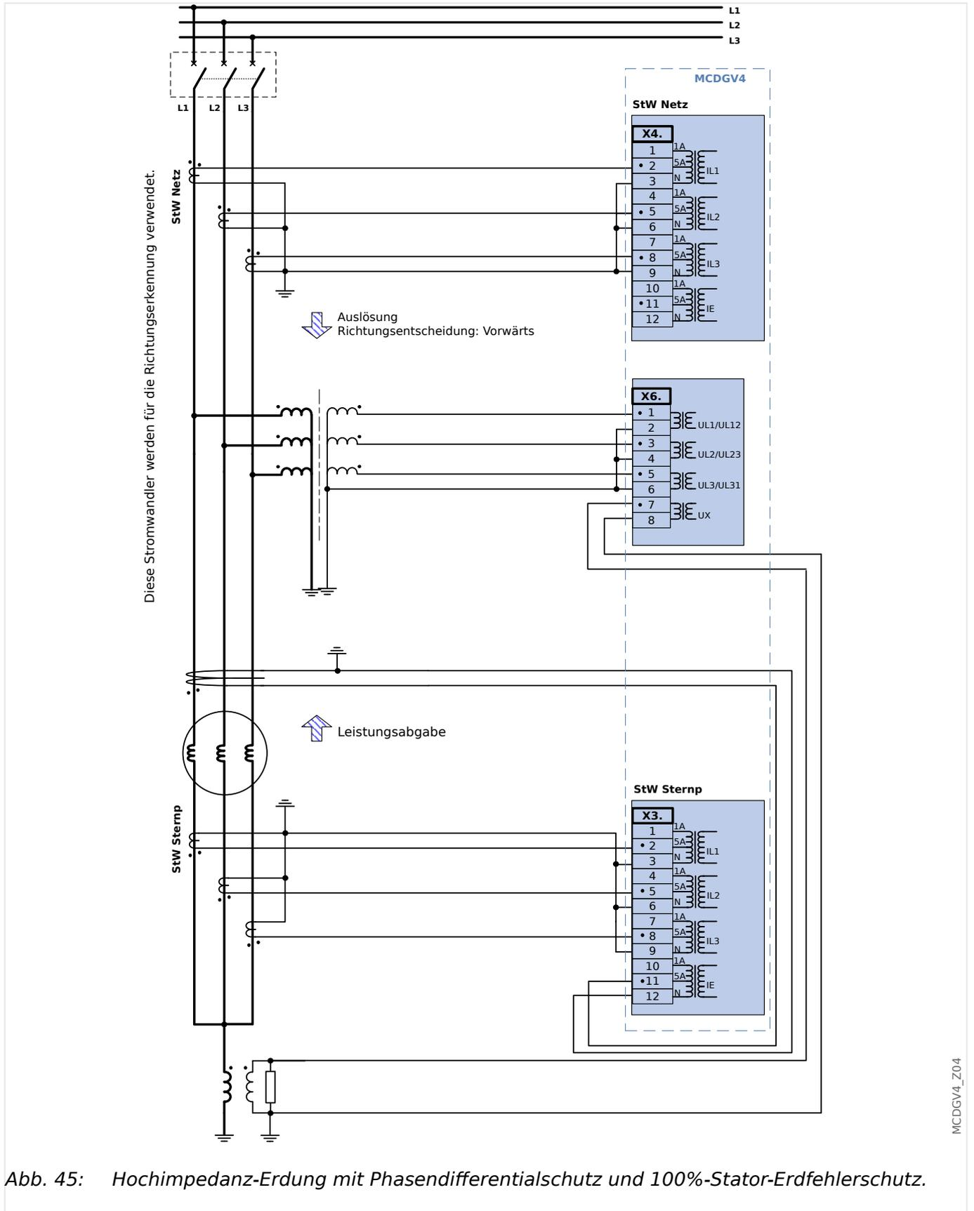
Abb. 45: Hochimpedanz-Erdung mit Phasendifferenzschutz und 100%-Stator-Erdfehlerschutz.
