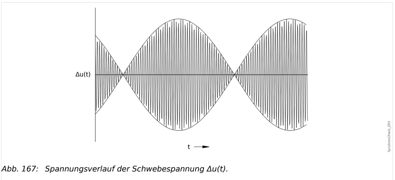
Abb. 167: Spannungsverlauf der Schwebespannung  $\Delta u(t)$ .
