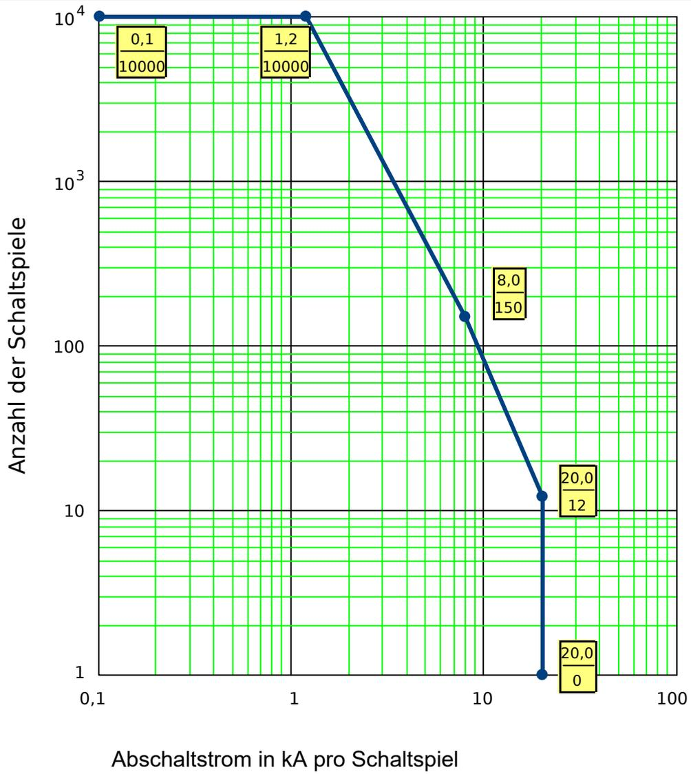
Abb. 195: Wartungskurve für einen typischen 25 kV Leistungsschalter
