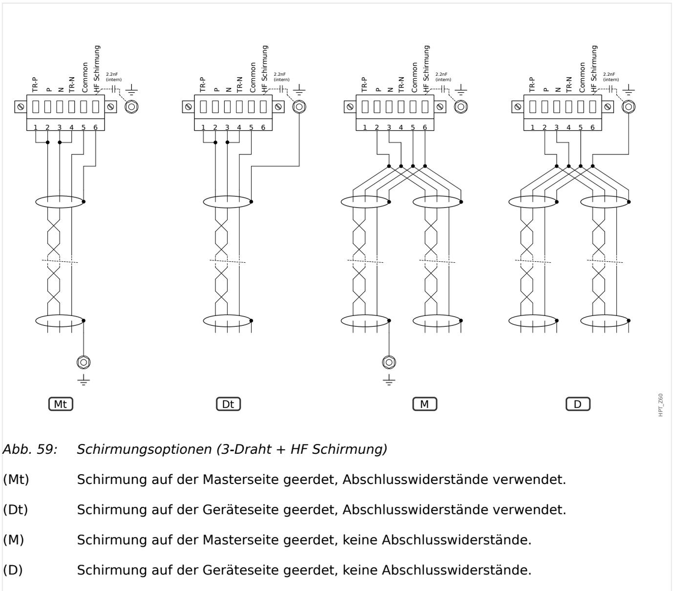
Abb. 59: Schirmungsoptionen (3-Draht + HF Schirmung)
