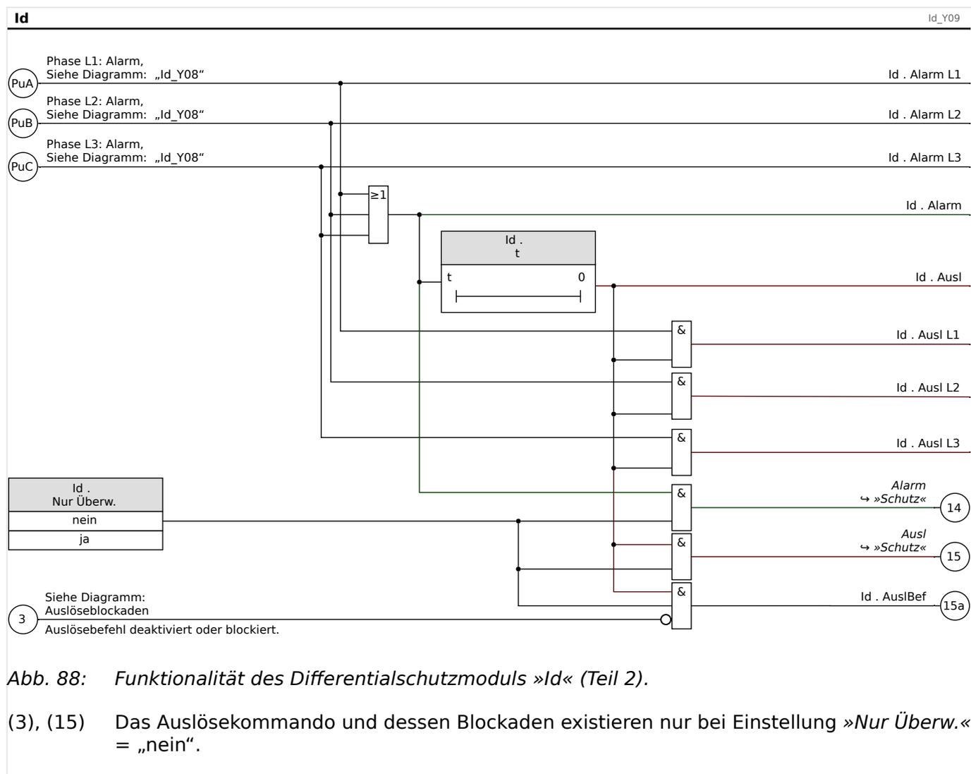
Abb. 88: Funktionalität des Differentialschutzmoduls »Id« (Teil 2).
