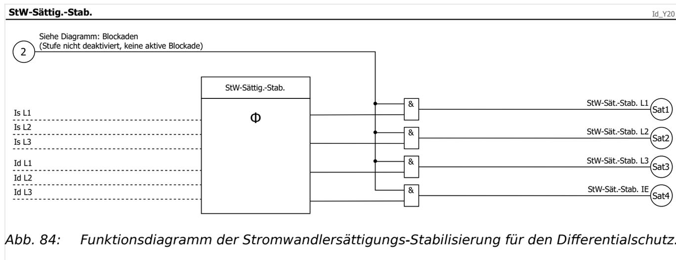
Abb. 84: Funktionsdiagramm der Stromwandlersättigungs-Stabilisierung für den Differentialschutz.
