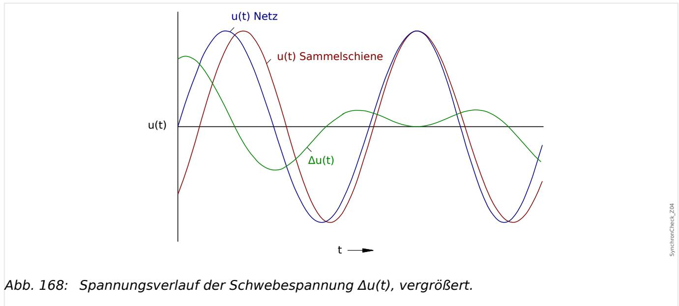
Abb. 168: Spannungsverlauf der Schwebespannung  $\Delta u(t)$ , vergrößert.
