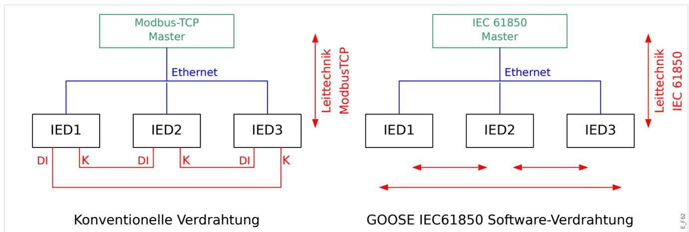
Inbetriebnahmeschritte für eine konventionelle Anlage mit Modbus TCP-Umgebung:
