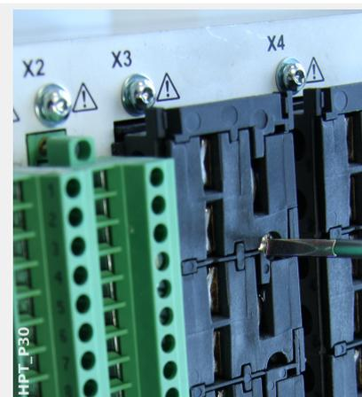
Unabhängig vom Anschlusstyp ist der erste Schritt immer, den Anschlussblock loszuschrauben und vom Schutzgerät zu entfernen.
