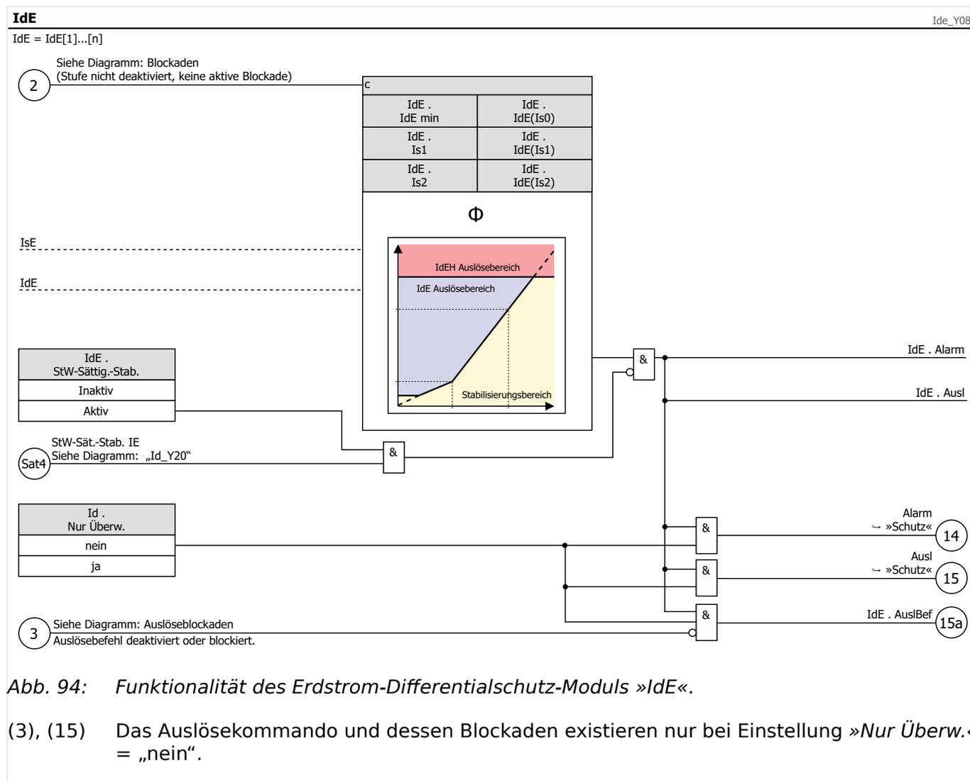
Abb. 94: Funktionalität des Erdstrom-Differentialschutz-Moduls »IdE«.
