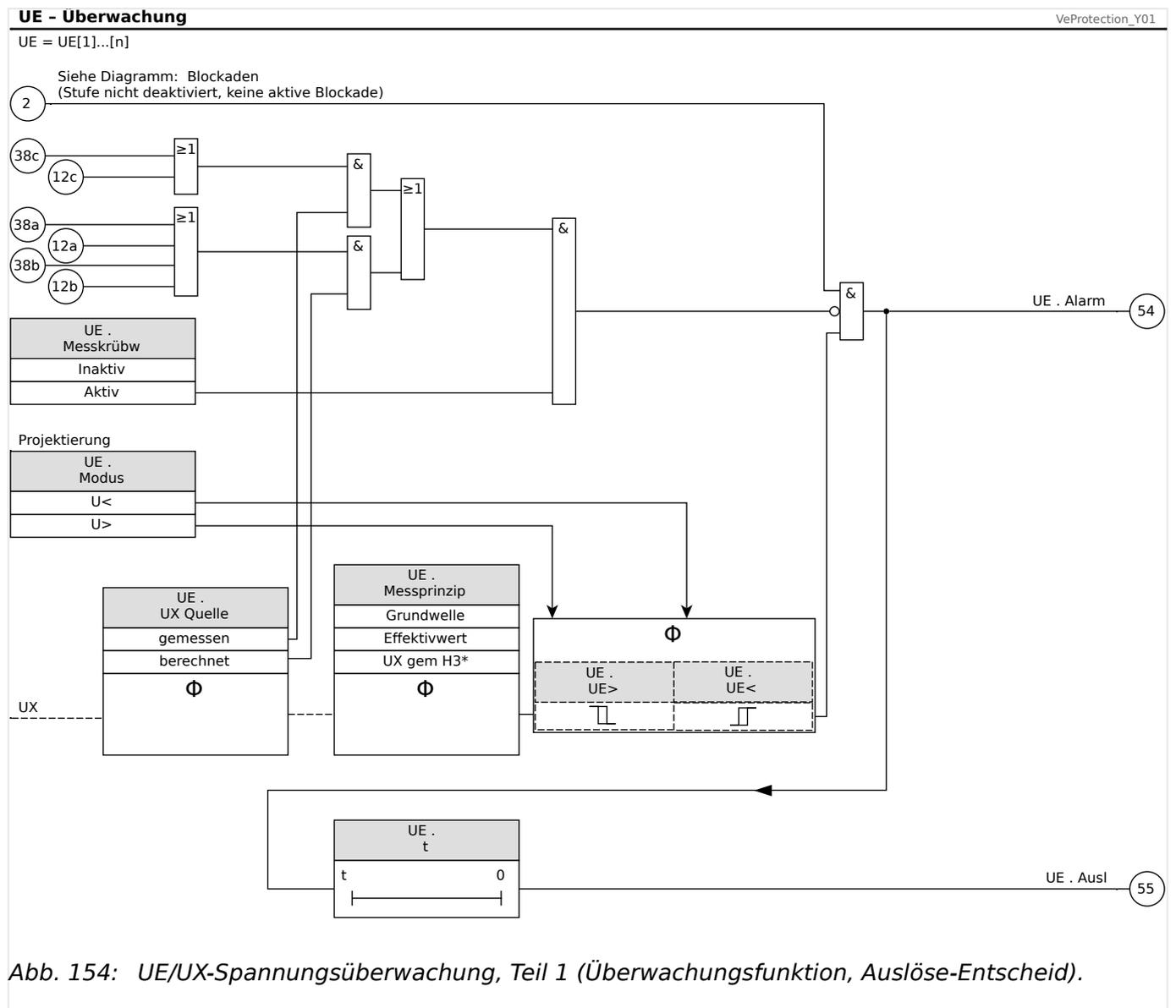
Abb. 154: UE/UX-Spannungsüberwachung, Teil 1 (Überwachungsfunktion, Auslöse-Entscheidung).
