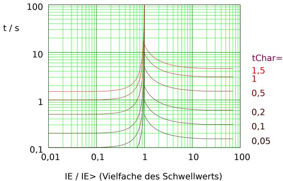
Abb. 134: RINV: Rückfallverzögerung (linke Hälfte,  $IE < I_{E>}$ ) und Auslöseverzögerung (rechte Hälfte,  $IE > I_{E>}$ ), Beispieldiagramm für  $I_{max} = 20 \cdot I_{E>}$ .
