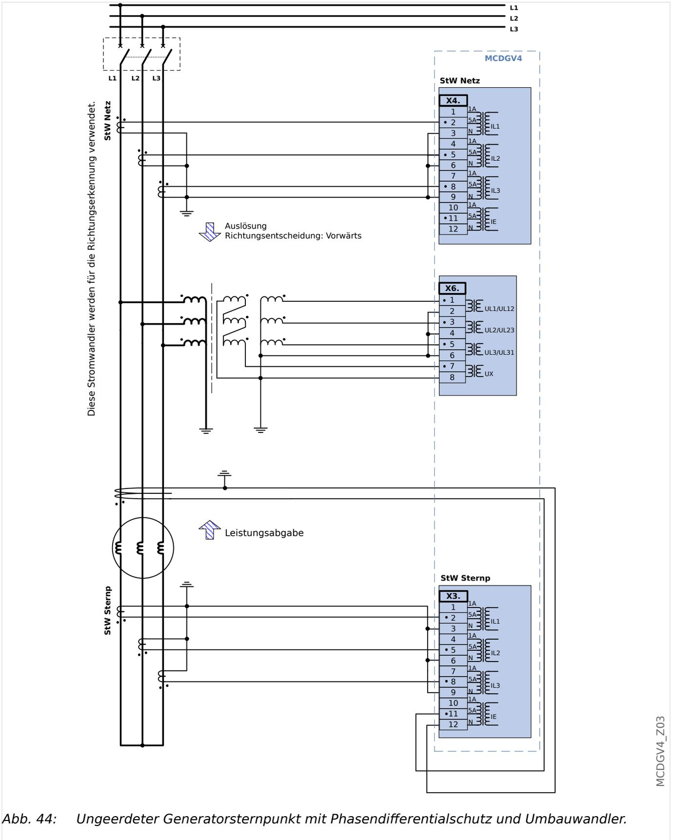
Abb. 44: Ungerdeter Generatorsternpunkt mit Phasendifferenzschutz und Umbauwandler.
