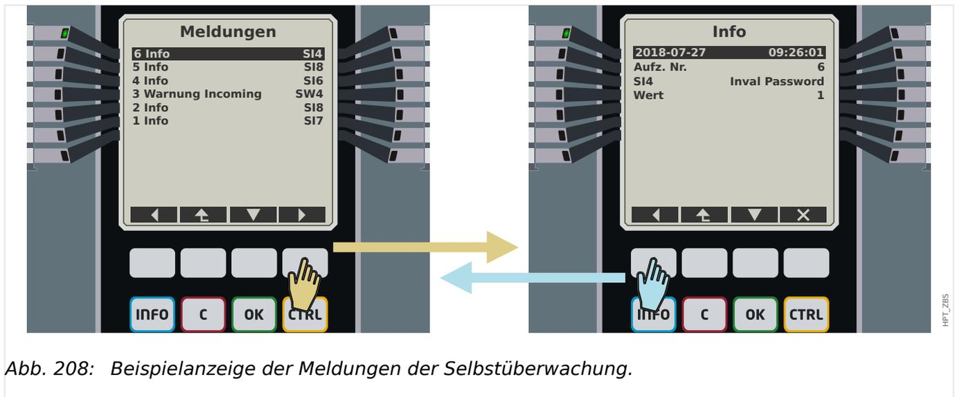
Abb. 208: Beispielanzeige der Meldungen der Selbstüberwachung.
