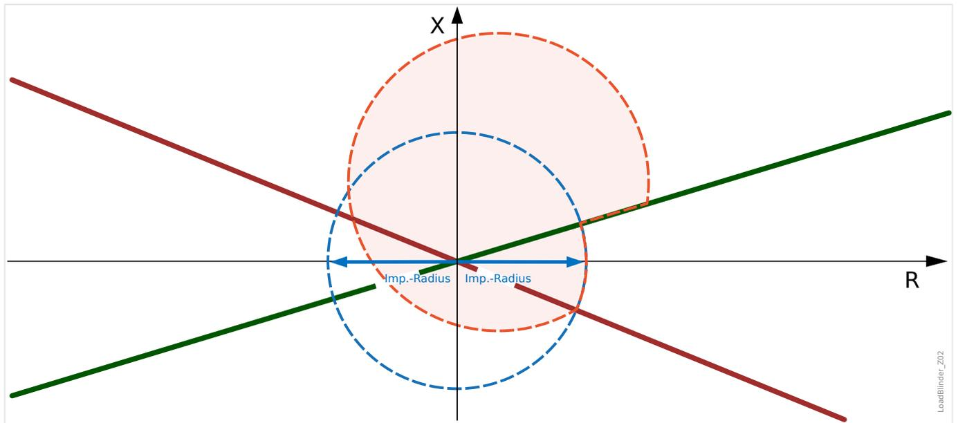
Abb. 116: Auslösebereich des Distanzschutzes (hellrote Fläche) bei aktiver Lastausblendung.
