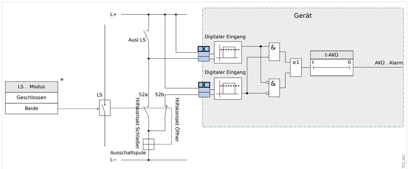
Abb. 185: Anschlussbeispiel (Empfehlung): Auslösekreisüberwachung mit zwei Hilfskontakten »Hiko EIN« (52a) und »Hiko AUS« (52b).
