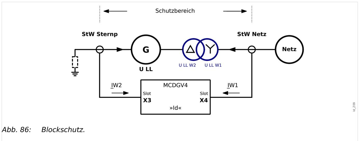
Zu verwenden, wenn der Generator **und** der Blocktransformator als ein einziges Phasenstrom-Differenzmodul geschützt werden sollen.
