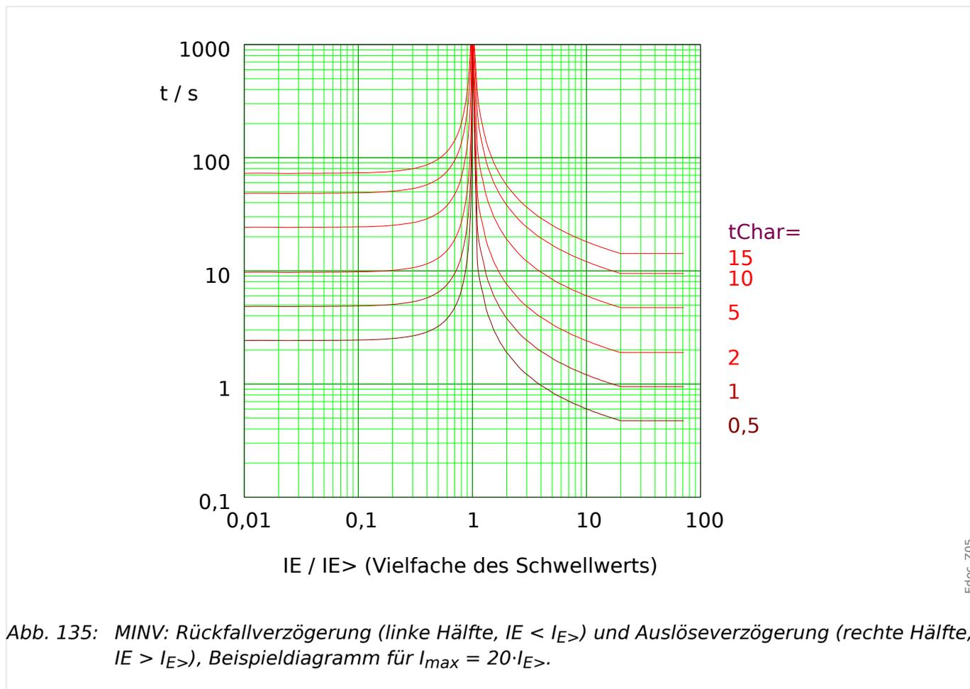
Abb. 135: MINV: Rückfallverzögerung (linke Hälfte,  $IE < I_{E>}$ ) und Auslöseverzögerung (rechte Hälfte,  $IE > I_{E>}$ ), Beispieldiagramm für  $I_{max} = 20 \cdot I_{E>}$ .
