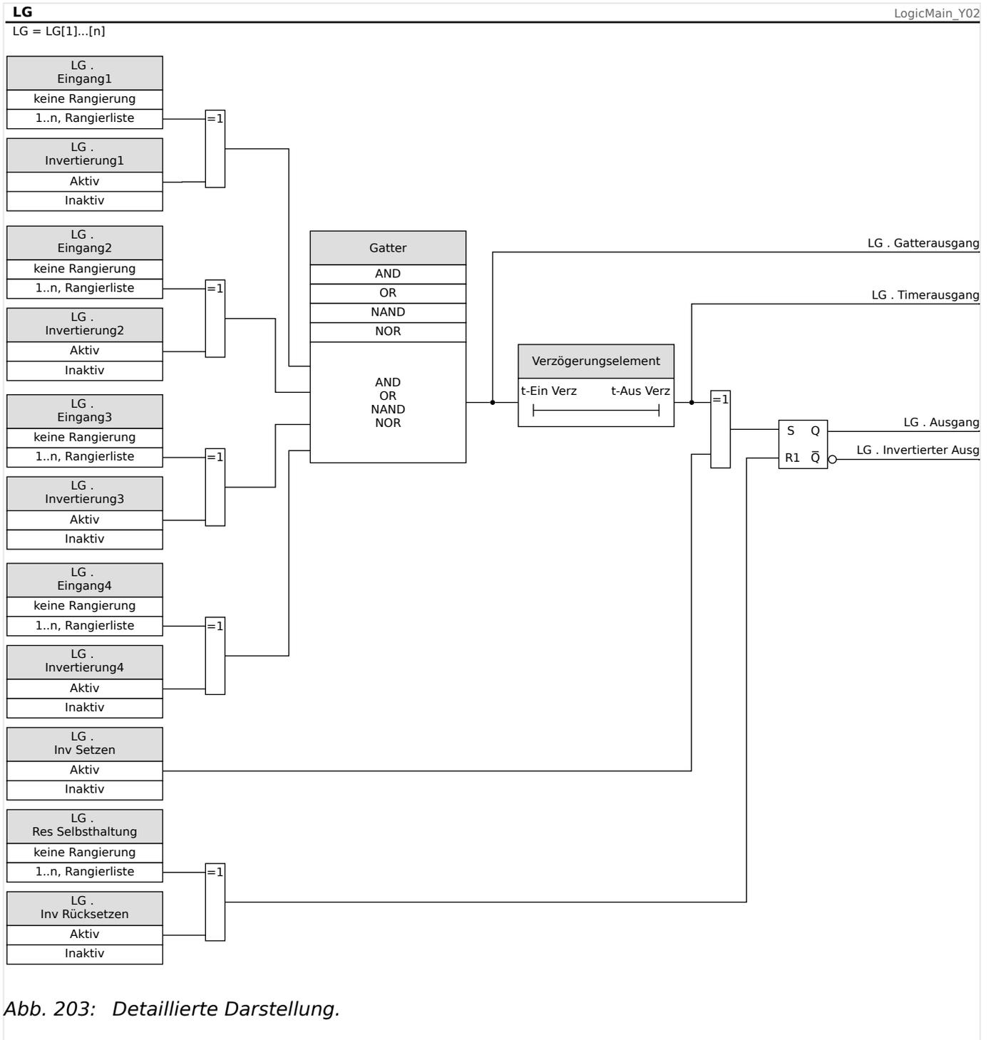
**Verfügbare Logikgatter (Operatoren)**
