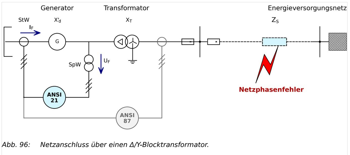
Abb. 96: Netzanschluss über einen  $\Delta/Y$ -Blocktransformator.
