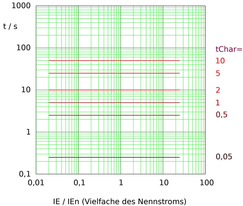
Abb. 139: Auslösekurve „Therm Flat“, wobei nur der Bereich  $IE > I_{E>}$  jeweils anwendbar ist. Beispieldiagramm für gemessenen (nicht empfindlichen) Erdstrom.
