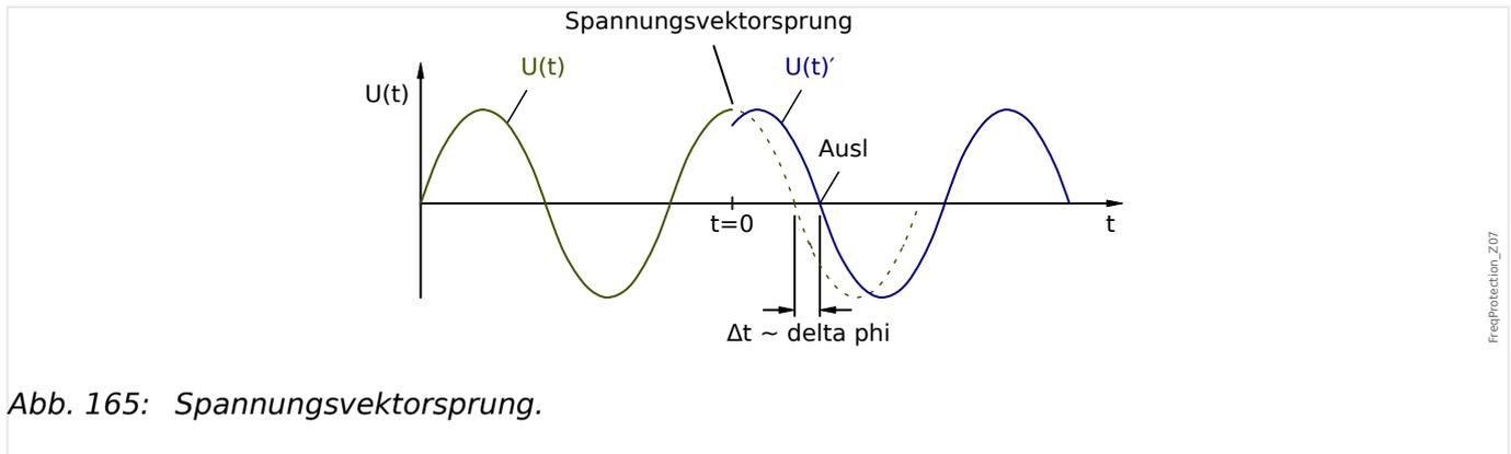
Abb. 165: Spannungsvektorsprung.
