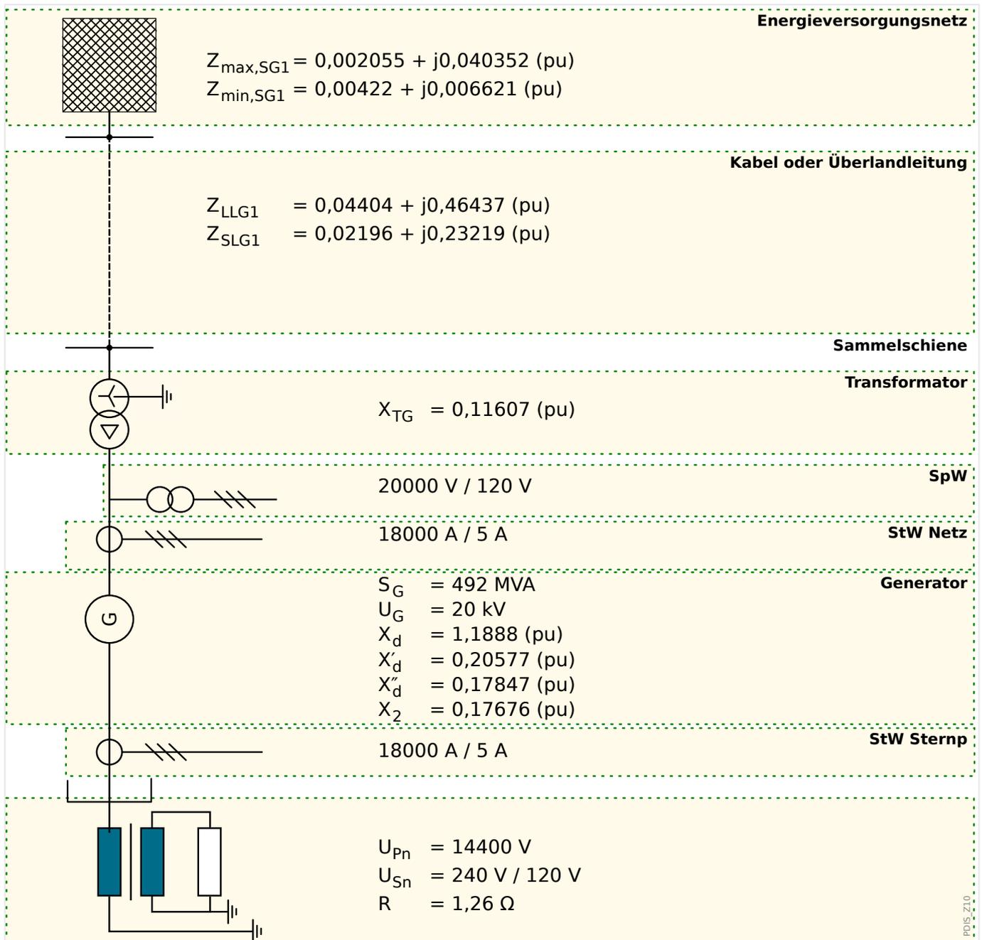
Abb. 106: Abzweigbild mit generatorbasierten Daten.
