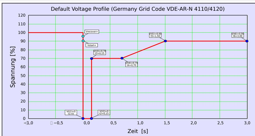
Abb. 179: LVRT-Werkseinstellung (Typ I).
