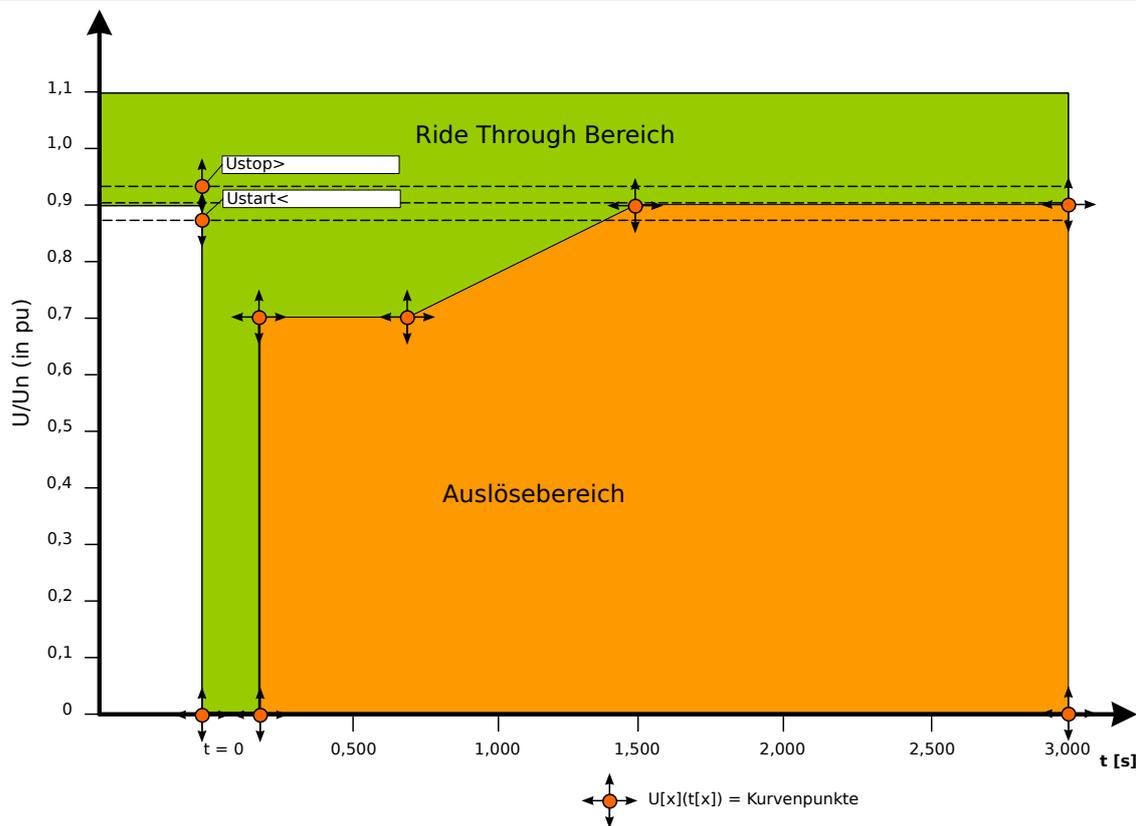
Abb. 178: Spannungs-Zeit-Profil und Auslösebereich.
