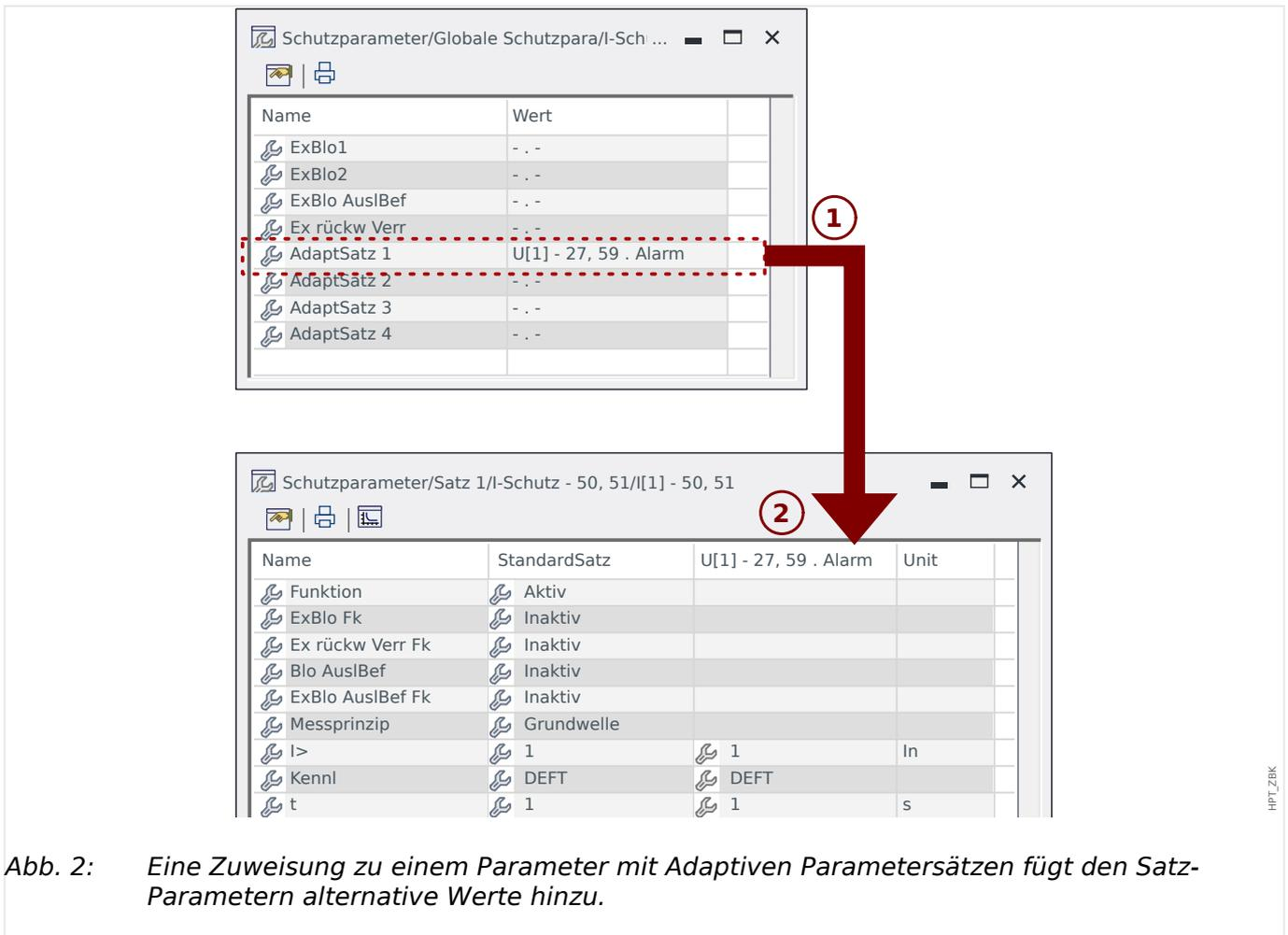
Durch diese Zuweisung eines Adaptiven Parametersatzes bekommen die meisten Satz-Parameter einen neuen, alternativen Einstellwert. Zunächst ist dieser gleich demjenigen für den „StandardSatz“, kann aber in üblicher Weise (durch Doppelklick) angepasst werden.
