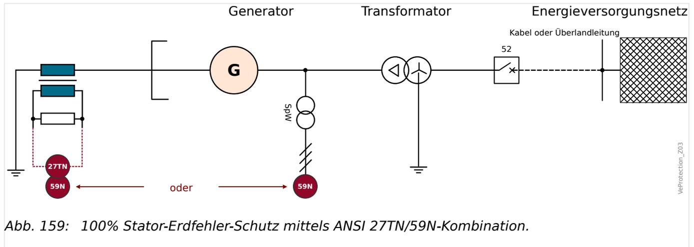
Abb. 159: 100% Stator-Erdfehler-Schutz mittels ANSI 27TN/59N-Kombination.
