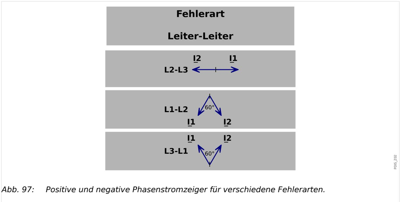
Abb. 97: Positive und negative Phasenstromzeiger für verschiedene Fehlerarten.
