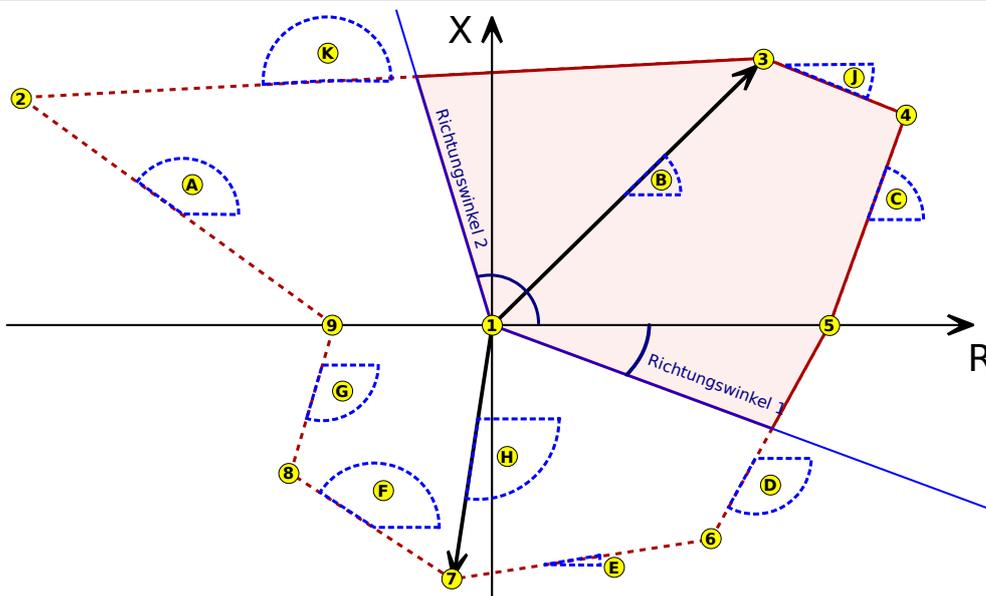
Abb. 102: Impedanzcharakteristik (hellrote Fläche) vom Typ Polygon mit aktivierter Richtungserfassung.
