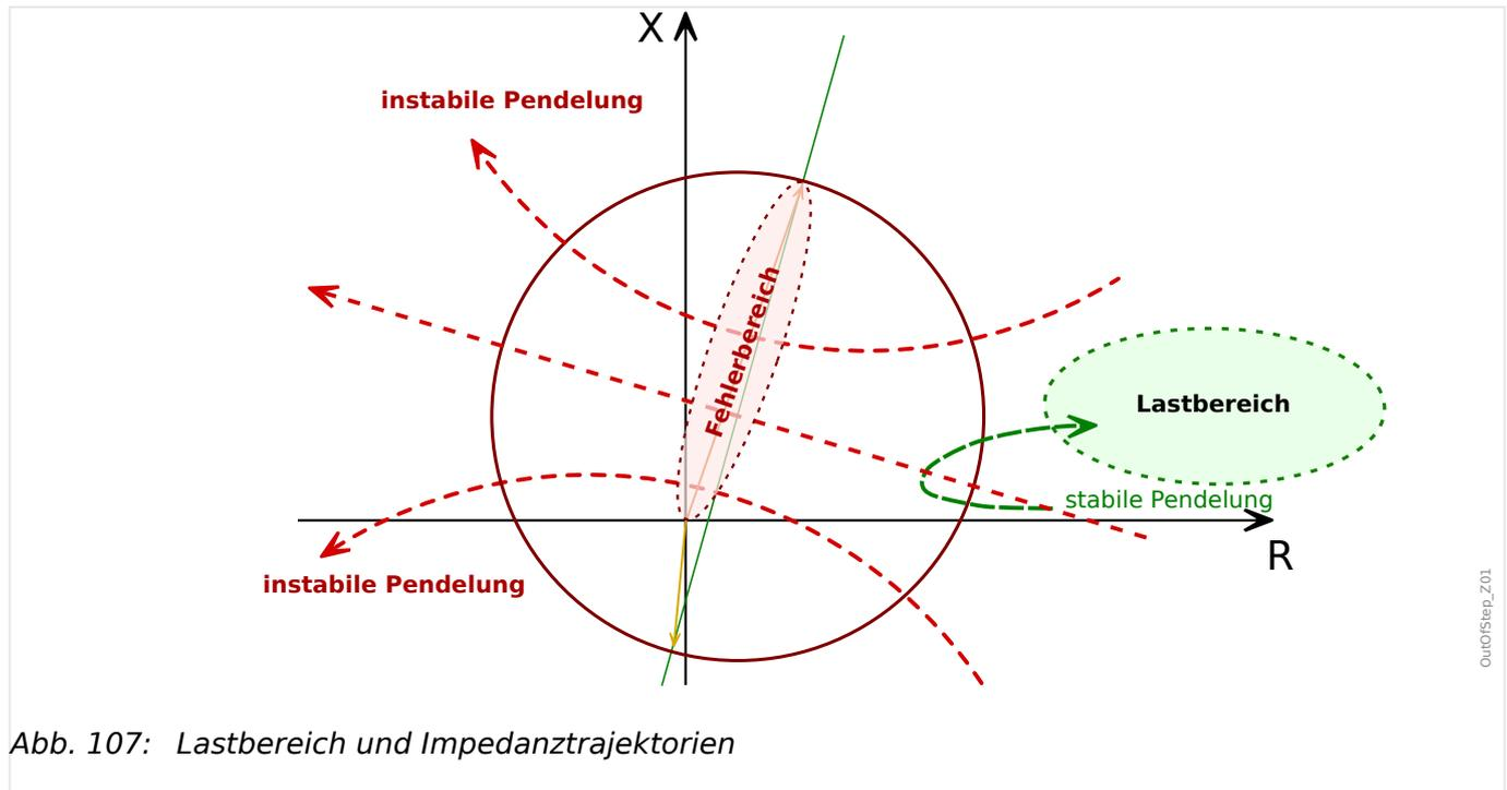
Abb. 107: Lastbereich und Impedanztrajektorien
