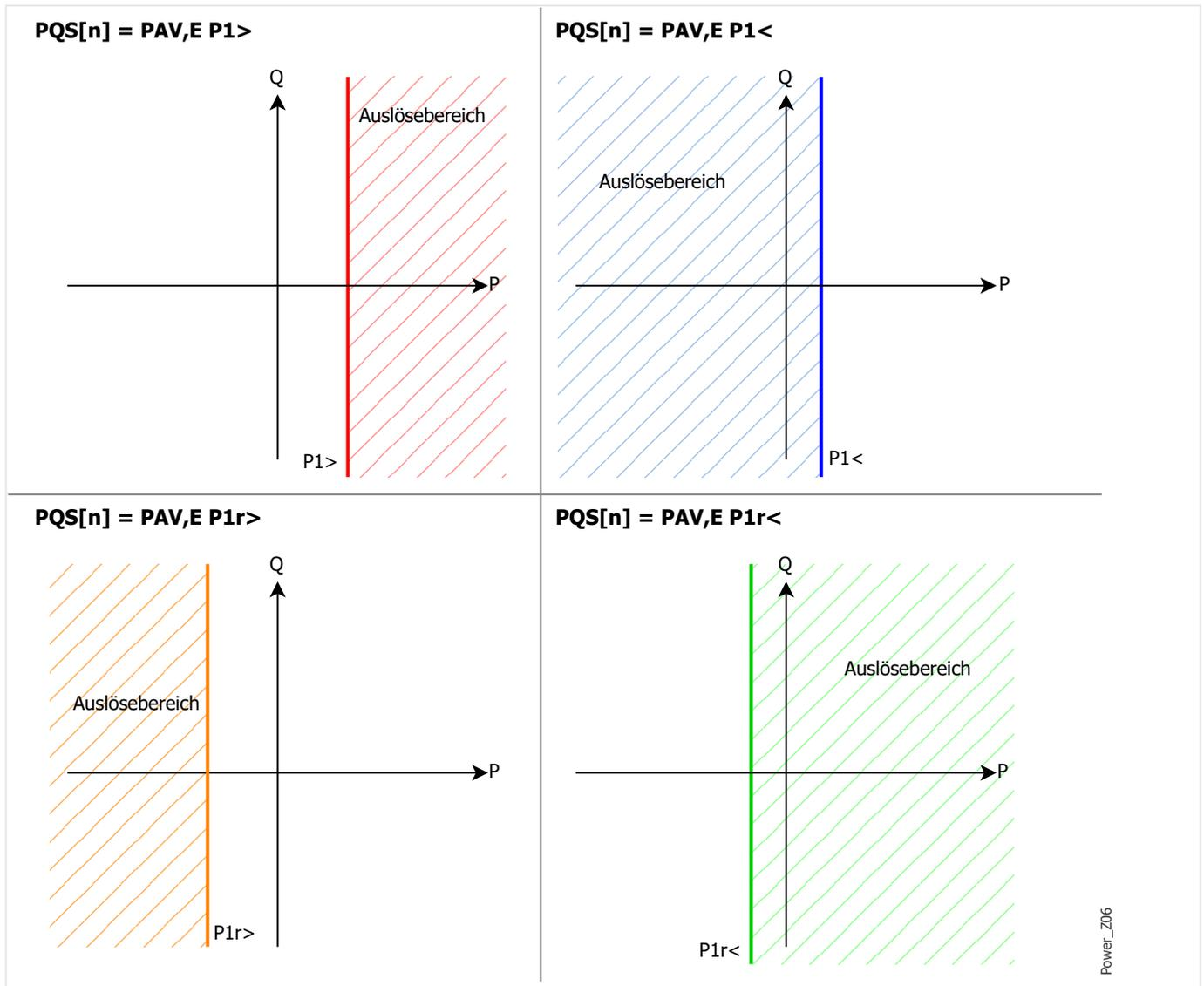
Die Überwachung muss am Netzanschlusspunkt erfolgen.
