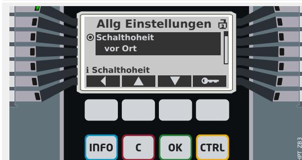
Durch Betätigen des „Modus“-Softkey erreicht man den Menüzwig [Steuerung / Allg Einstellungen].
