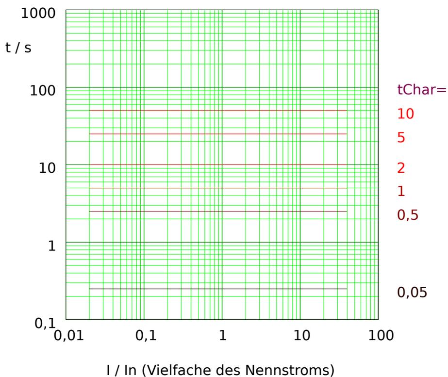
Abb. 126: Auslösekurve „Therm Flat“, wobei nur der Bereich  $I > I_{>}$  jeweils anwendbar ist.
