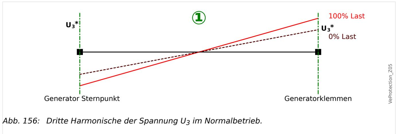
Abb. 156: Dritte Harmonische der Spannung  $U_3$  im Normalbetrieb.
