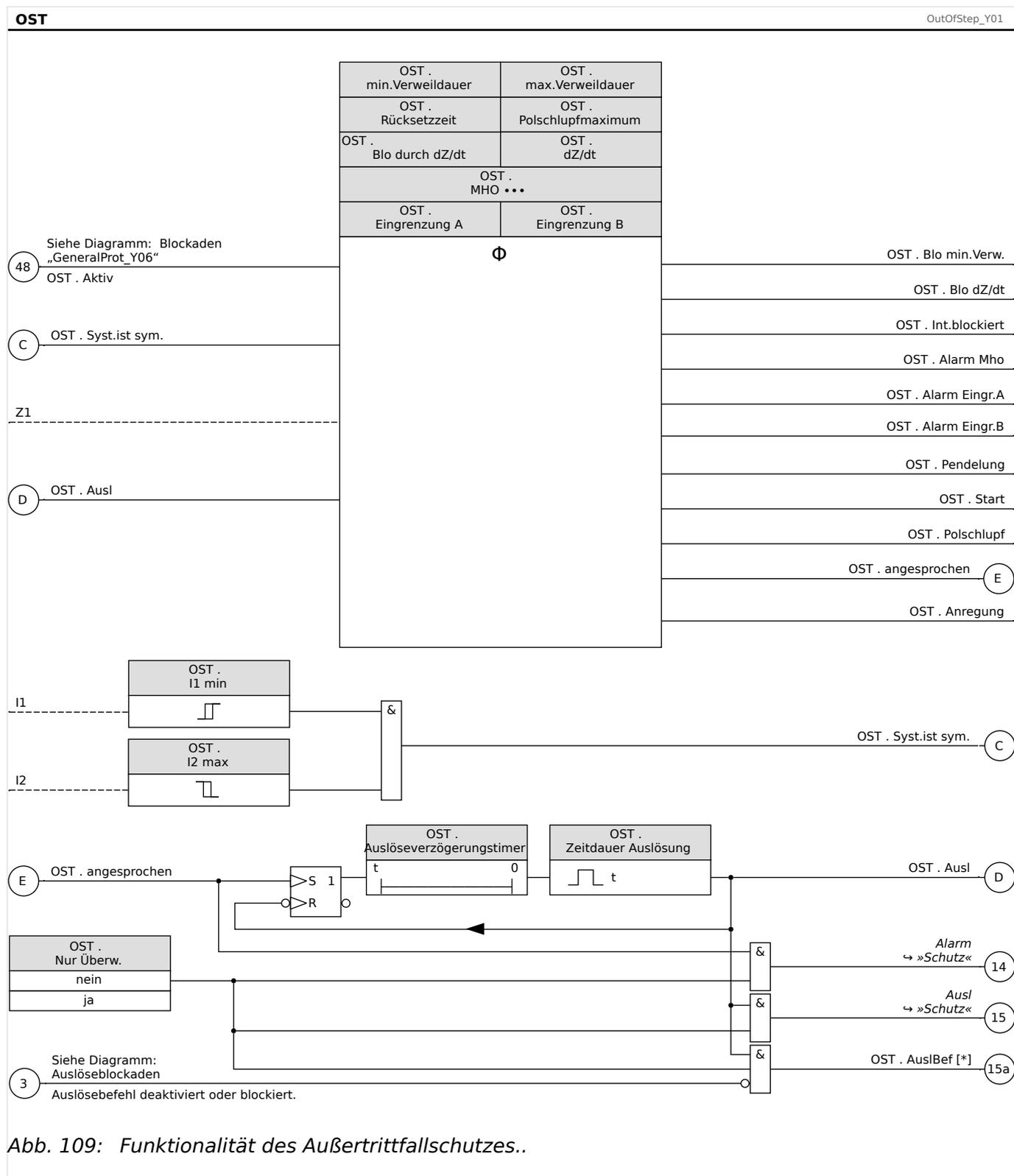
Abb. 109: Funktionalität des Außertrittfallschutzes..
