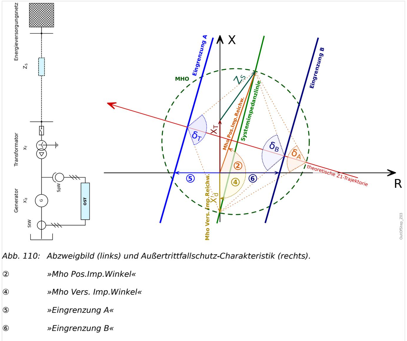
Abb. 110: Abzweigbild (links) und Außertrittfallschutz-Charakteristik (rechts).
