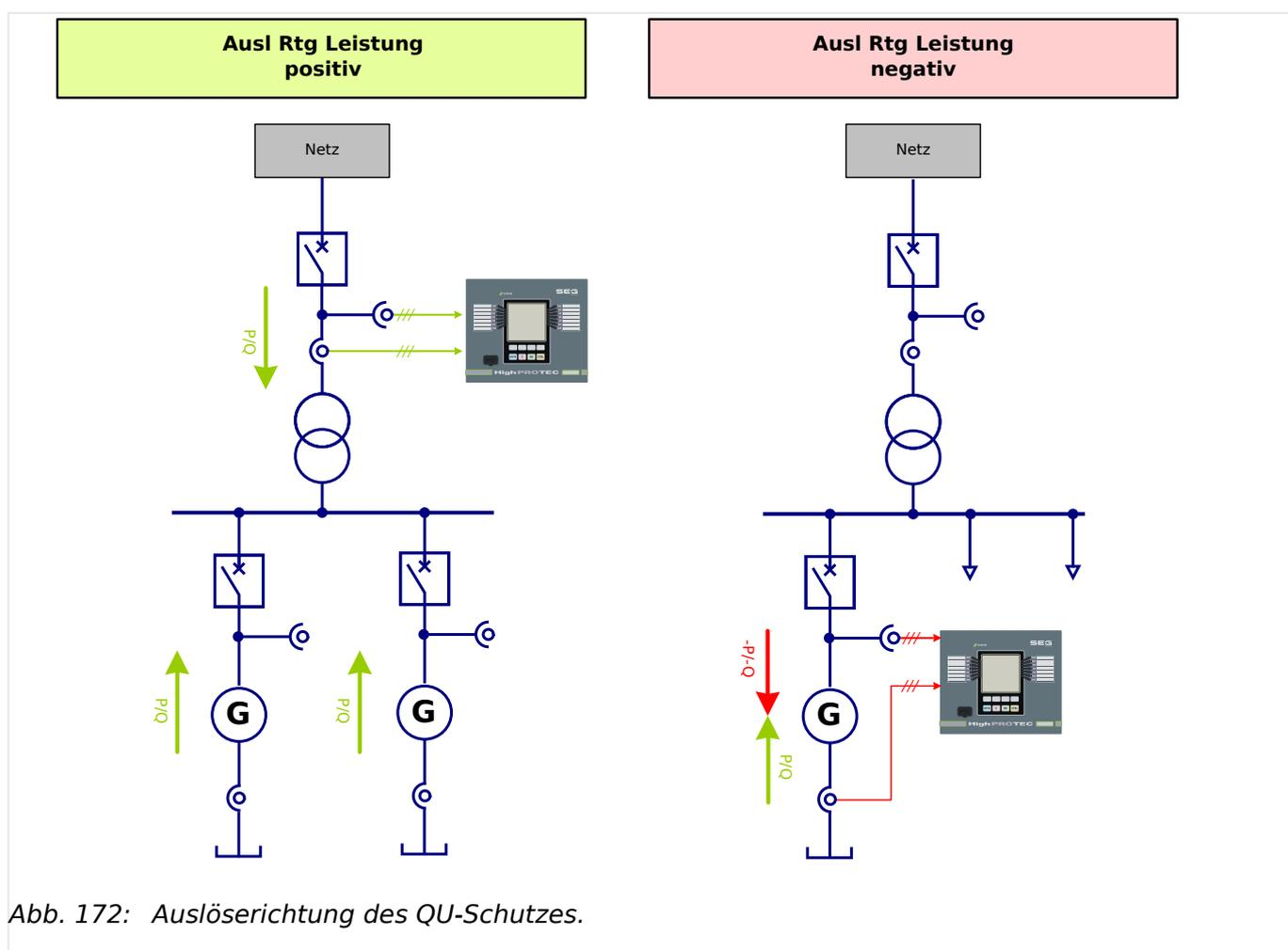
Abb. 172: Auslöserichtung des QU-Schutzes.
