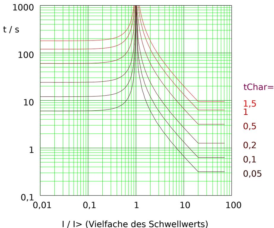
Abb. 121: LINV: Rückfallverzögerung (linke Hälfte,  $I < I_n$ ) und Auslöseverzögerung (rechte Hälfte,  $I > I_n$ ), Beispieldiagramm für  $I_{max} = 20 \cdot I_n$ .
