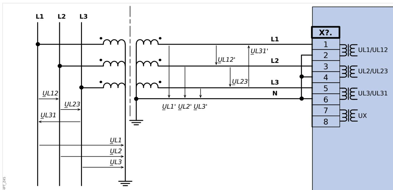
Abb. 38: Drei Spannungswandler mit Geräteanschluss in Sternschaltung
