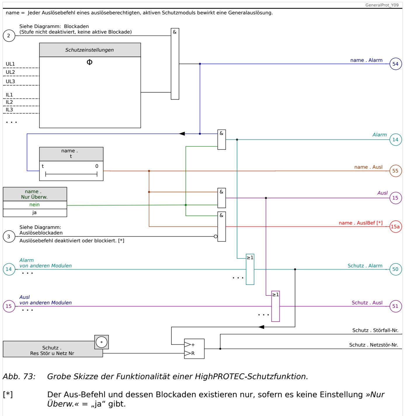
Das Diagramm zeigt das grundlegende Konzept hinter einer Schutzfunktion. (Beachten Sie dennoch, dass es bei den implementierten Schutzfunktionen gerätespezifische und auch schutzspezifische Unterschiede geben kann: Einige Gerätetypen haben keine Spannungsmessung, andere keine Strommessung, einige Schutzfunktionen verfügen über ein anderes Zeitstufenkonzept und/oder phasenspezifische Algorithmen, usw. Die exakte Funktionalität ist somit immer im jeweiligen Handbuchkapitel nachzusehen.)
