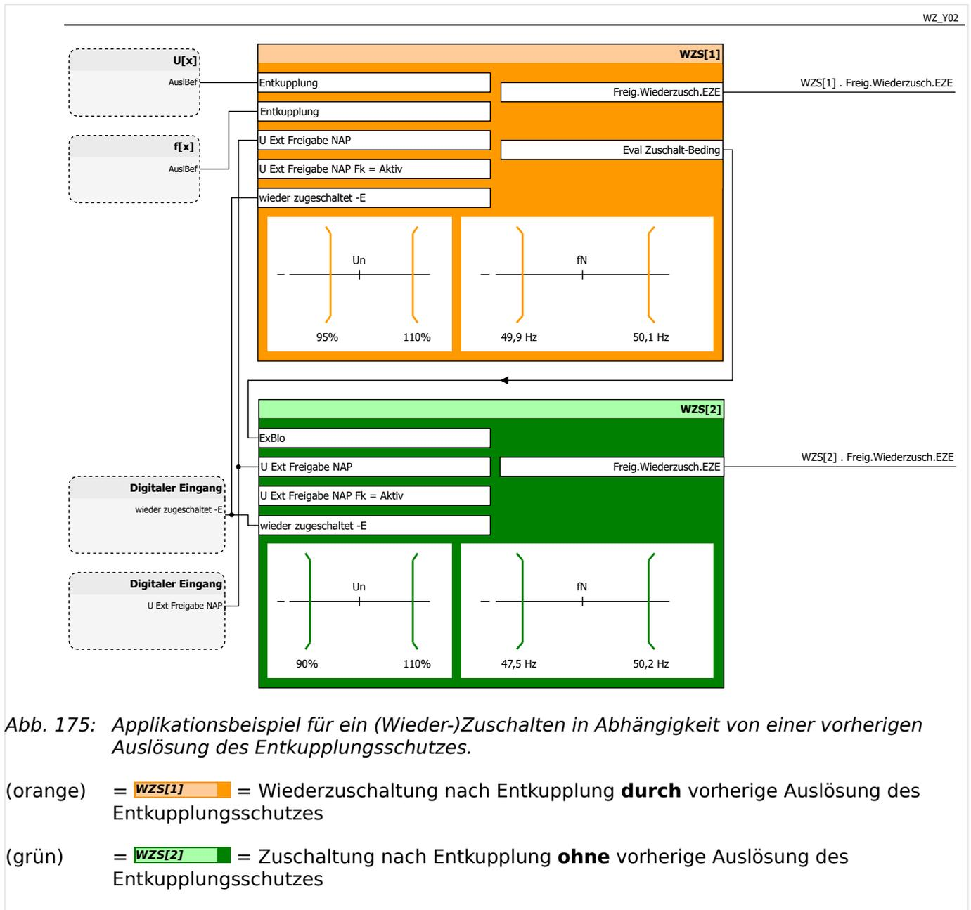
Abb. 175: Applikationsbeispiel für ein (Wieder-)Zuschalten in Abhängigkeit von einer vorherigen Auslösung des Entkupplungsschutzes.
