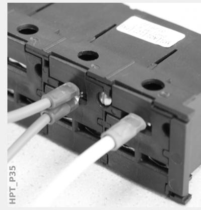
Anmerkung: Sofern der Kabelquerschnitt in den Grenzen liegt, die in den Technischen Daten ([↔13.1 Technische Daten](#), [↔Tab.](#) ) spezifiziert sind, passen auch zwei Ringe - Rücken an Rücken - in die Öffnung, siehe Bild. Dies ist nützlich für den Anschluss eines Sternpunktes.
