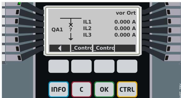
Abb. 191: Beispiel einer Steuer-Seite mit „Leistungsschalter“ in Störstellung (bzw. unplausiblen Zustand).
