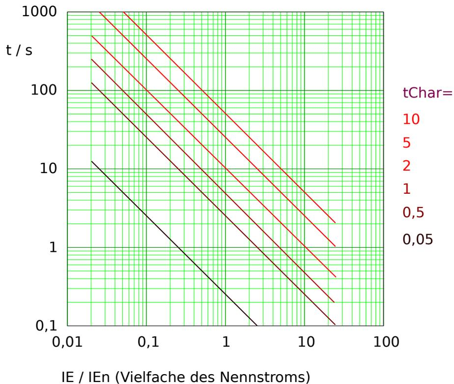
Abb. 140: Auslösekurve „IT“, wobei nur der Bereich  $IE > I_{E>}$  jeweils anwendbar ist. Beispieldiagramm für gemessenen (nicht empfindlichen) Erdstrom.
