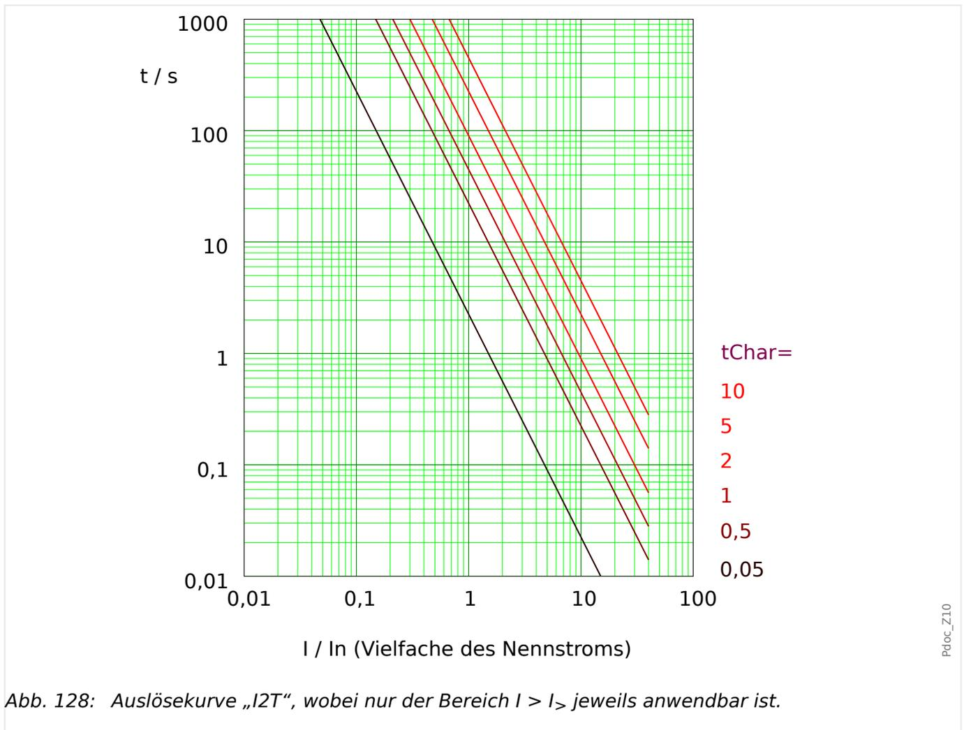
Abb. 128: Auslösekurve „I2T“, wobei nur der Bereich  $I > I_{>}$  jeweils anwendbar ist.
