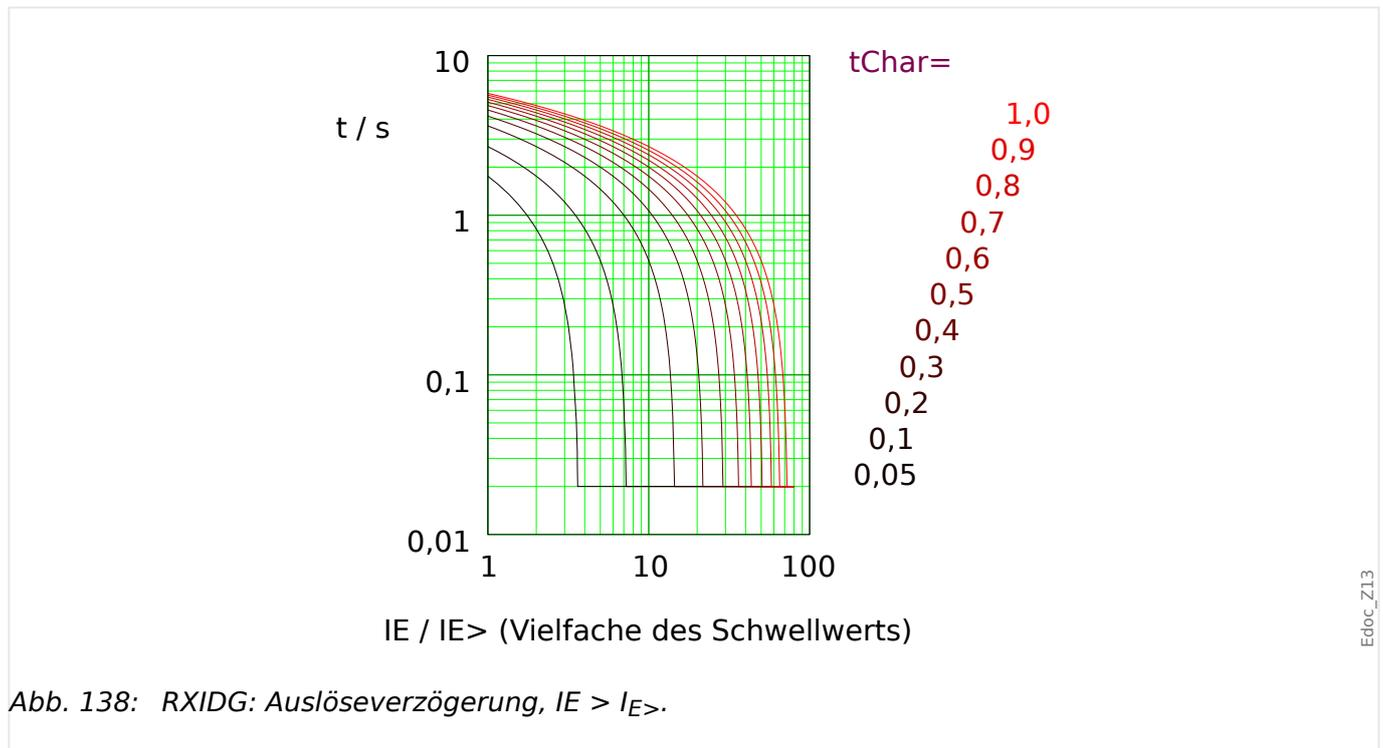
Abb. 138: RXIDG: Auslöseverzögerung,  $IE > I_{E>}$ .
