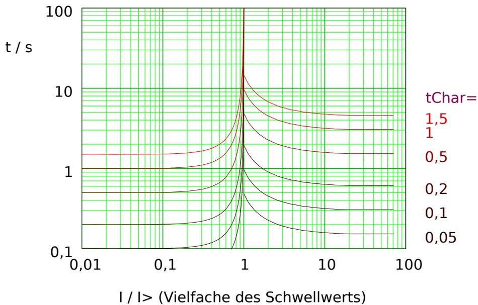
Abb. 122: RINV: Rückfallverzögerung (linke Hälfte,  $I < I_{>}$ ) und Auslöseverzögerung (rechte Hälfte,  $I > I_{>}$ ), Beispieldiagramm für  $I_{max} = 20 \cdot I_{>}$ .
