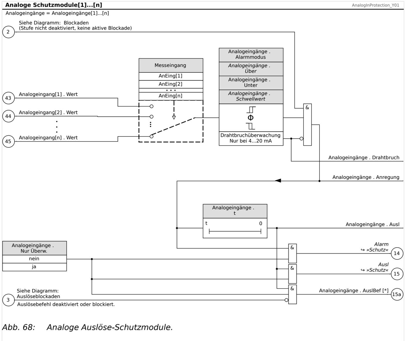
Abb. 68: Analoge Auslöse-Schutzmodule.
