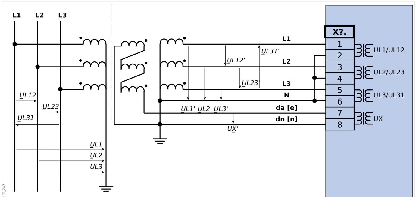
Abb. 39: Spannungswandler mit Geräteanschluss in offener Dreieckschaltung.
