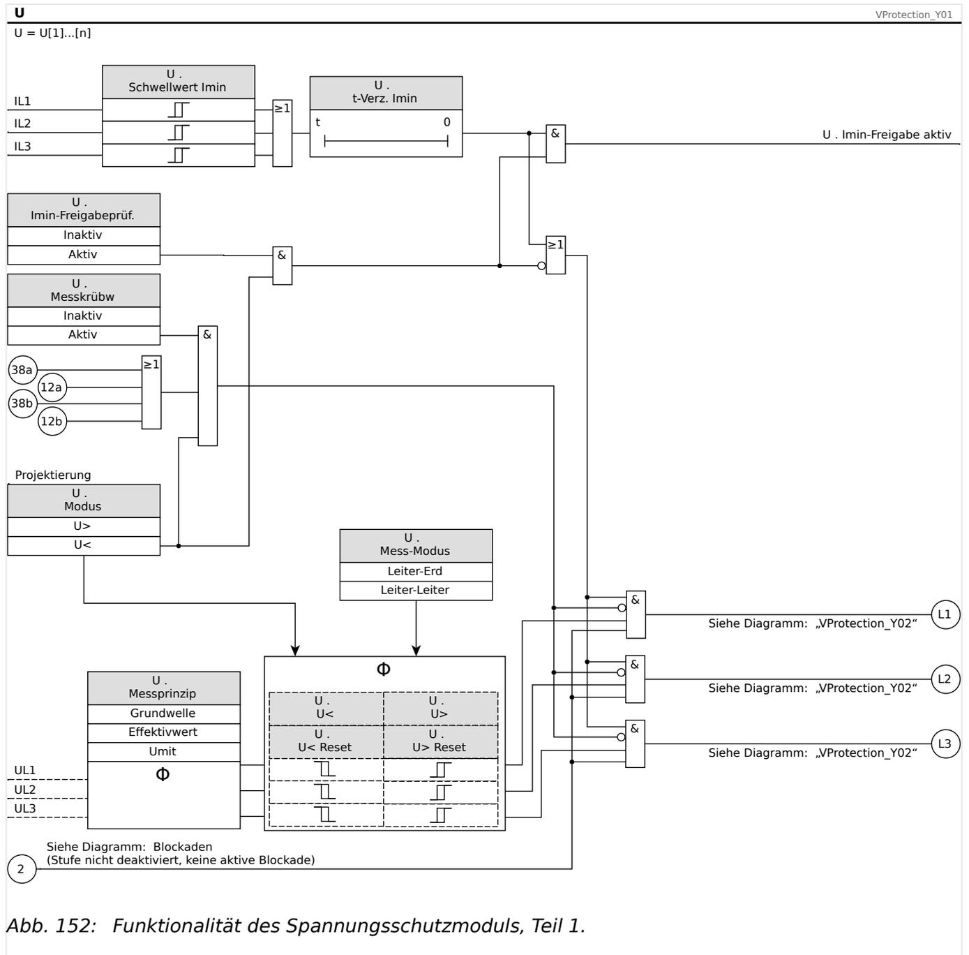
Abb. 152: Funktionalität des Spannungsschutzmoduls, Teil 1.
