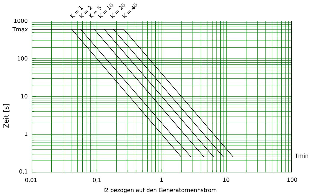
Abb. 145: Schieflastauslösekennlinien.
