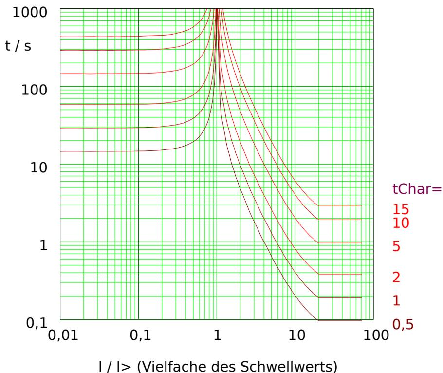
Abb. 125: EINV: Rückfallverzögerung (linke Hälfte,  $I < I_{>}$ ) und Auslöseverzögerung (rechte Hälfte,  $I > I_{>}$ ), Beispieldiagramm für  $I_{max} = 20 \cdot I_{>}$ .
