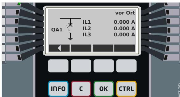
Abb. 189: Beispiel einer Steuer-Seite mit „Leistungsschalter“ in Zwischenposition).
