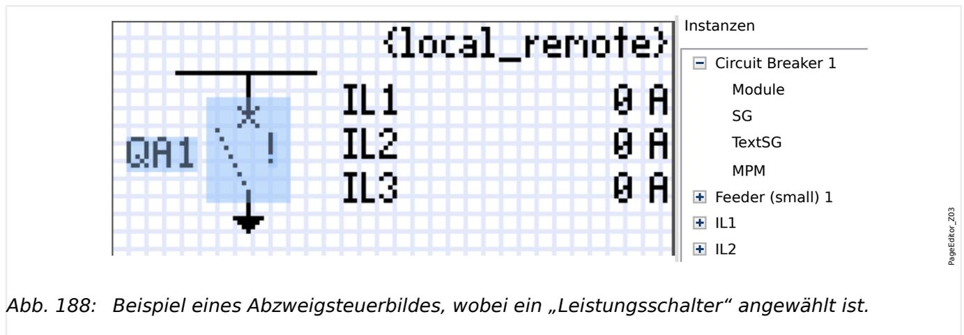
Abb. 188: Beispiel eines Abzweigsteuerbildes, wobei ein „Leistungsschalter“ angewählt ist.
