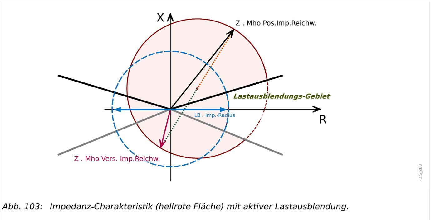
Abb. 103: Impedanz-Charakteristik (hellrote Fläche) mit aktiver Lastausblendung.
