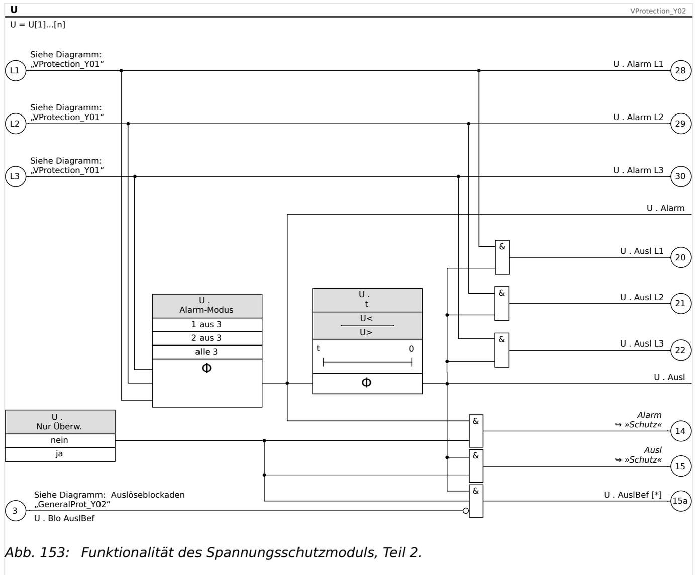
Abb. 153: Funktionalität des Spannungsschutzmoduls, Teil 2.
