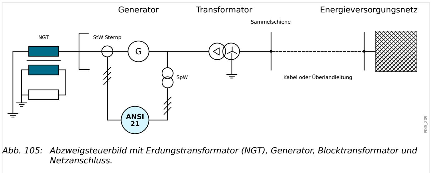
Abb. 105: Abzweigsteuerbild mit Erdungstransformator (NGT), Generator, Blocktransformator und Netzanschluss.
