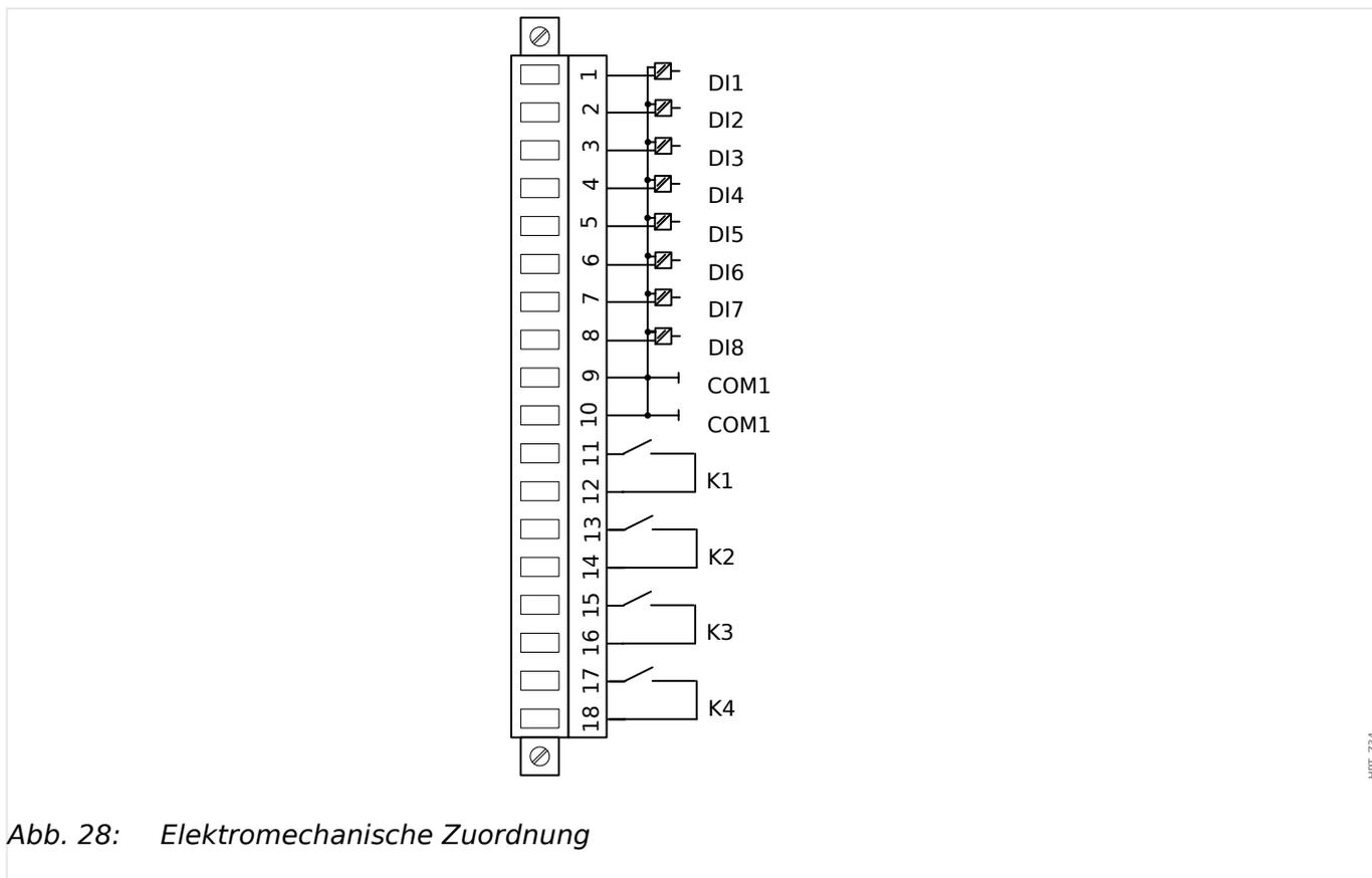
Abb. 28: Elektromechanische Zuordnung
