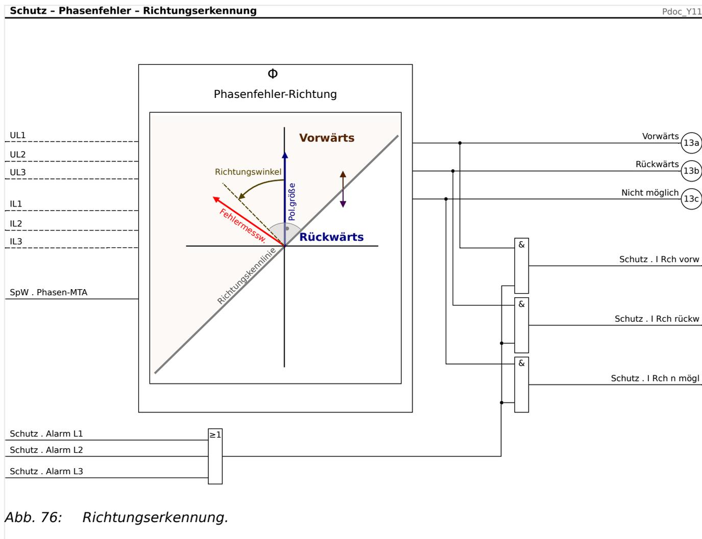
Das MCDGV4 ermittelt den Winkel zwischen dem Phasenstrom mit der größten Stromstärke (*Fehlermesswert*) und der Leiter-Leiter-Spannung der anderen Phasen (*Polarisationsgröße*). Im Falle eines dreiphasigen Fehlers, bei dem die Leiter-Leiter-Spannung zu klein für eine Richtungserkennung ist, wird ein Spannungsspeicher verwendet.
