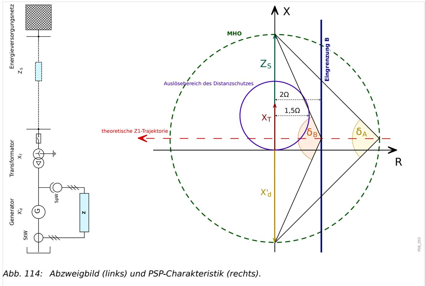
Abb. 114: Abzweigbild (links) und PSP-Charakteristik (rechts).
