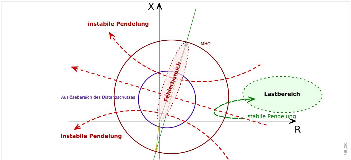
Abb. 111: Lastbereich und Impedanztrajektorien.
