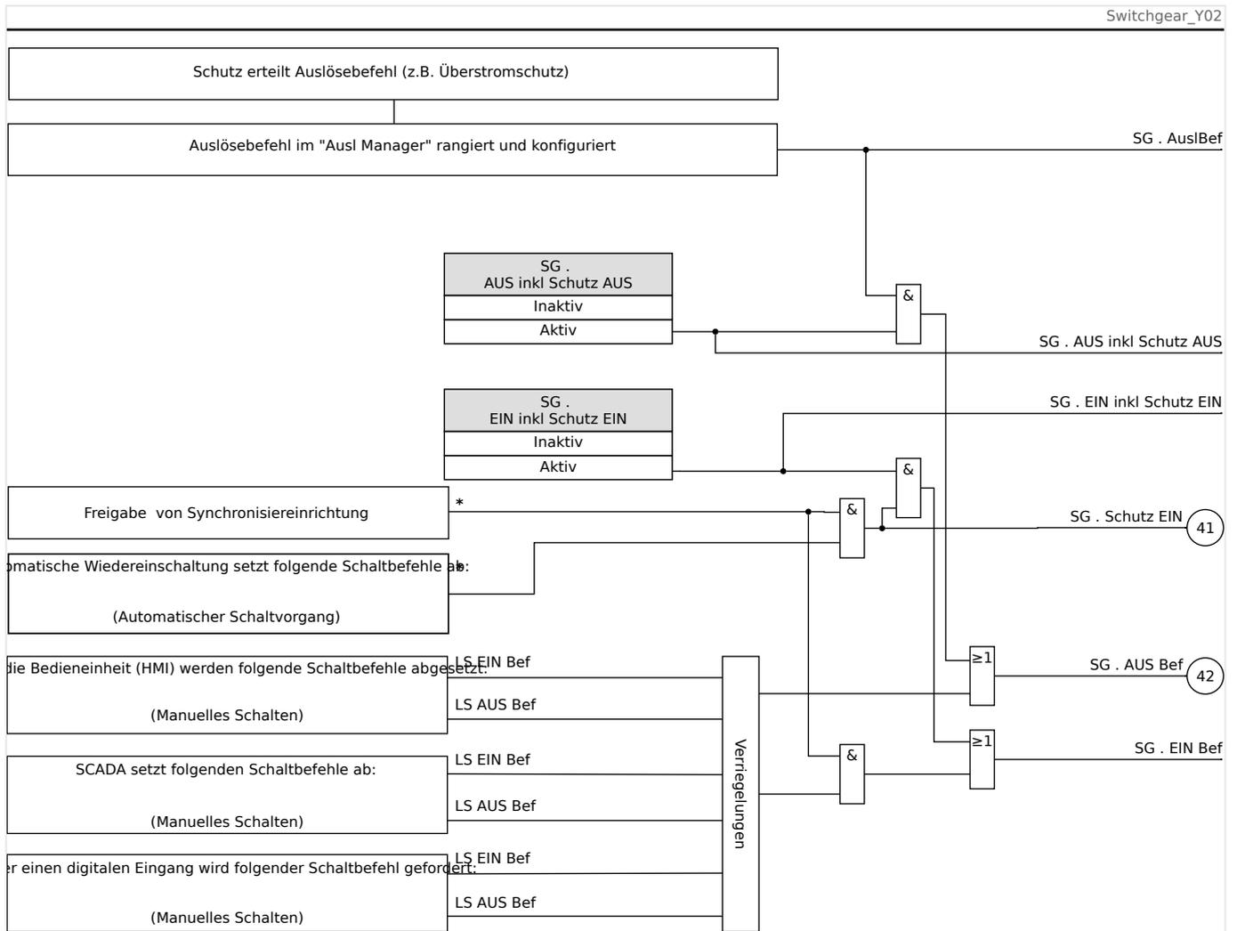
Abb. 193: Verriegelungen. (Für die mit „\*“ markierten Teile gilt: Verfügbarkeit hängt von der bestellten Gerätevariante ab.)
