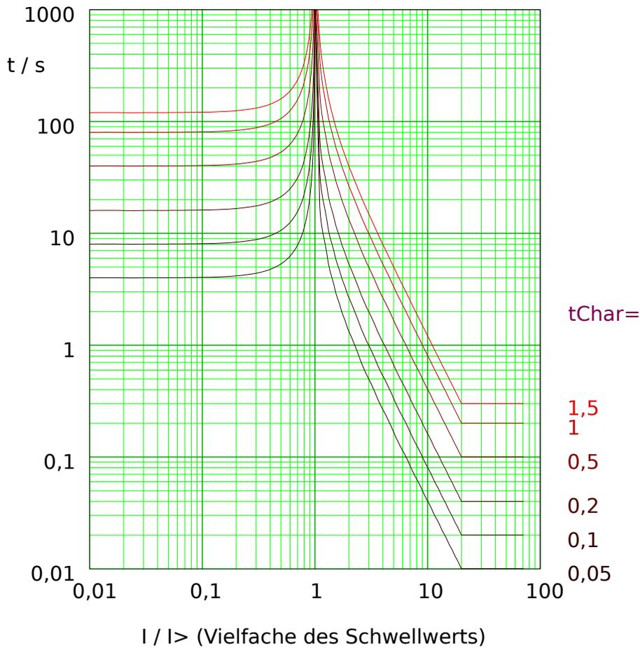
Abb. 120: EINV: Rückfallverzögerung (linke Hälfte,  $I < I_{>}$ ) und Auslöseverzögerung (rechte Hälfte,  $I > I_{>}$ ), Beispieldiagramm für  $I_{max} = 20 \cdot I_{>}$ .
