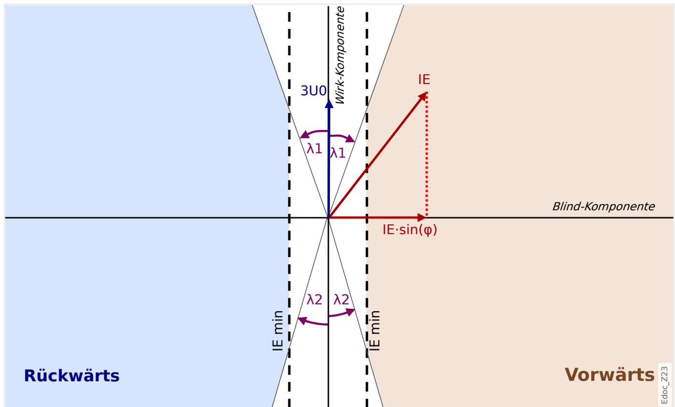
Abb. 80: Richtungserkennung nach der Methode „ $\sin(\phi)$ “.
