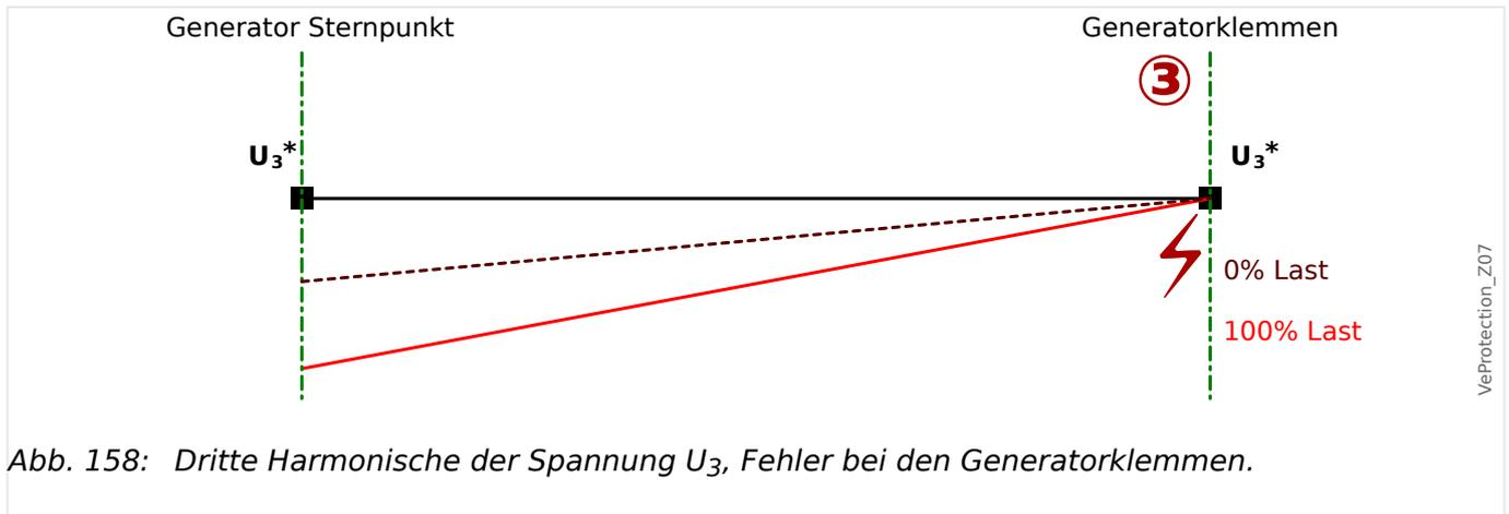
Abb. 158: Dritte Harmonische der Spannung  $U_3$ , Fehler bei den Generatorklemmen.
