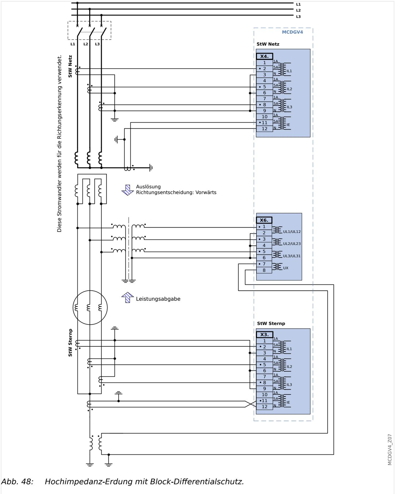
Abb. 48: Hochimpedanz-Erdung mit Block-Differentialschutz.
