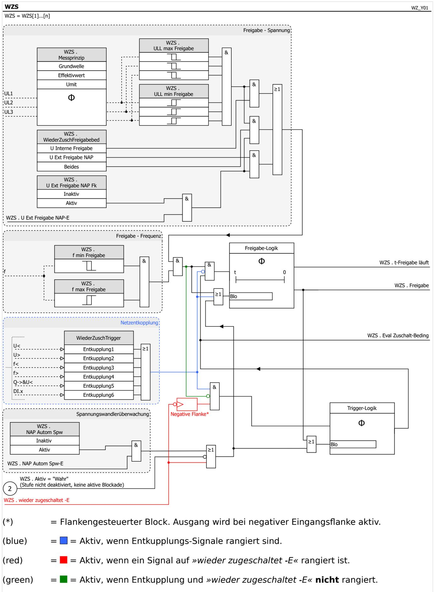
Grundsätzlich kann die Funktion unterteilt werden in eine Trigger- und eine Freigabe-Logik. Der Trigger-Teil definiert, wann mit der Evaluation der Zuschalt-Bedingungen begonnen wird. Die Evaluations-Phase, welche die Netzberuhigungszeit »t-Freigabe Blo« beinhaltet, wird von der Freigabe-Logik definiert.
