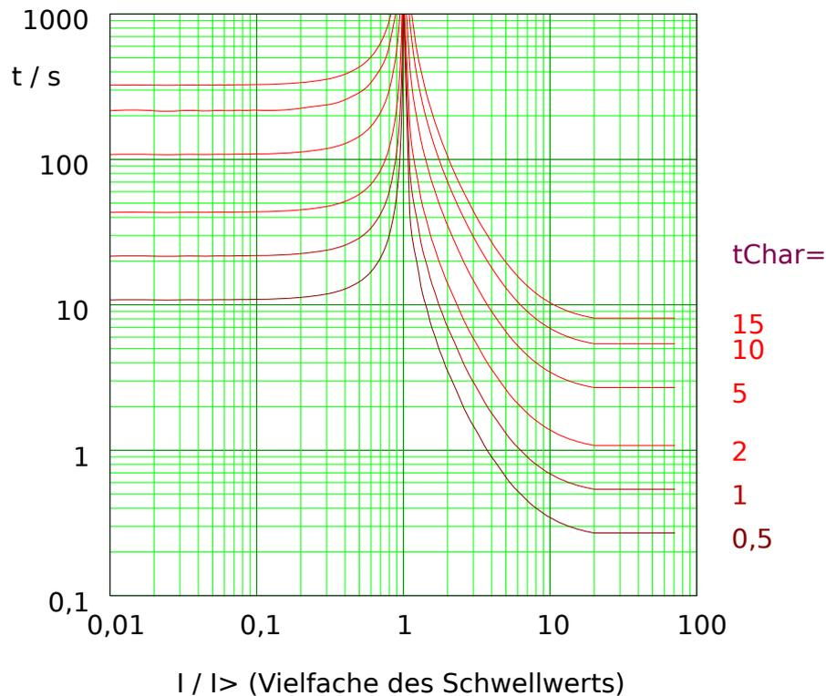
Abb. 124: VINV: Rückfallverzögerung (linke Hälfte,  $I < I_{>}$ ) und Auslöseverzögerung (rechte Hälfte,  $I > I_{>}$ ), Beispieldiagramm für  $I_{max} = 20 \cdot I_{>}$ .
