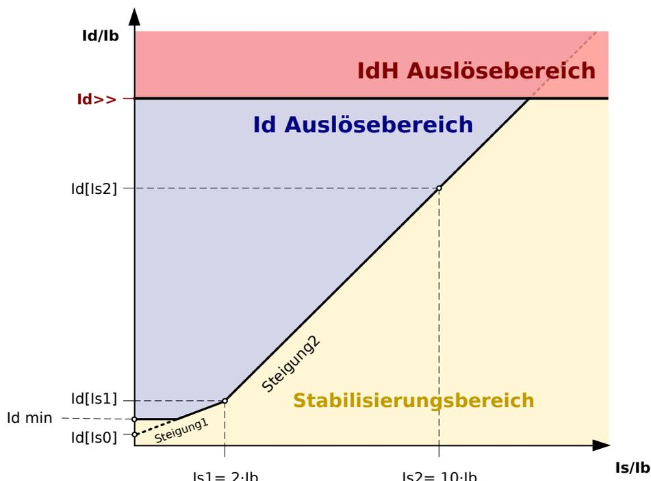
Abb. 92: Unstabilisierte Hochstromdifferentialstufe  $I_{dH}$ .
