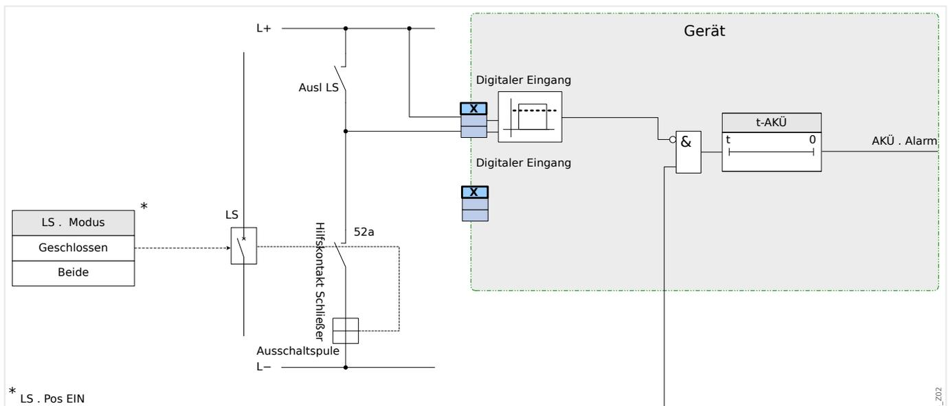
Abb. 186: Anschlussbeispiel: Auslösekreisüberwachung mit einem Hilfskontakt »Hiko EIN« (52a).
