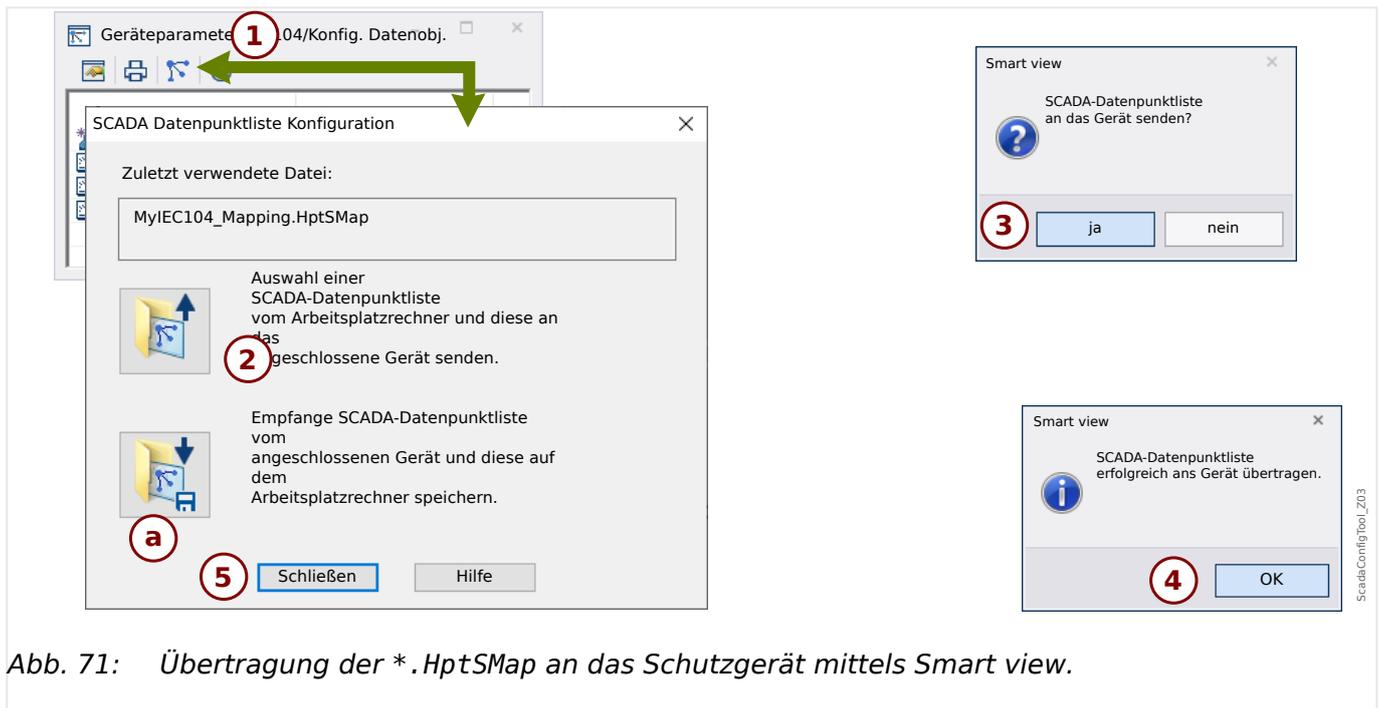
Abb. 71: Übertragung der \*.HptSMap an das Schutzgerät mittels Smart view.
