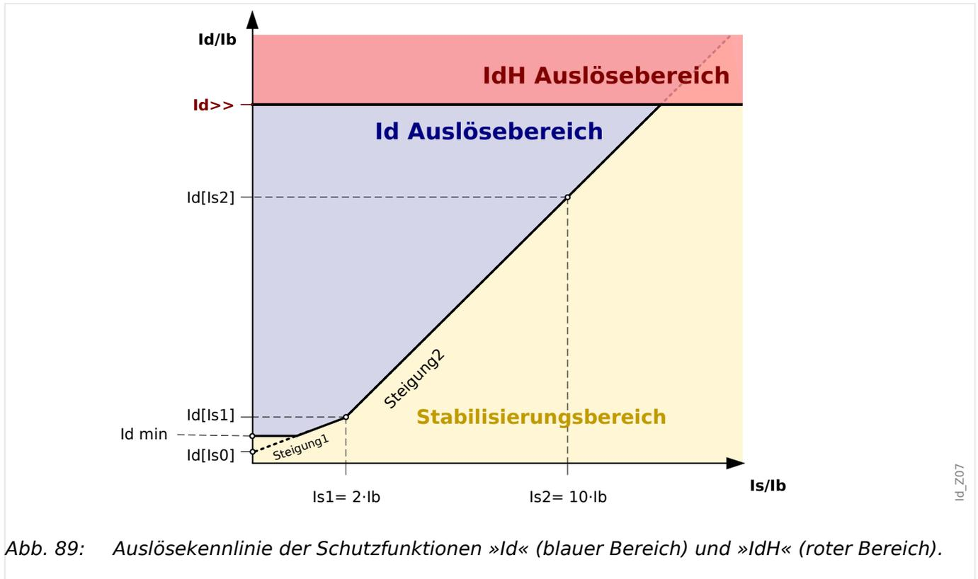
Abb. 89: Auslösekennlinie der Schutzfunktionen »Id« (blauer Bereich) und »IdH« (roter Bereich).
