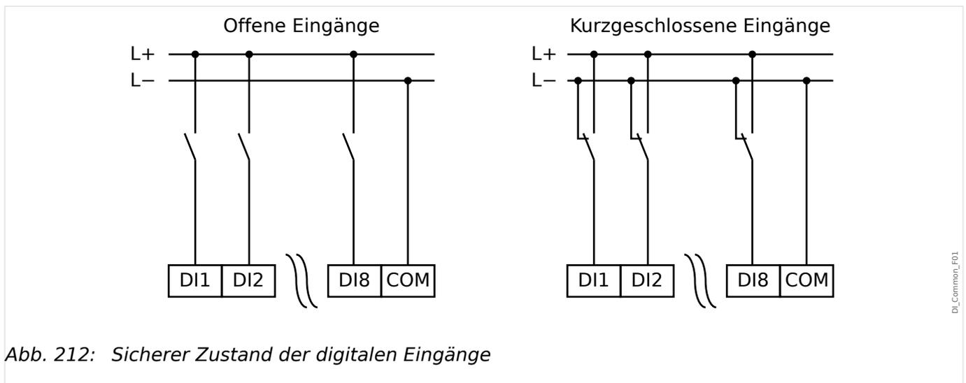
Abb. 212: Sicherer Zustand der digitalen Eingänge
