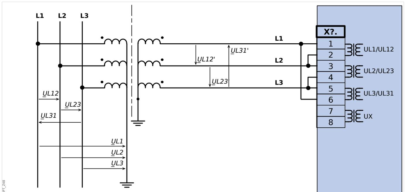
Abb. 40: Drei Spannungswandler mit Geräteanschluss in Dreieckschaltung
