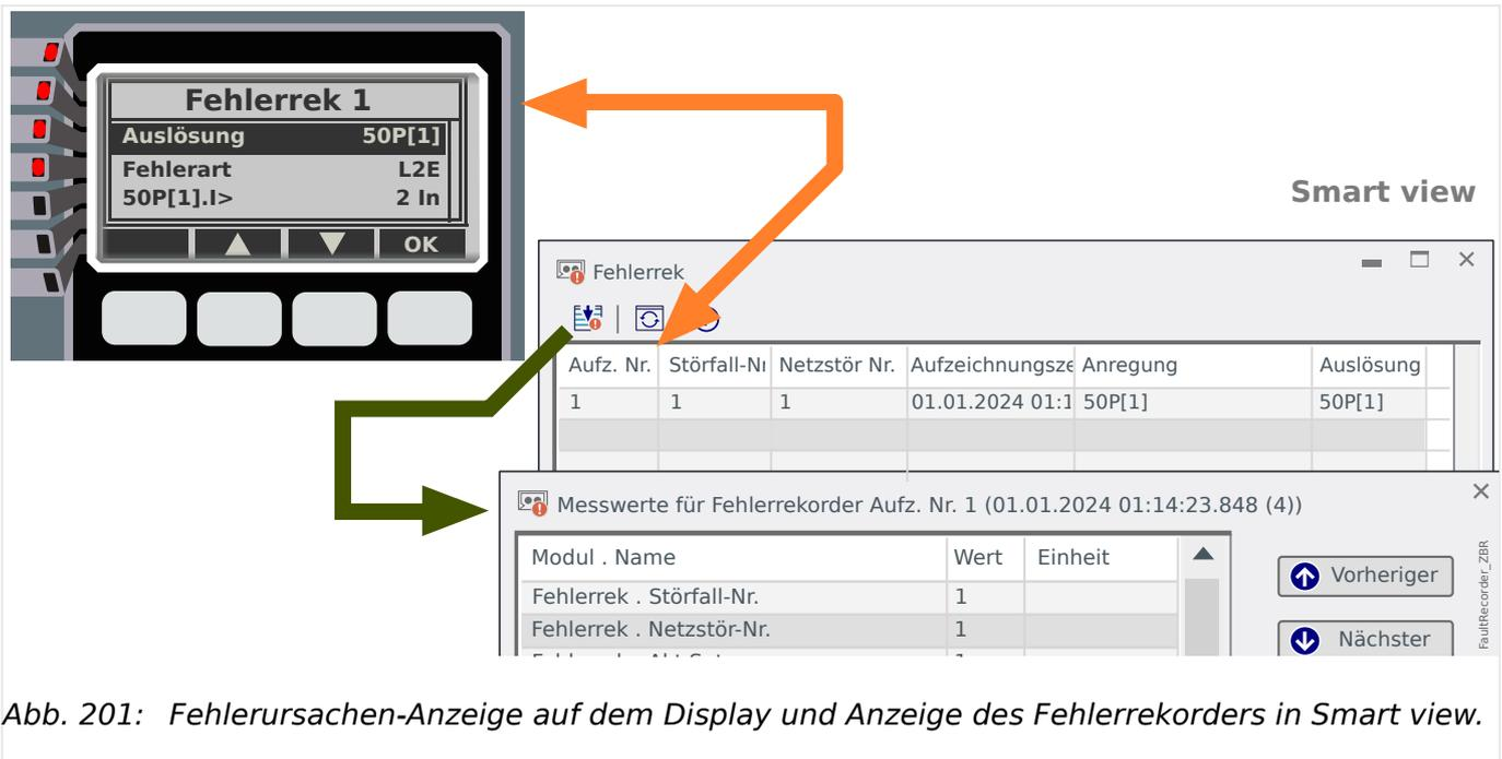
Abb. 201: Fehlerursachen-Anzeige auf dem Display und Anzeige des Fehlerrekorders in Smart view.
