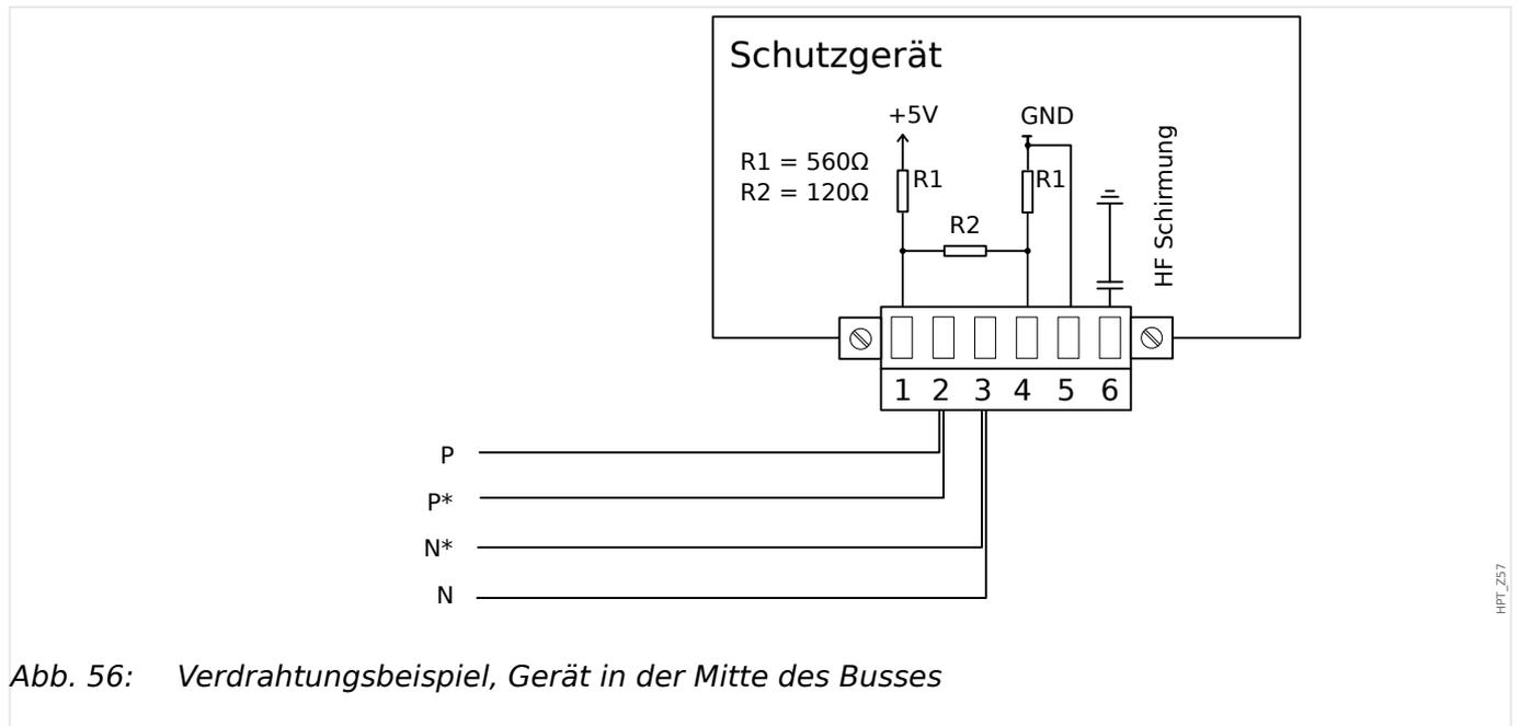
Abb. 56: Verdrahtungsbeispiel, Gerät in der Mitte des Busses
