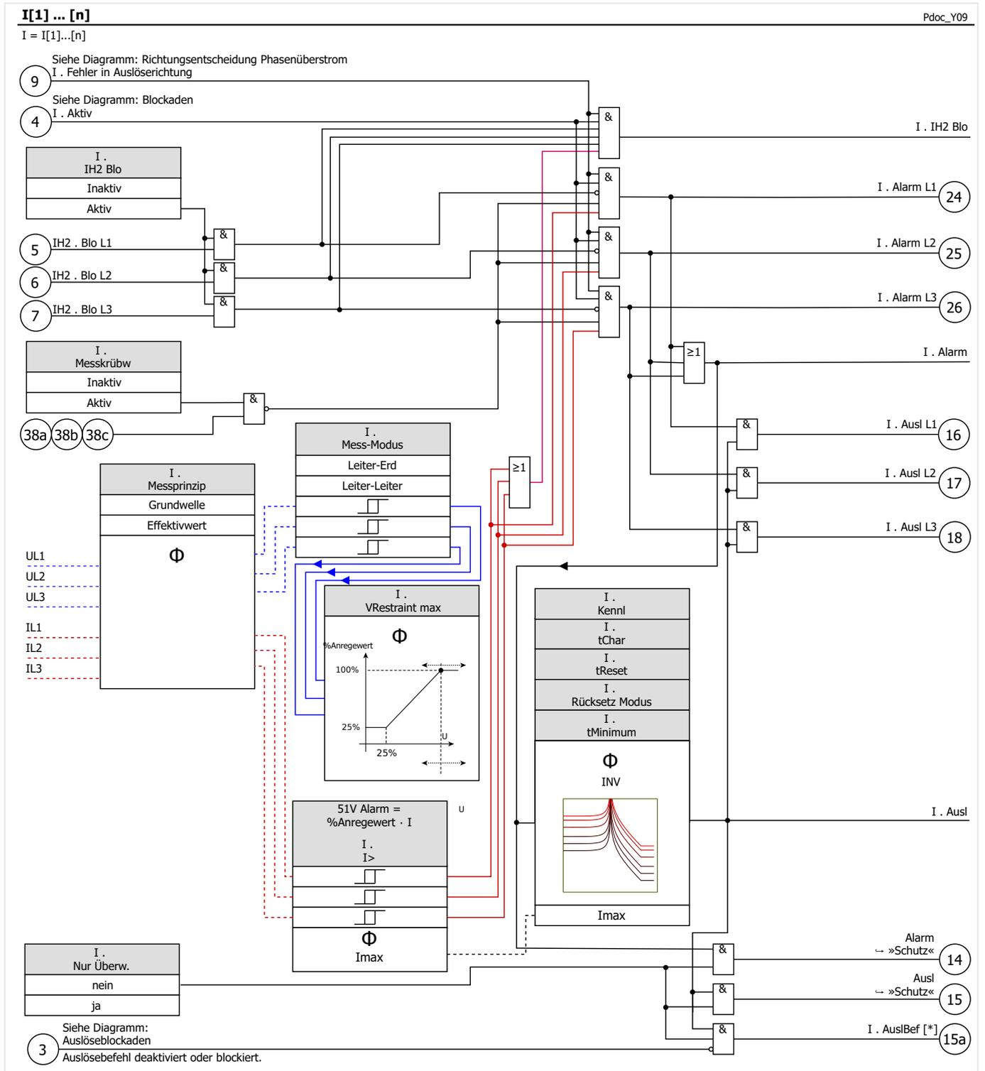
Anmerkung: Um das Diagramm nicht zu sehr zu überladen, ist hierin nicht die Tatsache berücksichtigt, dass für den Fall [Feldparameter / SpW] »SpW Anschluss« = "Leiter-Leiter" der Parameter »I[x]« . Mess-Modus geräteintern auf "Leiter-Leiter" gesetzt wird, unabhängig vom ursprünglich konfigurierten Wert (siehe auch den Hinweis in [Kapitel 5.12.3](#)).
