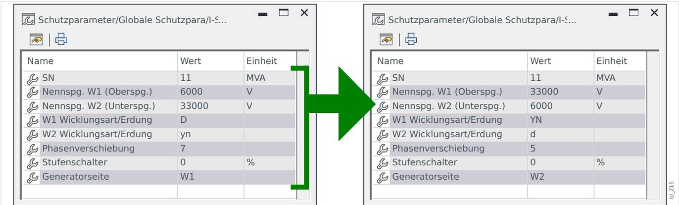
Abb. 91: Links: „Invers“ parametrisierte Transformatorparameter bis Version 3.4. Rechts: Manuell angepasste Daten für Versionen ab 3.6.
