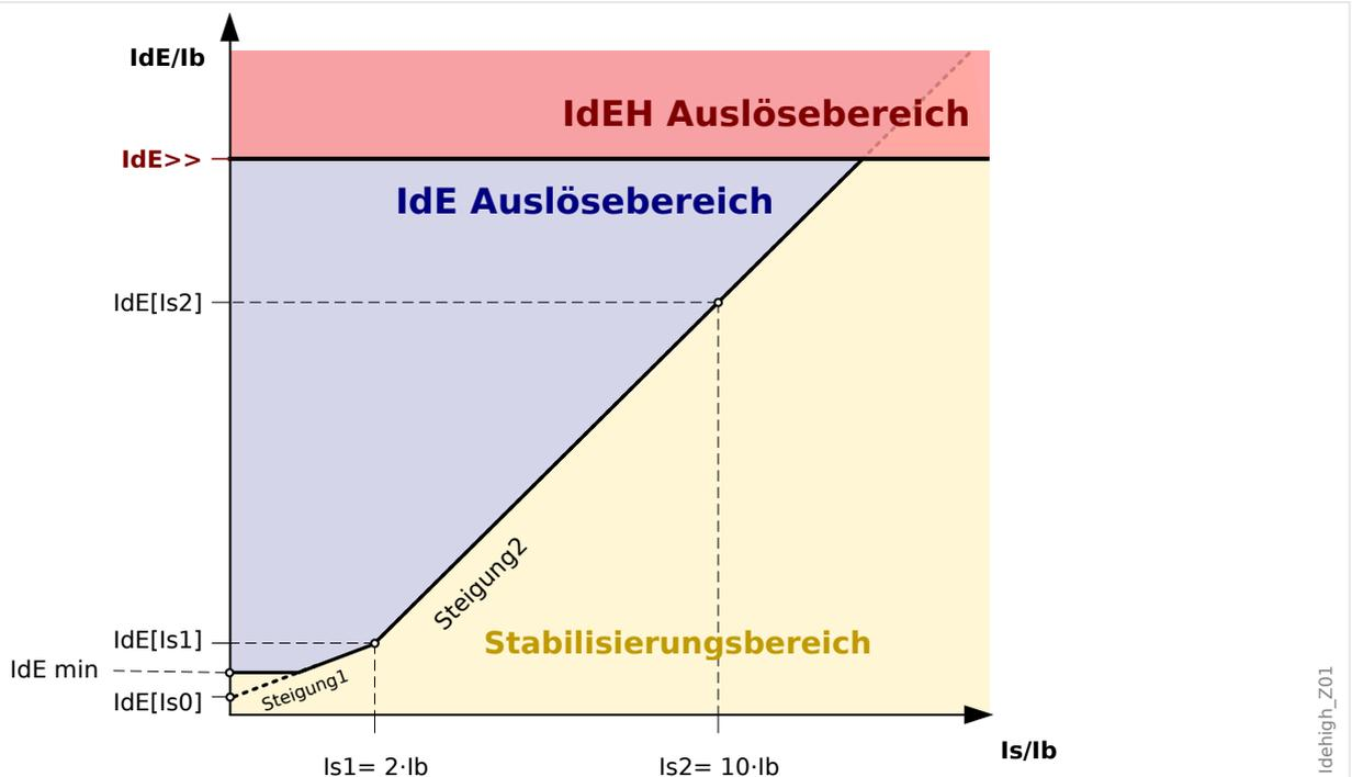
Abb. 95: Ansprechwert »IdE>>« des Erddifferentialstromes bezogen auf den Nennstrom »Ib« des entsprechenden Schutzobjektes.
