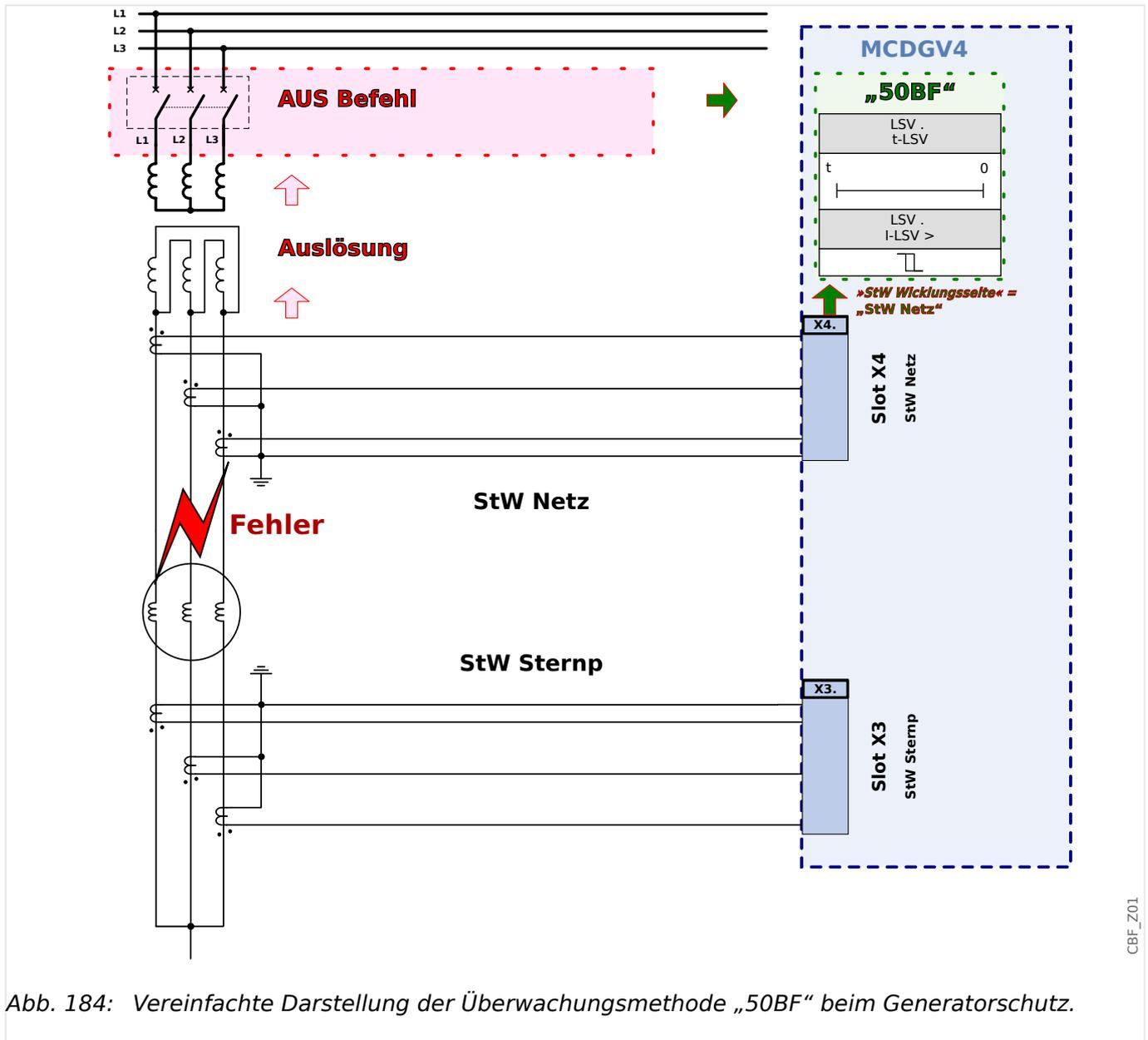
Abb. 184: Vereinfachte Darstellung der Überwachungsmethode „50BF“ beim Generatorschutz.
