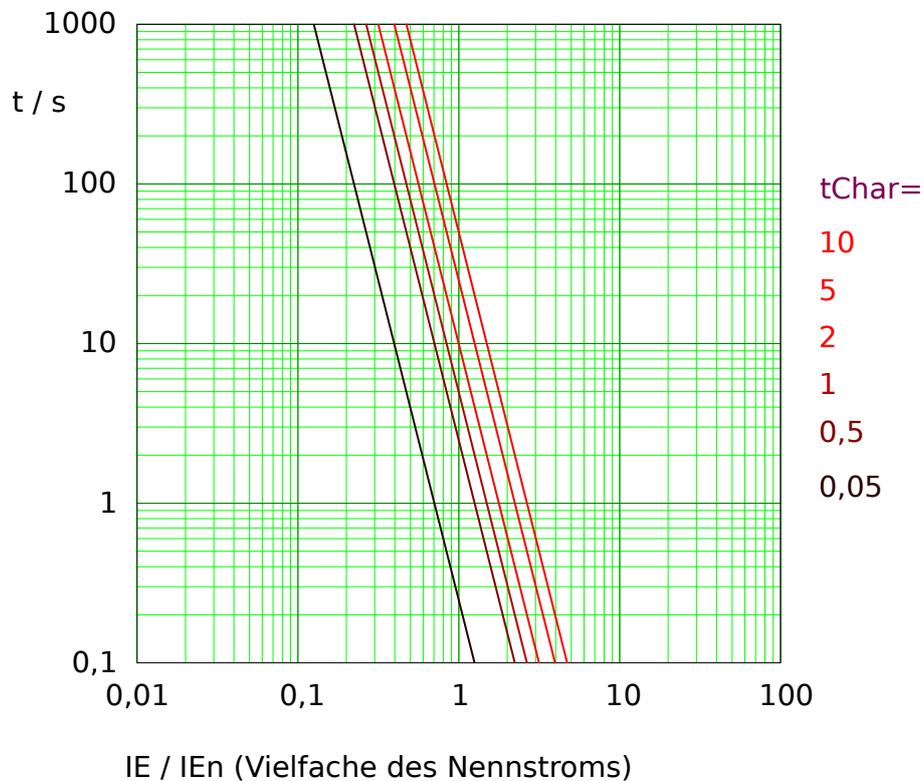
Abb. 142: Auslösekurve „I4T“, wobei nur der Bereich  $IE > I_{E>}$  jeweils anwendbar ist. Beispieldiagramm für gemessenen (nicht empfindlichen) Erdstrom.
