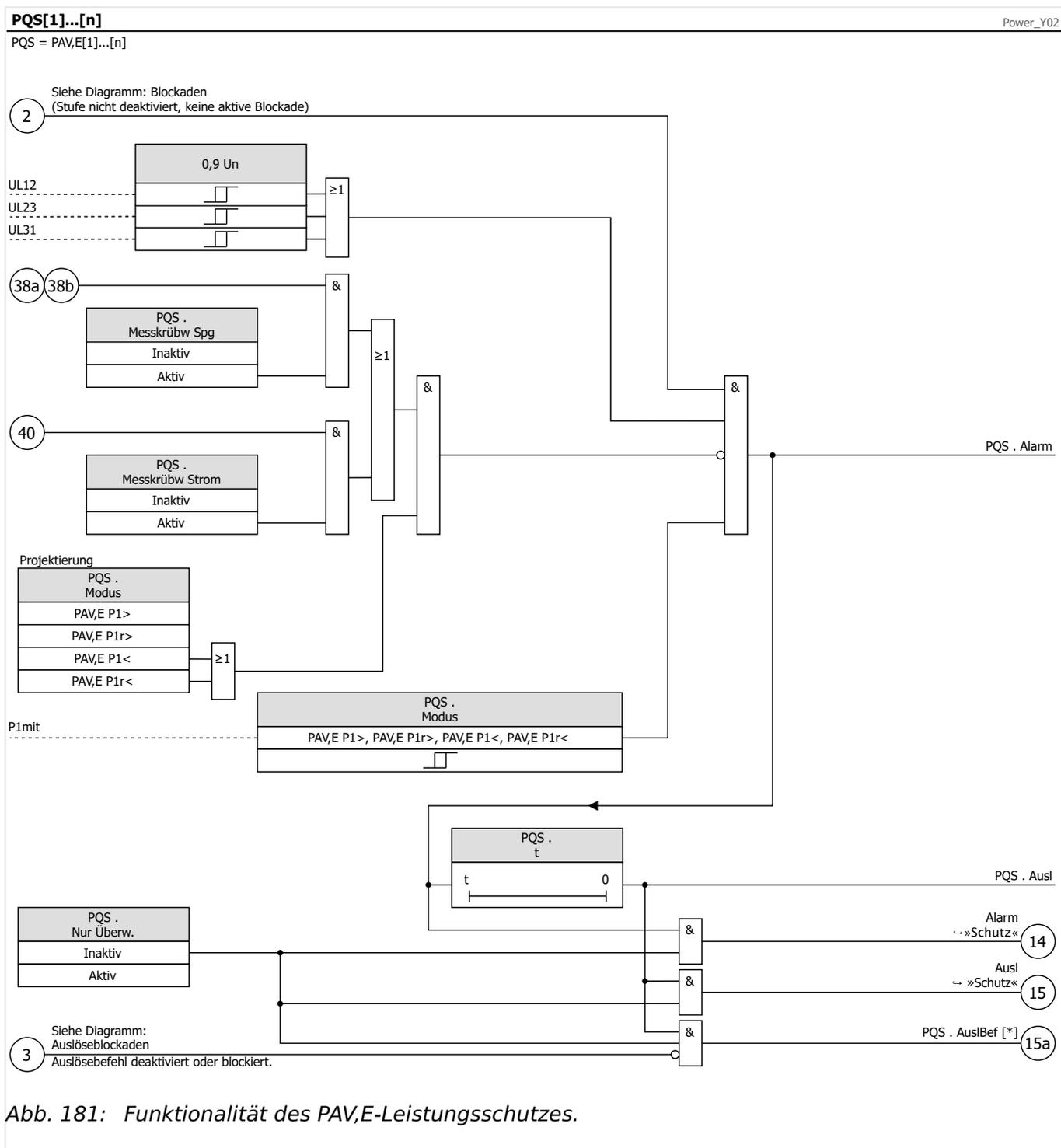
Abb. 181: Funktionalität des PAV,E-Leistungsschutzes.
