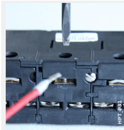
Stiftkabelschuhe können nun in die jeweiligen Anschlussöffnungen eingeführt und verschraubt werden. Die Schrauben zum Befestigen des Kabelschuhs befinden sich seitlich.
