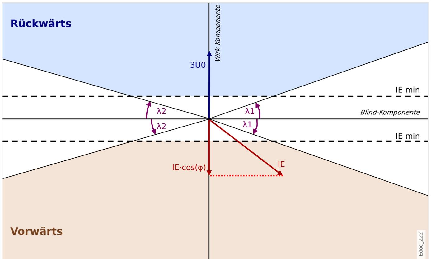
Abb. 79: Richtungserkennung nach der Methode „ $\cos(\phi)$ “.
