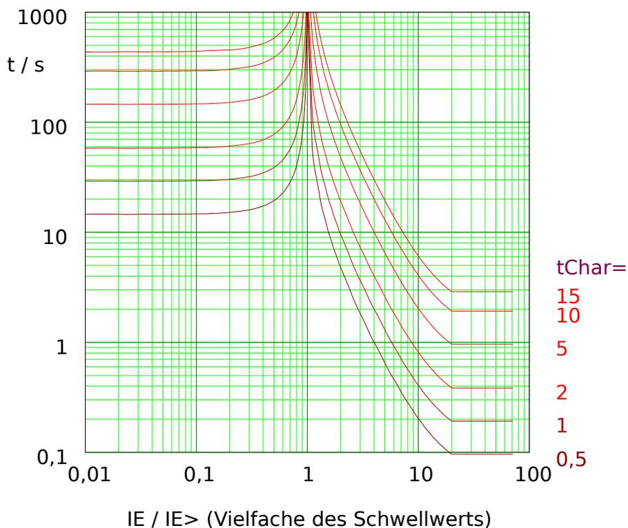
Abb. 137: EINV: Rückfallverzögerung (linke Hälfte,  $IE < I_{E>}$ ) und Auslöseverzögerung (rechte Hälfte,  $IE > I_{E>}$ ), Beispieldiagramm für  $I_{max} = 20 \cdot I_{E>}$ .
