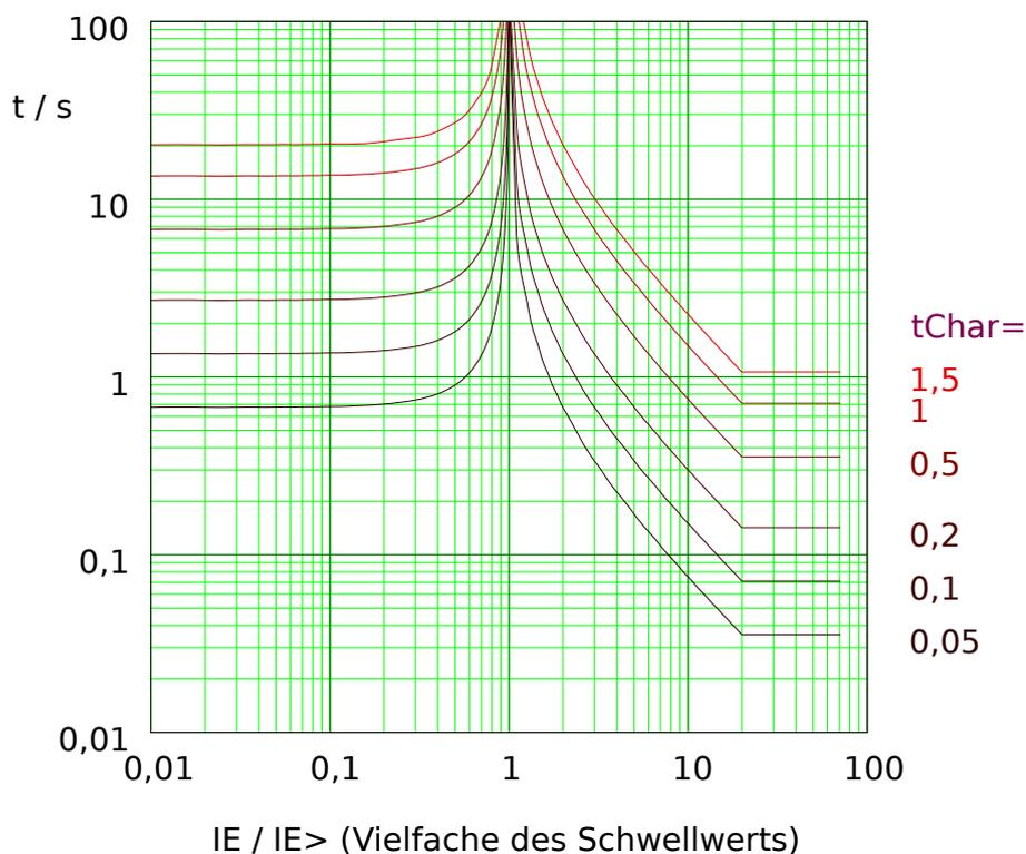
Abb. 131: VINV: Rückfallverzögerung (linke Hälfte,  $IE < I_{E>}$ ) und Auslöseverzögerung (rechte Hälfte,  $IE > I_{E>}$ ), Beispieldiagramm für  $I_{max} = 20 \cdot I_{E>}$ .
