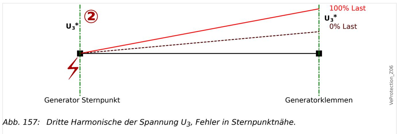
Abb. 157: Dritte Harmonische der Spannung  $U_3$ , Fehler in Sternpunktnähe.
