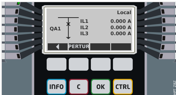
Fig. 164: Ejemplo de página de control, con el circuito en posición cerrada.
