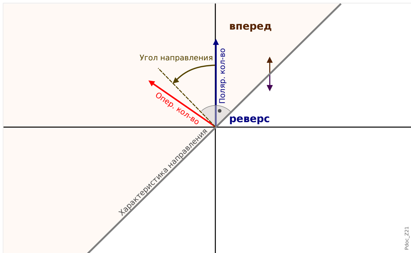
Рис. 72: Принцип определения направления межфазного короткого замыкания.
