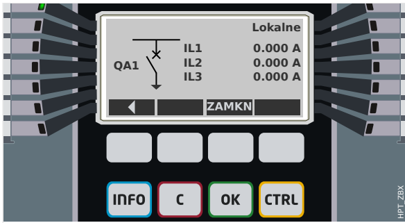
Rys. 156: Przykład strony sterowania z wyłącznikiem w pozycji otwartej.
