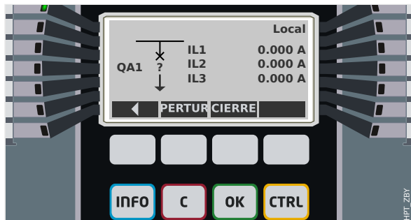
Fig. 155: Ejemplo de página de control, con el circuito en posición de fallo (o improbable).
