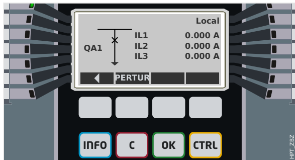
Fig. 154: Ejemplo de página de control, con el circuito en posición cerrada.
