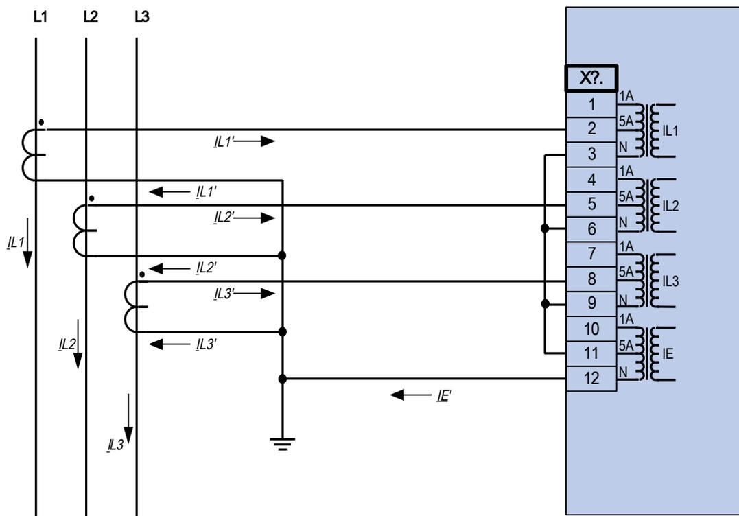
Dreiphasiger Stromwandleranschluss;  $I_n$  sekundär = 5 A.
