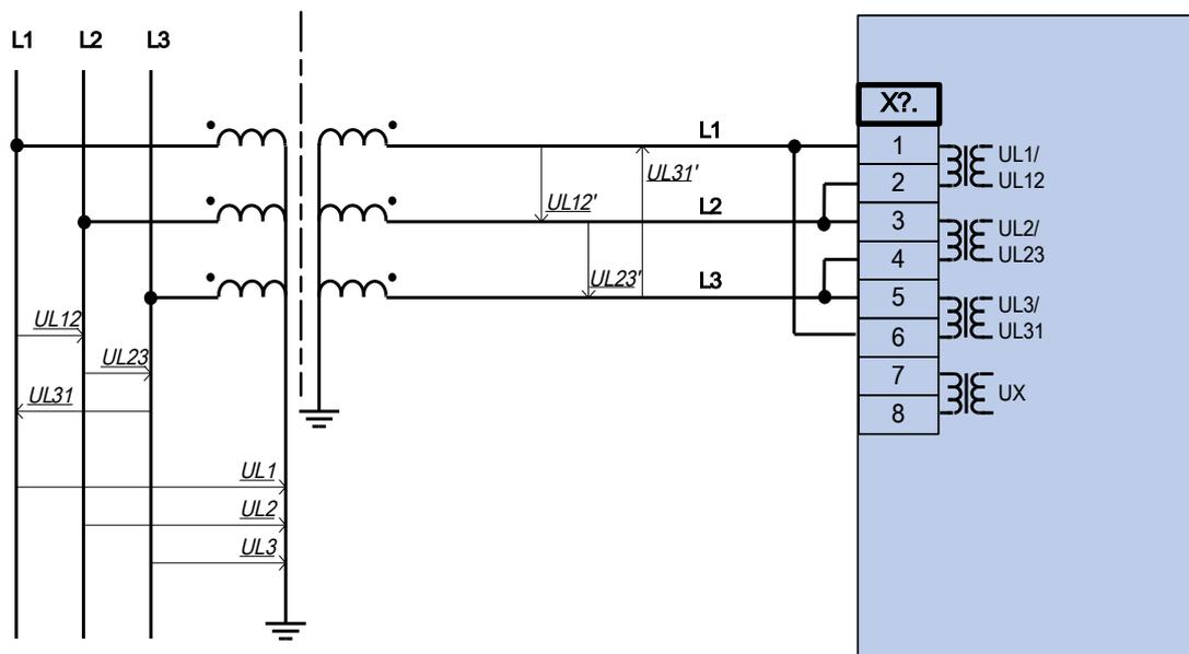
Drei Spannungswandler mit Geräteanschluss in Dreieckschaltung
