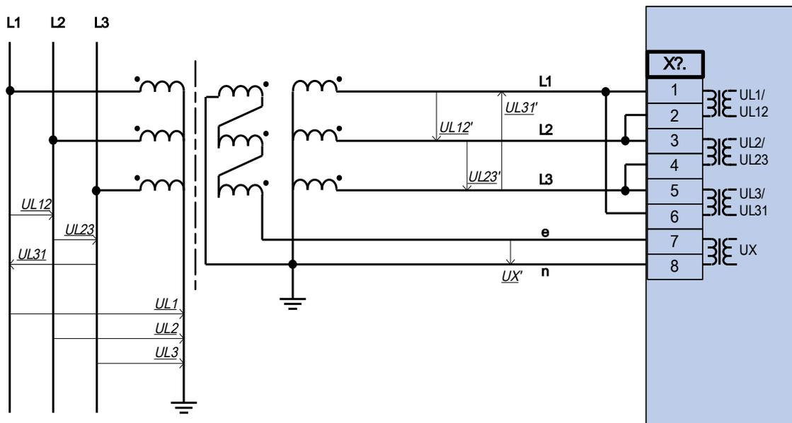
Drei Spannungswandler mit Geräteanschluss in Dreieckschaltung
