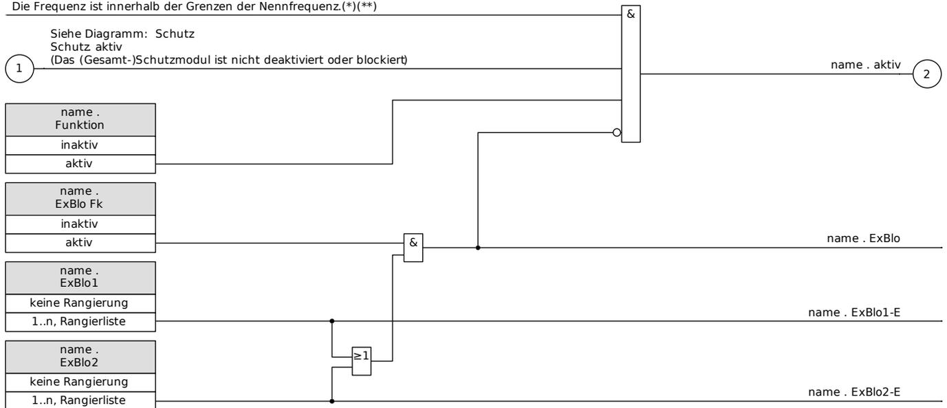
(\*) Alle Schutzstufen, die die Grundwelle oder Harmonische auswerten, werden blockiert, wenn die Frequenz ausserhalb des Nennbereiches liegt. Schutzstufen, die RMS verwenden, werden nicht blockiert.
