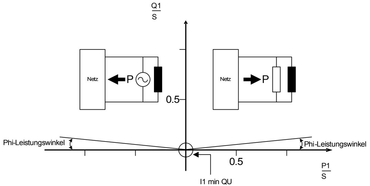
Variante 2: Reine Blindleistungsschwellwertüberwachung
