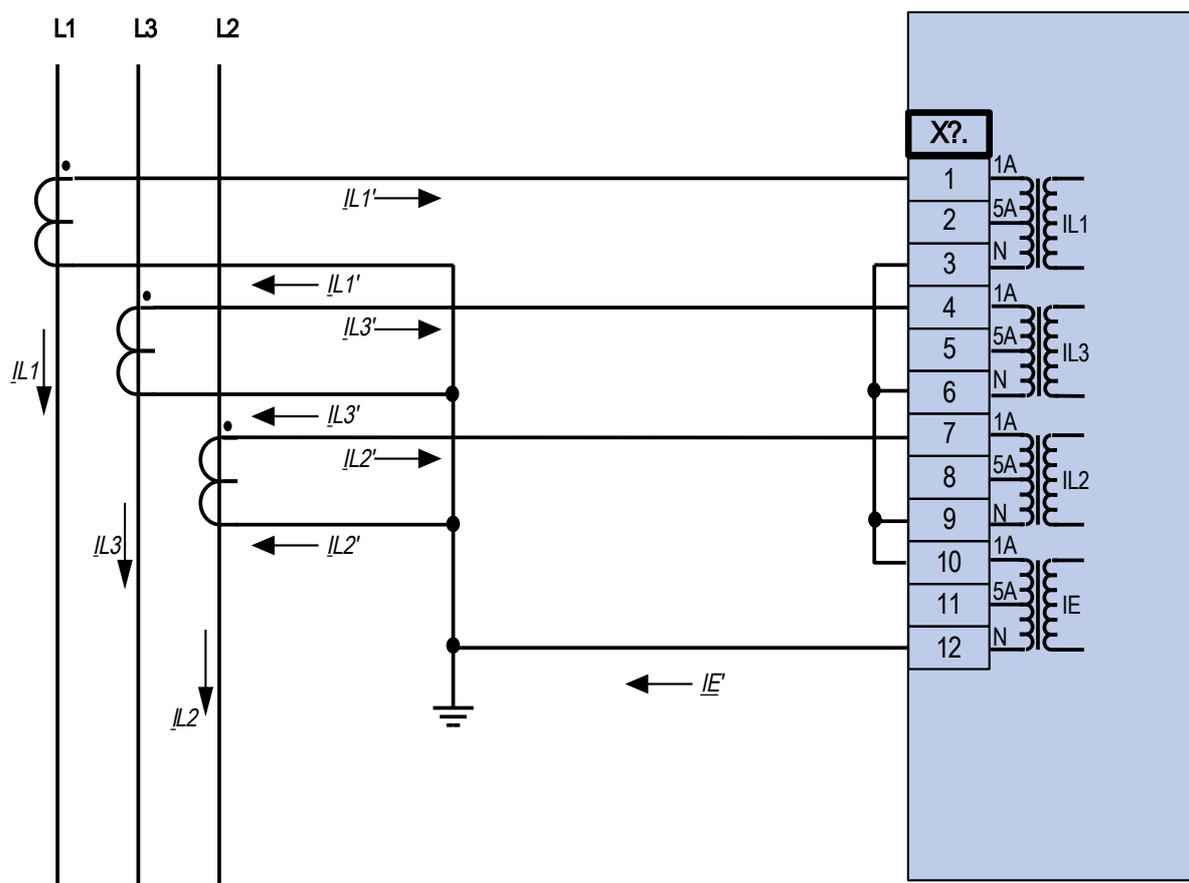
Dreiphasiger Stromwandleranschluss;  $I_n$  sekundär = 1 A.
