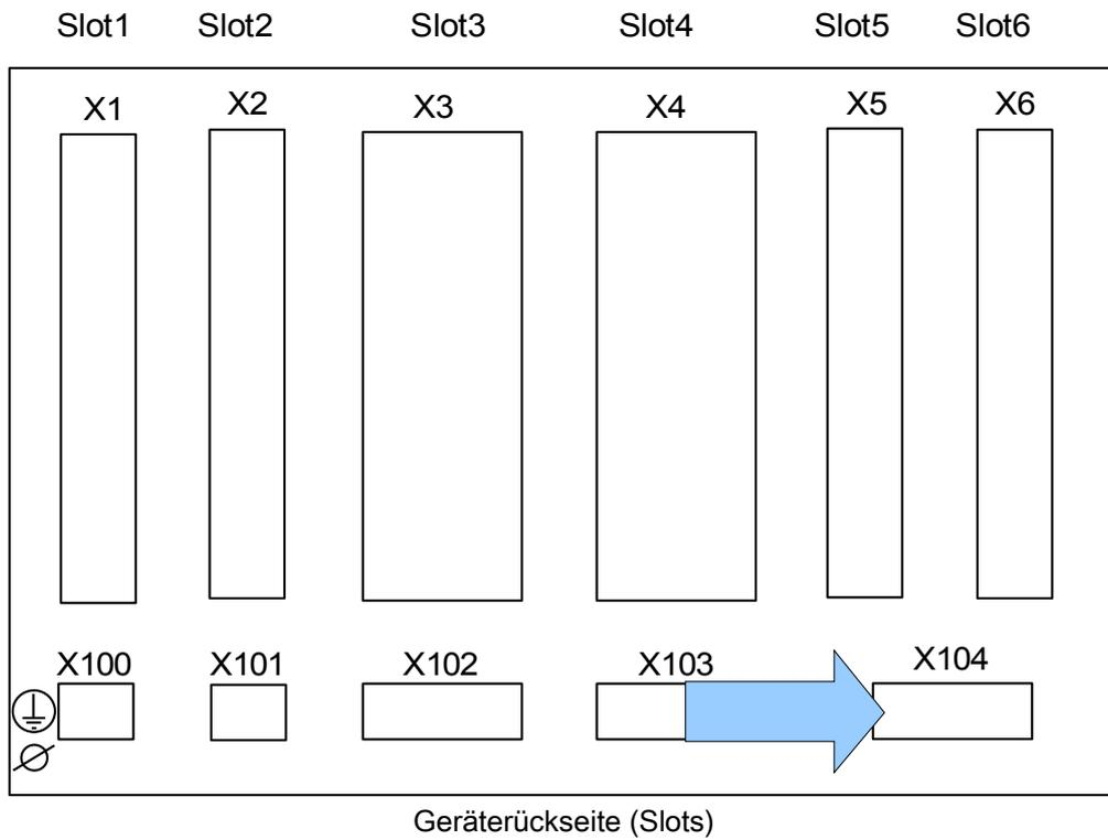
Auf dieser Klemme befinden sich die IRIG-B00X Schnittstelle und der Selbstüberwachungskontakt.
