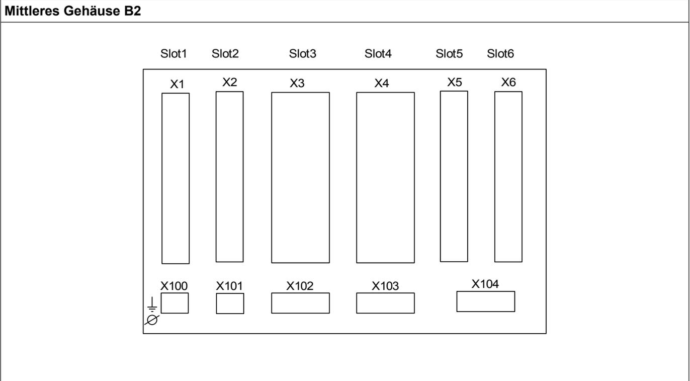
B2 Gehäuse prinzipielle Rückansicht
