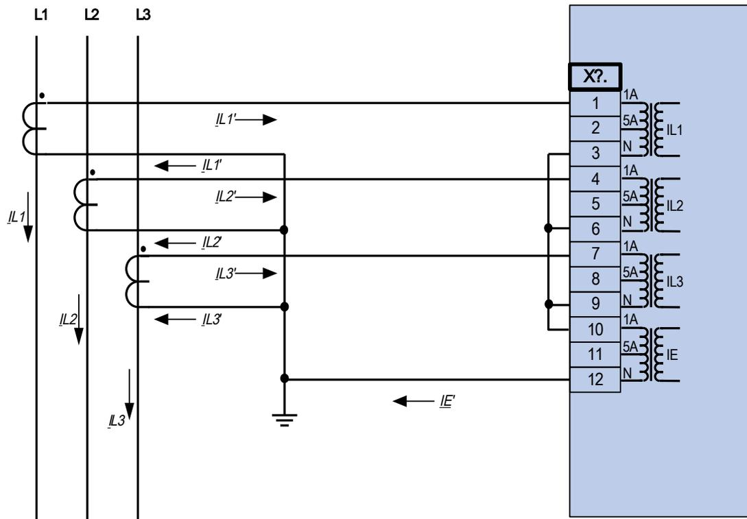
Dreiphasiger Stromwandleranschluss; In sekundär = 1 A.
