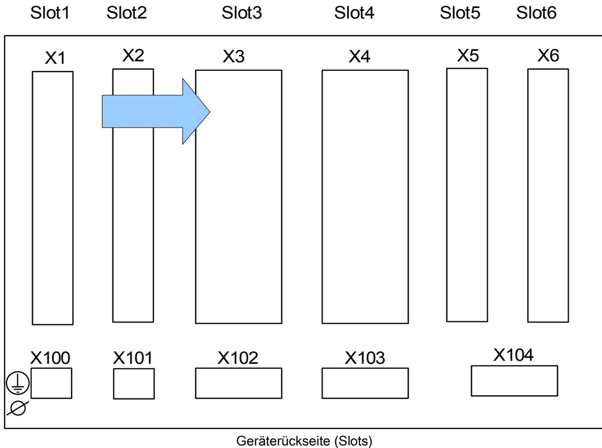
In diesem Slot befinden sich die Strommesseingänge für die Sternpunktseite des Differenzialschutzes.
