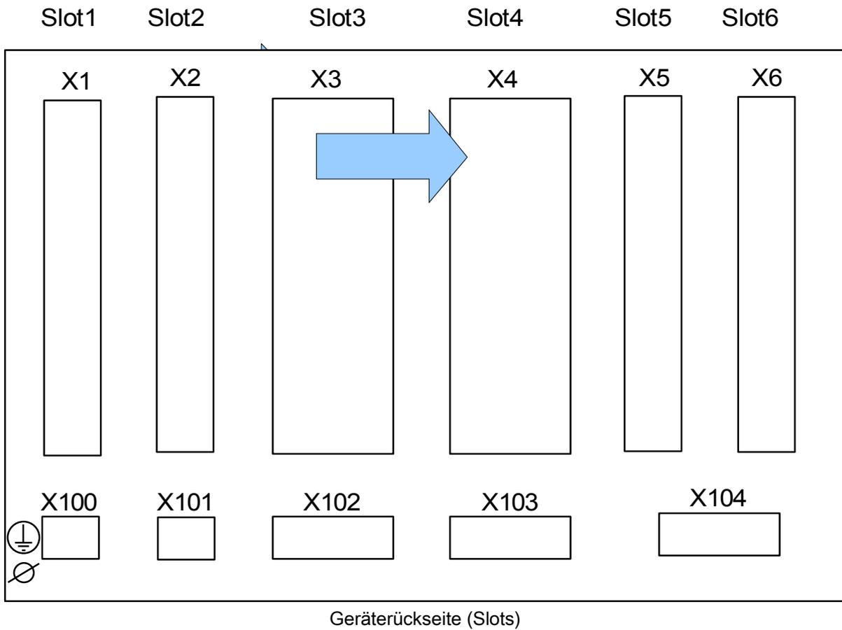
In diesem Slot befinden sich die Strommesseingänge für die Leitungsseite des Differentialsschutzes.
