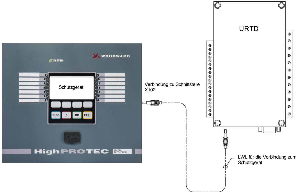
Vorkonfektionierte Kunststofflichtwellenleiter können von entsprechenden Lieferanten von Lichtwellenleiterprodukten bezogen werden. Meistens sind Lichtwellenleiter auch als Meterware erhältlich, mit Steckern, die vor Ort montiert werden können.
