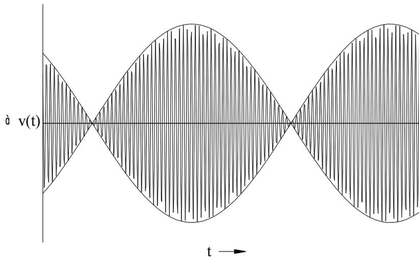
*Spannungsverlauf der Schwebespannung  $\Delta u(t)$ .*
