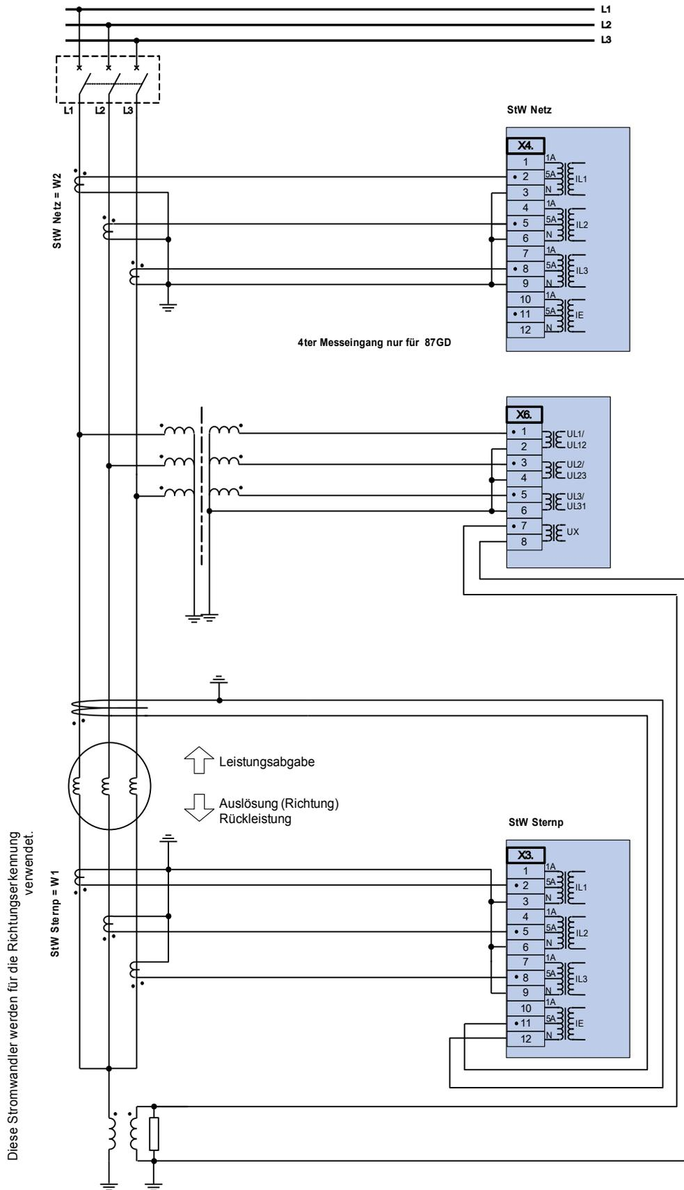
Hochimpedanz-Erdung mit Phasendifferenzialschutz und Synchrocheck
