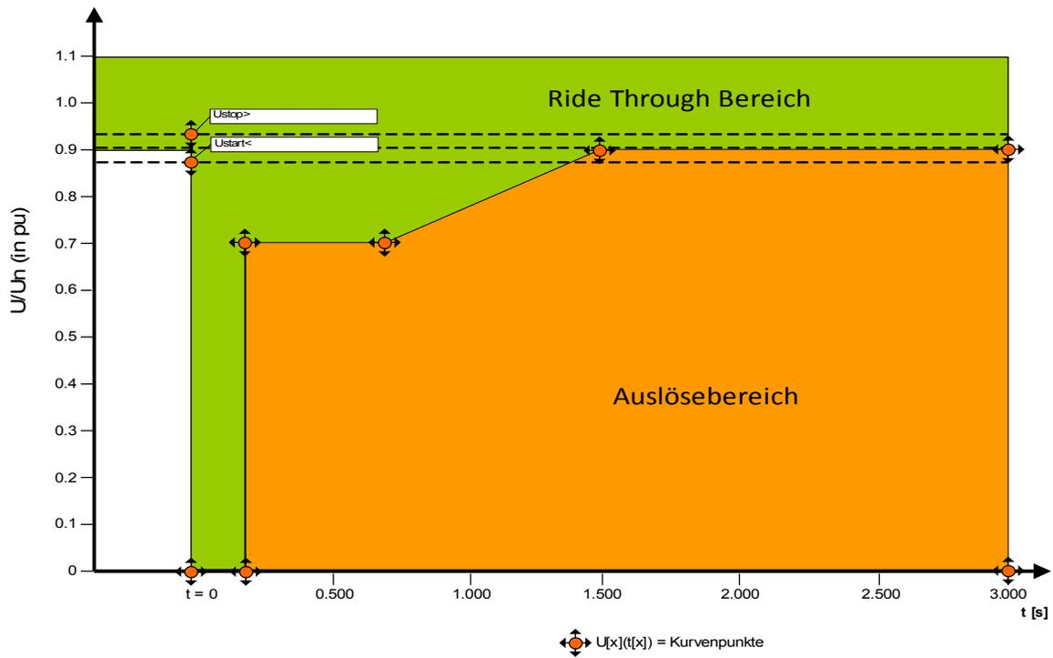
Das LVRT-Modul wechselt in den Standby-Modus zurück, wenn die Netzspannung den Stoppwert » $U_{stop}$ « wieder überschreitet.
