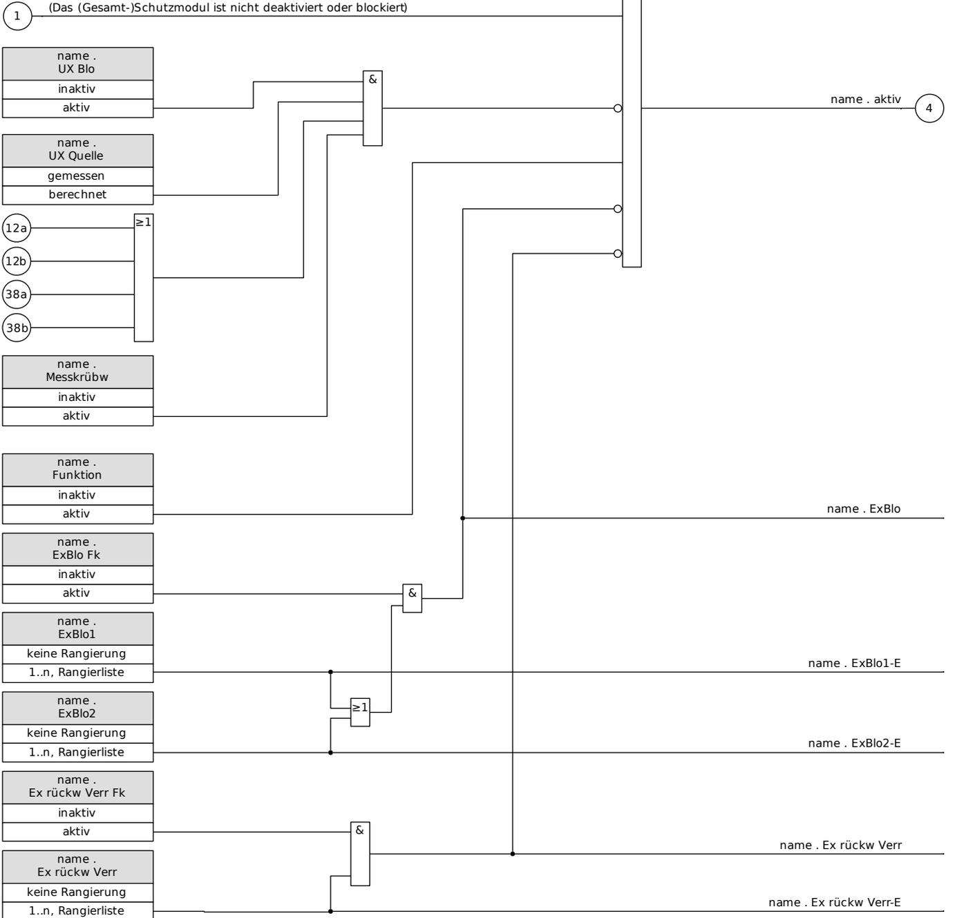
(\*) Alle Schutzstufen, die die Grundwelle oder Harmonische auswerten, werden blockiert, wenn die Frequenz ausserhalb des Nennbereiches liegt. Schutzstufen, die RMS verwenden, werden nicht blockiert.
