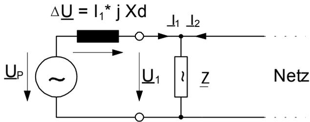
Polradwinkel bei konstanter Belastung des Generators
