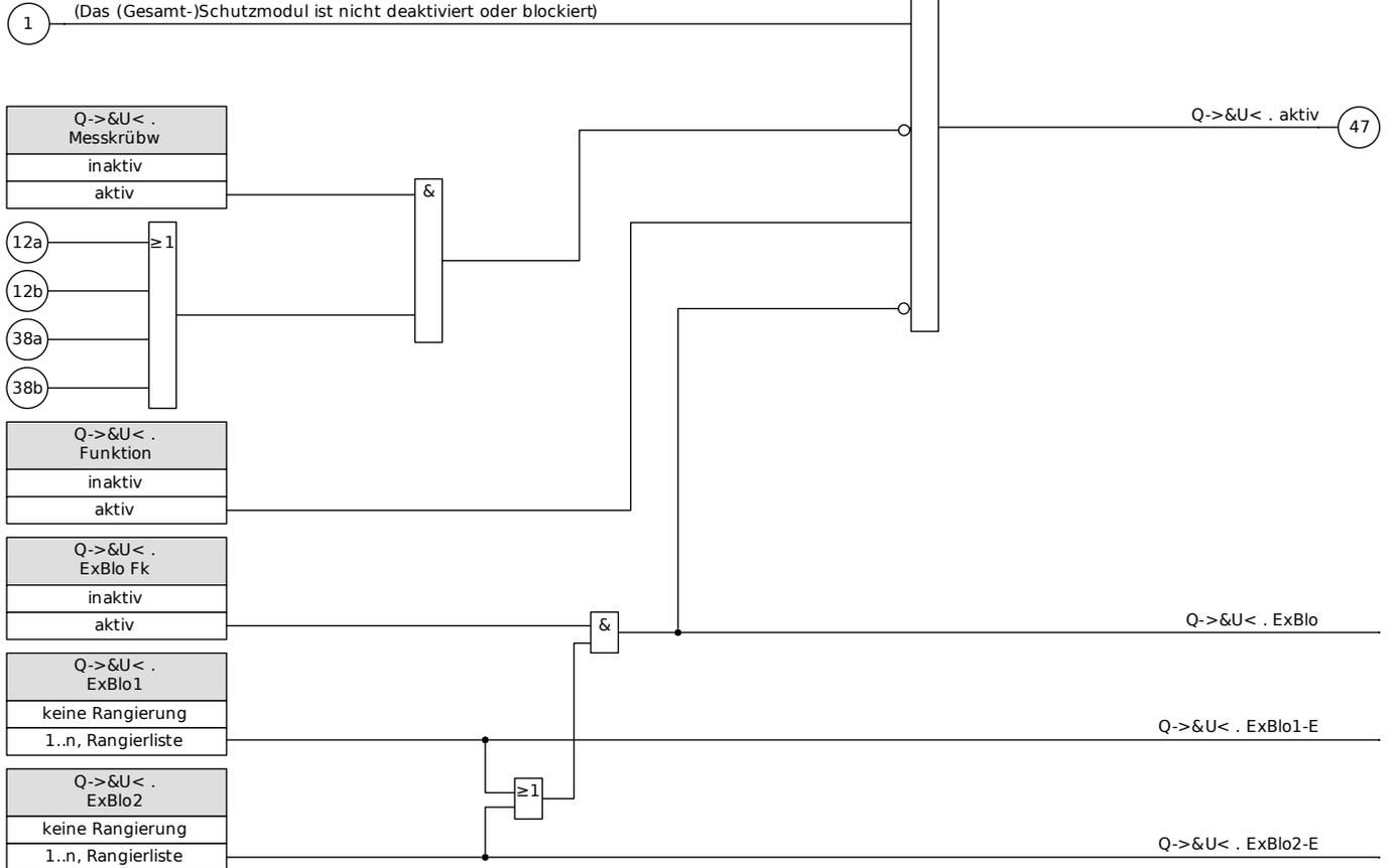
(\*) Alle Schutzstufen, die die Grundwelle oder Harmonische auswerten, werden blockiert, wenn die Frequenz ausserhalb des Nennbereiches liegt. Schutzstufen, die RMS verwenden, werden nicht blockiert.
