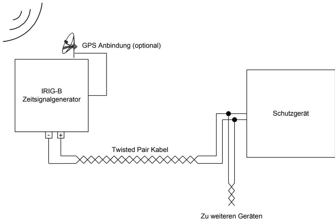
Der Einbauort der IRIG-B Schnittstelle hängt vom bestellten Gerätetyp ab. Nähere Informationen zur Einbaulage sind dem Anschlussbild oben auf dem Schutzgerät zu entnehmen.
