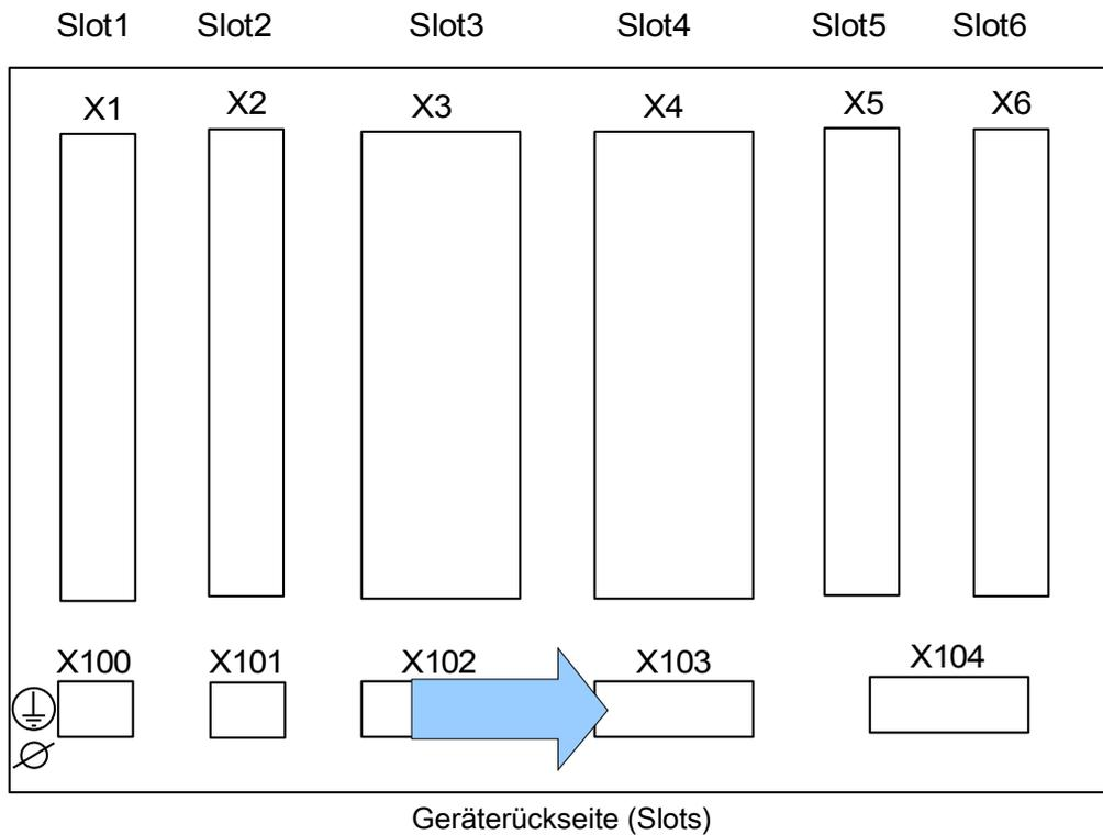
Aus dem Bestellschlüssel ergibt sich, welche Datenkommunikationsschnittstelle in Slot **X103** verbaut ist. Der Funktionsumfang hängt davon ab, welche Schnittstelle verbaut ist.
