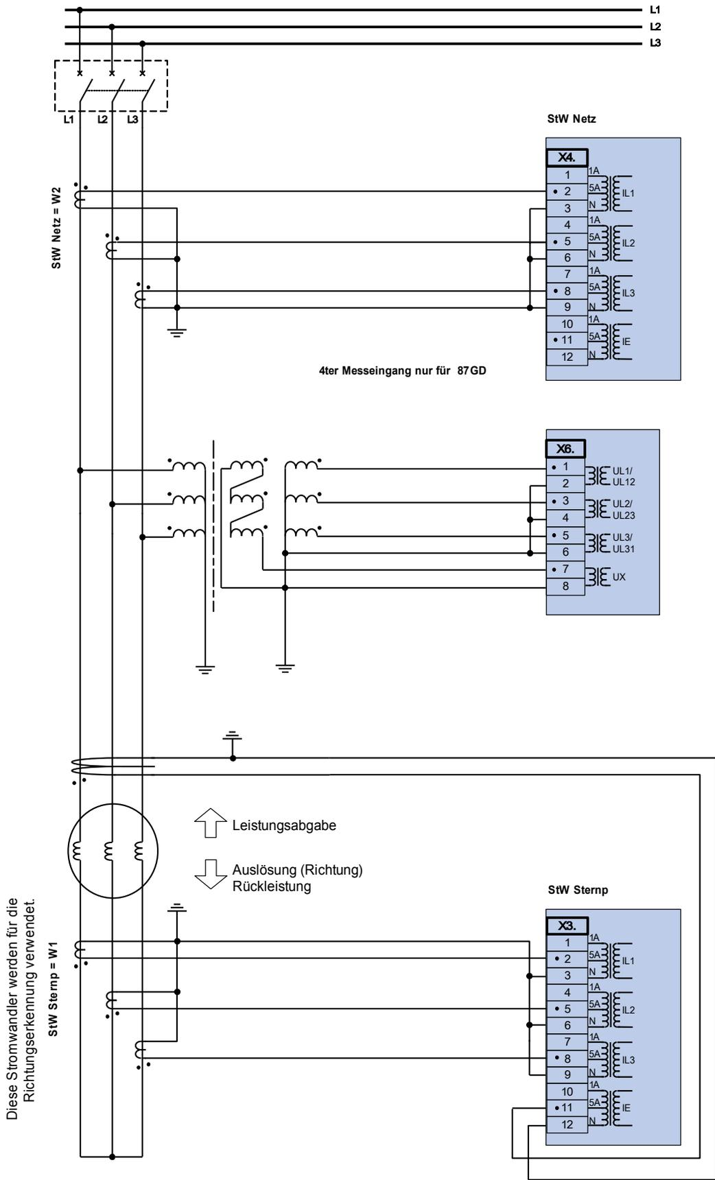
Hochimpedanz-Erdung mit Phasendifferenzialschutz und 100% Stator-Erdfehlerschutz
