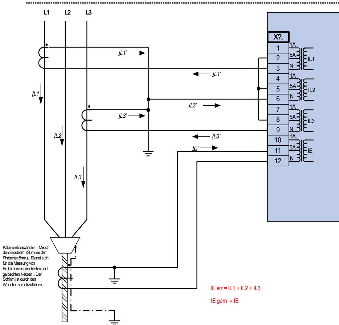
Zweiphasiger Stromwandleranschluss in V-Schaltung; In sekundär = 5 A.
