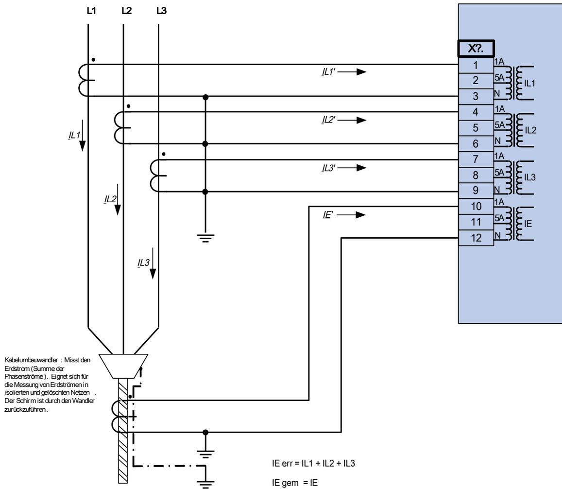
Dreiphasiger Stromwandleranschluss;  $I_n$  sekundär = 1 A.
