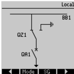
Der Kombischalter ist eine Kombination aus Trennerschalter und einem Erdungsschalter. Dieser Schalter schaltet zwischen der »EIN-POSITION« (z.B. Sammelschiene) und der Erdungsposition um.
