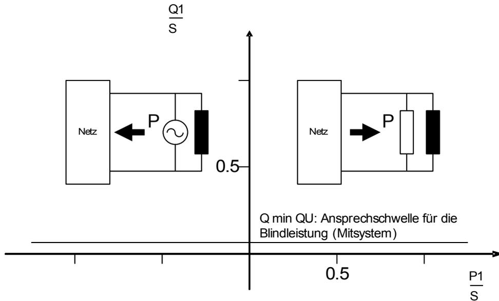
Durch die Mindeststromüberwachung (I1) im Mitsystem kann eine mögliche Überfunktion der Blindleistungüberwachung im unteren Leistungsbereich verhindert werden.
