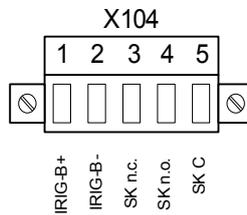
Der *Selbstüberwachungskontakt/Life-Kontakt (SK)* kann nicht konfiguriert werden. Der *Selbstüberwachungskontakt/Life-Kontakt (SK)* ist ein Wechselkontakt, der abfällt, wenn das Gerät einen internen Fehler erkennt. Nach Umschalten der Versorgungsspannung zieht der Kontakt nach Abschluss des Bootvorgangs (wenn der Schutz aktiv ist) an. Mit dem Anziehen des *Selbstüberwachungskontakts/Life-Kontakts (SK)* wird auch die entsprechende LED (System OK) aktiviert (siehe auch Kapitel Selbstüberwachung).
