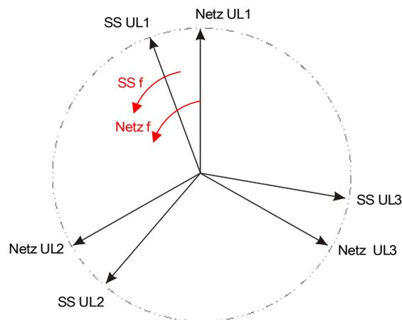
Wenn die Generatorfrequenz  $f_{SS}$  ungleich der Netzfrequenz  $f_{Netz}$  ist, so stellt sich zwischen den beiden Systemen eine Schwebefrequenz ein.
