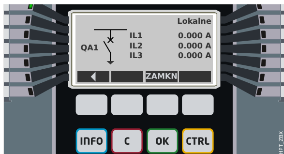
Rys. 120: Przykład strony sterowania z wyłącznikiem w pozycji otwartej.
