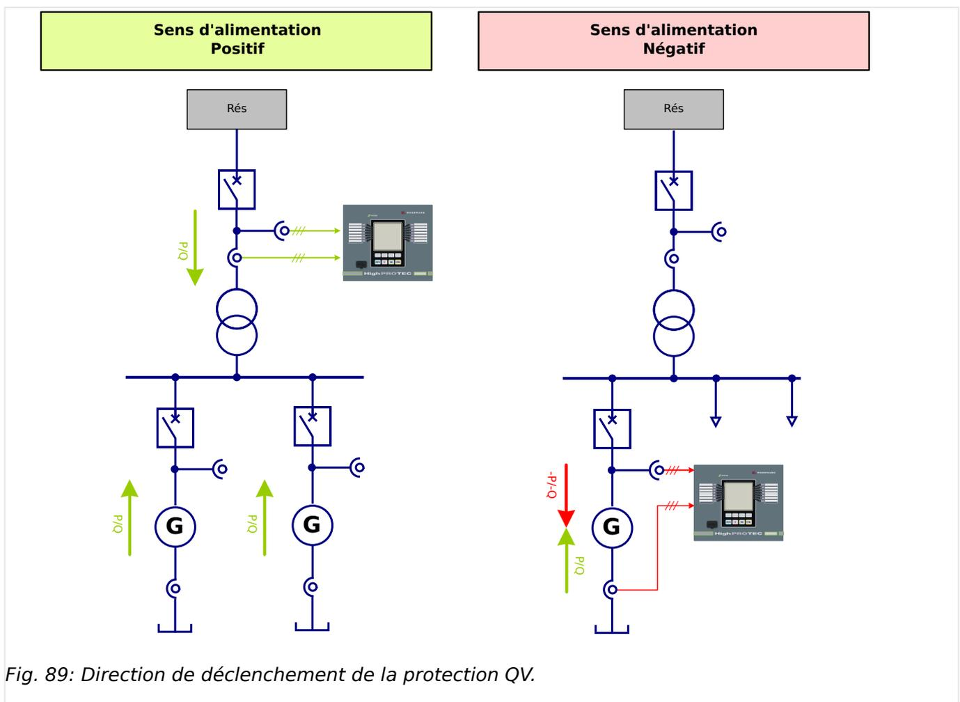
Fig. 89: Direction de déclenchement de la protection QV.
