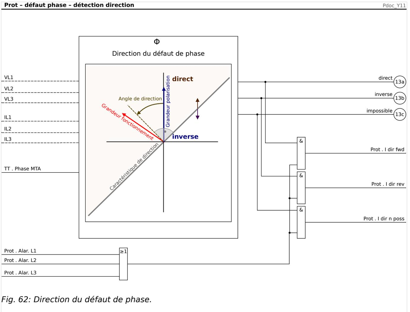
Le MCA4 évalue l'angle entre le courant de phase dont le courant est le plus élevé (*Grandeur de fonctionnement*) et la tension phase/phase des autres phases (*Grandeur de polarisation*). Pour les défauts en triphasé dans le cadre desquels la tension phase/phase est trop basse, une mémoire de tension est utilisée.
