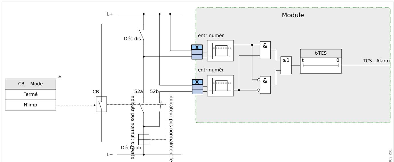
Fig. 114: Exemple de connexion : Surveillance du circuit de déclenchement avec de contacts auxiliaires de disjoncteur «Aux ON» (52a) et «Aux OFF» (52b).
