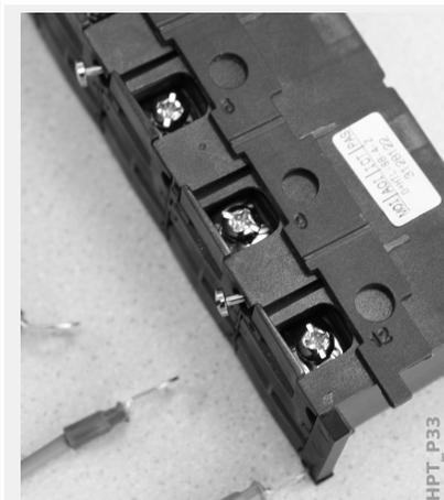
Déplacez le curseur sur le côté, de sorte que les vis et le contact métallique soit totalement accessibles.
