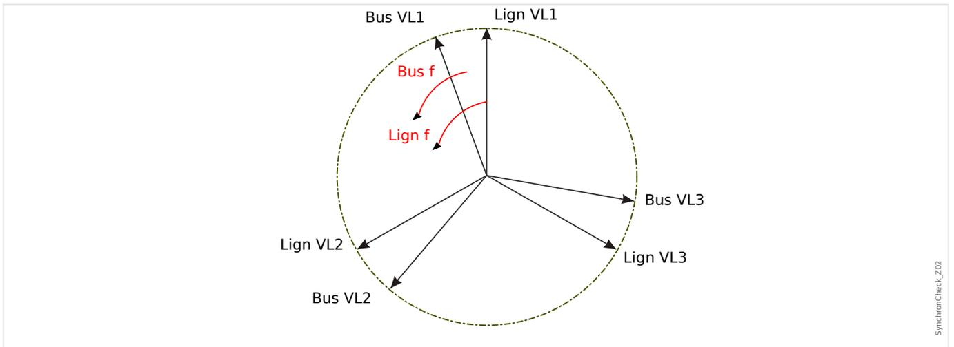
Si la fréquence du générateur  $f_{\text{Bus}}$  n'est pas égale à la fréquence du secteur  $f_{\text{Line}}$ , il se produit un glissement de fréquence  $\Delta F = |f_{\text{Bus}} - f_{\text{Line}}|$  entre les deux fréquences de réseau.
