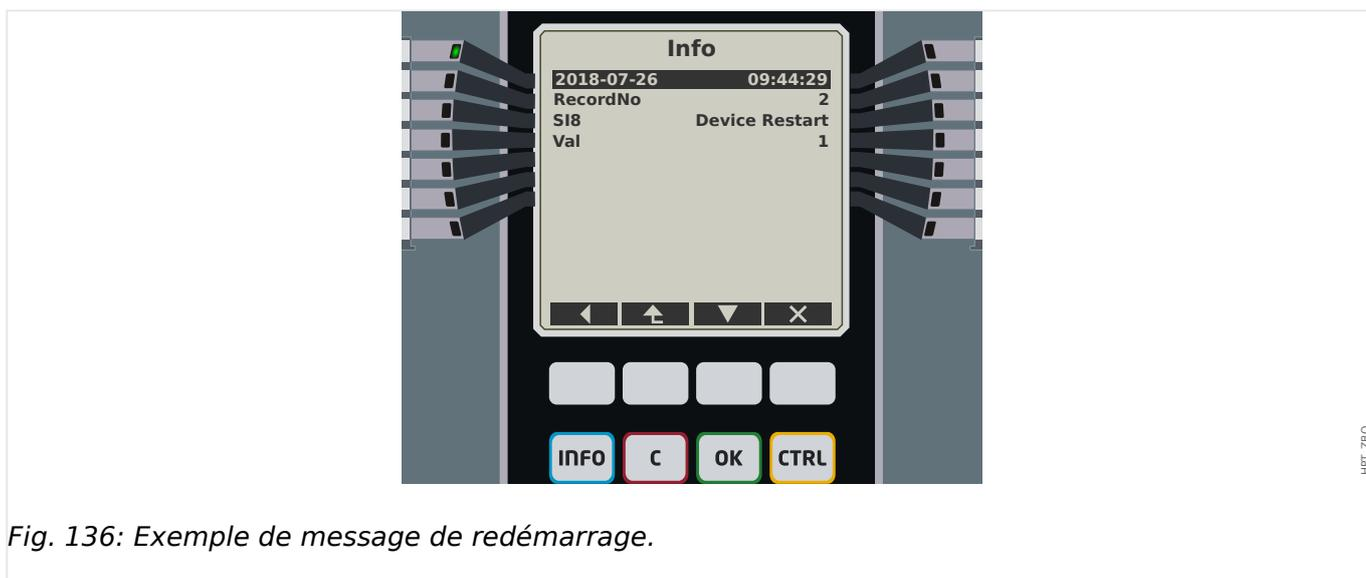
Fig. 136: Exemple de message de redémarrage.
