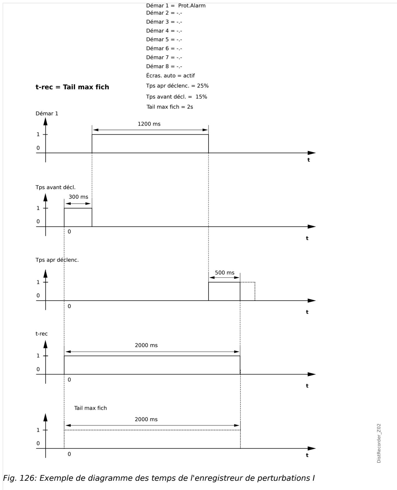
Fig. 126: Exemple de diagramme des temps de l'enregistreur de perturbations I
