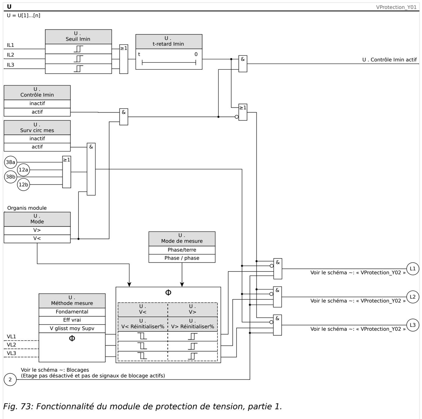
Fig. 73: Fonctionnalité du module de protection de tension, partie 1.
