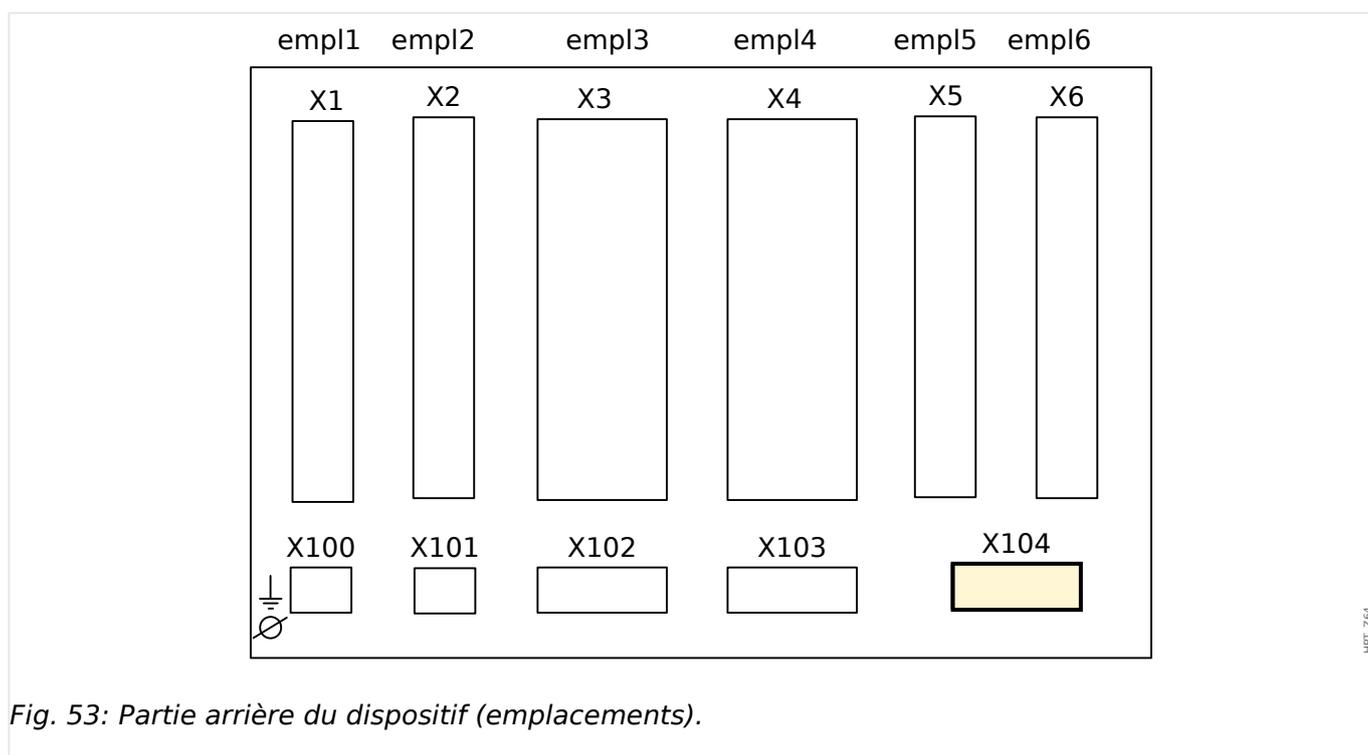
Fig. 53: Partie arrière du dispositif (emplacements).
