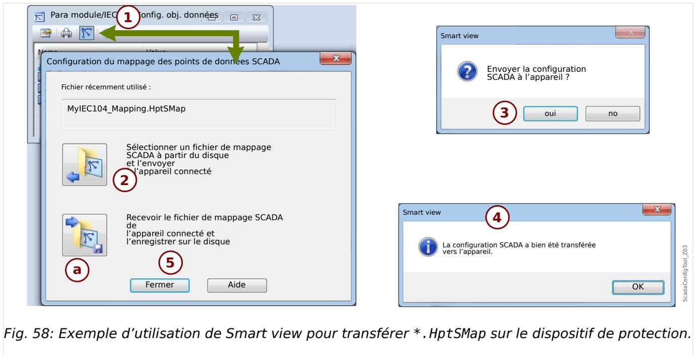
Fig. 58: Exemple d'utilisation de Smart view pour transférer \*.HptSMap sur le dispositif de protection.
