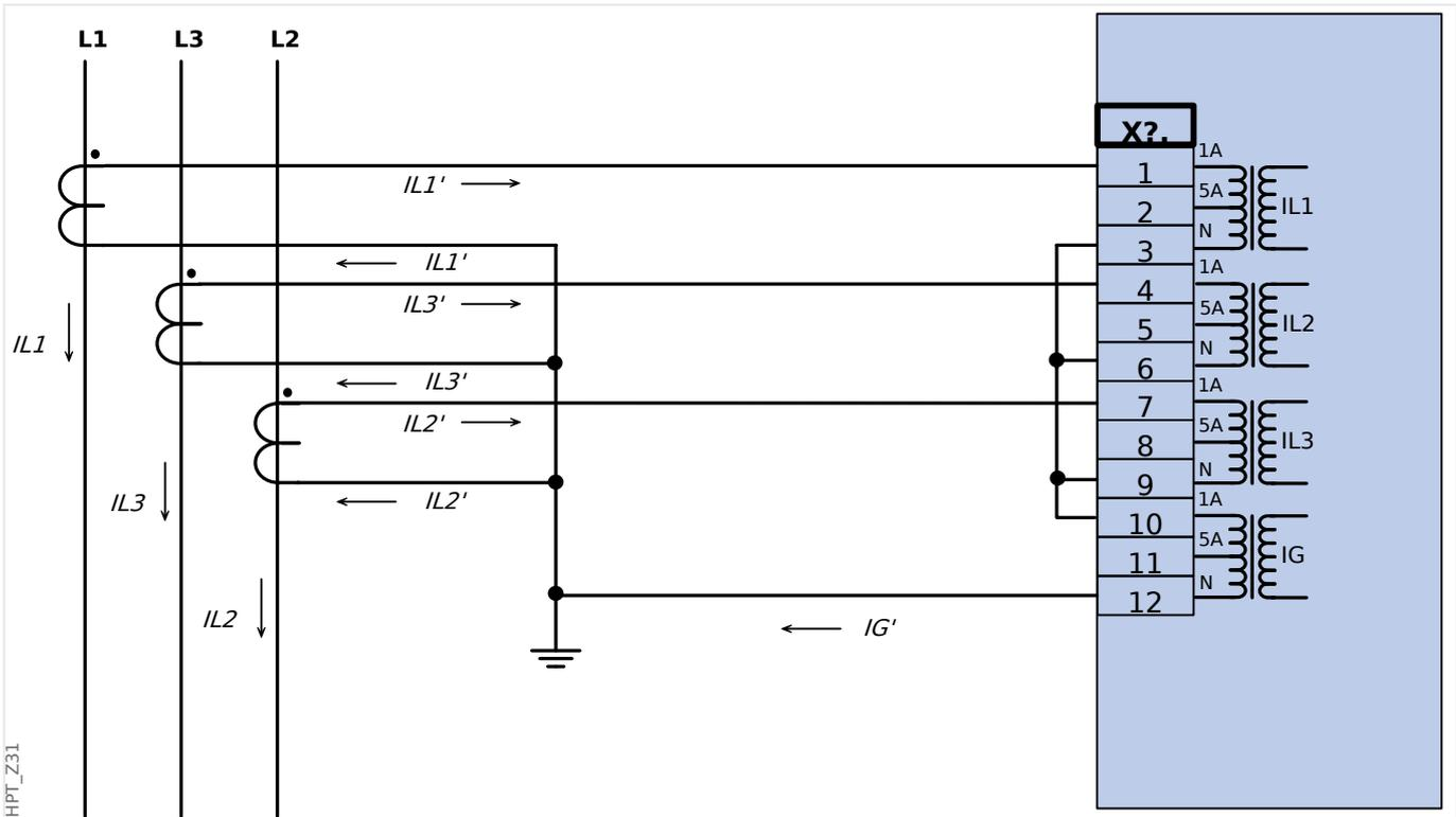
Fig. 24: Mesure de courant triphasé;  $I_n \text{ sec} = 1 \text{ A}$  Mesure courant via connexion de Holmgreen;  $I_{Gnom} \text{ sec} = 1 \text{ A}$
