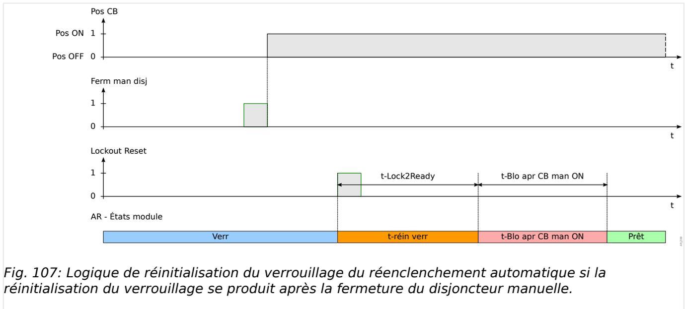
Fig. 107: Logique de réinitialisation du verrouillage du réenclenchement automatique si la réinitialisation du verrouillage se produit après la fermeture du disjoncteur manuelle.
