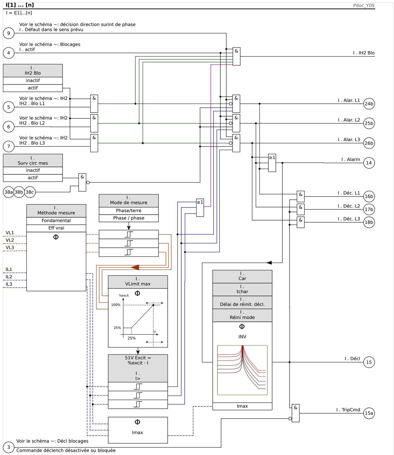
Remarque : par souci de simplicité, le schéma ci-dessus ne montre pas que si [para champ / TT] »TT con« = « Phase / phase », le paramètre »I[x]« . Mode de mesure est configuré en interne sur « Phase / phase », indépendamment de sa valeur configurée (voir le paragraphe « Avis » dans le [Chapitre 4.4.3](#)).
