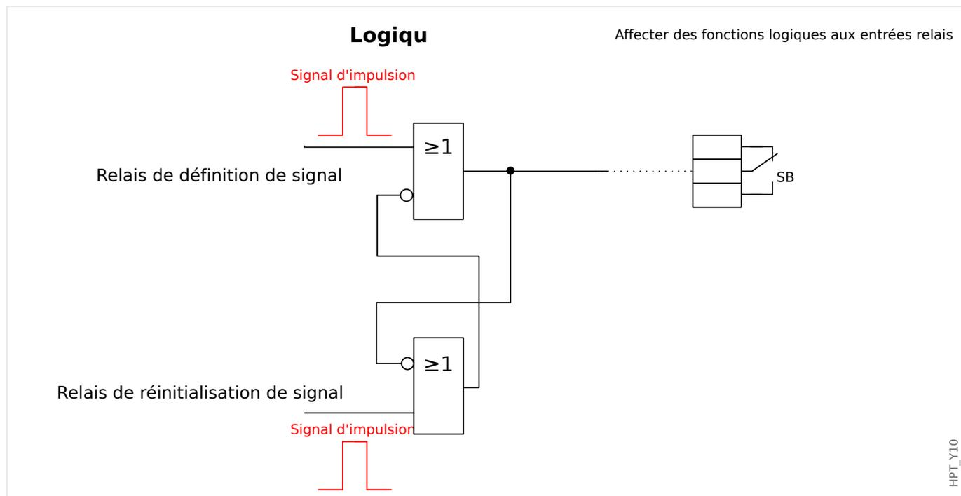
Les signaux de sortie binaires du DNP ne peuvent pas être utilisés directement pour commuter les relais parce que les sorties binaires DNP sont des signaux d'impulsion (par définition DNP, pas d'état stable). Des états stables peuvent être créés au moyen de fonctions logiques. Les fonctions logiques peuvent être affectées sur les entrées de relais.
