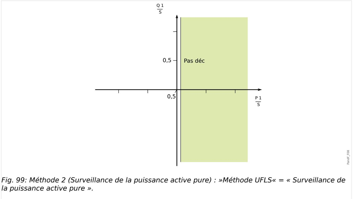
Fig. 99: Méthode 2 (Surveillance de la puissance active pure) : »Méthode UFLS« = « Surveillance de la puissance active pure ».
