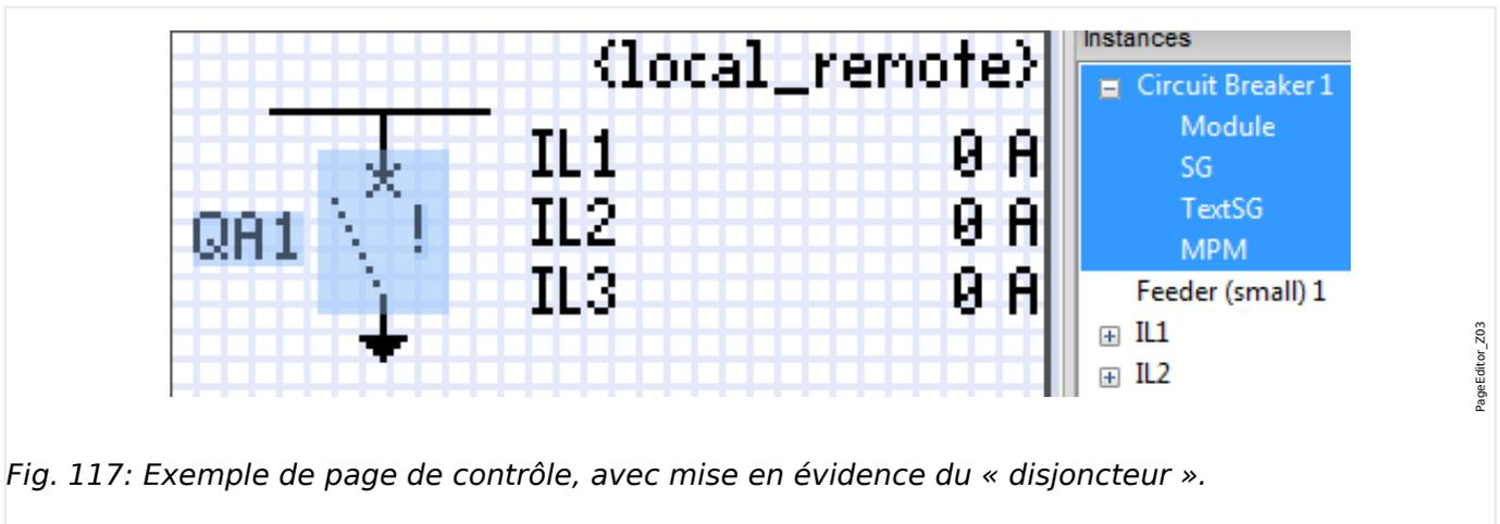
Fig. 117: Exemple de page de contrôle, avec mise en évidence du « disjoncteur ».
