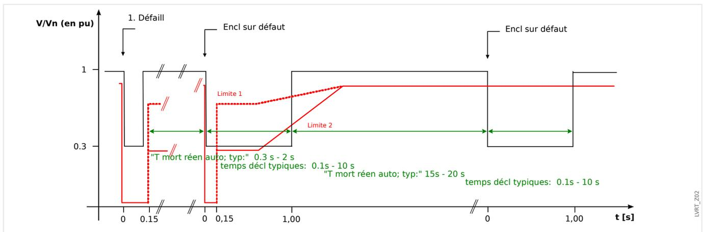
Fig. 77: Exécution d'une courbe de tension lors de l'échec d'un réenclenchement automatique en deux étapes ; source : Technische Richtlinie, Erzeugungsanlagen am Mittelspannungsnetz, Ausgabe Juni 2008, BDEW Bundesverband der Energie- und Wasserwirtschaft e.V. (Page 89).
