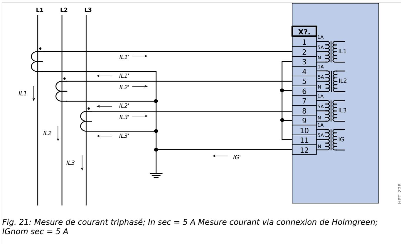
Fig. 21: Mesure de courant triphasé;  $In\ sec = 5\ A$  Mesure courant via connexion de Holmgreen;  $IGnom\ sec = 5\ A$
