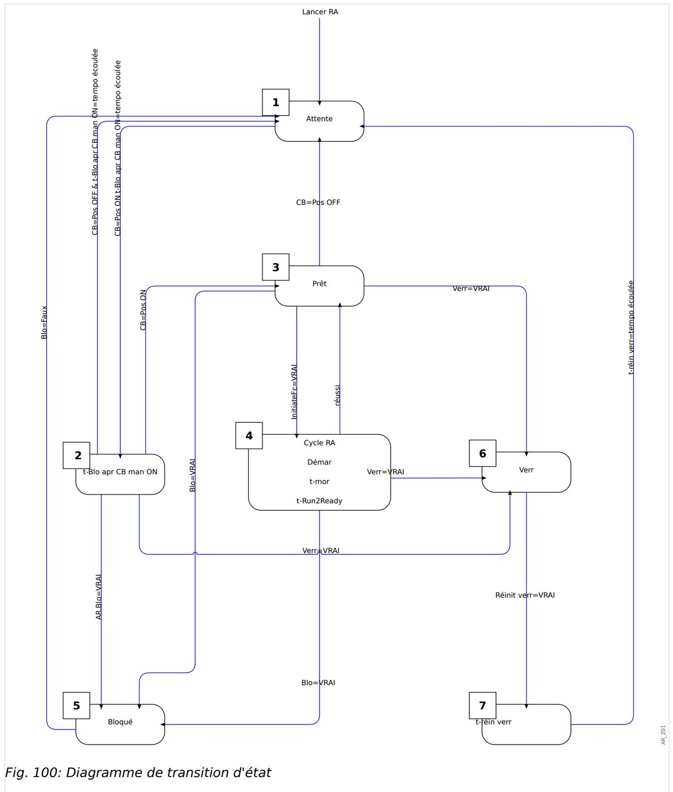
Fig. 100: Diagramme de transition d'état
