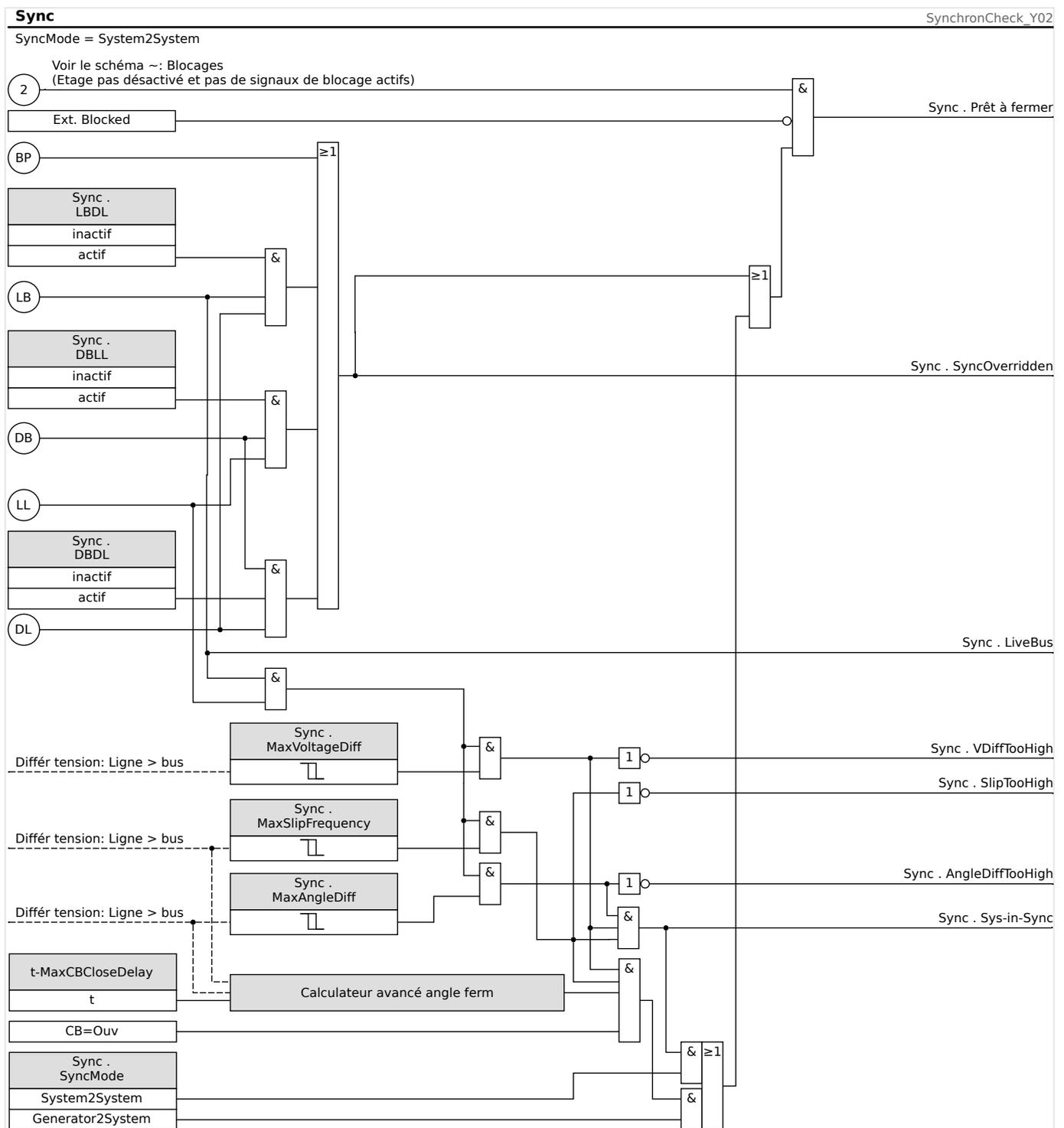
Fig. 111: Fonctionnalité du module «Sync», « System2System ».
