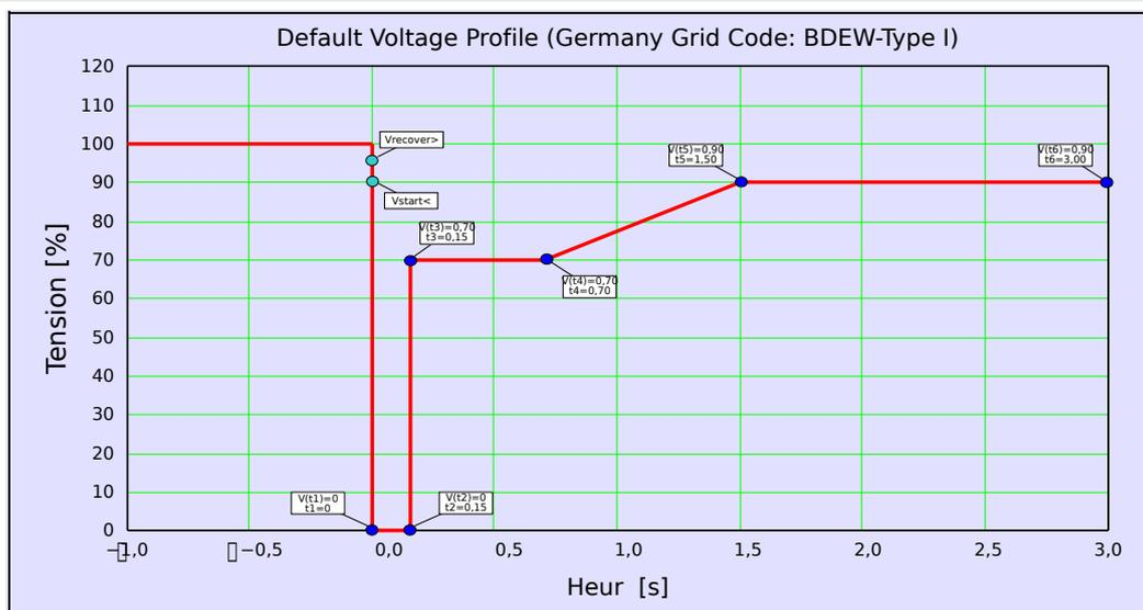
Fig. 79: Profil LVRT prédéfini en usine (BDEW-Type I).
