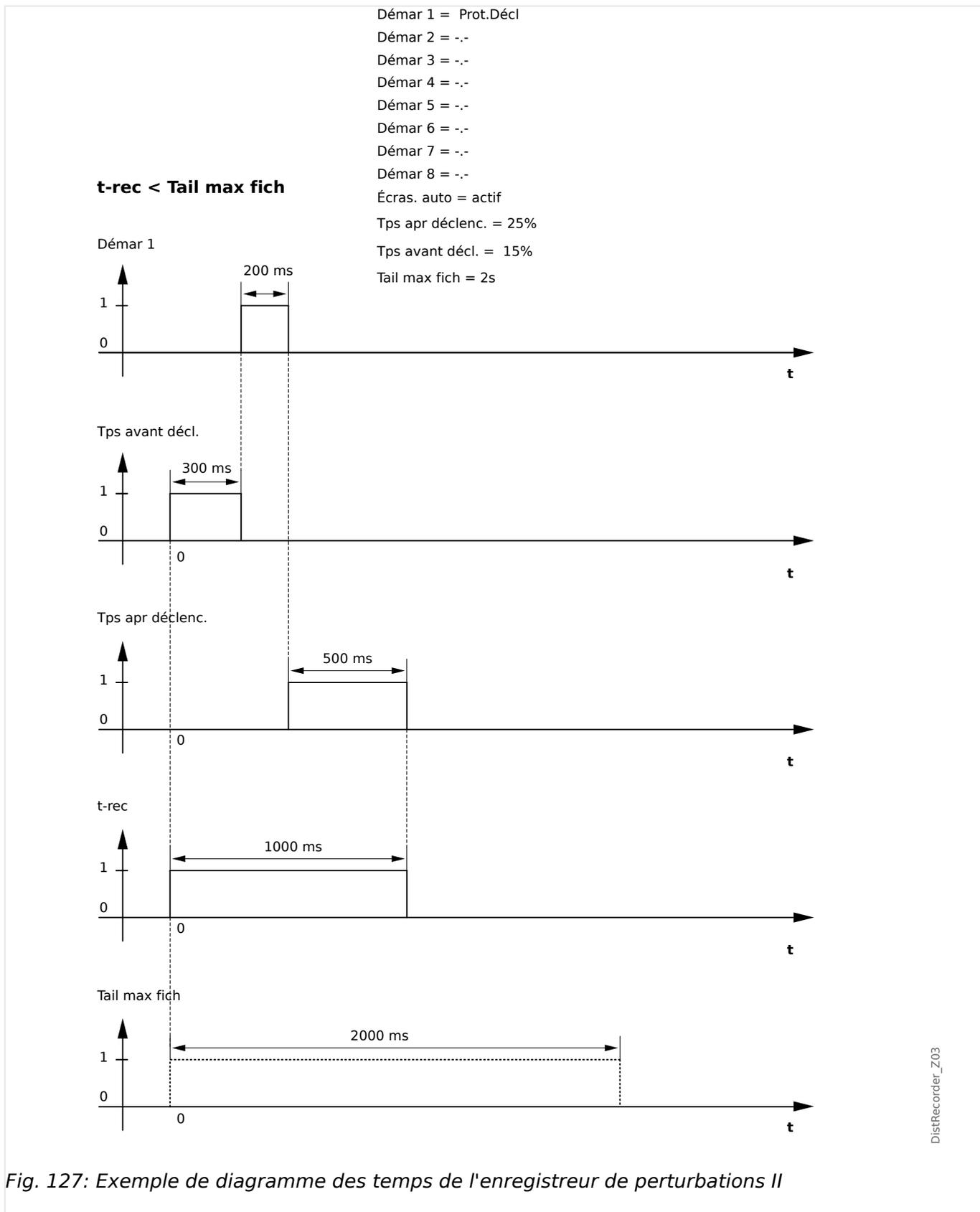
Fig. 127: Exemple de diagramme des temps de l'enregistreur de perturbations II
