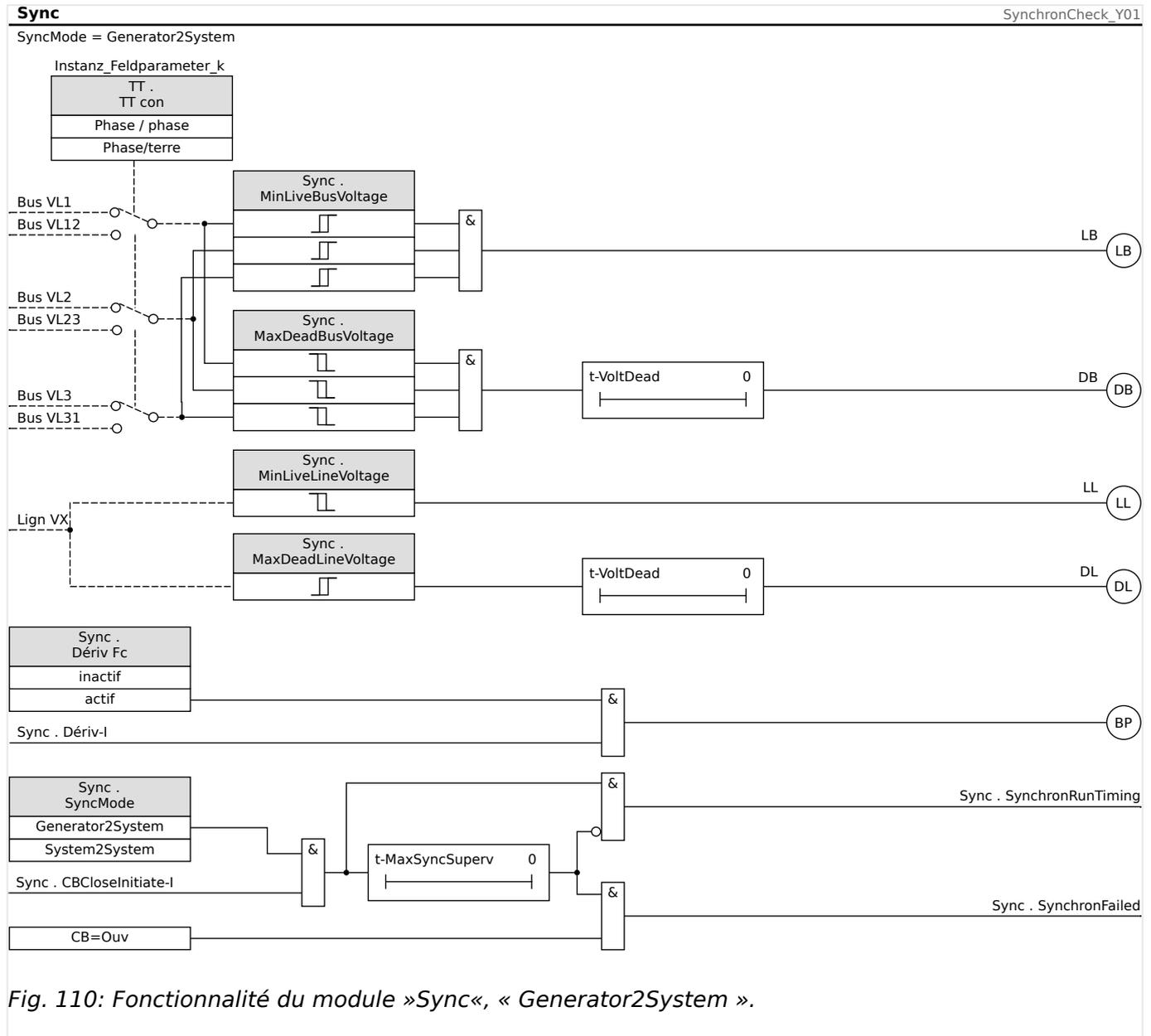
Fig. 110: Fonctionnalité du module »Sync«, « Generator2System ».
