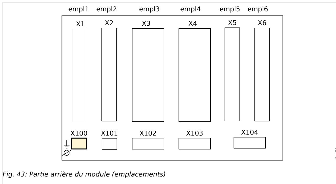
Fig. 43: Partie arrière du module (emplacements)
