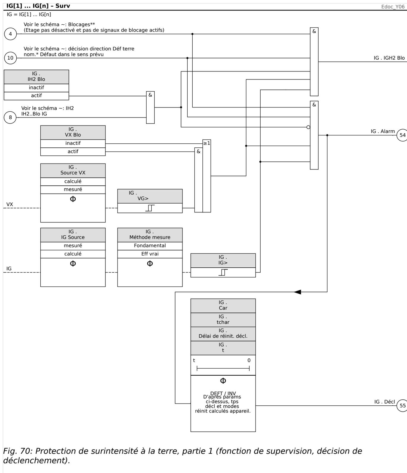
Fig. 70: Protection de surintensité à la terre, partie 1 (fonction de supervision, décision de déclenchement).
