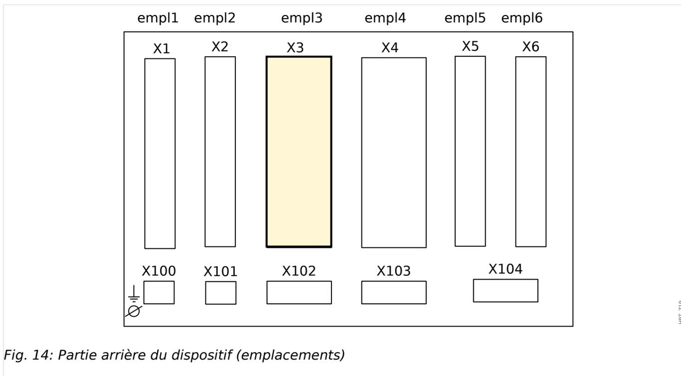
Fig. 14: Partie arrière du dispositif (emplacements)
