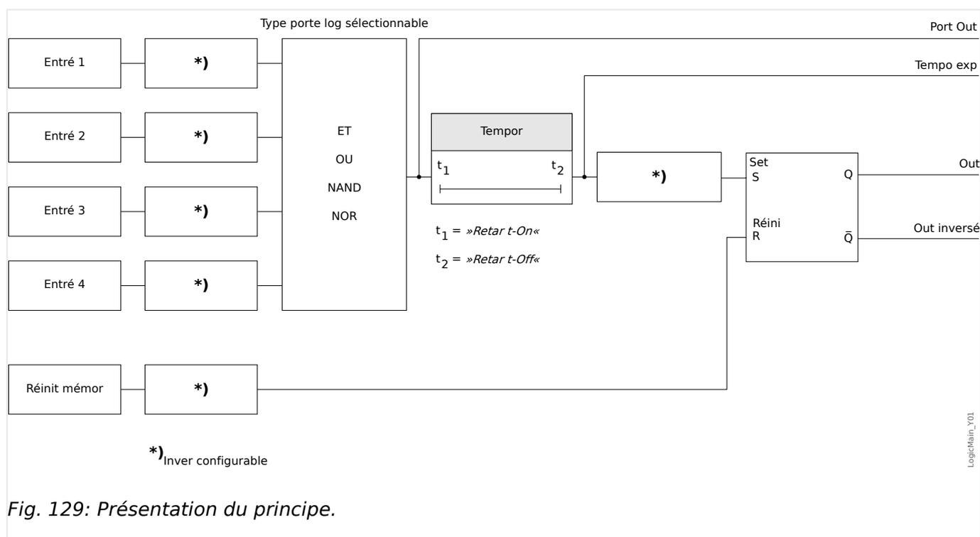
Fig. 129: Présentation du principe.
