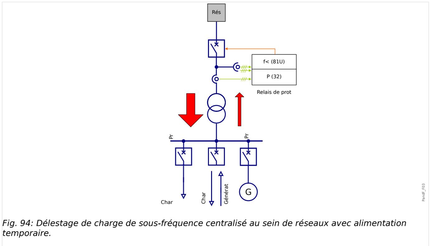
Fig. 94: Délestage de charge de sous-fréquence centralisé au sein de réseaux avec alimentation temporaire.
