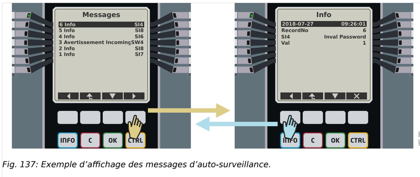
Fig. 137: Exemple d'affichage des messages d'auto-surveillance.
