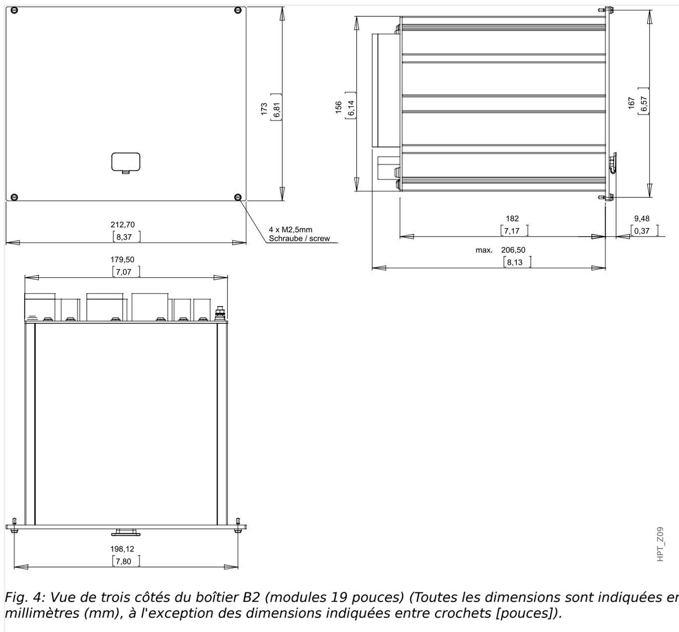
Fig. 4: Vue de trois côtés du boîtier B2 (modules 19 pouces) (Toutes les dimensions sont indiquées en millimètres (mm), à l'exception des dimensions indiquées entre crochets [pouces]).
