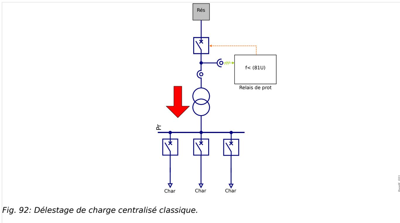
Fig. 92: Délestage de charge centralisé classique.
