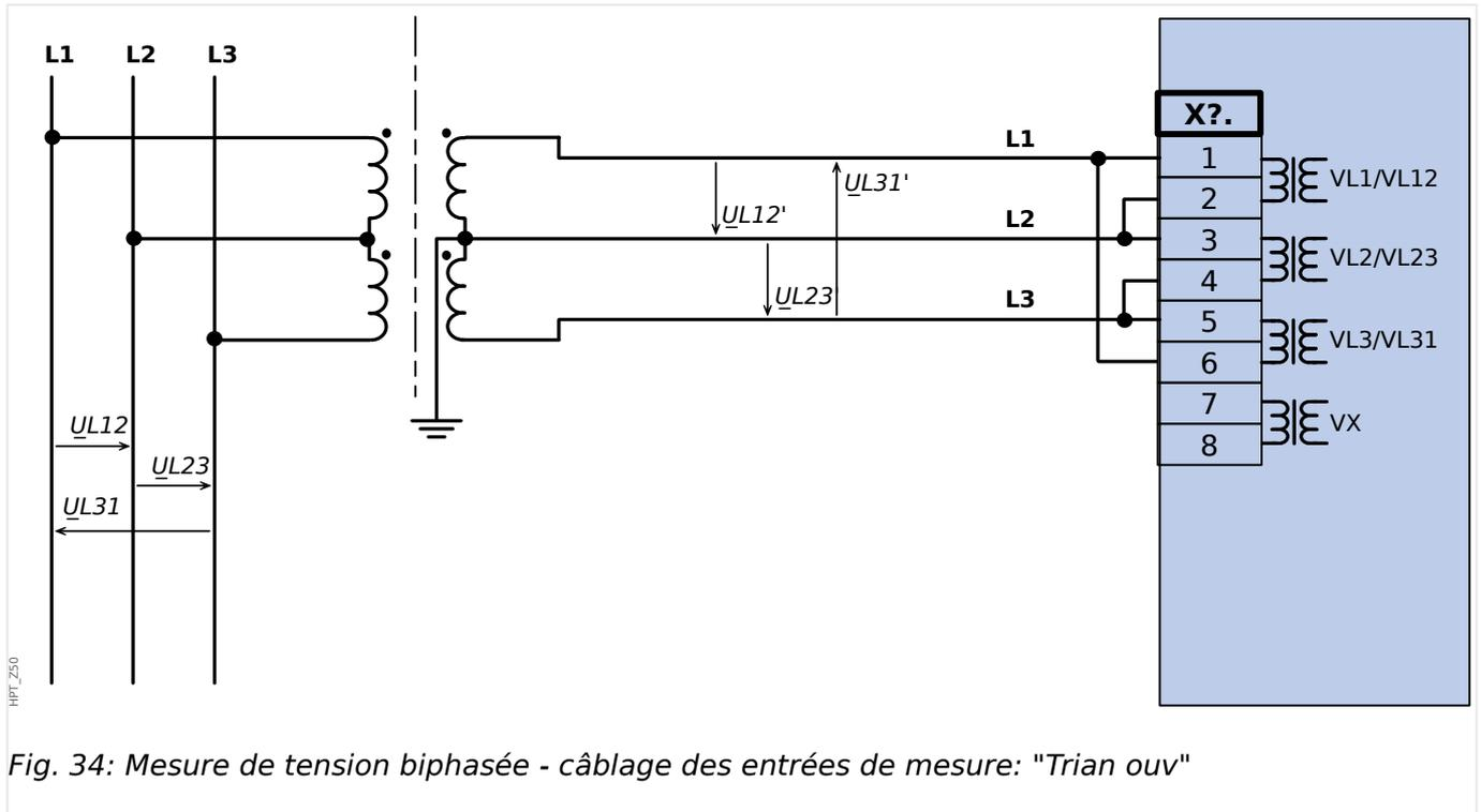
Fig. 34: Mesure de tension biphasée - câblage des entrées de mesure: "Triangulaire"
