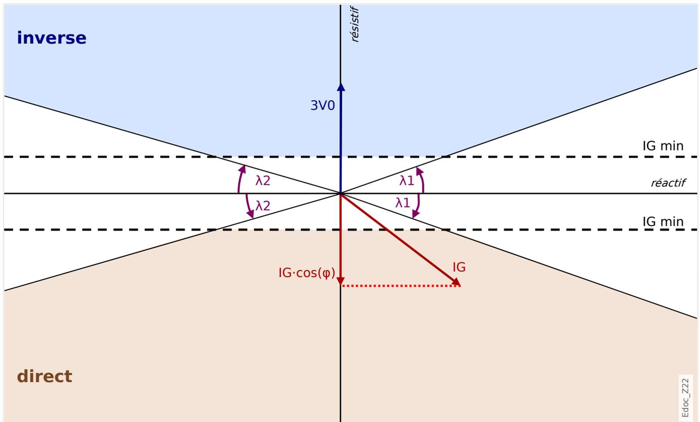
Fig. 65: Principe de détermination de la direction pour la méthode « cos(φ) ».
