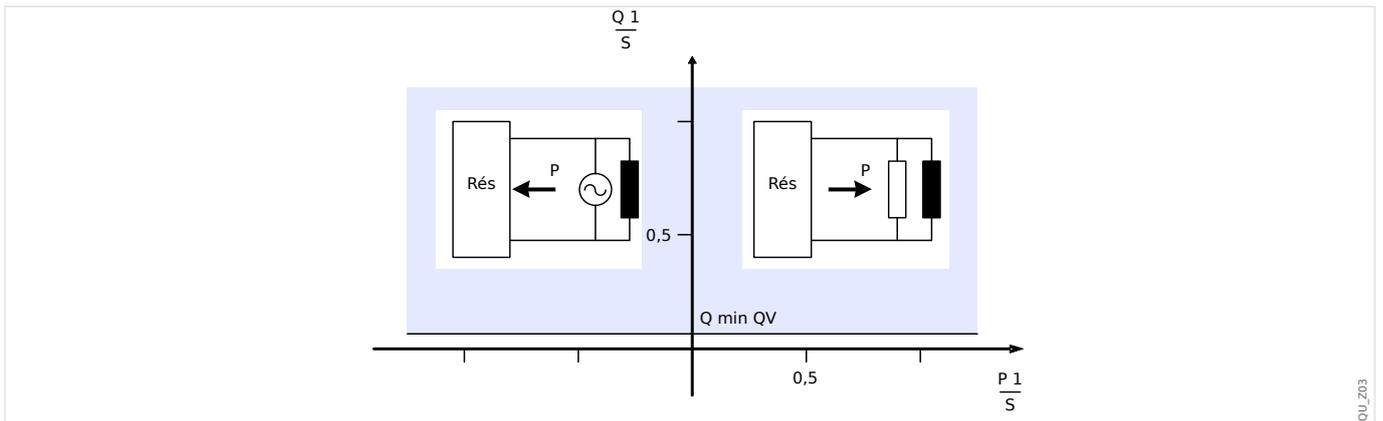
Fig. 91: Méthode 2 : Surveillance de la puissance réactive pure
