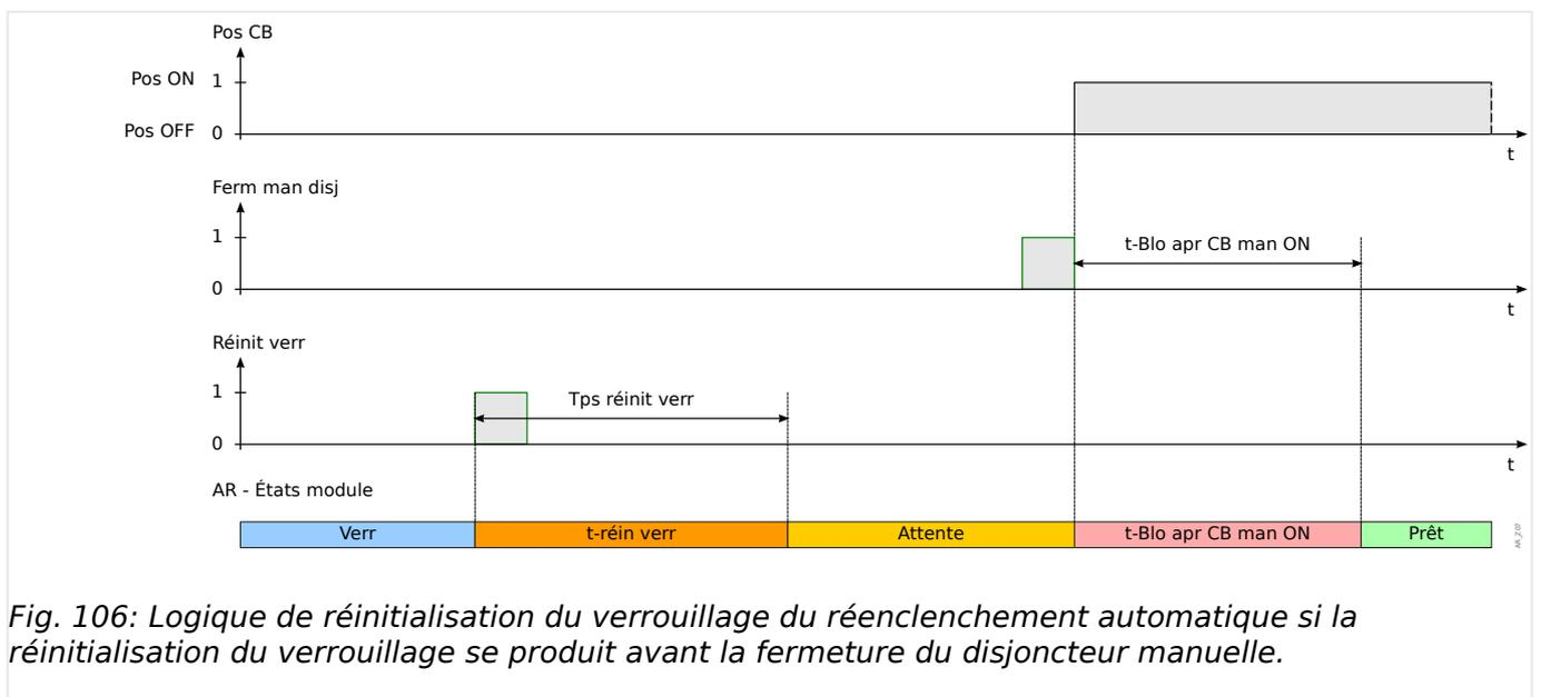
Fig. 106: Logique de réinitialisation du verrouillage du réenclenchement automatique si la réinitialisation du verrouillage se produit avant la fermeture du disjoncteur manuelle.
