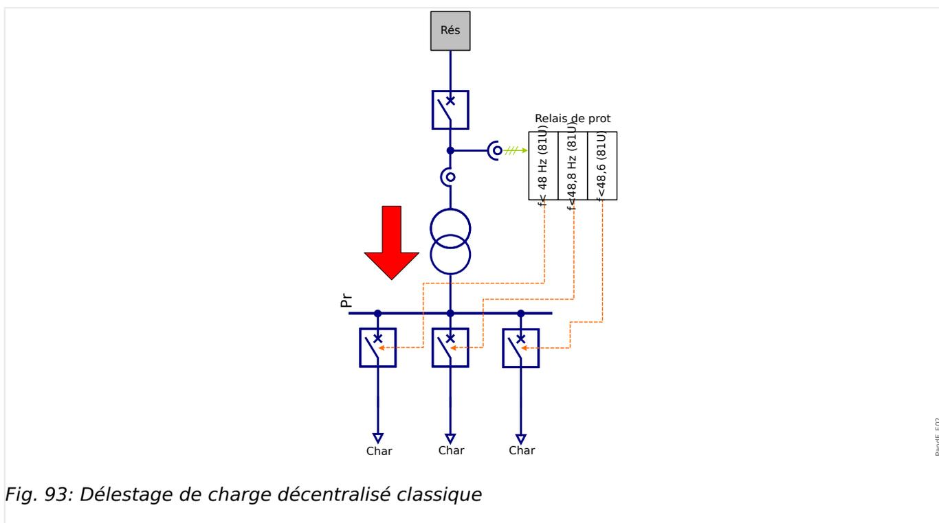
Fig. 93: Délestage de charge décentralisé classique
