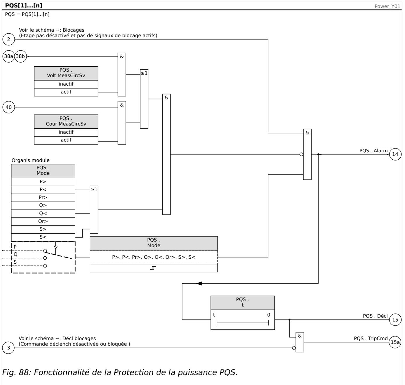
Fig. 88: Fonctionnalité de la Protection de la puissance PQS.
