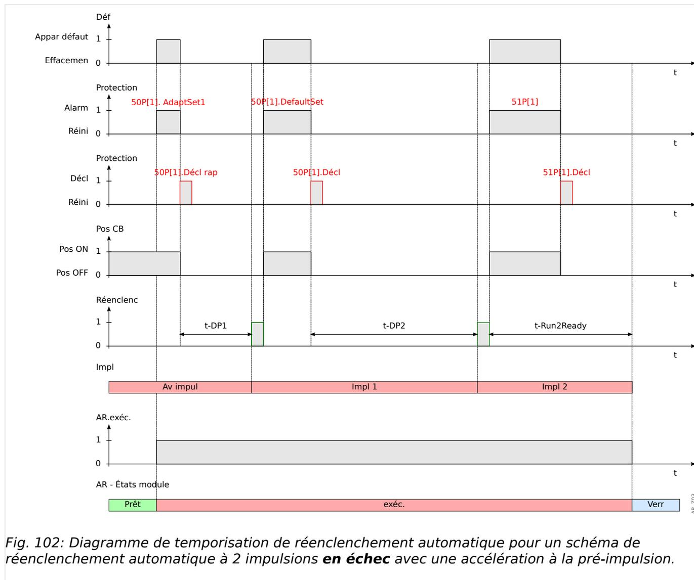
Fig. 102: Diagramme de temporisation de réenclenchement automatique pour un schéma de réenclenchement automatique à 2 impulsions **en échec** avec une accélération à la pré-impulsion.
