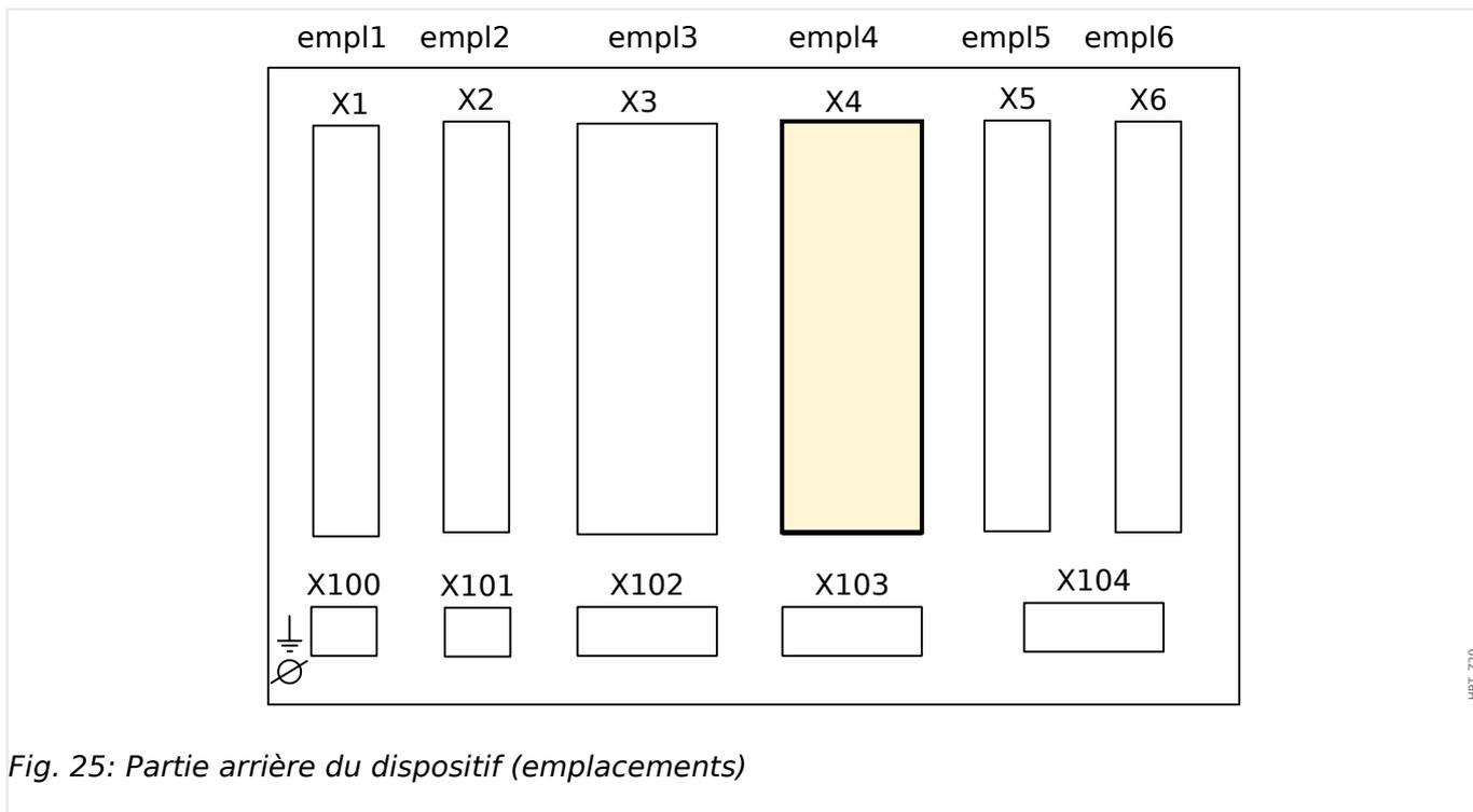
Fig. 25: Partie arrière du dispositif (emplacements)
