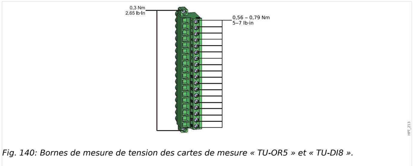
Fig. 140: Bornes de mesure de tension des cartes de mesure « TU-OR5 » et « TU-DI8 ».
