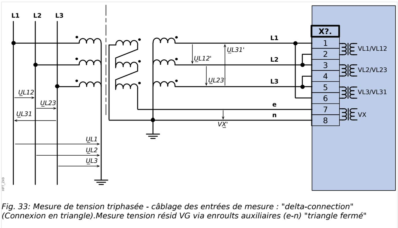
Fig. 33: Mesure de tension triphasée - câblage des entrées de mesure : "delta-connection" (Connexion en triangle). Mesure tension résid VG via enroults auxiliaires (e-n) "triangle fermé"
