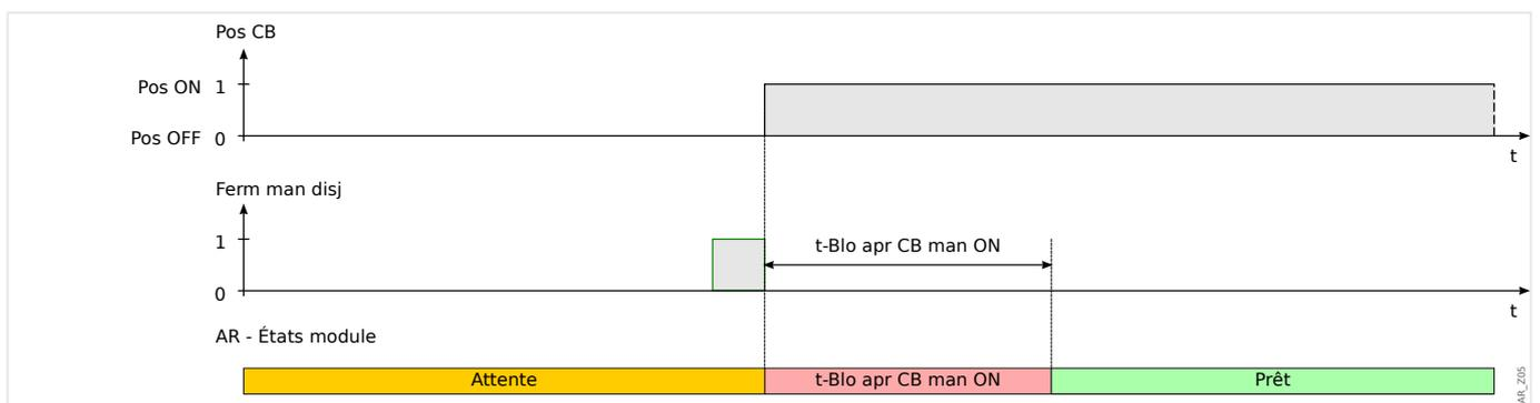
Fig. 104: États du réenclenchement automatique pendant la fermeture manuelle du disjoncteur.
