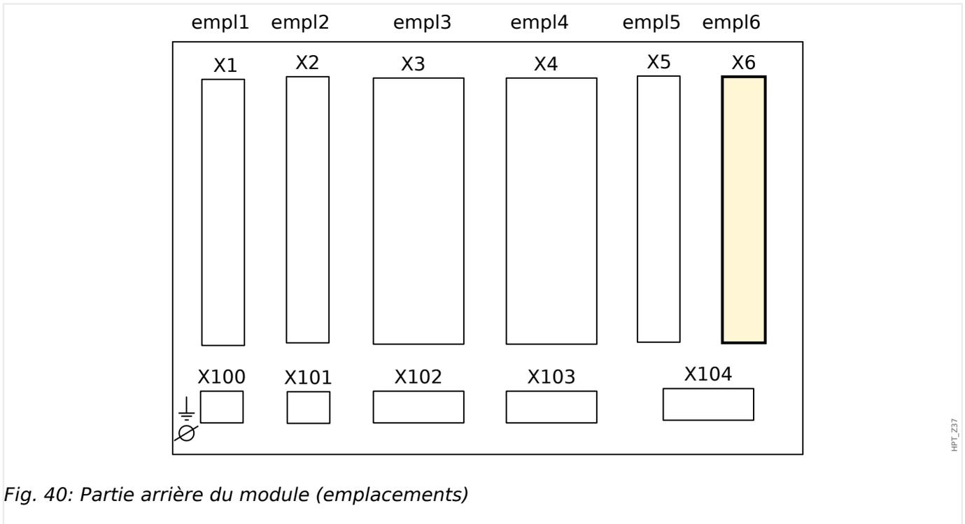
Fig. 40: Partie arrière du module (emplacements)
