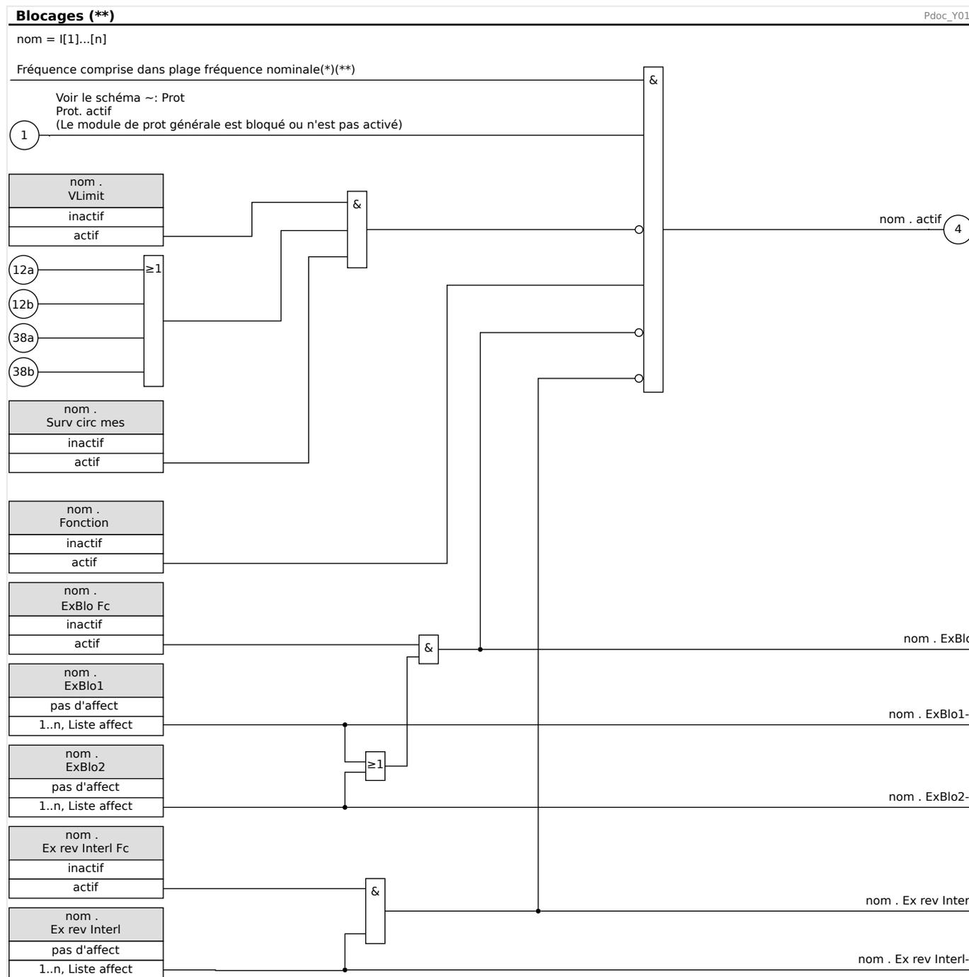
(\*) Toutes les fonctions de protection utilisant les valeurs harmoniques ou fondamentales mesurées sont bloquées si la fréquence sort de la plage nominale. Les fonctions de protection utilisant les valeurs efficaces restent actives. Voir le chapitre « Grande plage de fréquence ».
