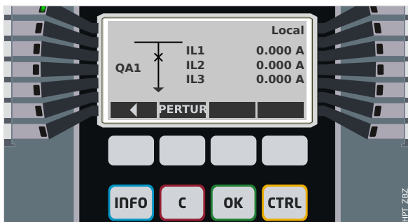
Fig. 118: Ejemplo de página de control, con el circuito en posición cerrada.
