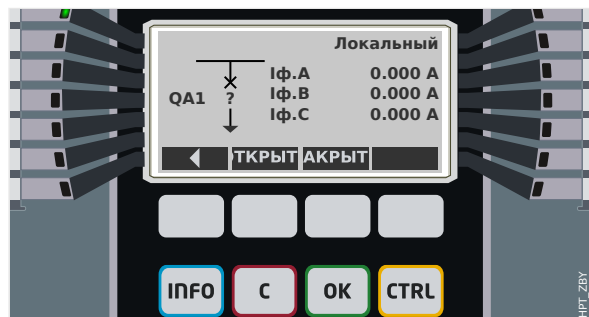
Рис. 128: Пример страницы управления, выключатель в аварийном (недопустимое состояние) положении.
