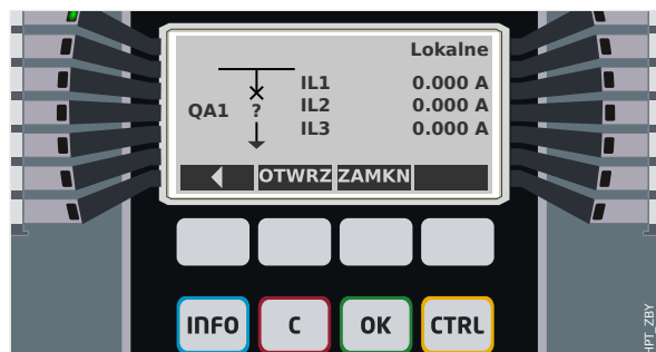
Rys. 128: Przykład strony sterowania z wyłącznikiem w pozycji zakłóconej (lub nieprawidłowej).
