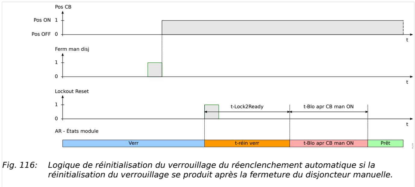
Fig. 116: Logique de réinitialisation du verrouillage du réenclenchement automatique si la réinitialisation du verrouillage se produit après la fermeture du disjoncteur manuelle.
