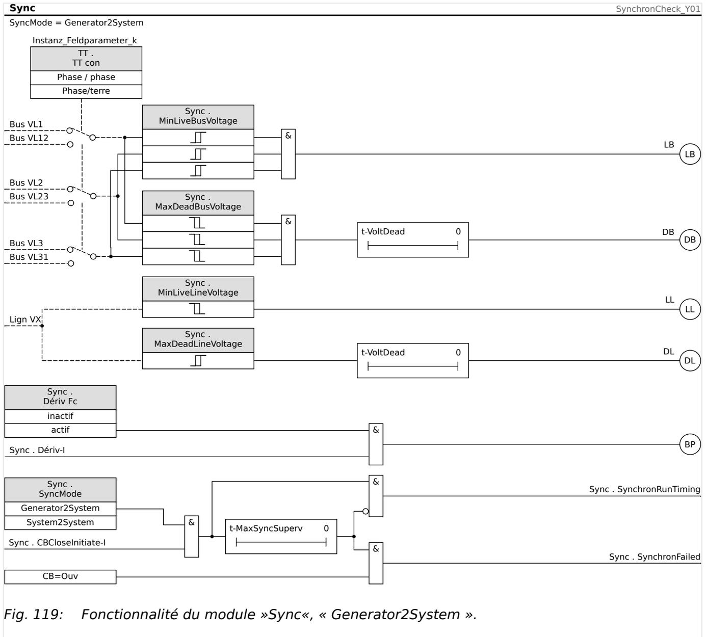
Fig. 119: Fonctionnalité du module »Sync«, « Generator2System ».
