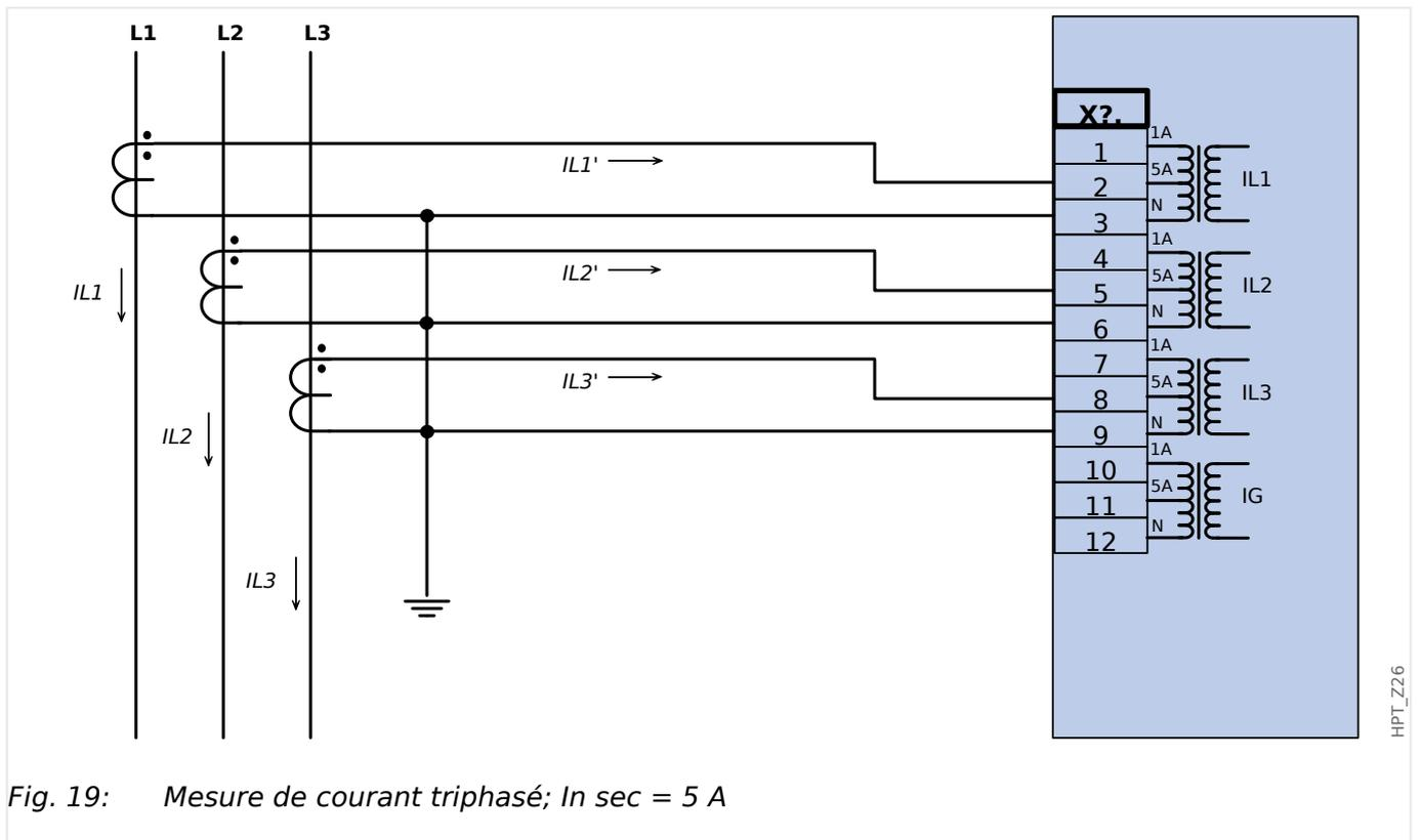
Fig. 19: *Mesure de courant triphasé; In sec = 5 A*
