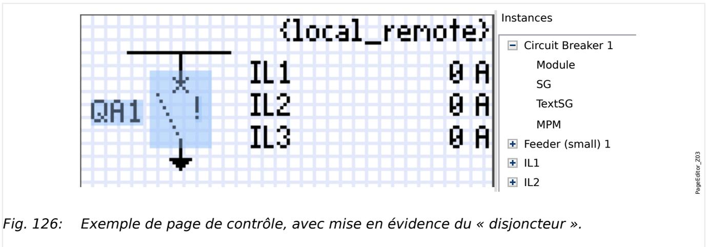
Fig. 126: Exemple de page de contrôle, avec mise en évidence du « disjoncteur ».
