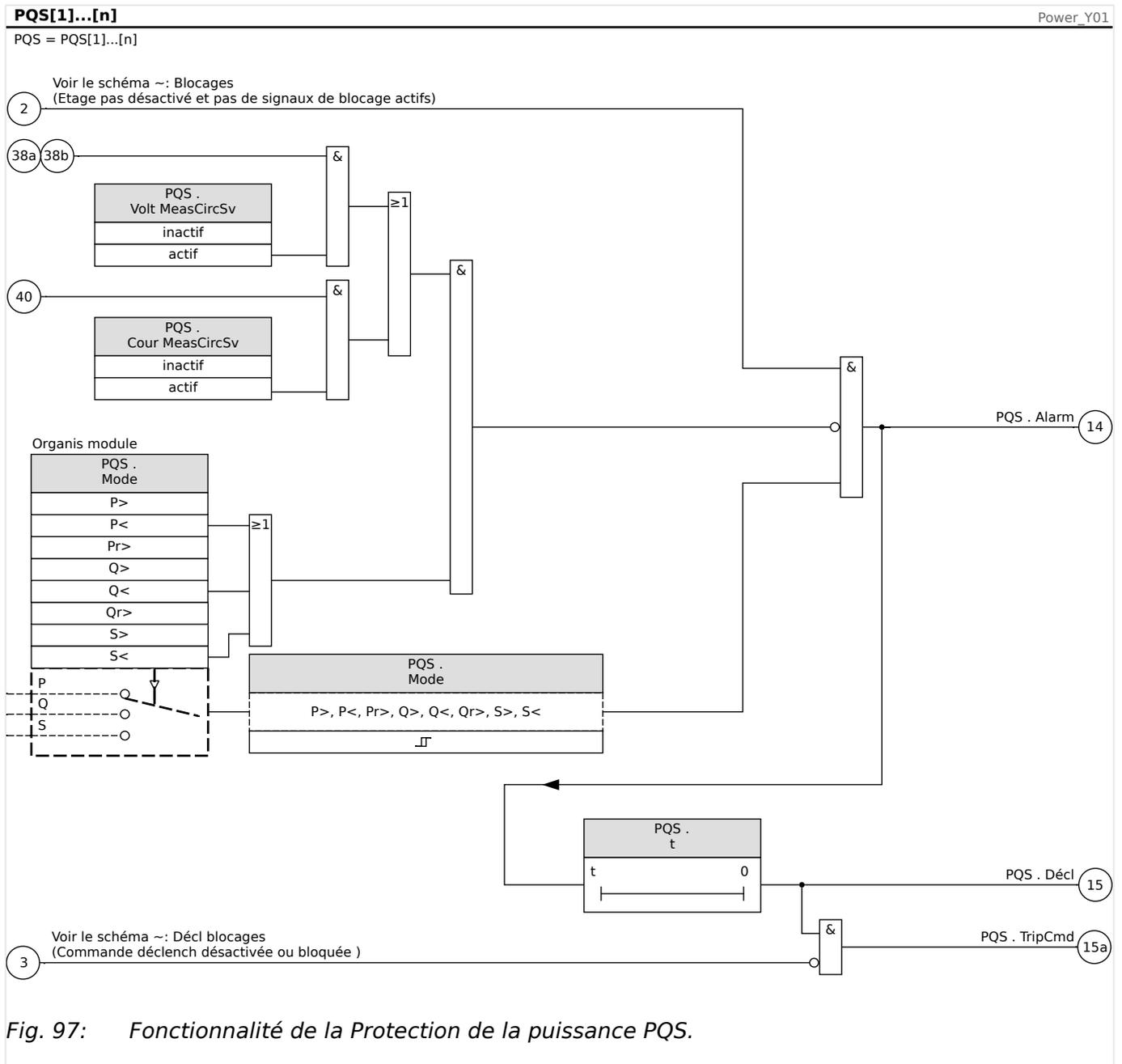
Fig. 97: Fonctionnalité de la Protection de la puissance PQS.
