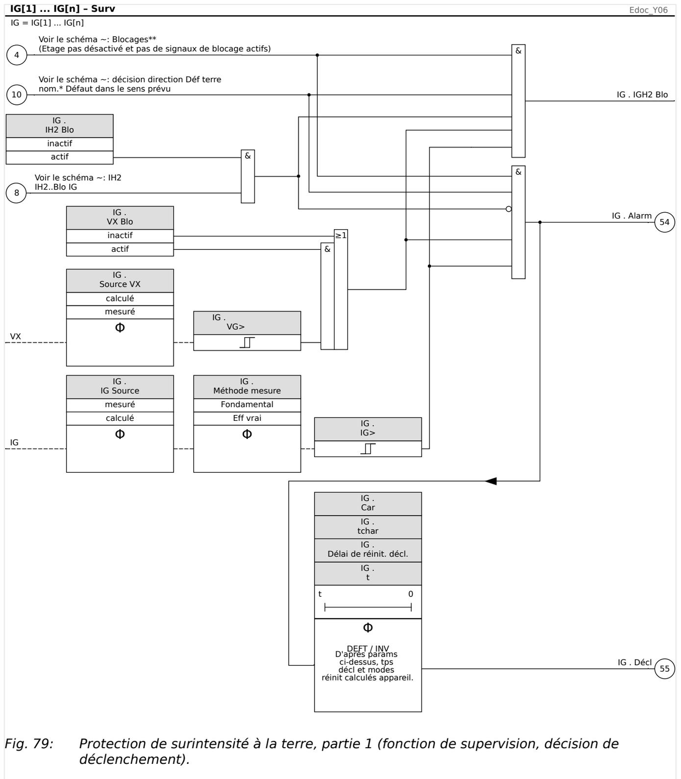
Fig. 79: Protection de surintensité à la terre, partie 1 (fonction de supervision, décision de déclenchement).
