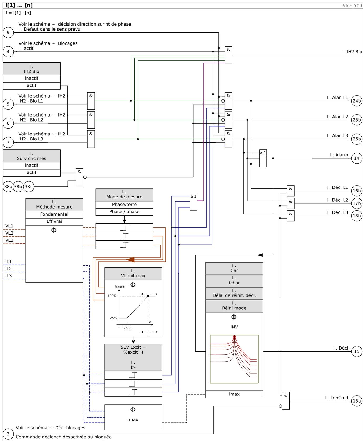
Remarque : par souci de simplicité, le schéma ci-dessus ne montre pas que si [para champ / TT] »TT con« = « Phase / phase », le paramètre »I[x]« . Mode de mesure est configuré en interne sur « Phase / phase », indépendamment de sa valeur configurée (voir le paragraphe « Avis » dans le [Chapitre 4.4.3](#)).
