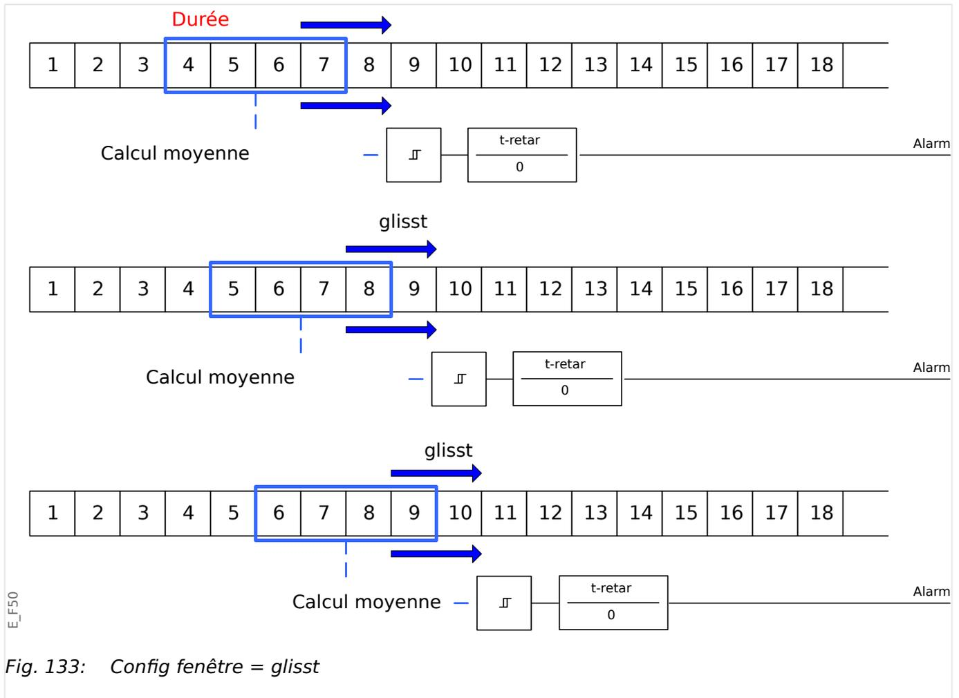
Fig. 133: Config fenêtre = glisst
