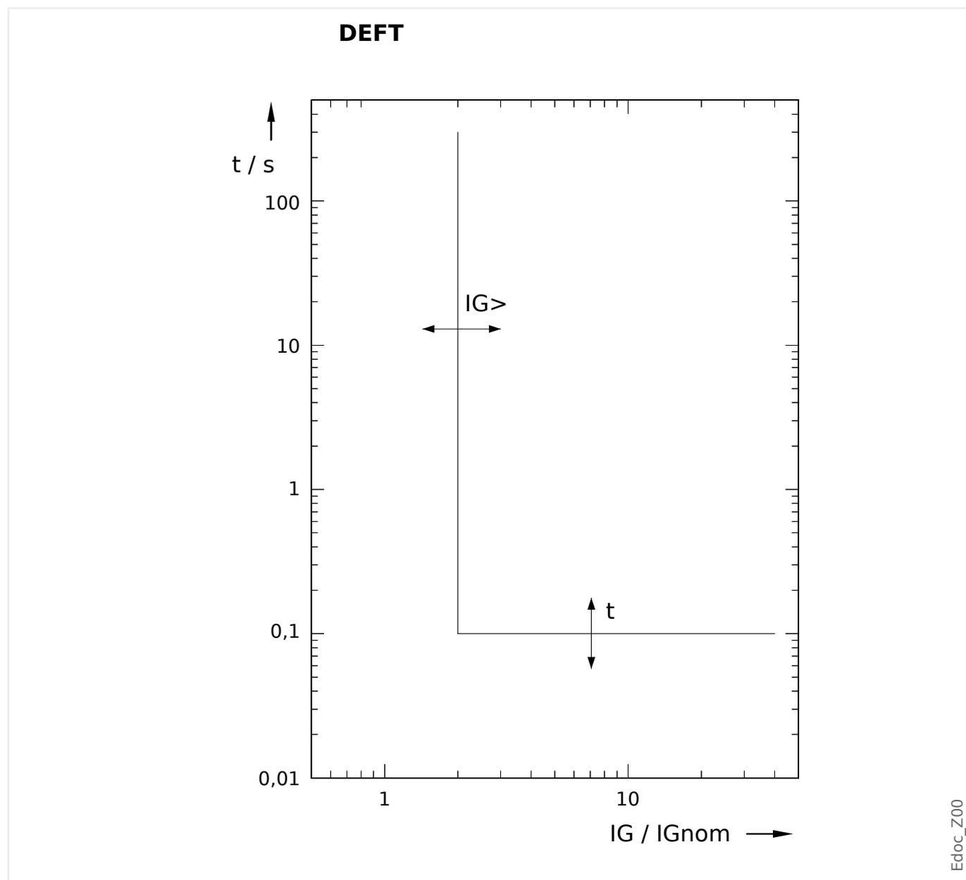
Délai de déclenchement pour  $IG > IG>$ , configurable via [Param protect / Set 1...4 / I-Prot / IG[x]] »t«.
