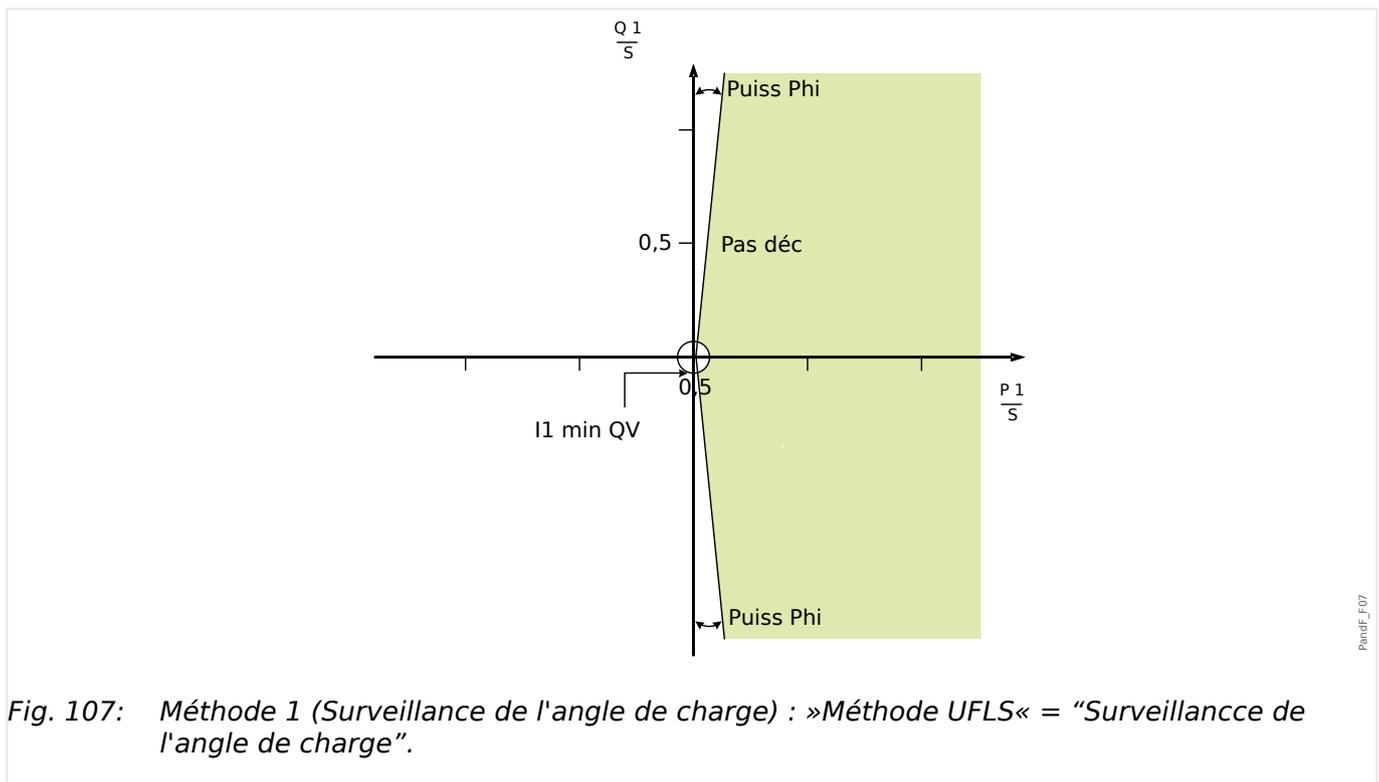
Fig. 107: *Méthode 1 (Surveillance de l'angle de charge) : «Méthode UFLS» = «Surveillance de l'angle de charge».*
