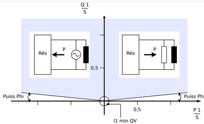
Fig. 99: Méthode 1 : Surveillance de l'angle de charge
