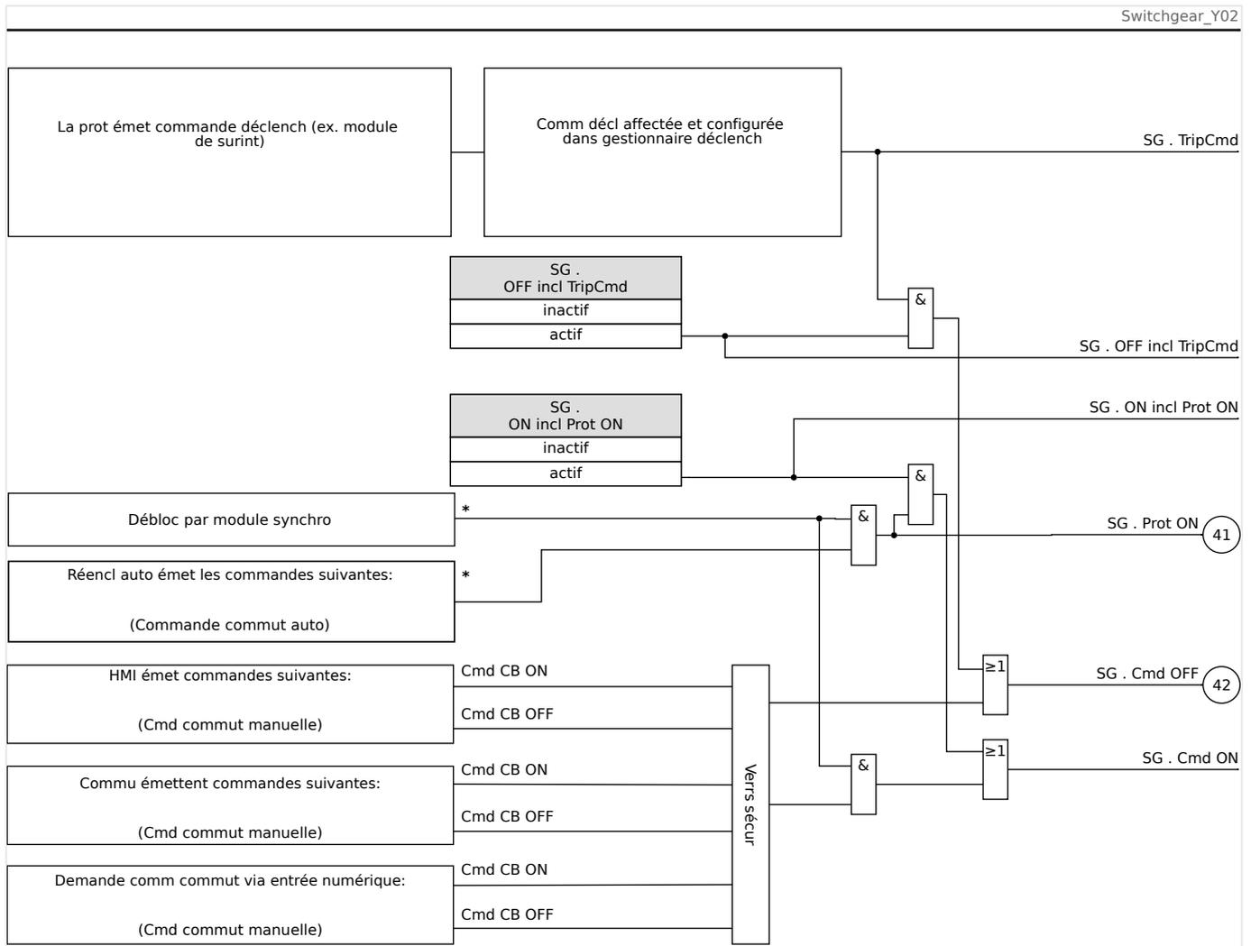
Fig. 130: Verrouillages (Parties identifiées par « \* » : la disponibilité dépend du type de dispositif commandé.)
