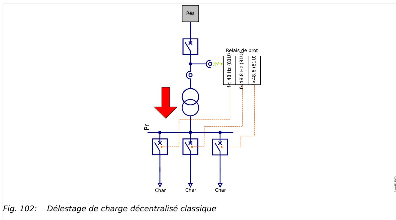
Fig. 102: Délestage de charge décentralisé classique
