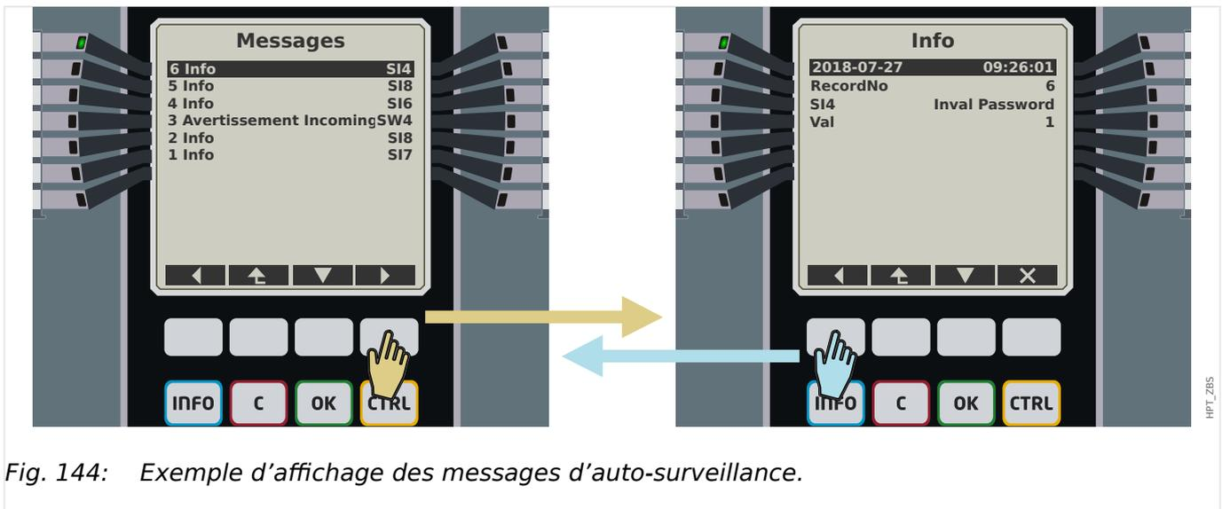
Fig. 144: Exemple d'affichage des messages d'auto-surveillance.
