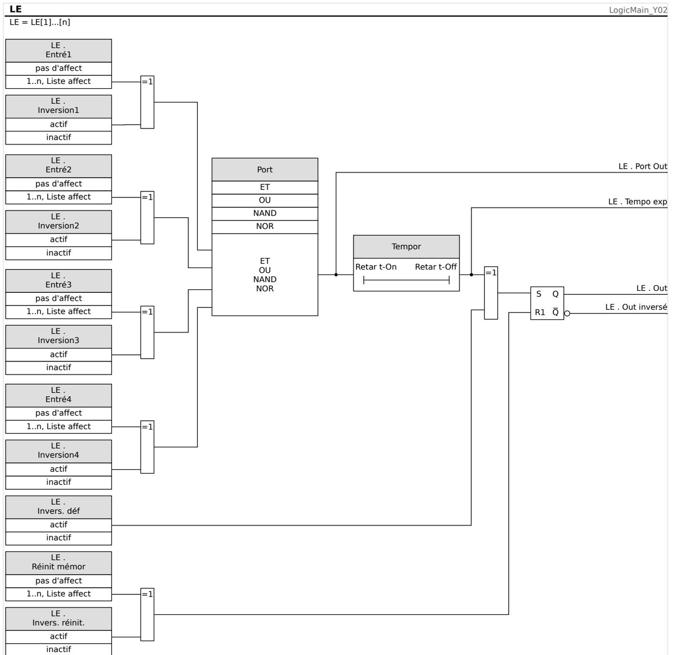
Fig. 139: Présentation détaillée - Diagramme logique global.
