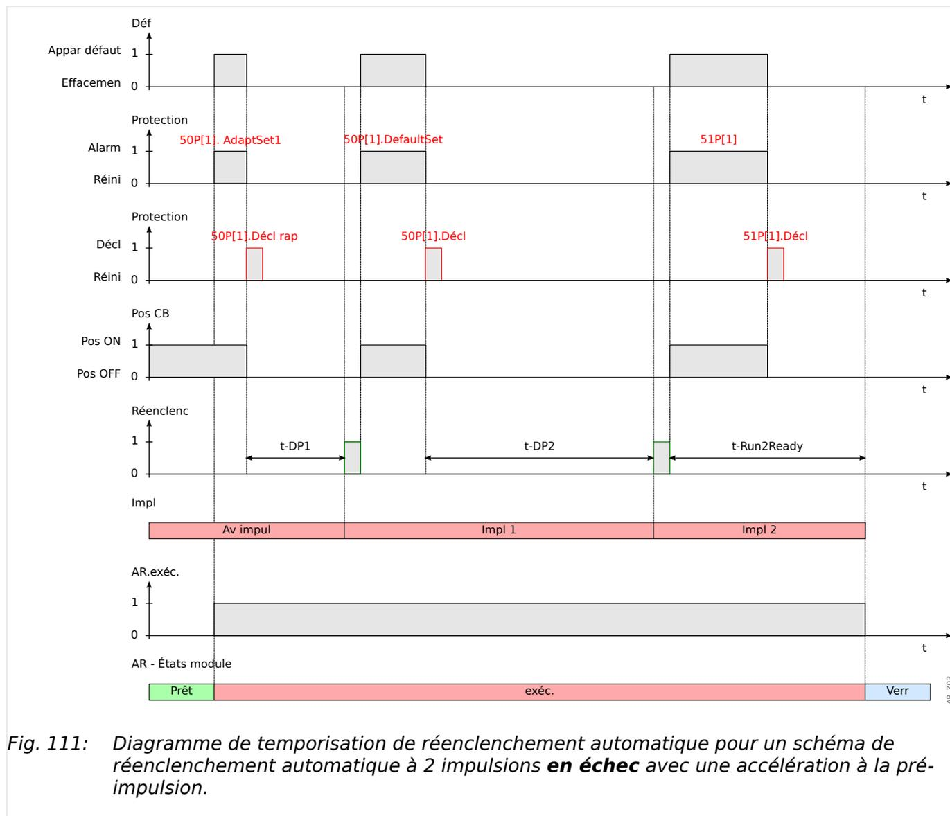
Fig. 111: Diagramme de temporisation de réenclenchement automatique pour un schéma de réenclenchement automatique à 2 impulsions **en échec** avec une accélération à la pré-impulsion.
