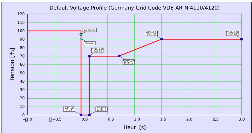
Fig. 88: Profil LVRT prédéfini en usine (Type I).
