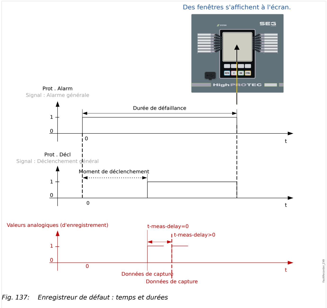
Fig. 137: Enregistreur de défaut : temps et durées
