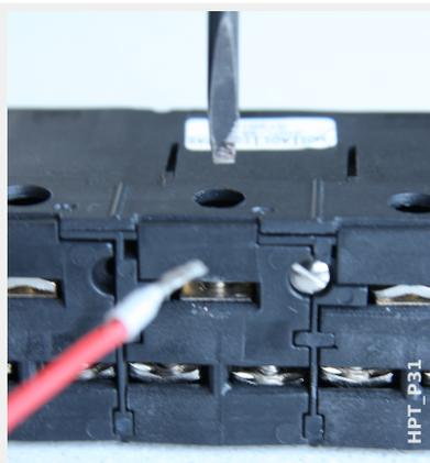
Pour le type de connexion borne à broche, insérez les câbles et fixez-les à l'aide des vis situées sur le côté de la carte d'entrée.
