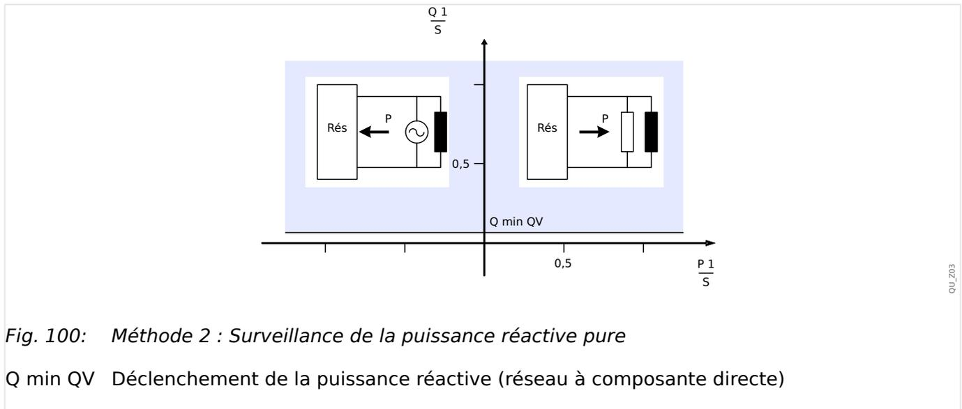
Fig. 100: Méthode 2 : Surveillance de la puissance réactive pure
