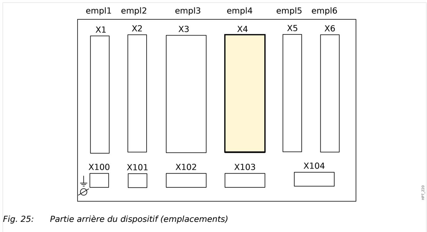
Fig. 25: Partie arrière du dispositif (emplacements)
