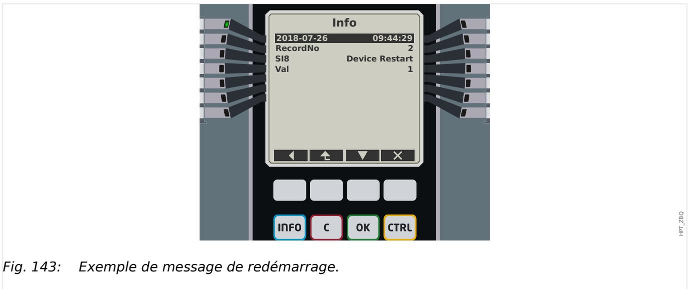
Fig. 143: Exemple de message de redémarrage.
