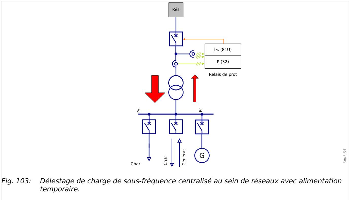
Fig. 103: Délestage de charge de sous-fréquence centralisé au sein de réseaux avec alimentation temporaire.
