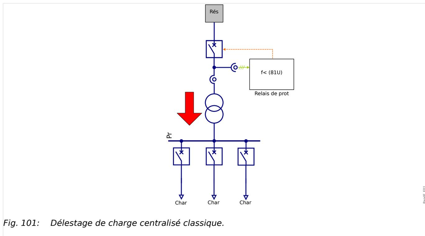
Fig. 101: Délestage de charge centralisé classique.
