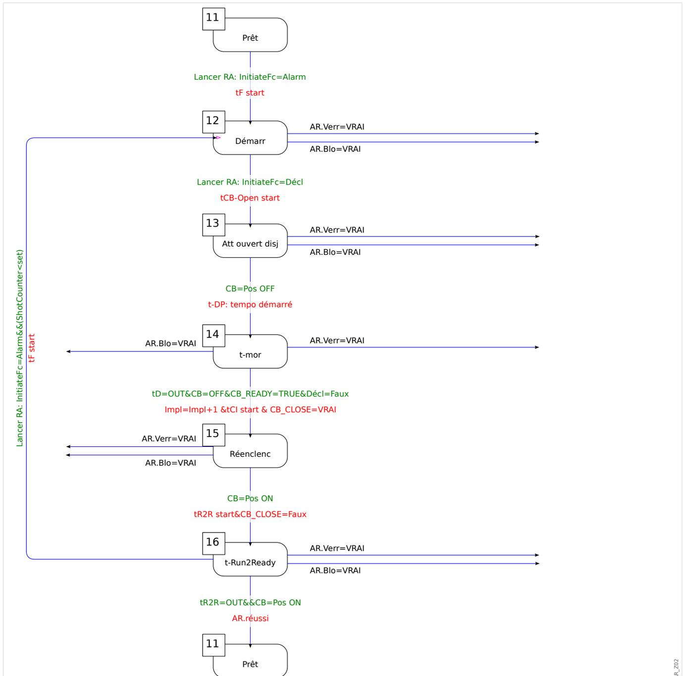
Fig. 110: Cycle d'exécution du AR (état 4).
