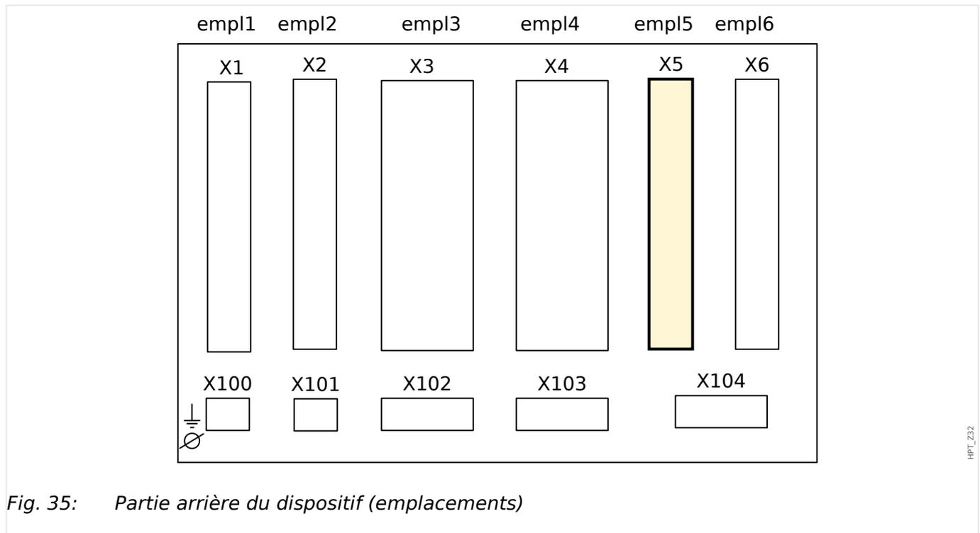
Fig. 35: Partie arrière du dispositif (emplacements)
