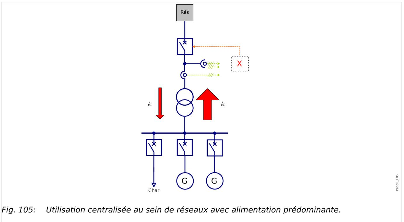
Il n'est pas nécessaire d'utiliser le Délestage de charge de sous-fréquence car en moyenne le sous-réseau délivre (produit) plus de puissance active qu'il n'en consomme. Le sous-réseau a avant tout un impact positif sur la fréquence du réseau.
