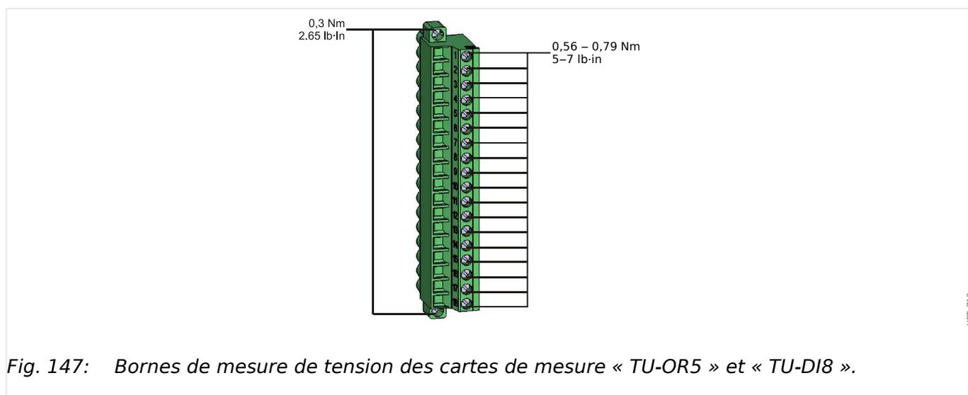
Fig. 147: Bornes de mesure de tension des cartes de mesure « TU-OR5 » et « TU-DI8 ».
