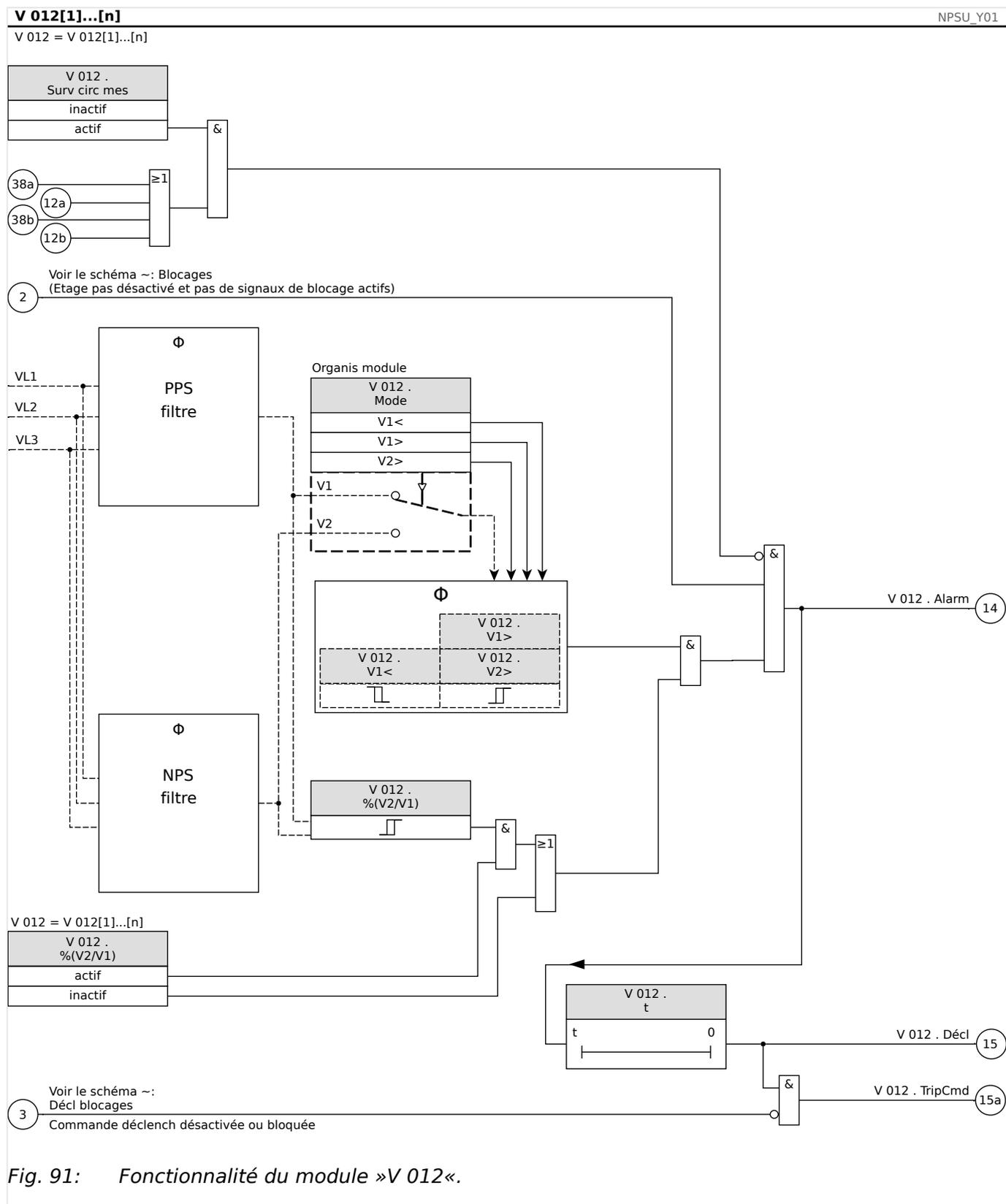
Fig. 91: Fonctionnalité du module »V 012«.
