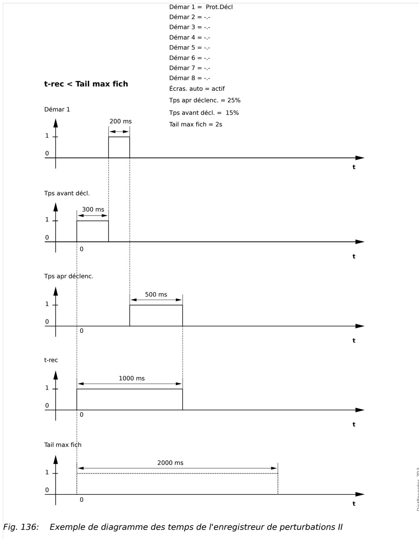
Fig. 136: Exemple de diagramme des temps de l'enregistreur de perturbations II
