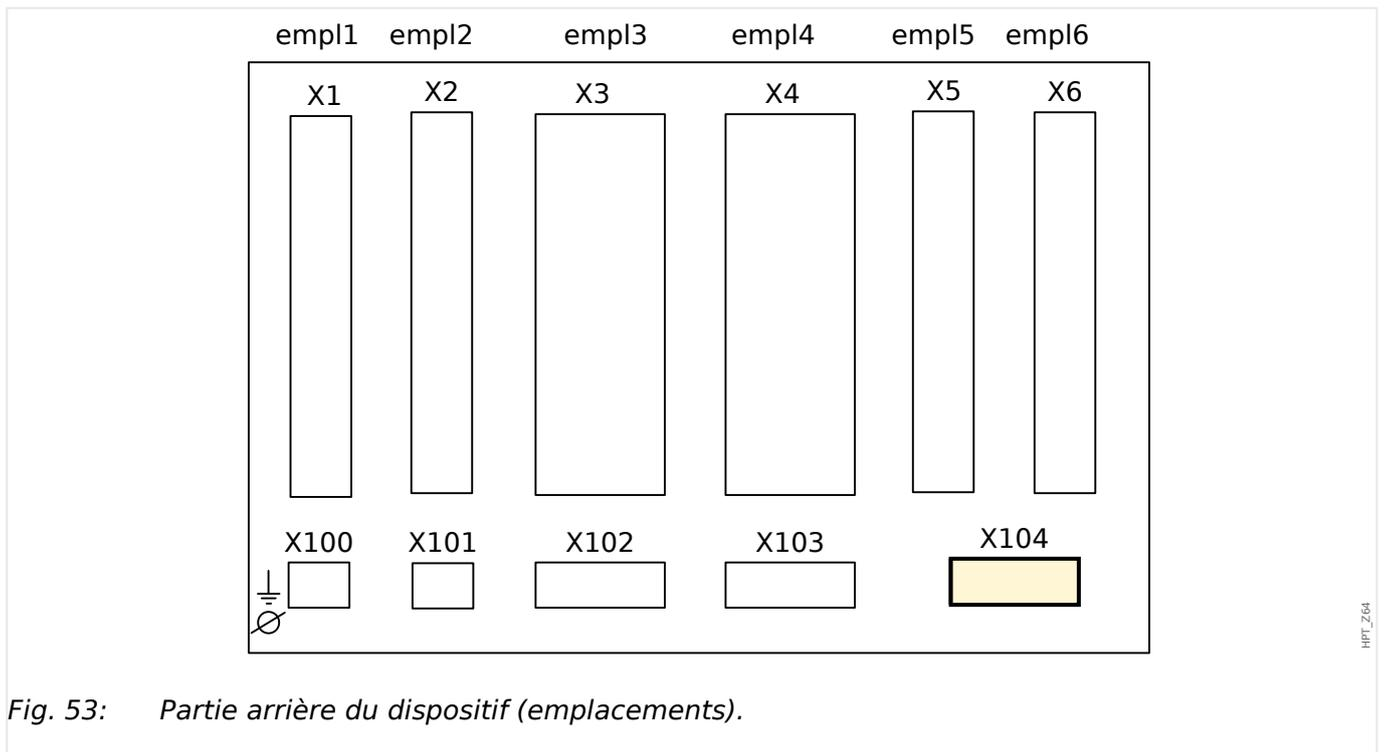
Fig. 53: Partie arrière du dispositif (emplacements).
