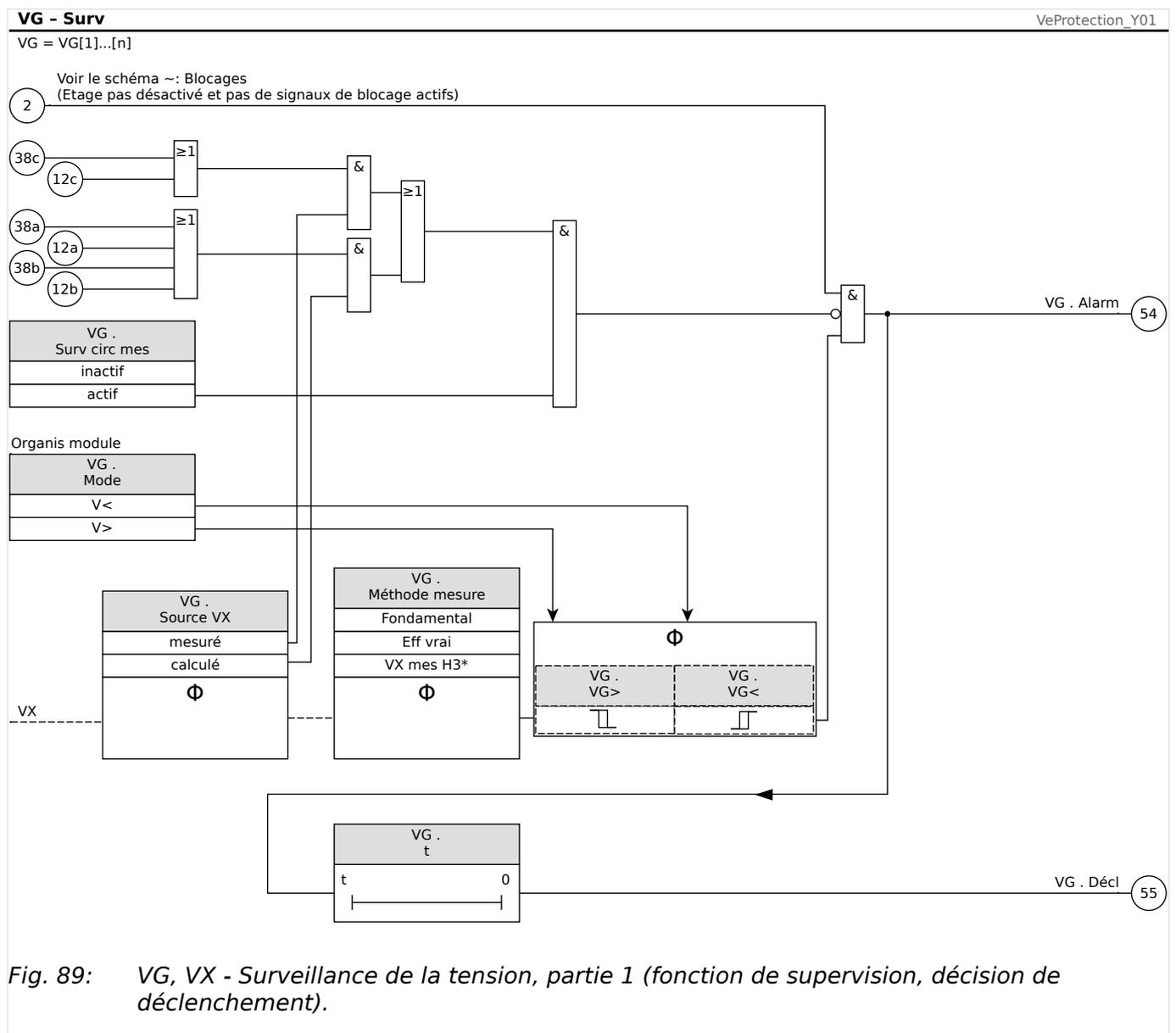
Fig. 89: VG, VX - Surveillance de la tension, partie 1 (fonction de supervision, décision de déclenchement).
