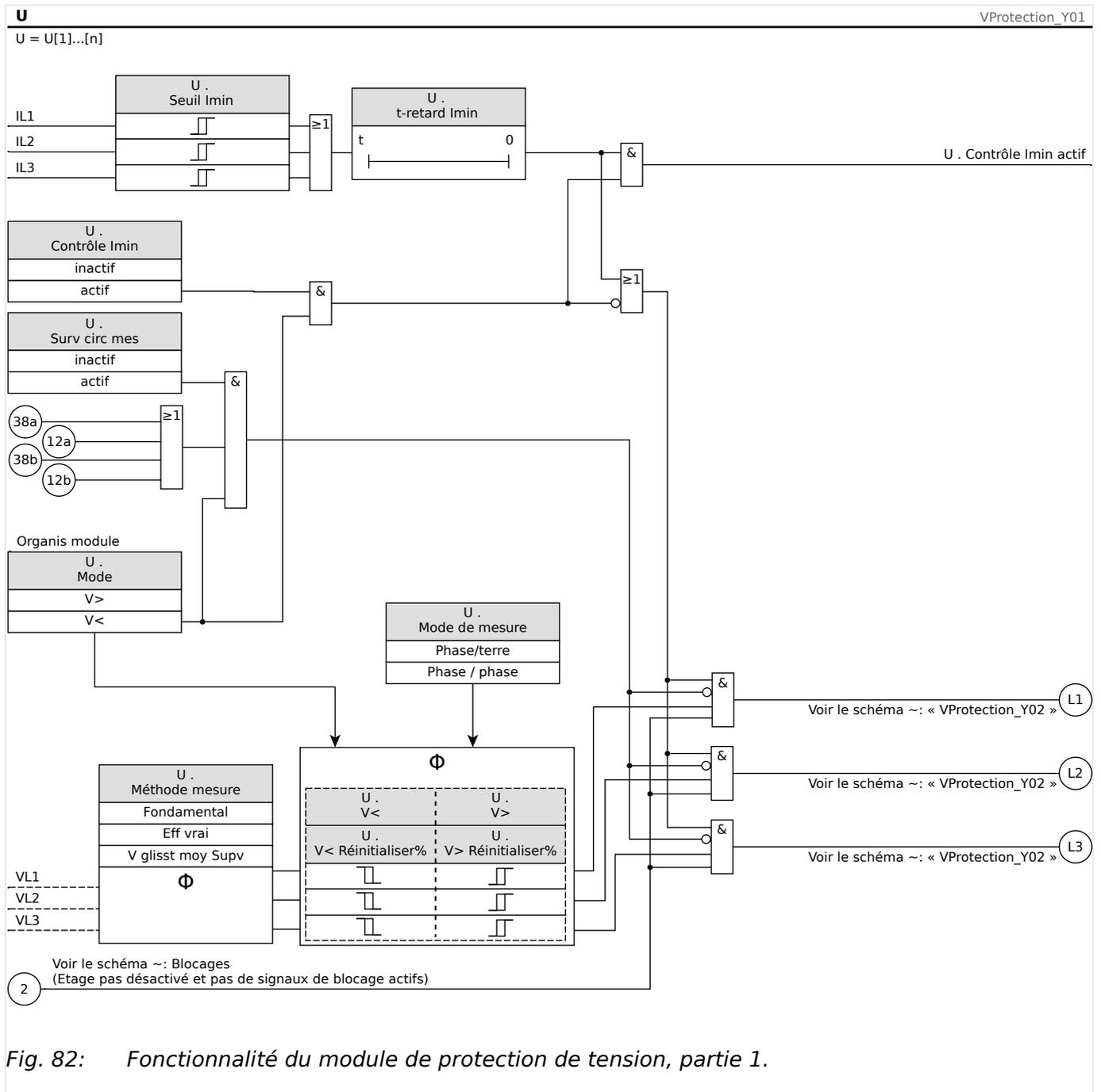
Fig. 82: Fonctionnalité du module de protection de tension, partie 1.
