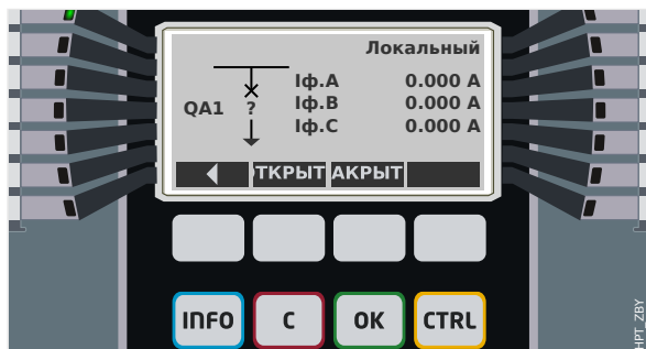
Рис. 120: Пример страницы управления, выключатель в аварийном (недопустимое состояние) положении.
