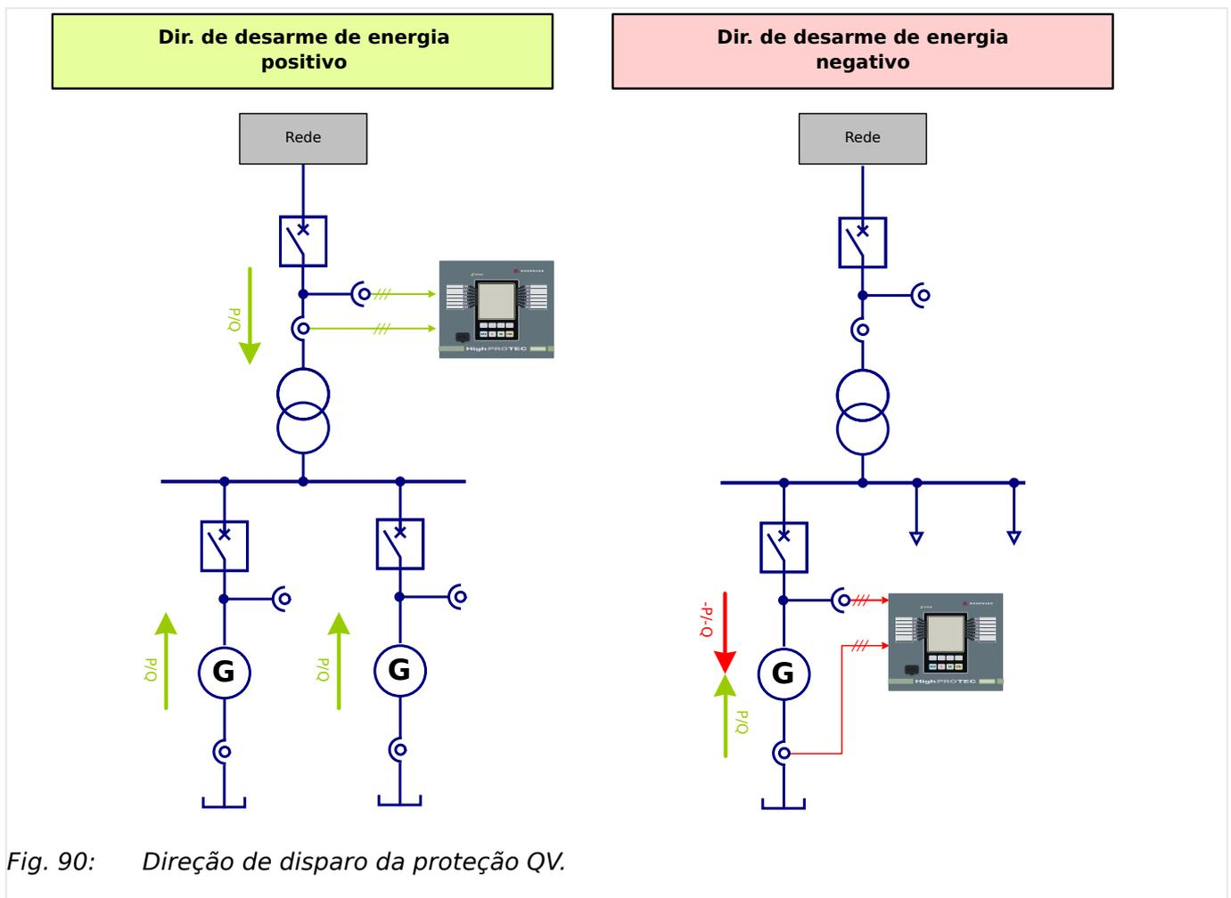
Fig. 90: Direção de disparo da proteção QV.
