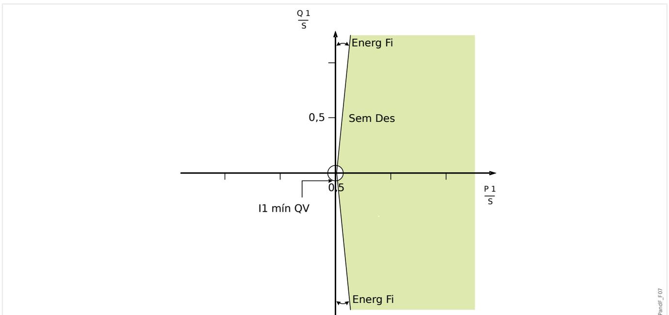
Fig. 99: Método 1 (Supervisão de Ângulo de Energia): “Método UFLS” = “Supervisão Âng Energ”.
