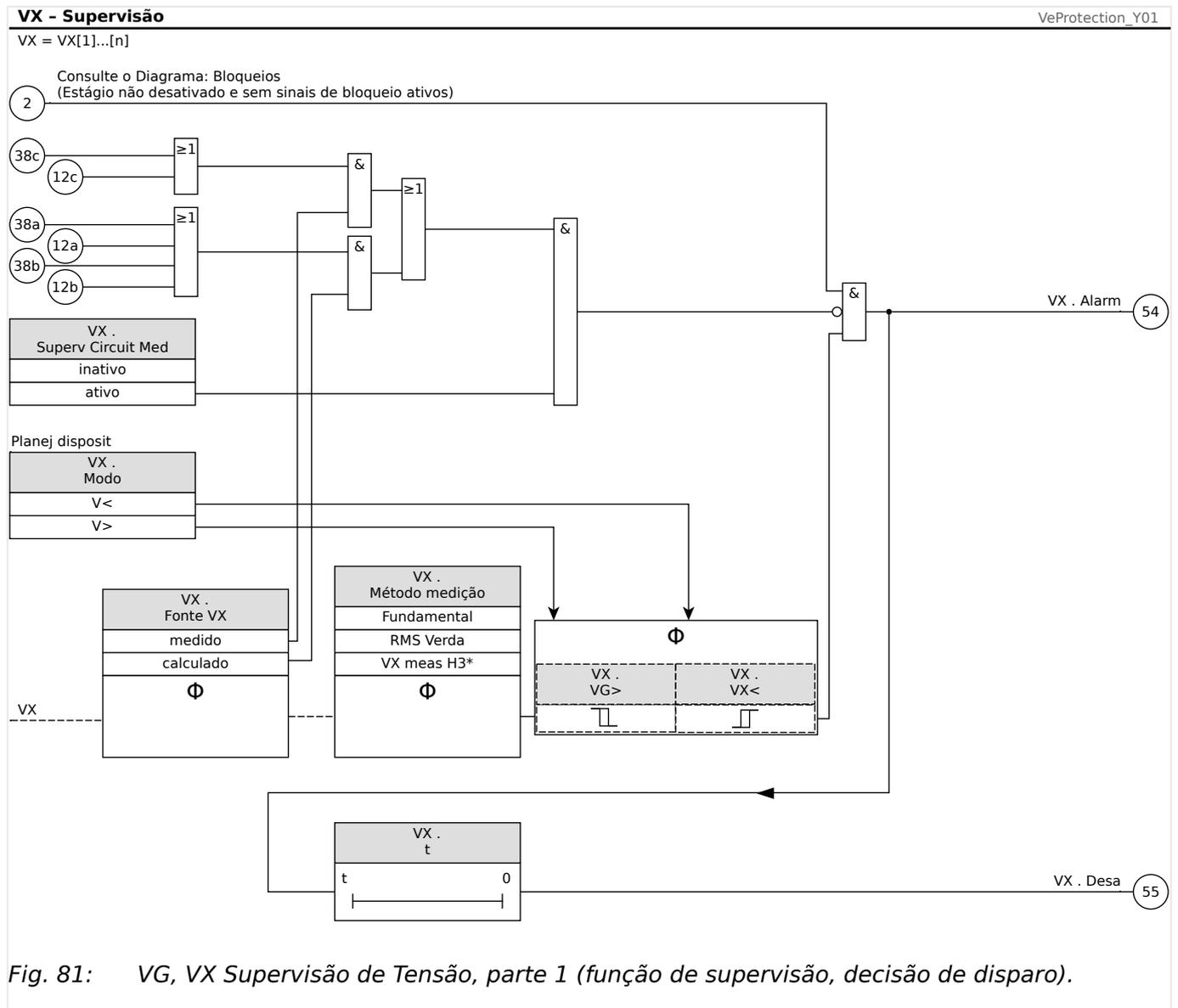
Fig. 81: VG, VX Supervisão de Tensão, parte 1 (função de supervisão, decisão de disparo).
