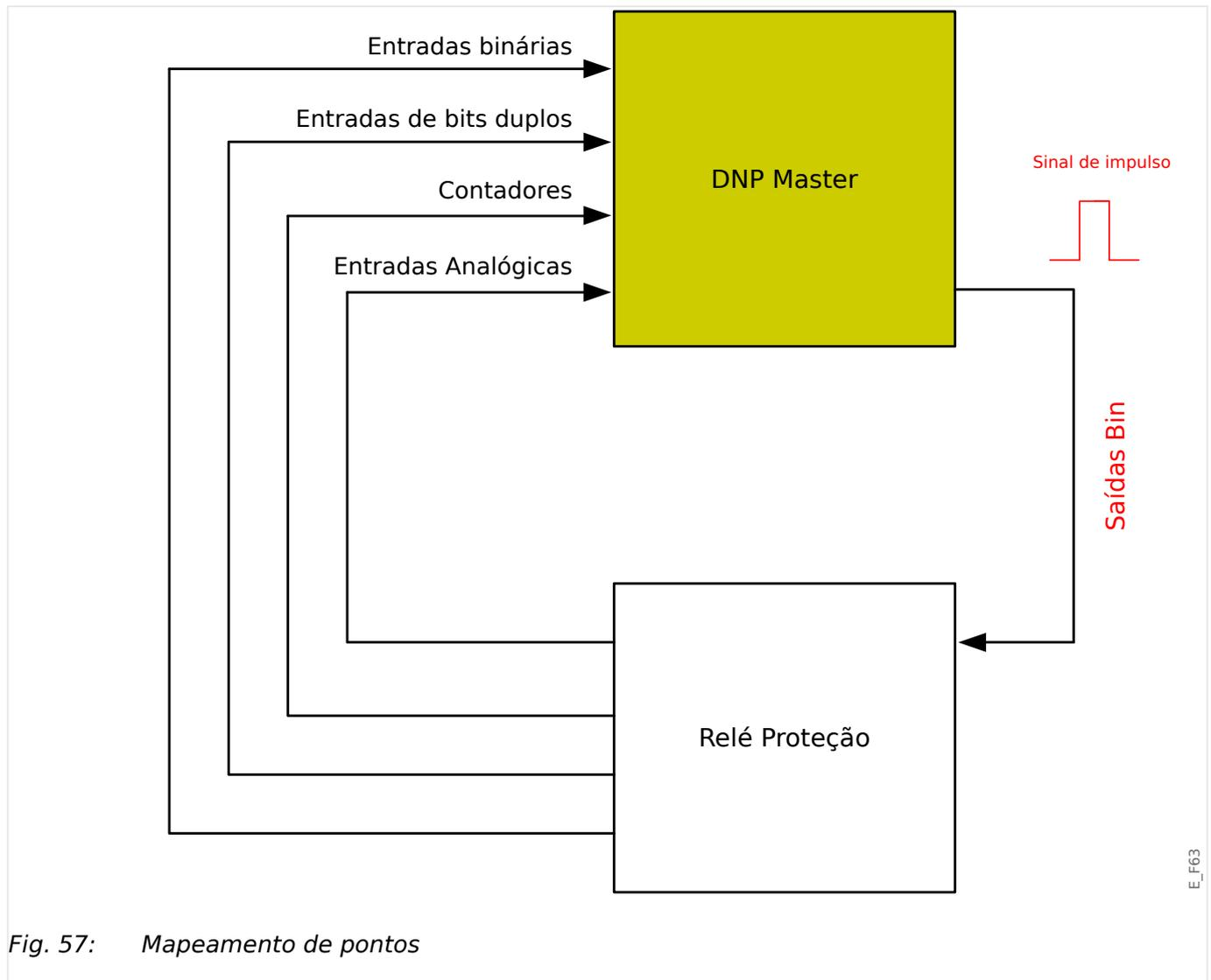
Fig. 57: Mapeamento de pontos
