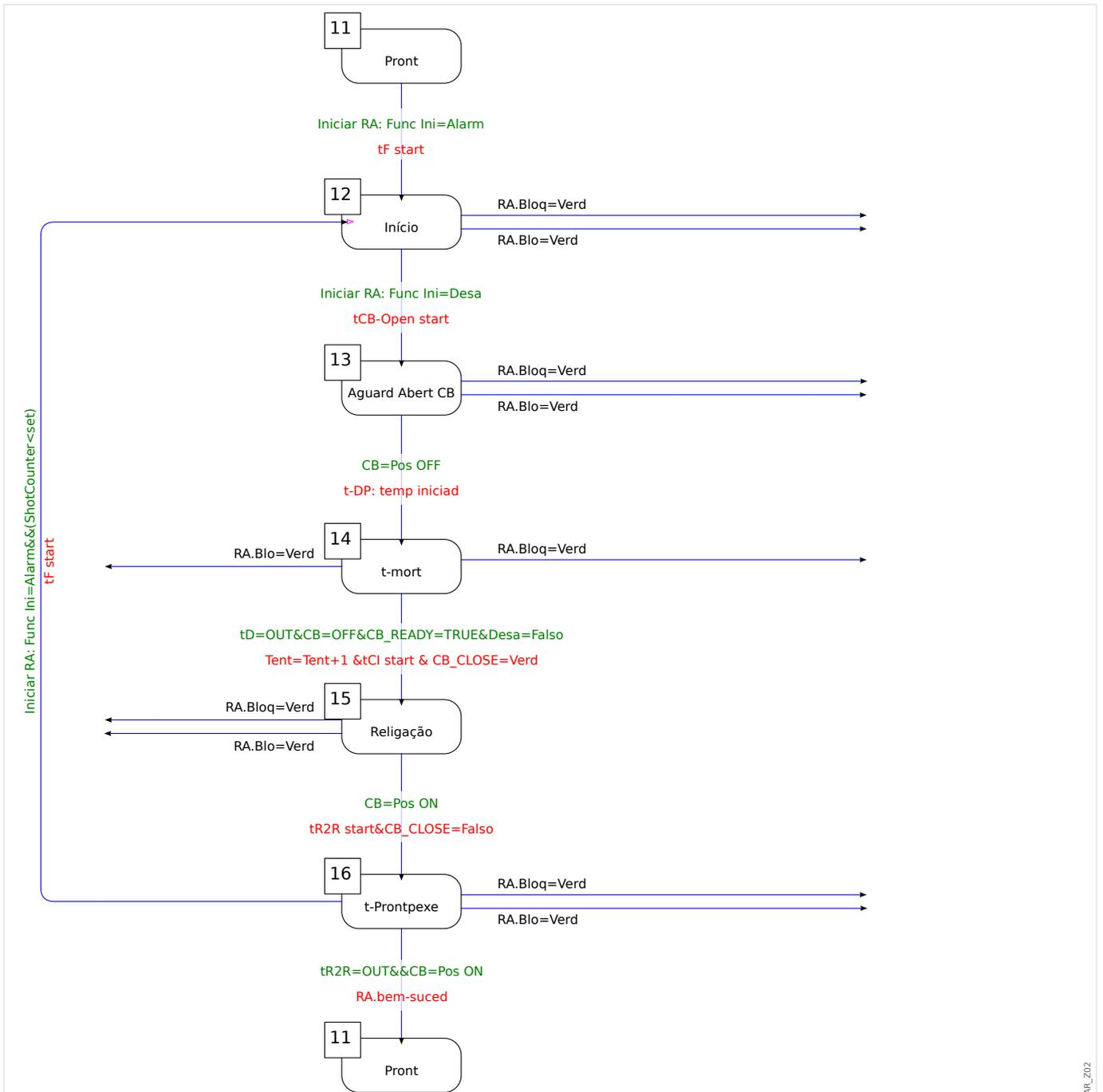
Fig. 102: Ciclo de execução de RA (estado 4).
