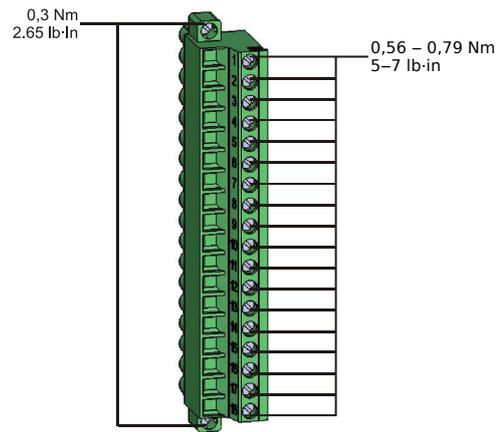
Fig. 139: Terminais de medição de tensão das placas de medição “TU-OR5” e “TU-DI8” , ).
