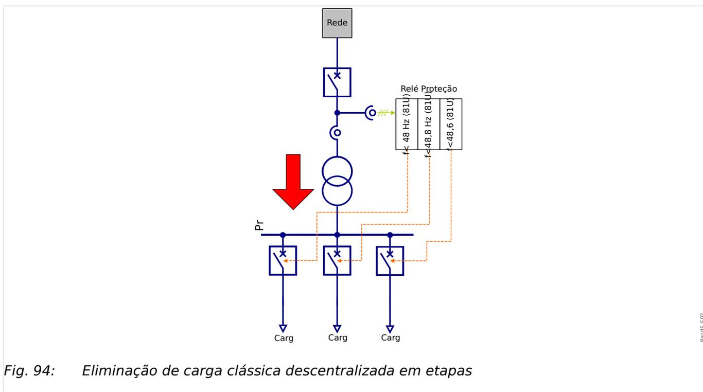
Um derramamento de carga clássico descentralizado pode ser feito ao desativar a detecção de direção do fluxo de potência.
