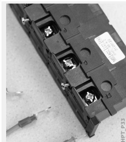
Mova o controle deslizante para o lado, de modo que os parafusos e o contato metálico fiquem totalmente acessíveis.
