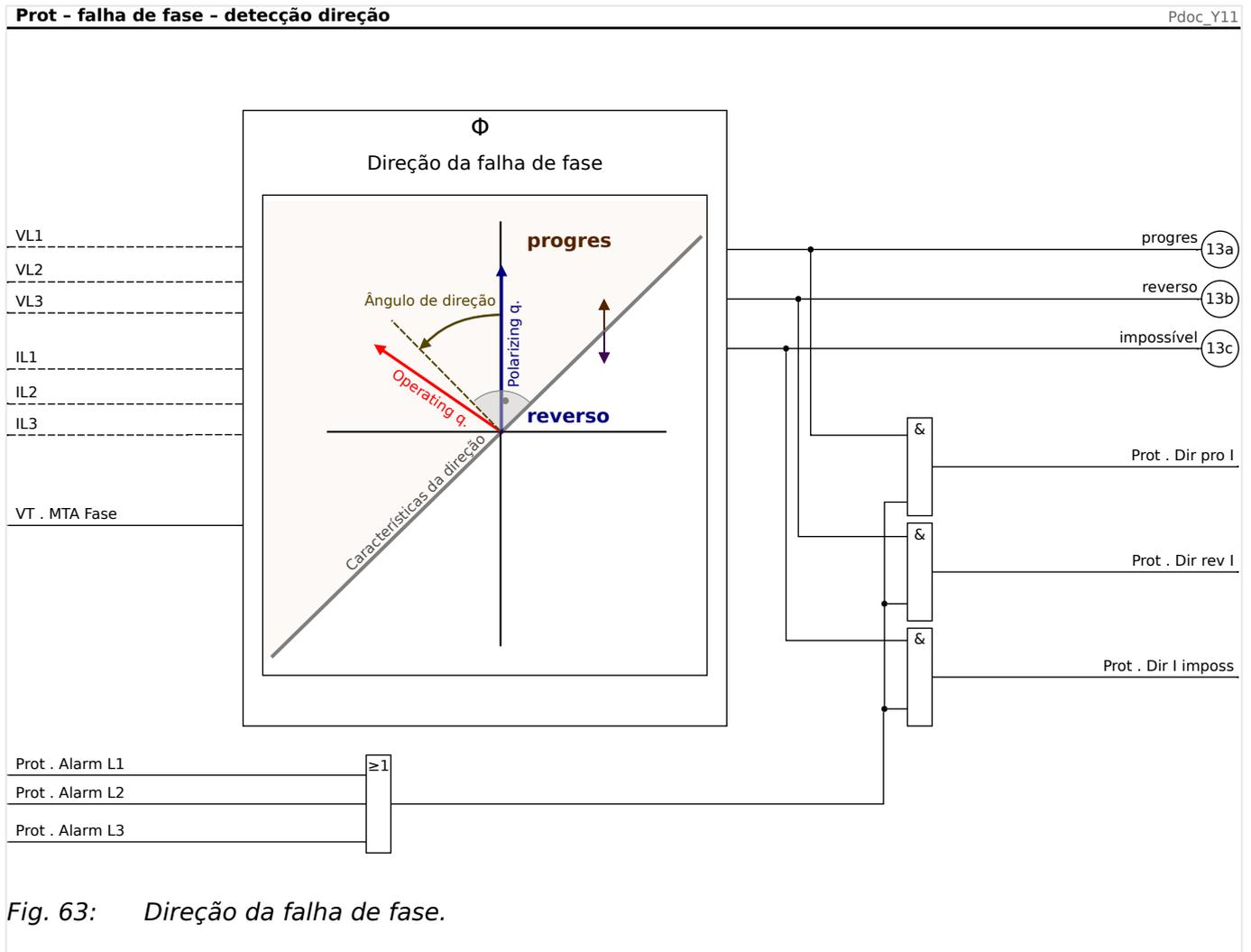
O MCA4 avalia o ângulo entre a corrente da fase com a maior corrente (*Quantidade operacional*) e a tensão fase-fase das outras fases (*Quantidade de polarização*). Para falhas de três fases onde a tensão fase-fase é uma tensão demasiado baixa, é usada uma memória de tensão.
