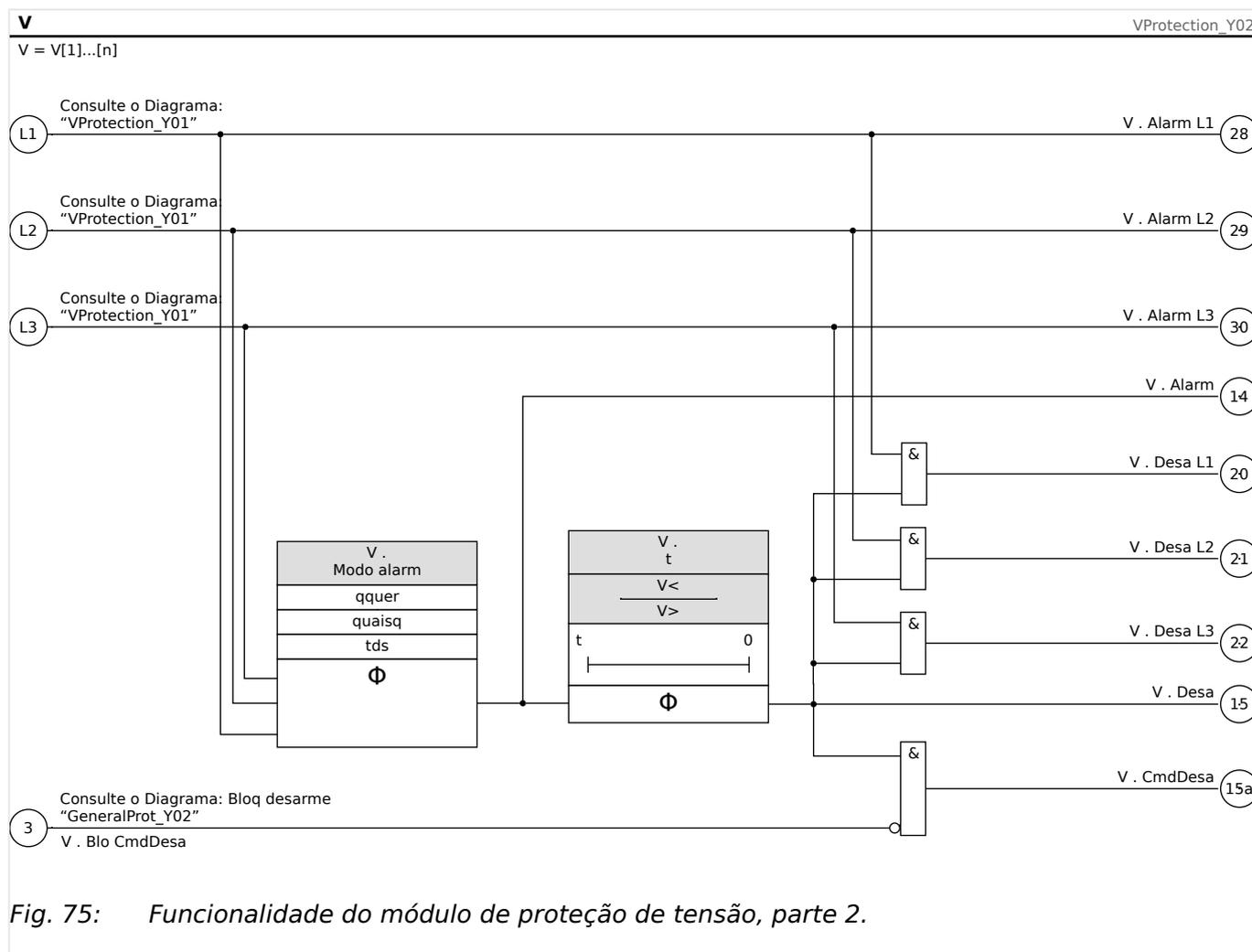
Fig. 75: Funcionalidade do módulo de proteção de tensão, parte 2.
