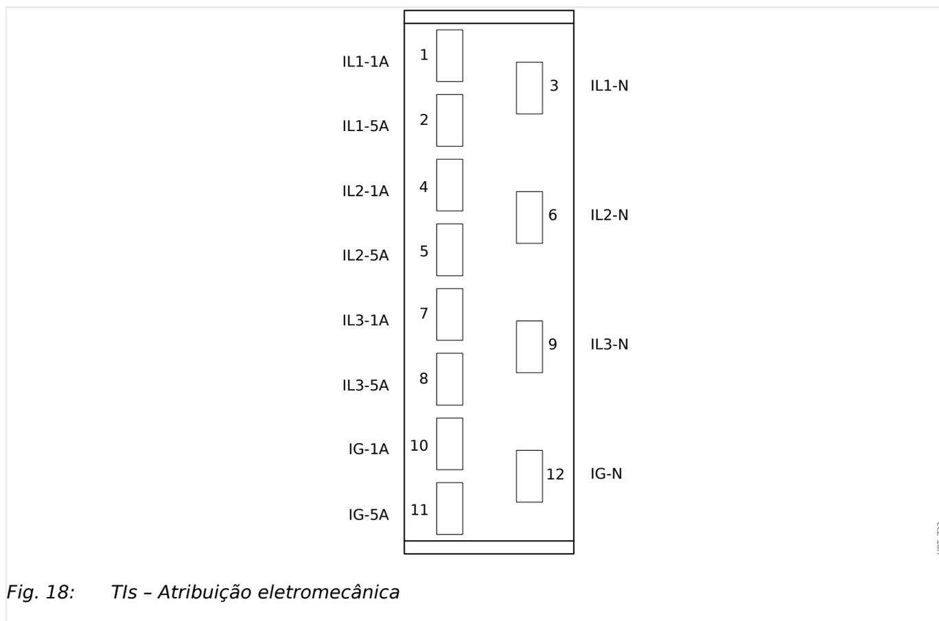
Fig. 18: TIs - Atribuição eletromecânica
