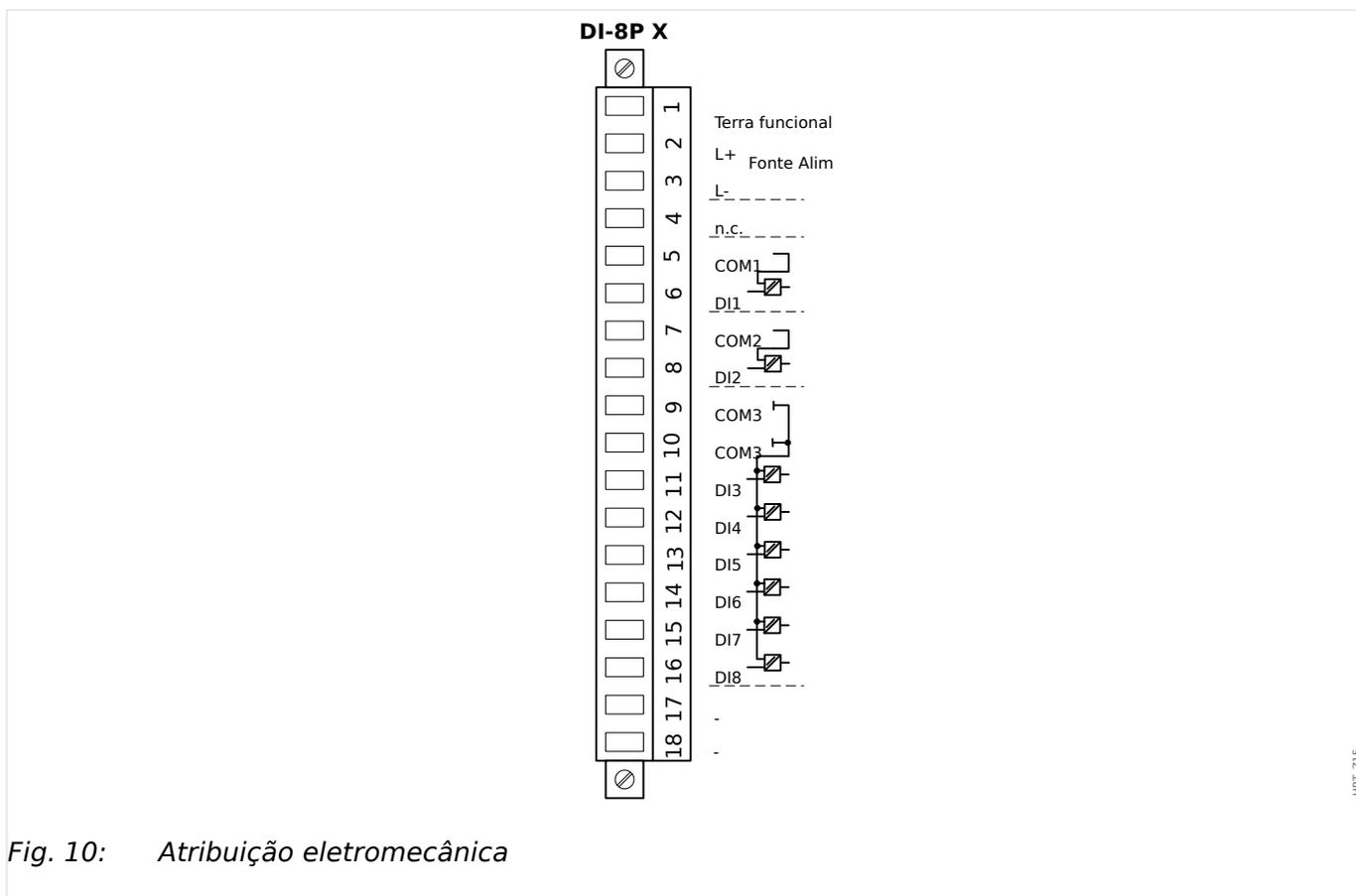
Fig. 10: Atribuição eletromecânica
