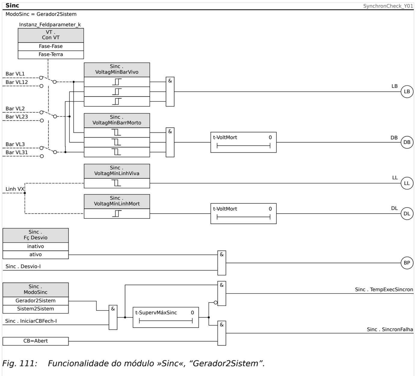
Fig. 111: Funcionalidade do módulo »Sinc«, “Gerador2Sistem”.
