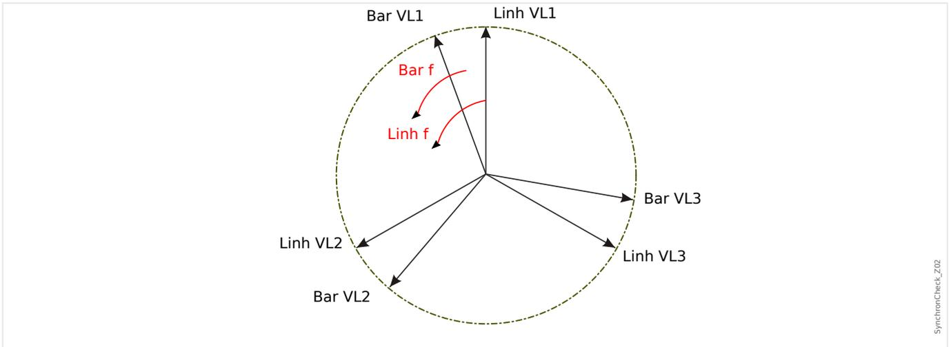
Se a frequência do gerador  $f_{Bus}$  não for igual à frequência de rede  $f_{Line}$ , isso resulta em uma frequência de deslize  $\Delta F = |f_{Bus} - f_{Line}|$  entre as duas frequências do sistema.
