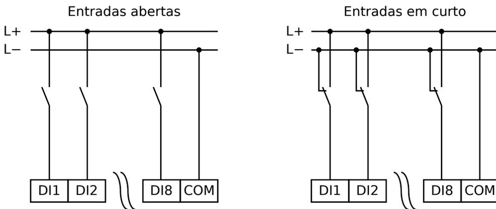
Fig. 140: Estado seguro das entradas digitais
