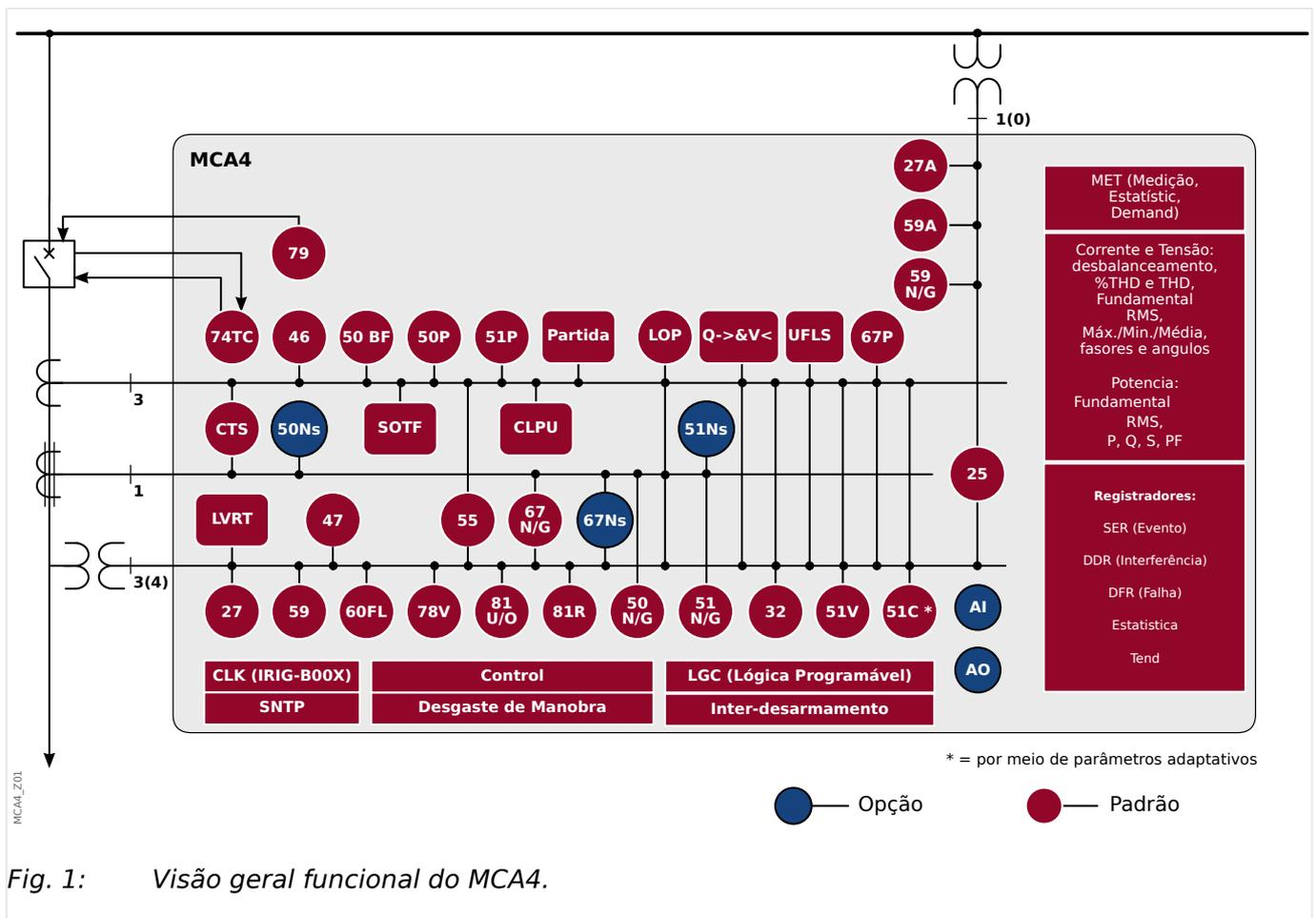
Fig. 1: Visão geral funcional do MCA4.
