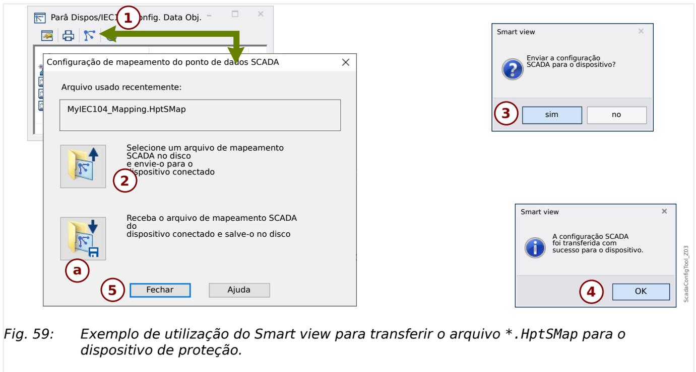
Fig. 59: Exemplo de utilização do Smart view para transferir o arquivo \*.HptSMap para o dispositivo de proteção.
