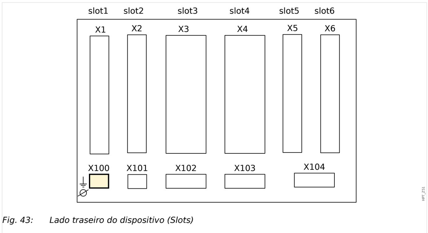
Fig. 43: Lado traseiro do dispositivo (Slots)
