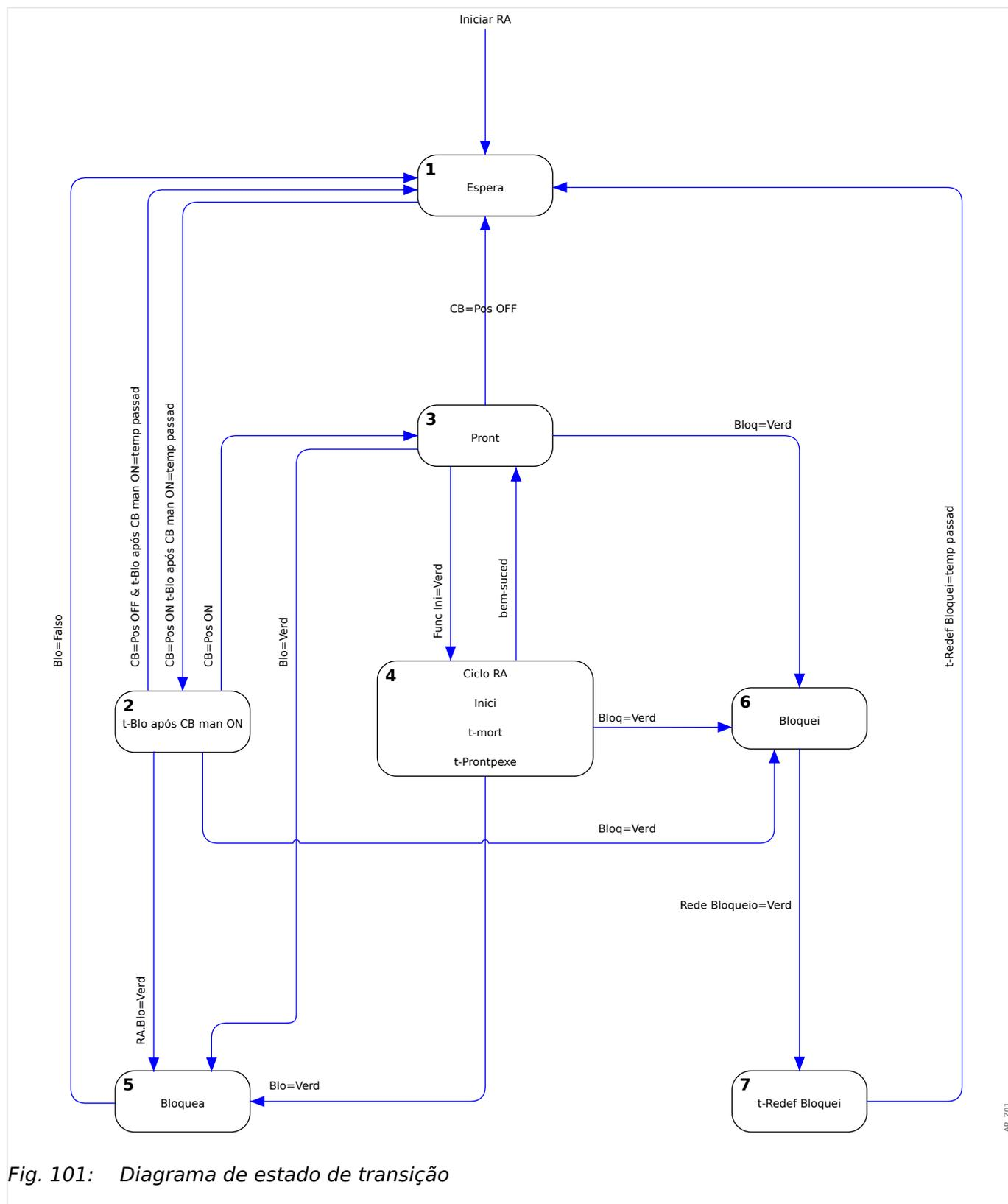
Fig. 101: Diagrama de estado de transição
