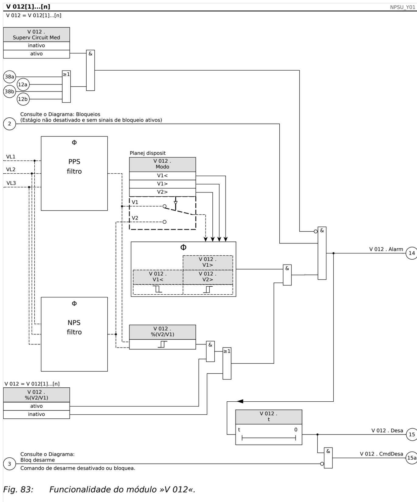
Fig. 83: Funcionalidade do módulo »V 012«.
