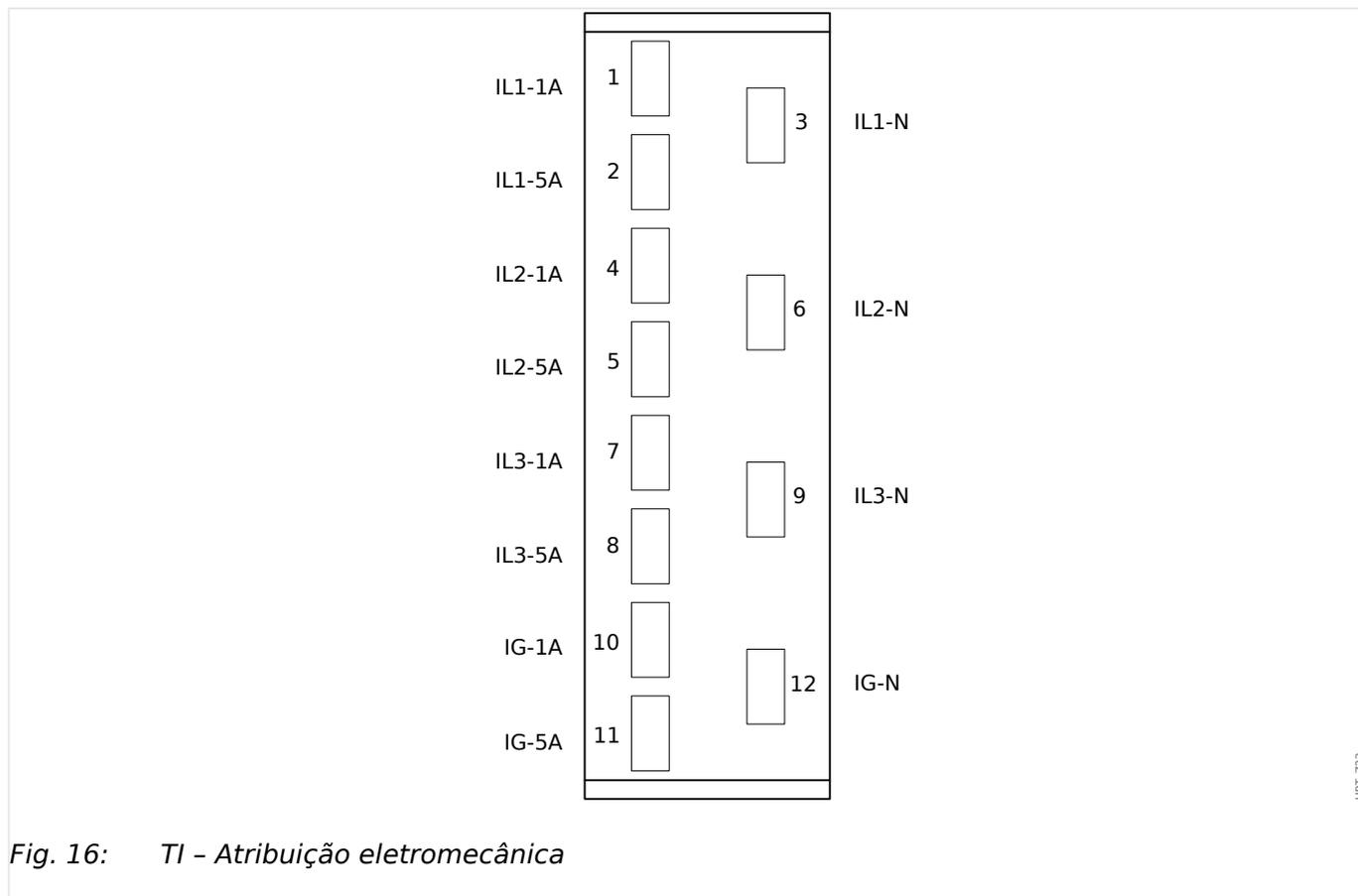
Fig. 16: TI - Atribuição eletromecânica
