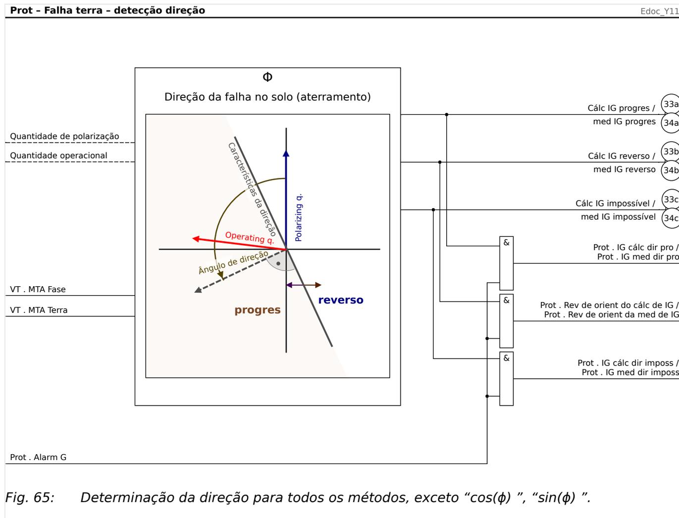
Fig. 65: Determinação da direção para todos os métodos, exceto " $\cos(\phi)$ ", " $\sin(\phi)$ ".
