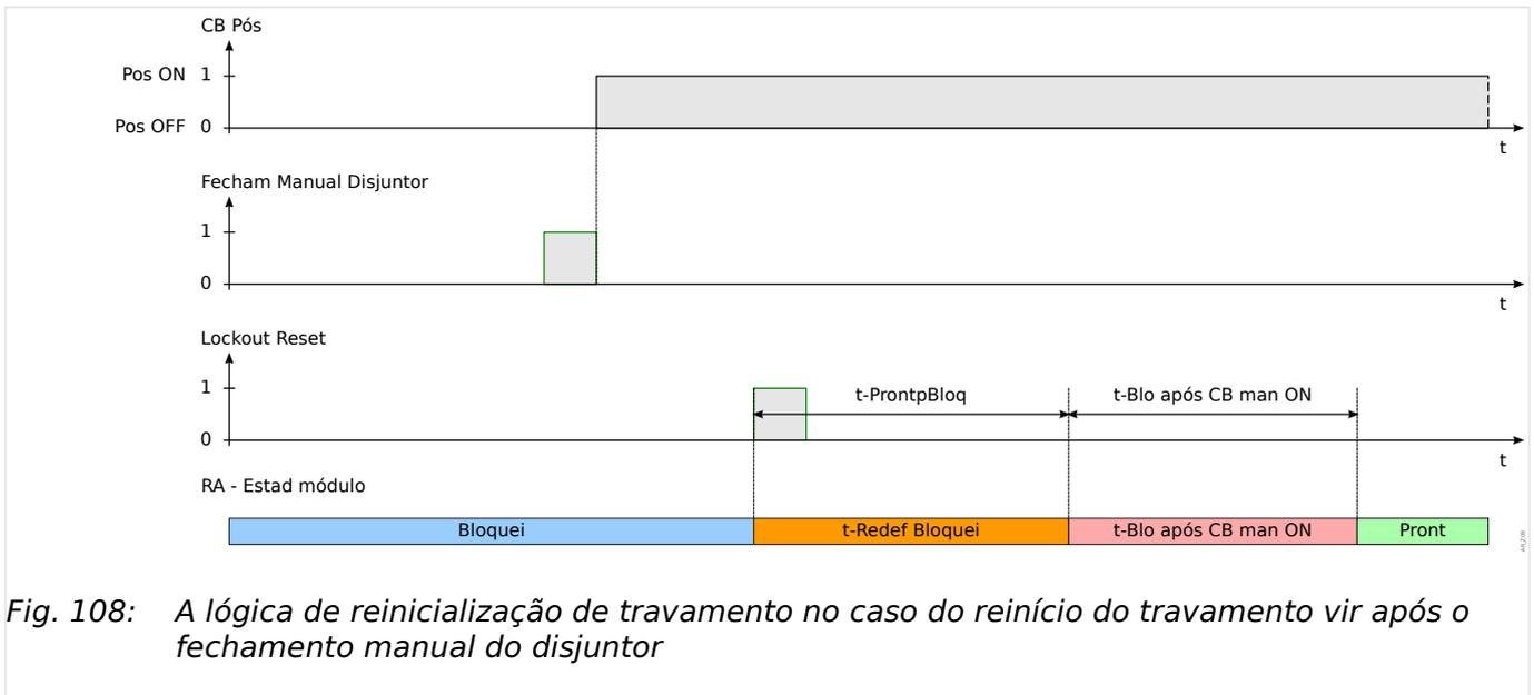
Fig. 108: A lógica de reinicialização de travamento no caso do reinício do travamento vir após o fechamento manual do disjuntor
