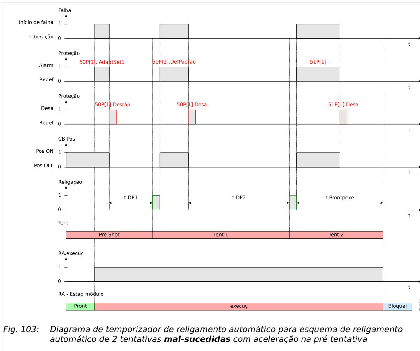
Fig. 103: Diagrama de temporizador de religamento automático para esquema de religamento automático de 2 tentativas **mal-sucedidas** com aceleração na pré tentativa
