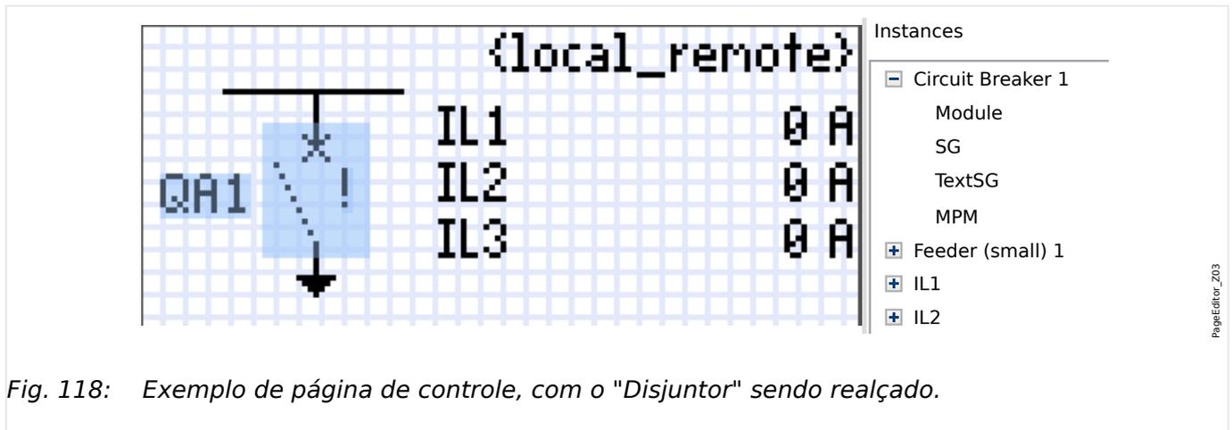
Fig. 118: Exemplo de página de controle, com o "Disjuntor" sendo realçado.
