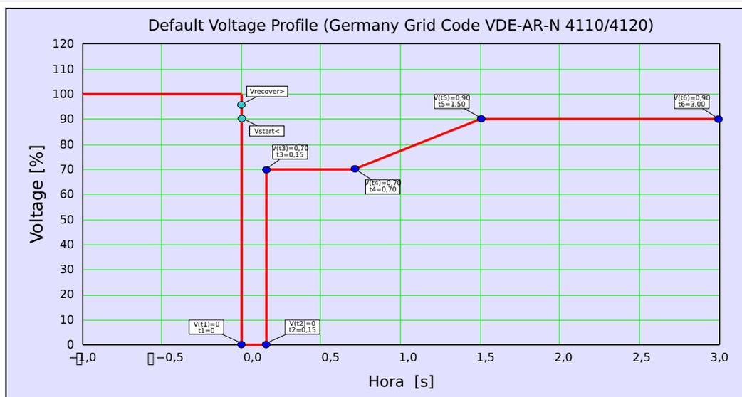
Fig. 80: Perfil padrão do LVRT (Tipo I).
