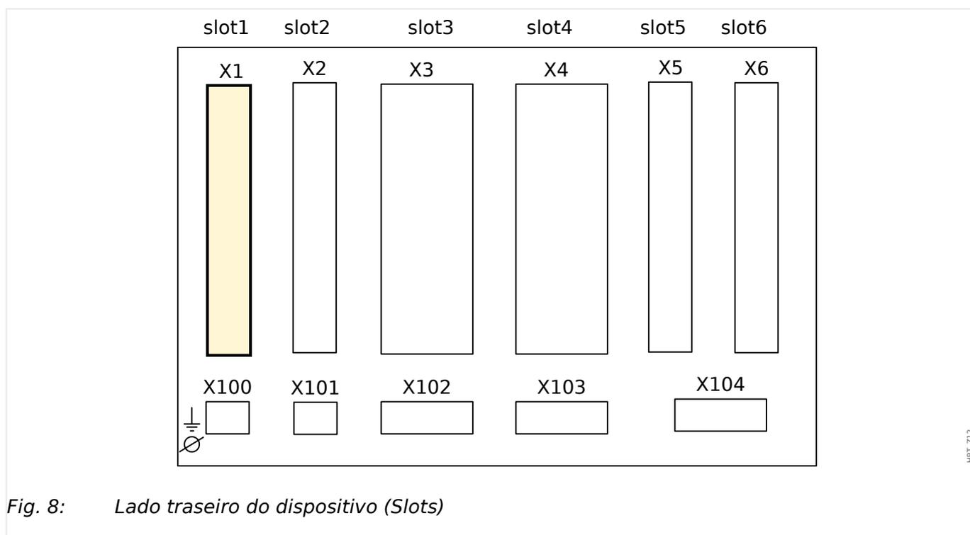
Fig. 8: Lado traseiro do dispositivo (Slots)
