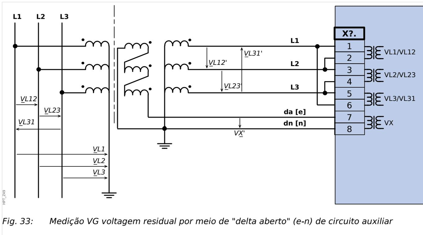
Fig. 33: Medição VG tensão residual por meio de "delta aberto" (e-n) de circuito auxiliar
