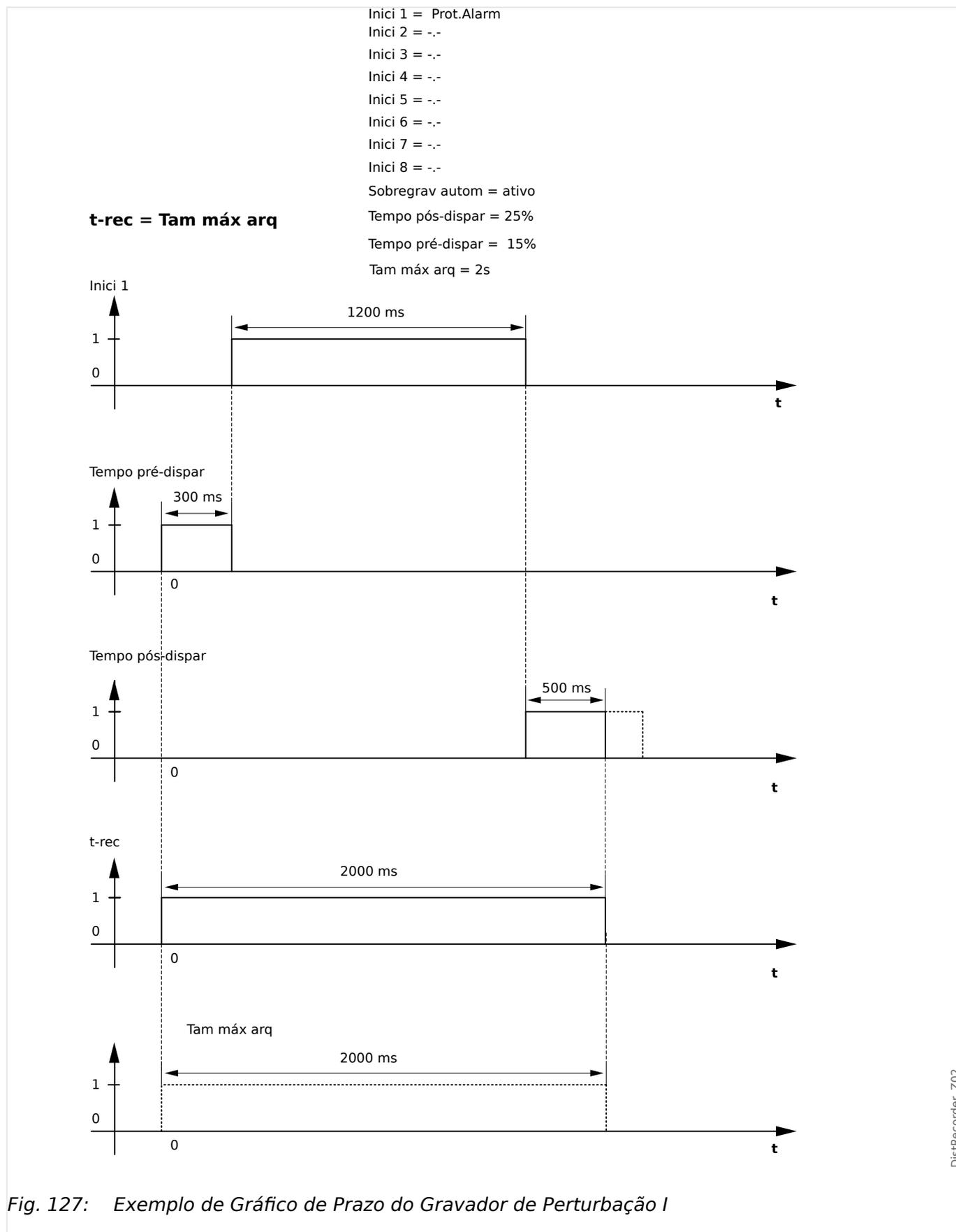
Fig. 127: Exemplo de Gráfico de Prazo do Gravador de Perturbação I
