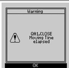
Avertissement : dans ce cas, l'appareillage de connexion n'atteint pas la nouvelle position de fin dans le délai de surveillance défini et l'avertissement suivant s'affiche à l'écran.
